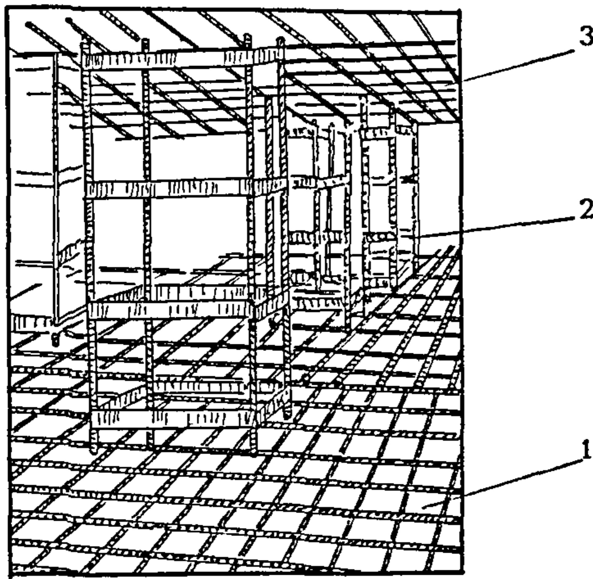
Рис. 4. Армирование плиты по схеме: — нижняя арматурная сетка — монтажный столик — верхняя арматурная сетка:
