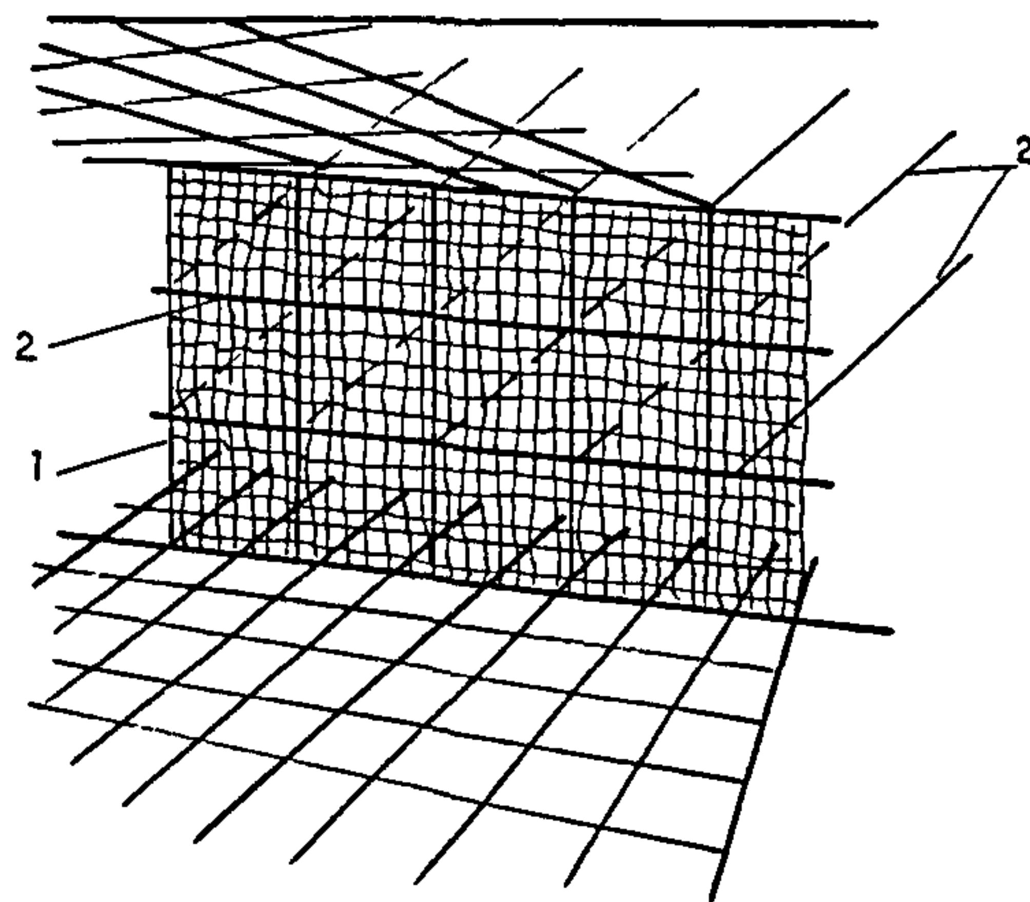
Рис. 1. Внутренняя опалубка рабочего шва плиты:
