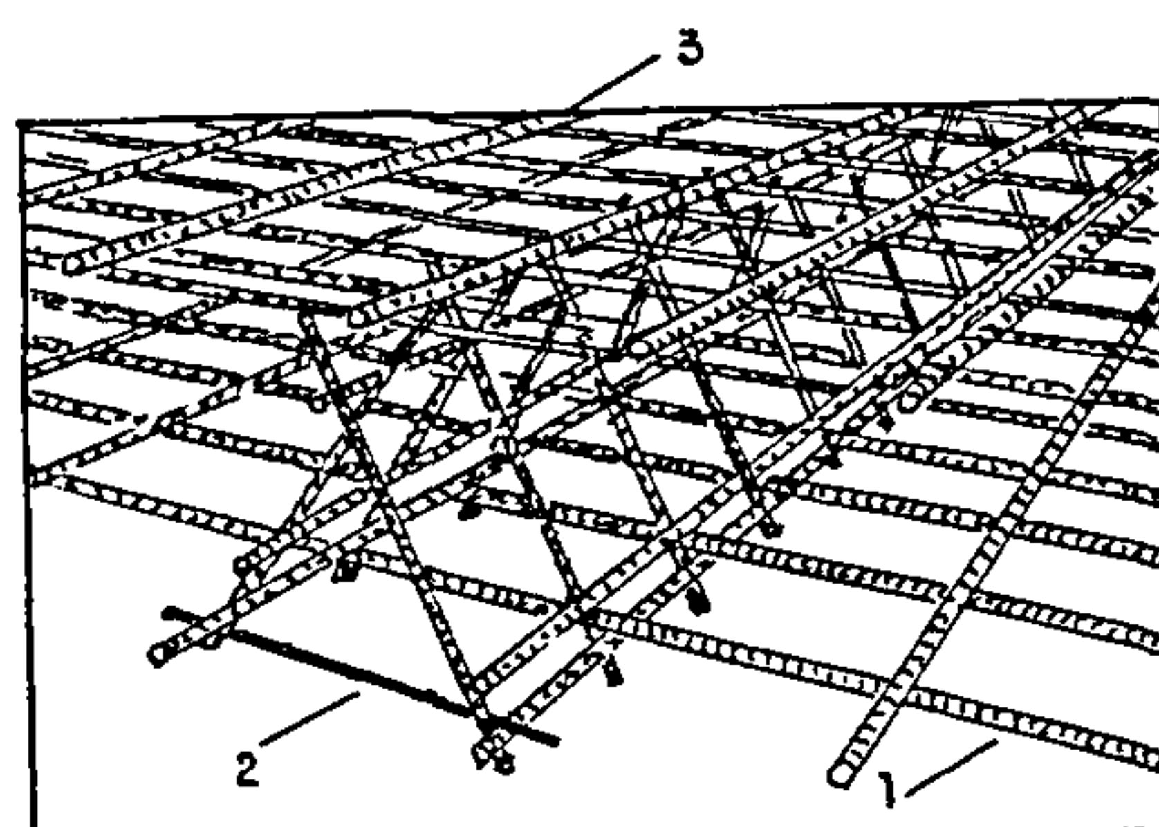
Рис. 2. Армирование плиты по схеме — нижняя арматурная сетка —
