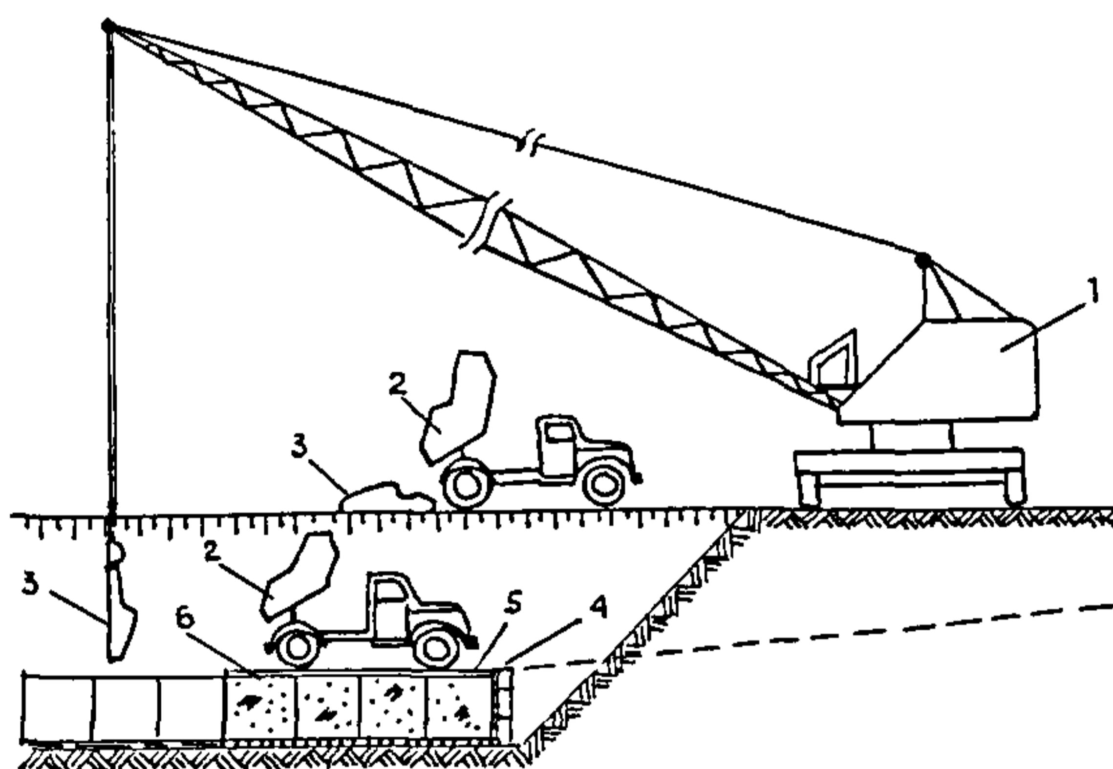
Рис. 8. Одновременная укладка бетонной смеси краном с бадьями, из самосвалов с задней и боковой разгрузкой или автобетоновозов непосредственно в плиту:
