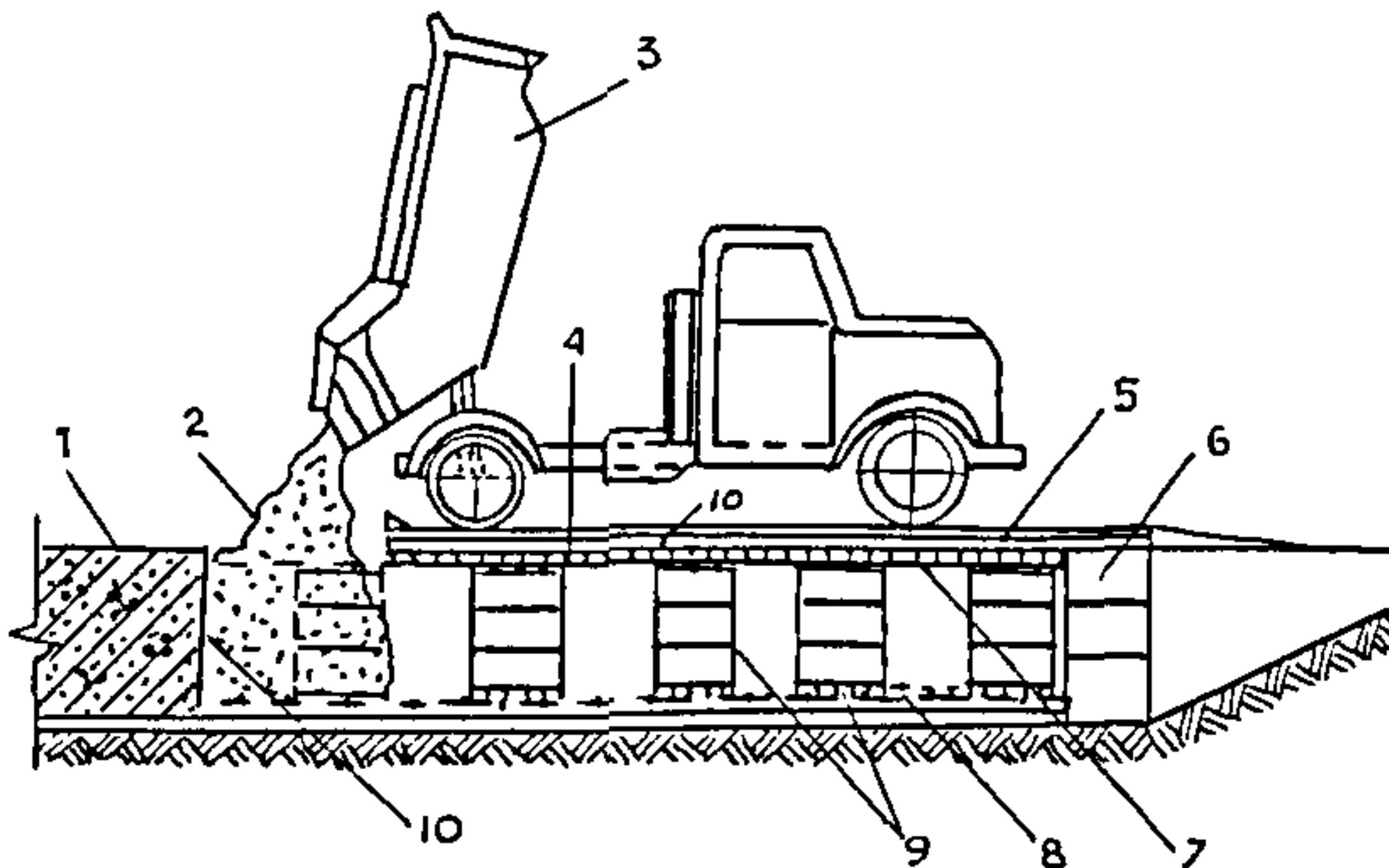
**Рис.6. Бетонирование плиты автобетоносмесителями, автобетоновозами или автосамосвалами методом "на себя":**
