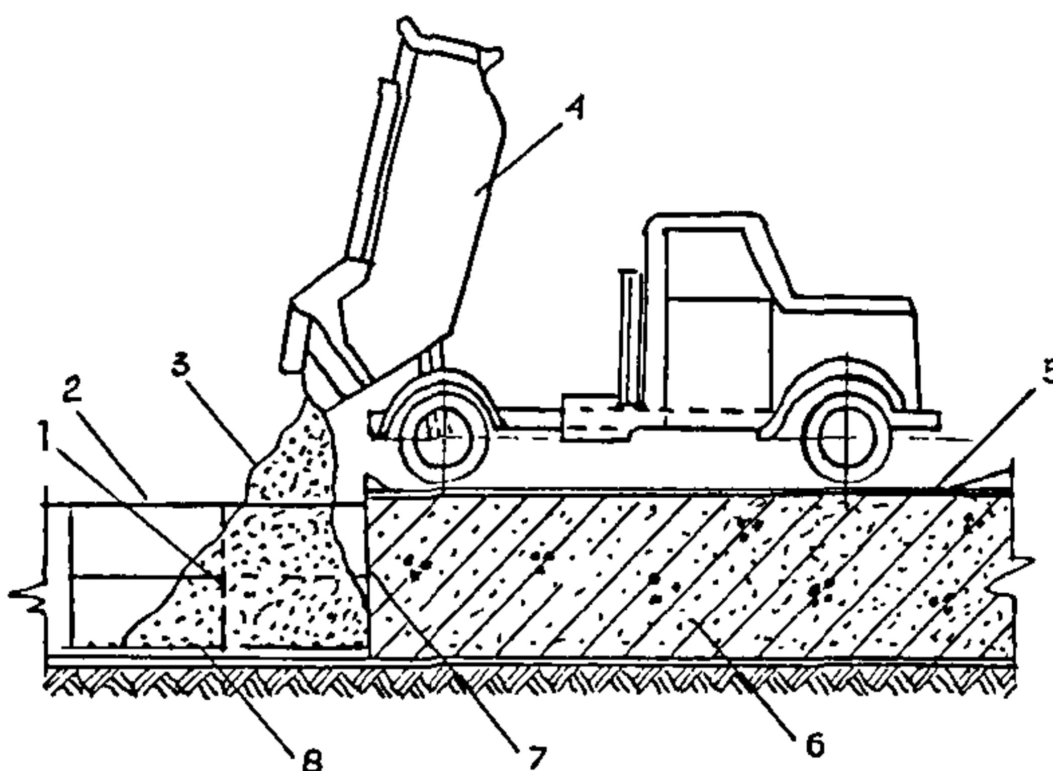
**Рис. 7. Бетонирование плиты автобетоносмесителями, автобетоновозами или автосамосвалами методом "от себя":**
