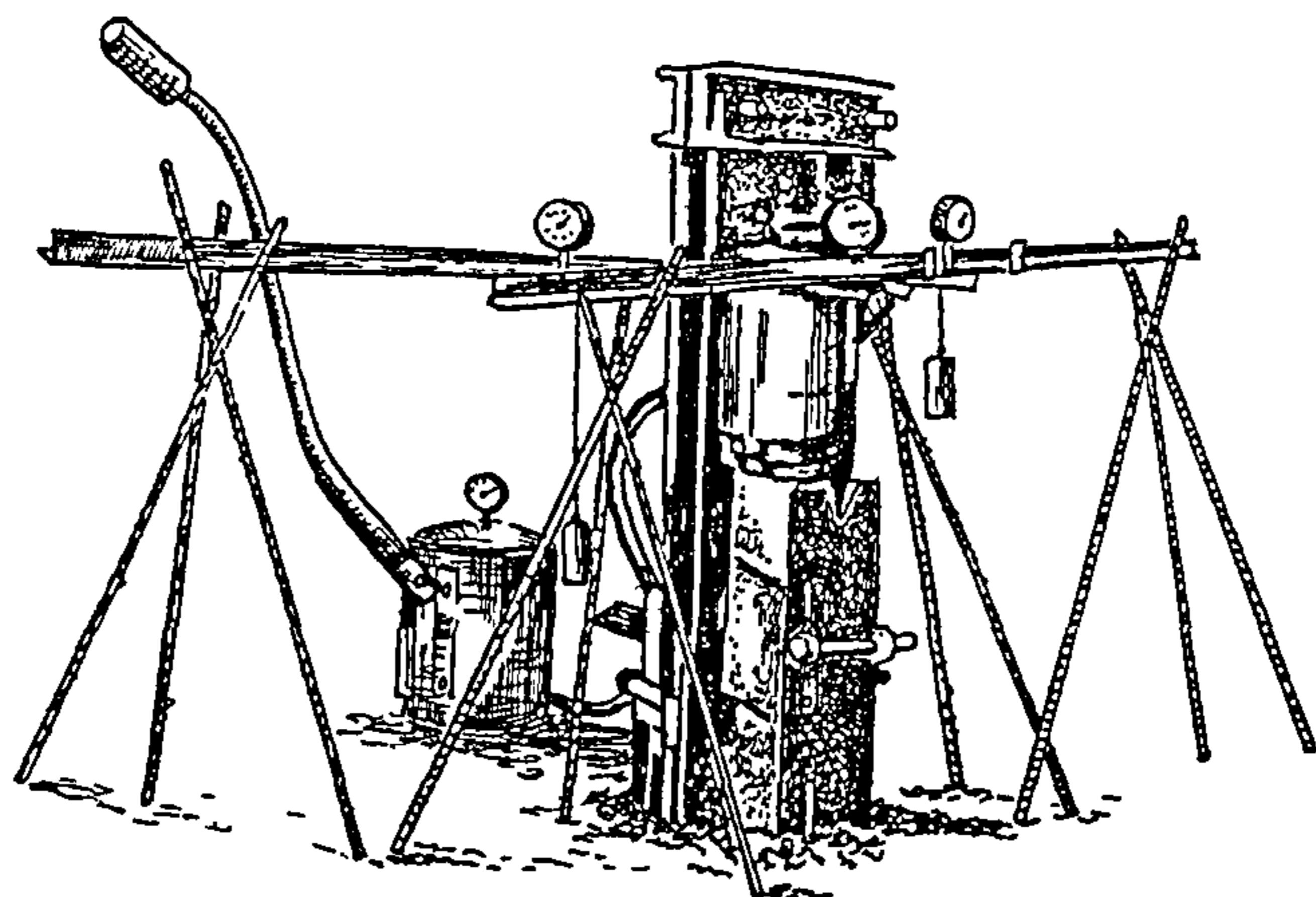
Р и с. 3. Статическое испытание стальной складывающейся сваи
