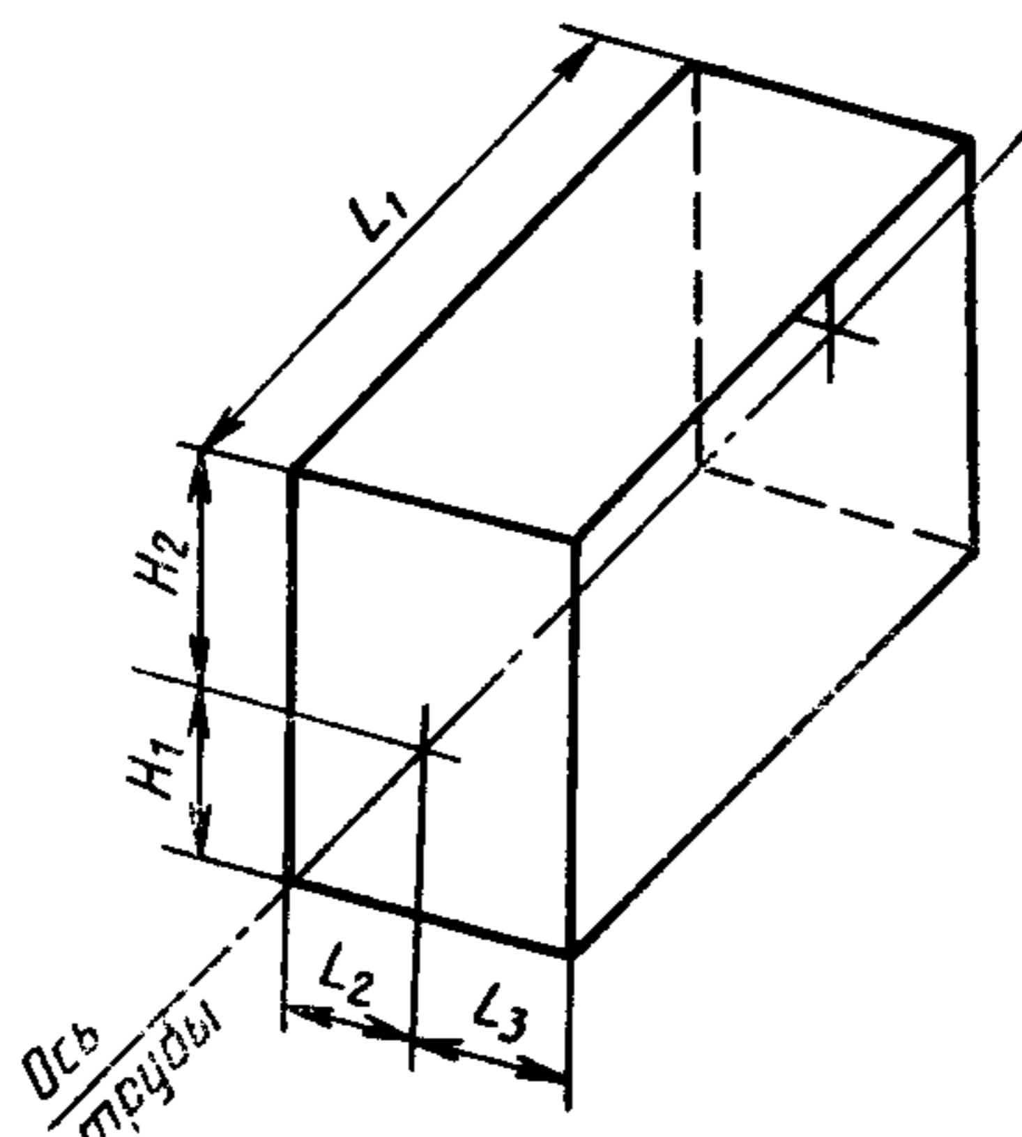
$H_1 + H_2$ ;  $L_1$ ,  $L_2 + L_3$  — соответственно высота, длина и ширина параллелепипеда, в который должен вписываться счетчик (крышка находится под прямым углом к ее закрытому положению);  $H_1$ ,  $H_2$ ,  $L_2$ ,  $L_3$  — максимальные размеры;  $L_1$  — заданное значение с определенными допустимыми погрешностями
