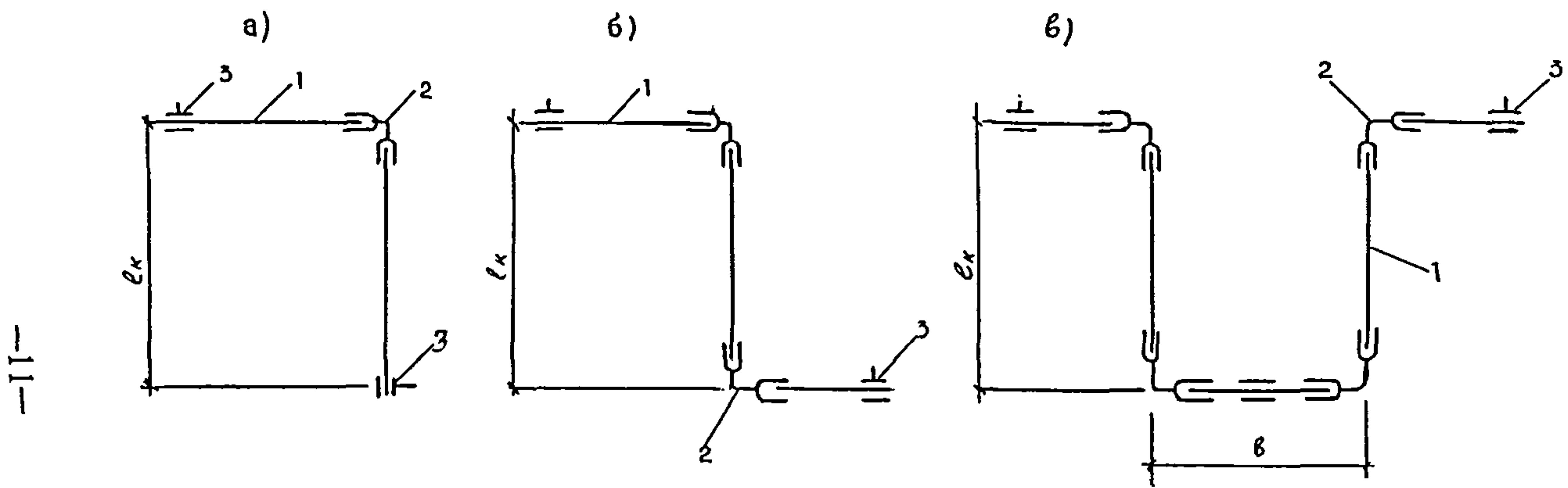
Рис. 1. Схемы компенсаторов на водопроводах из труб PP-R80-GF и PP-R80-AI
