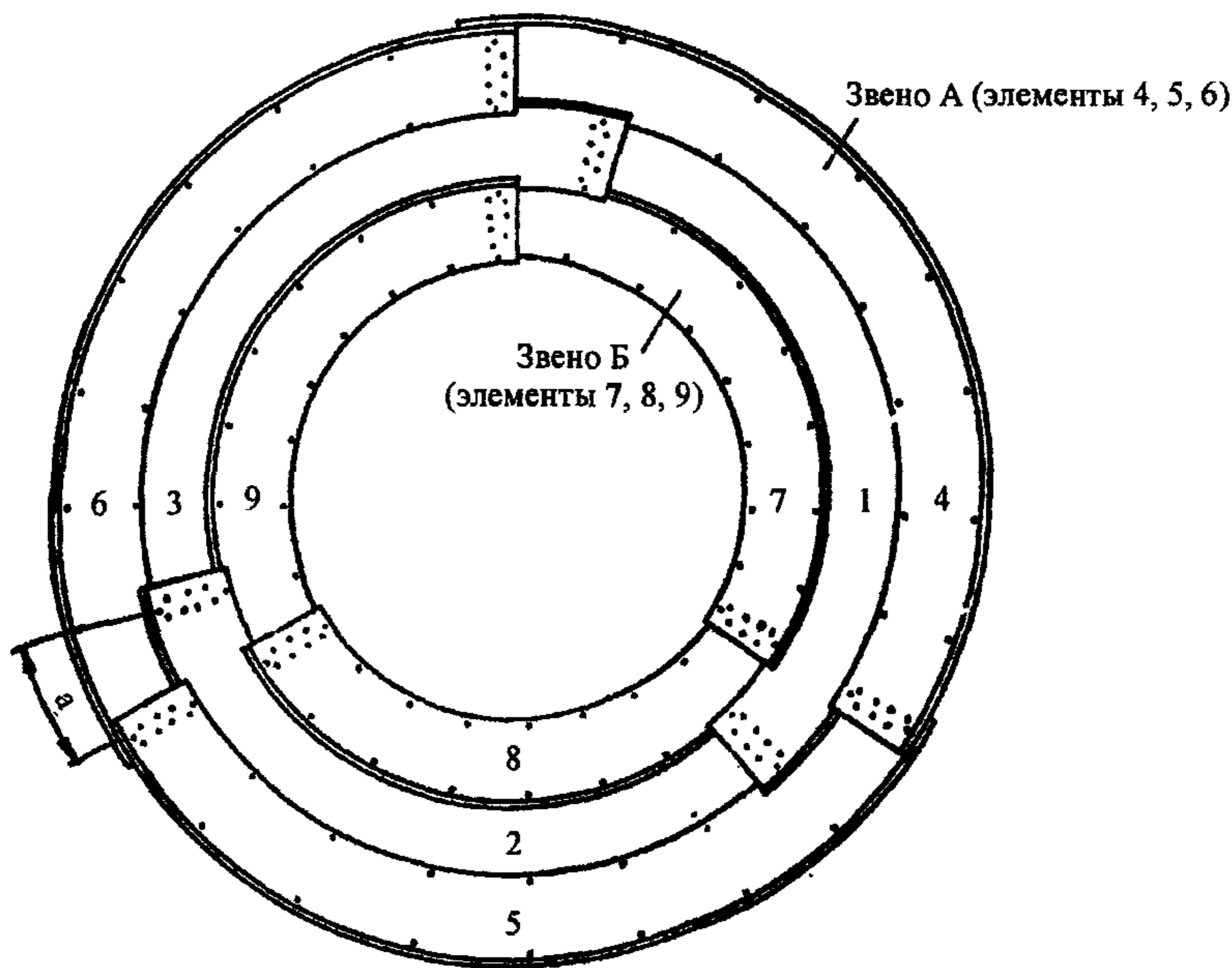
**Рис. 5. Сборка секции трубы из звеньев ( $d = 1,5 \text{ м}$ , вид с торца): цифрами показан порядок установки элементов; а – сдвигка (забег) продольных стыков**
