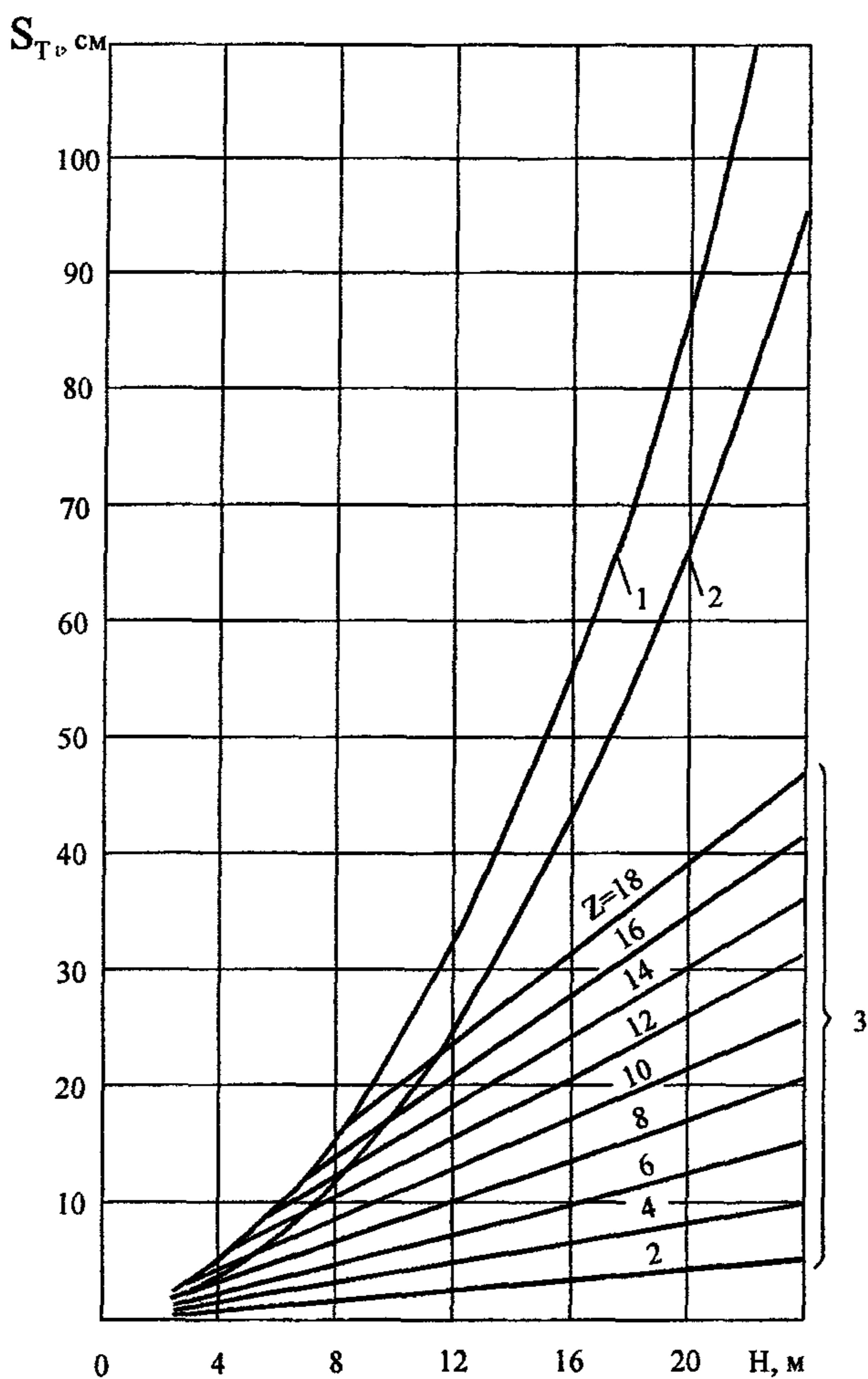
**Рис. 1. Расчетный график для определения осадки трубы:**
