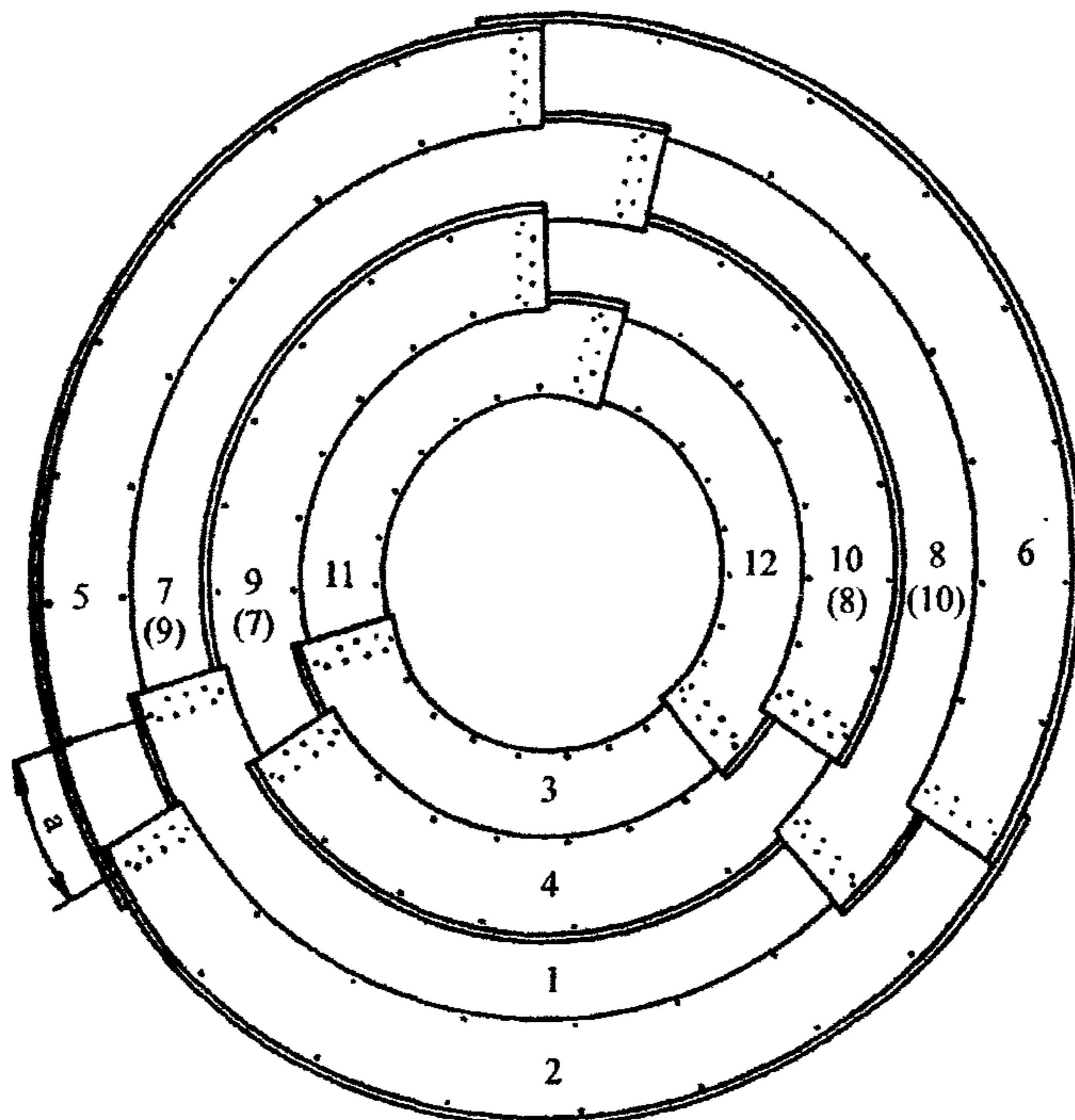
*Рис.8. Сборка труб из элементов на оси сооружения
