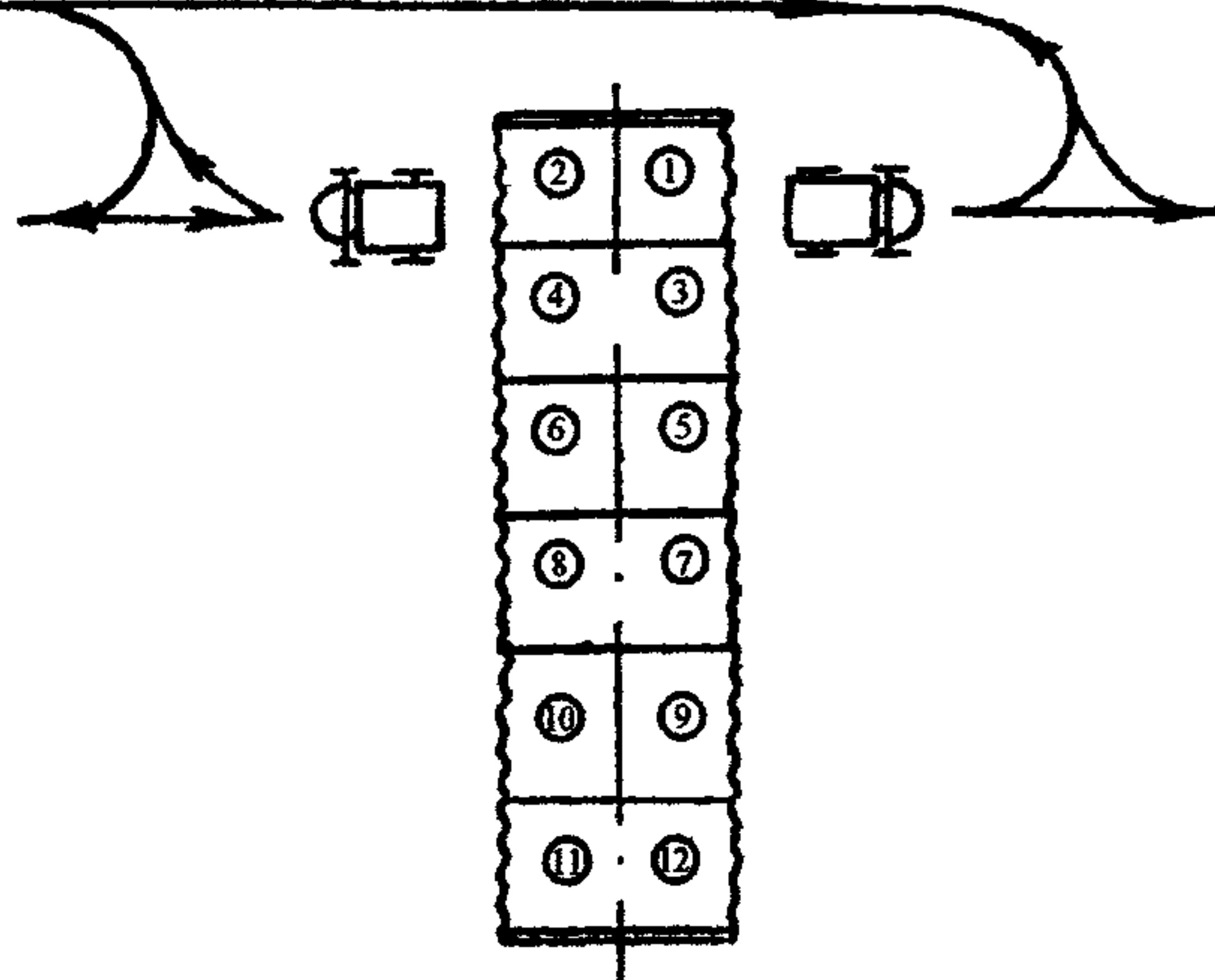
*Рис. 9. Схемы движения автомобилей-самосвалов и уплотняющих механизмов при устройстве обоймы:
