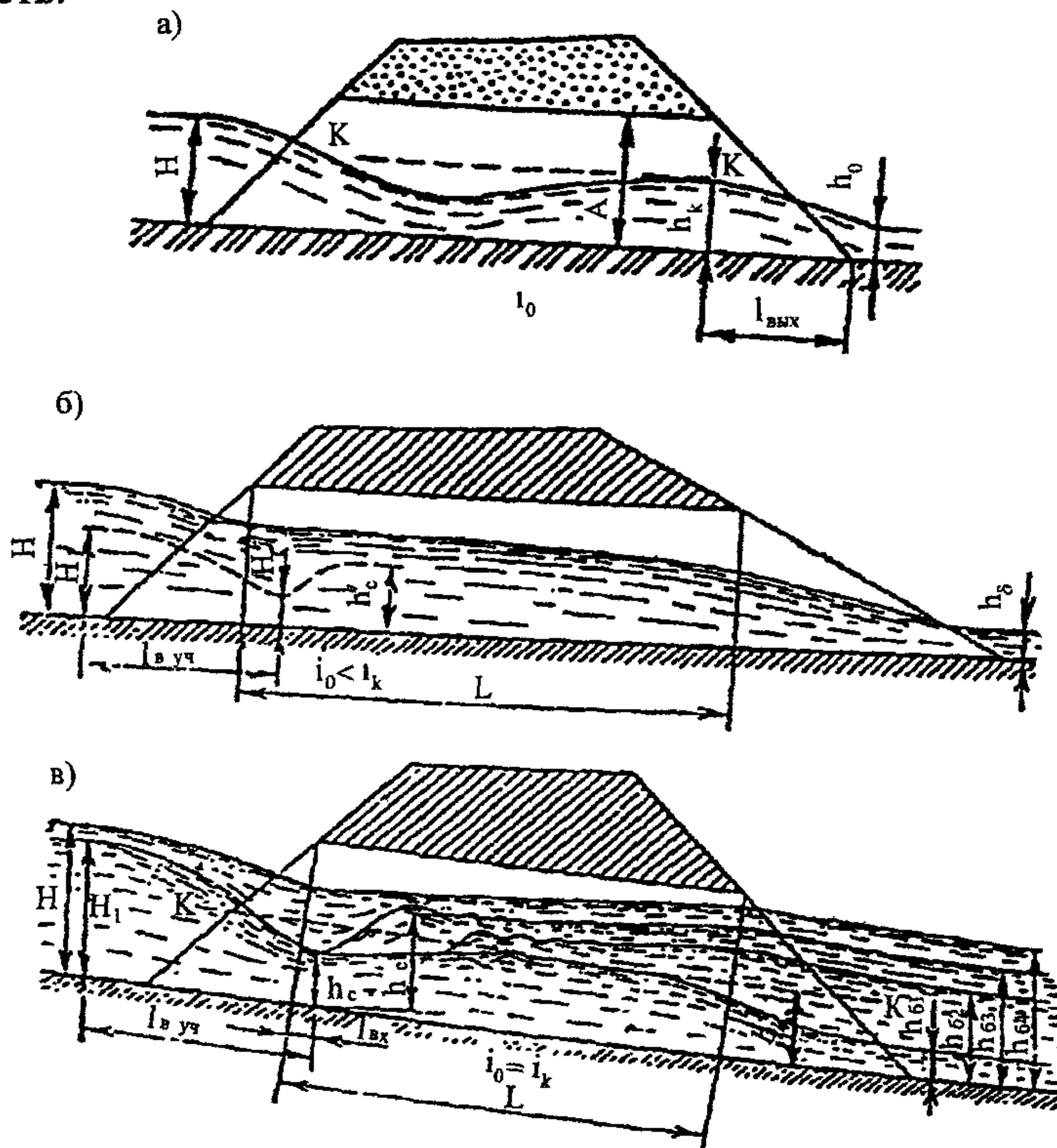
**Рис. 1. Схема протекания воды в равнинной трубе при безнапорном режиме:**
