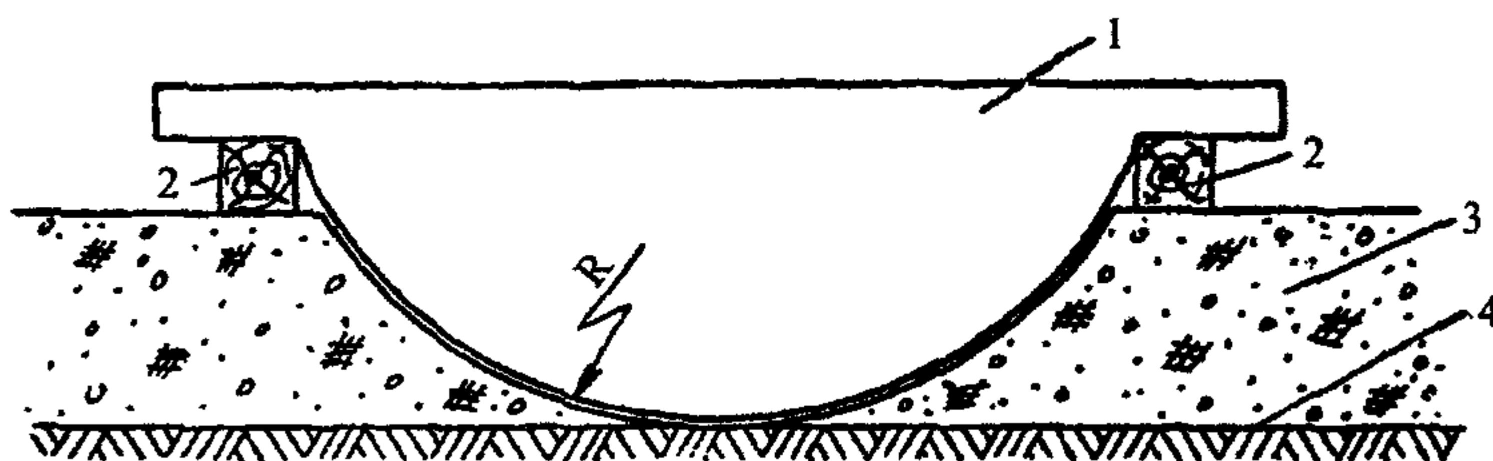
*Рис. 4. Вырезка грунтового ложа по шаблону:*
