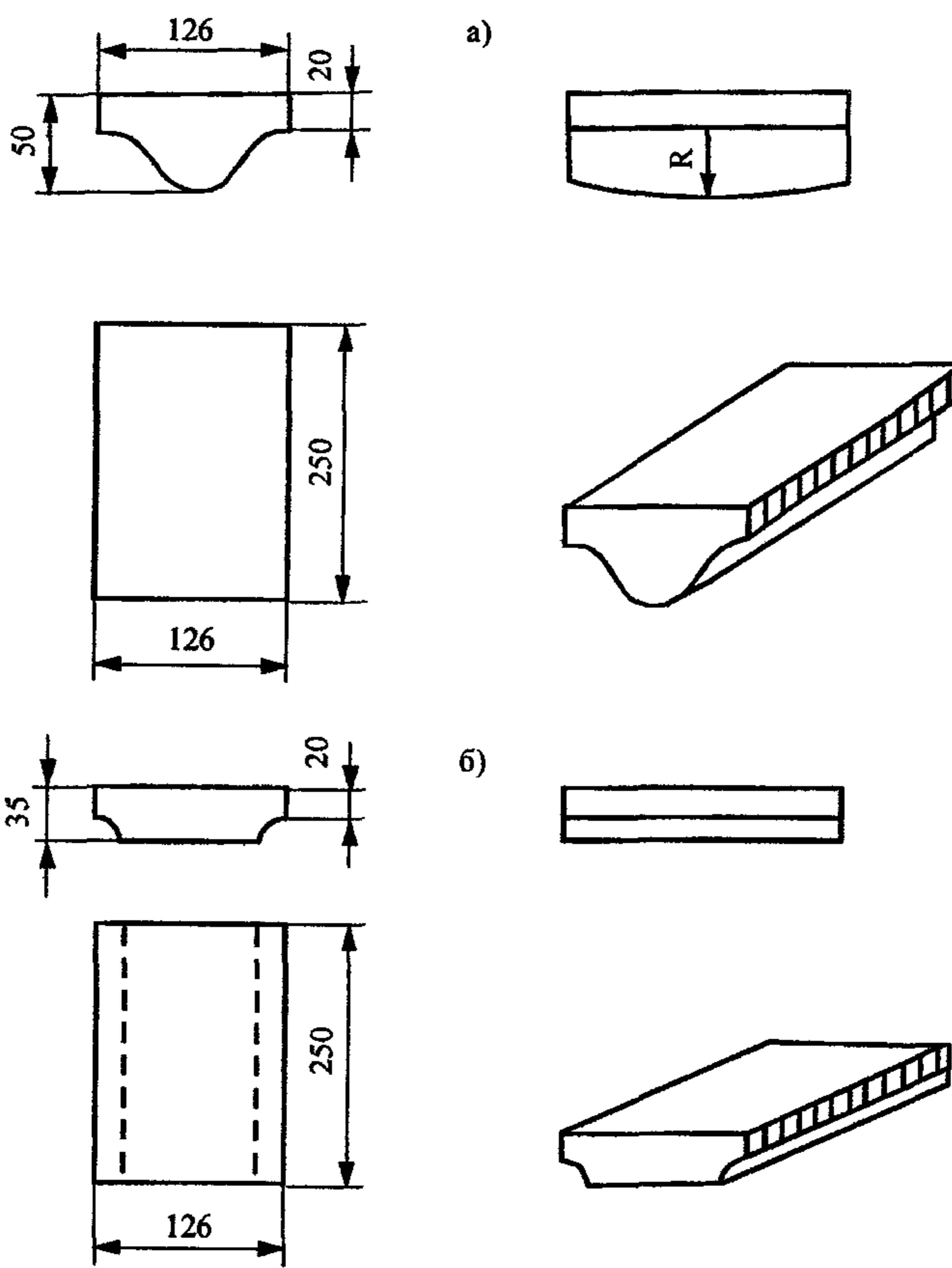
**Рис.10. Типы сборных асфальтобетонных лотков:**
