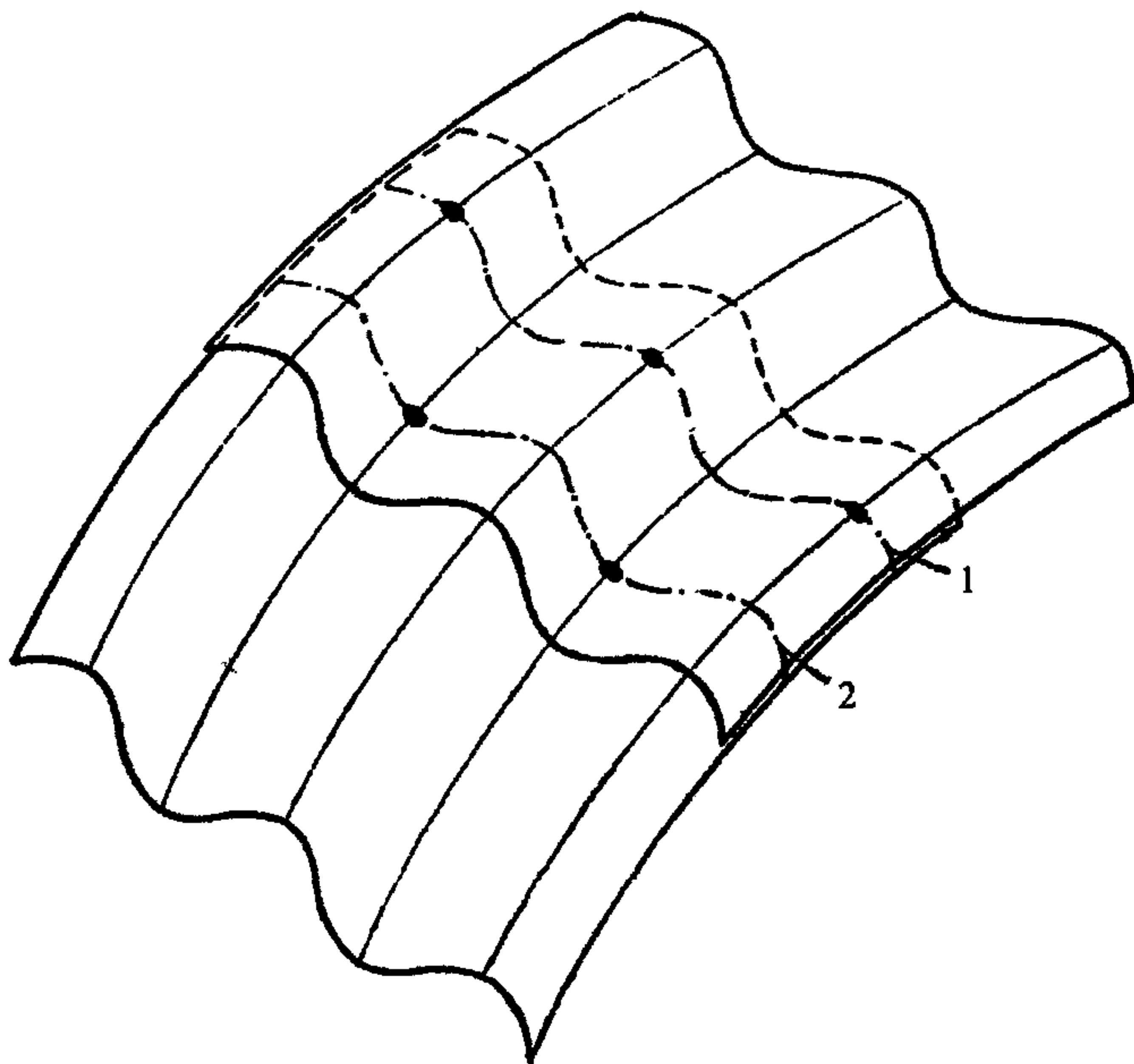
*Рис. 6. Размещение болтов продольного стыка:
