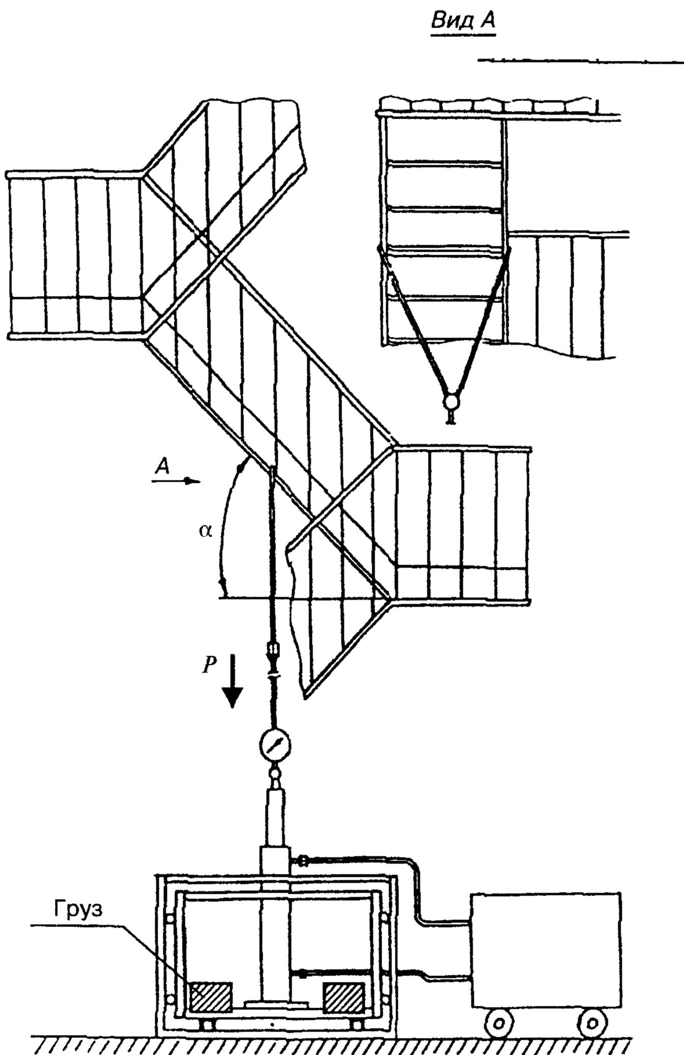
**Рисунок 3.** Испытание на прочность марша лестницы
