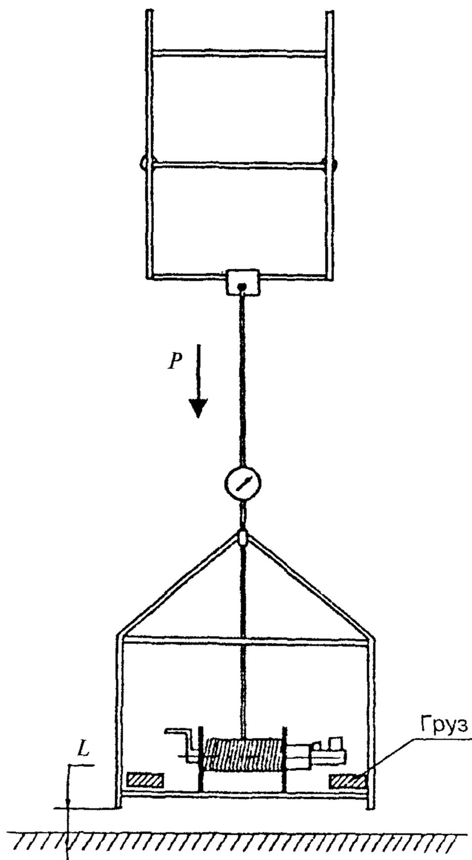
**Рисунок 1.** Испытание на прочность ступени лестницы
