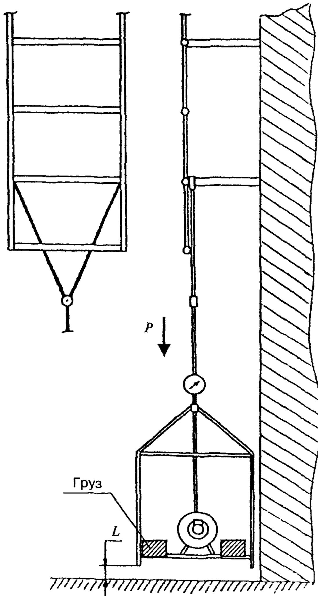
**Рисунок 2.** Испытание на прочность балки крепления вертикальной лестницы (высота отрыва площадки от земли  $L = 100\text{--}200$  мм)
