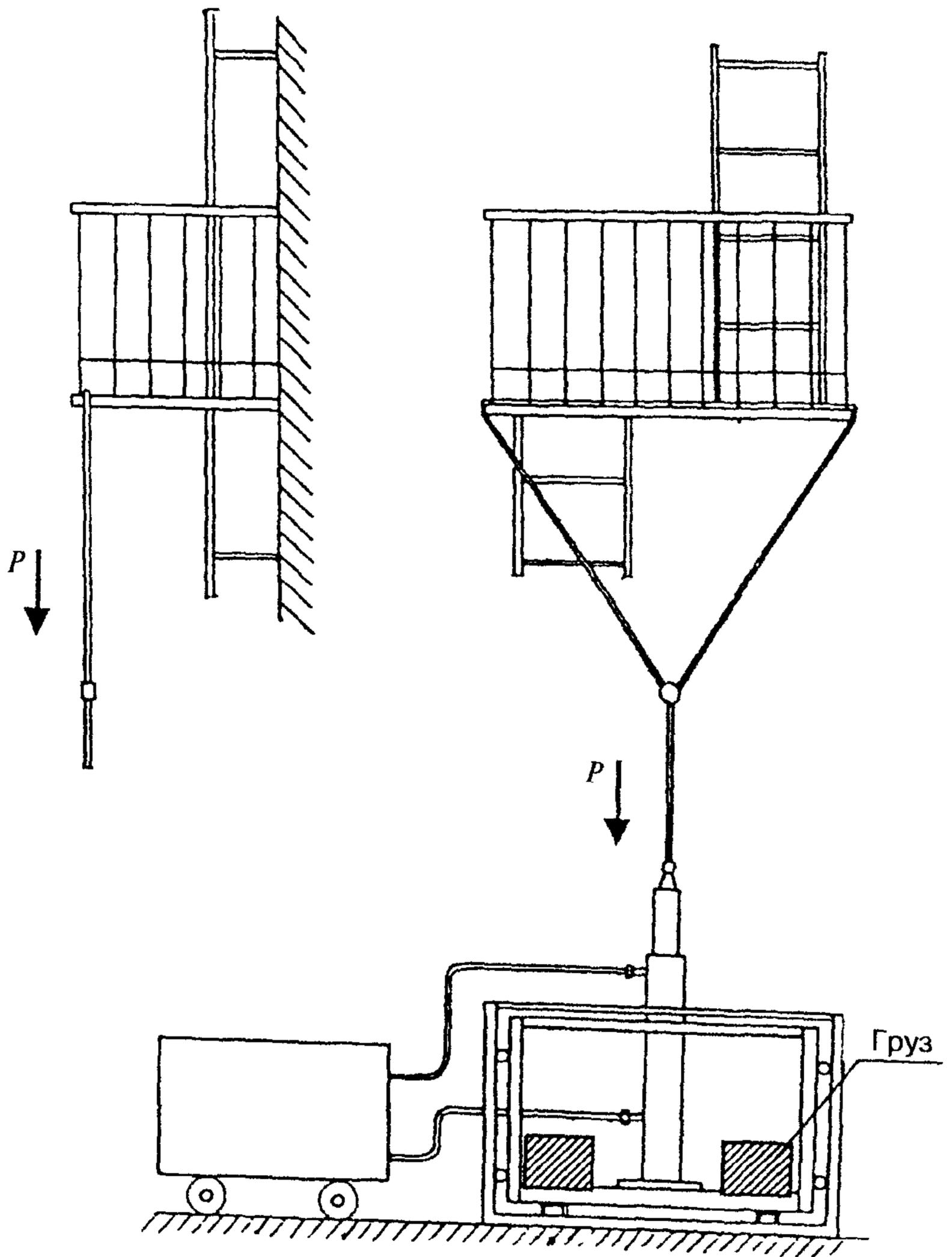
Рисунок 4. Испытание на прочность площадки лестницы
