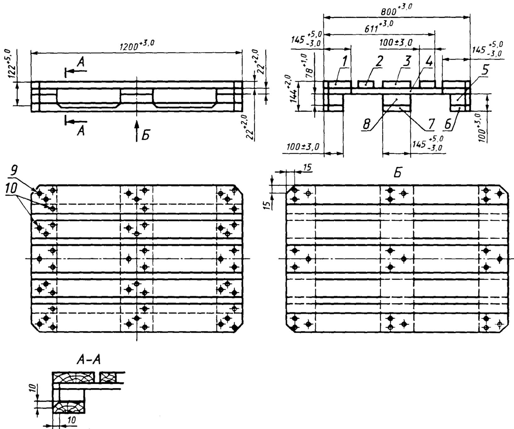
1 — доска настила (крайняя); 2 — доска настила (промежуточная); 3 — доска настила (средняя); 4 — доска поперечная; 5 — малая шашка; 6 — доска основания (крайняя); 7 — доска основания (средняя); 8 — большая шашка; 9 — винтовые гвозди диаметром 4,5 мм и длиной 90 мм; 10 — винтовые гвозди диаметром 3,5 мм и длиной 60 мм
