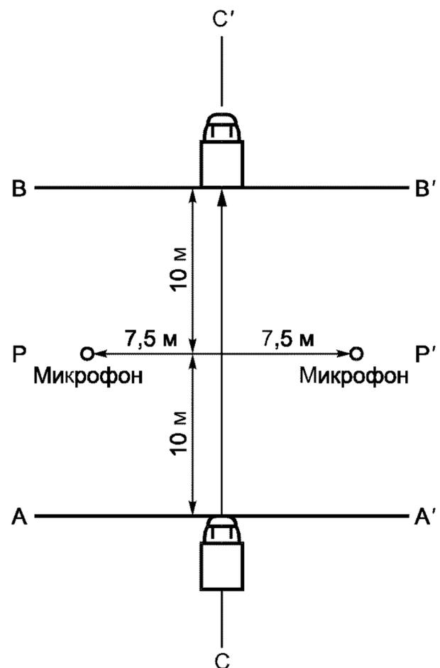
Рисунок 3.1 — Положения движущихся транспортных средств при измерениях
