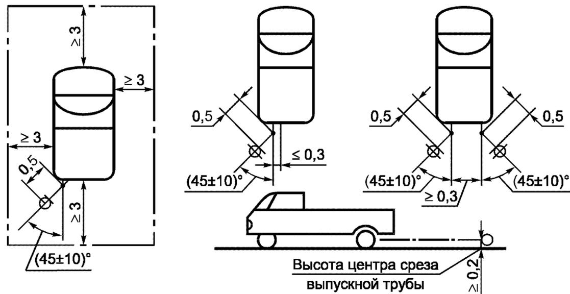
Рисунок 3.2 — Положения неподвижных транспортных средств при измерениях
