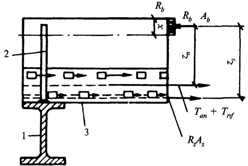
Рис. 14. Схема усилий при расчете по прочности анкеровки
