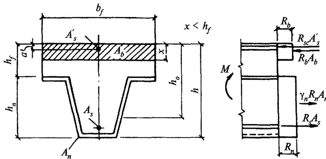
Рис. 10. Схема усилий в пролетном сечении плиты при расположении нейтральной оси в пределах толщины полки плиты
