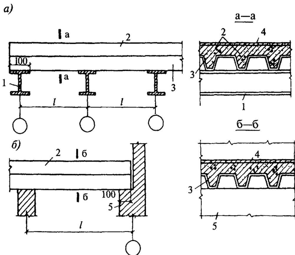
Рис. 2. Конструктивные схемы монолитного перекрытия по СПН
