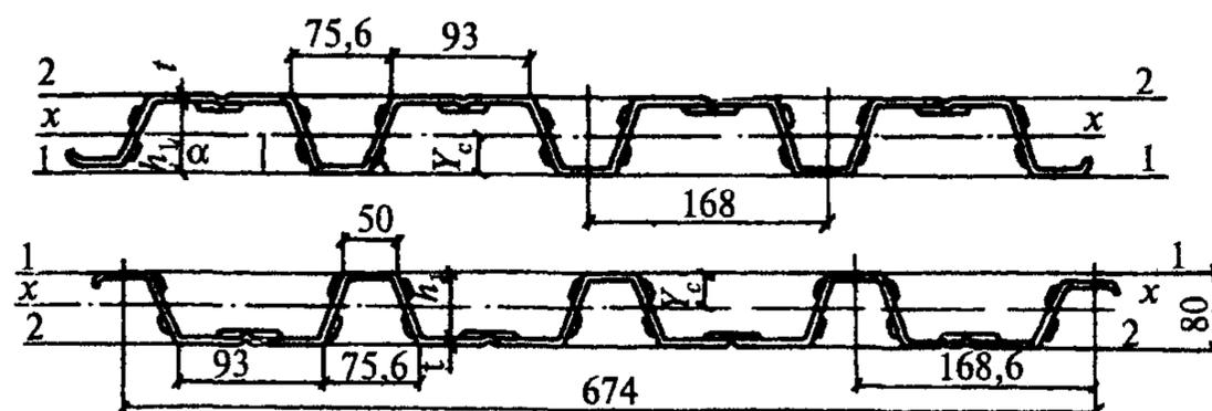
Рис. 1. Стальной профилированный настил, рекомендуемый для монолитных перекрытий
