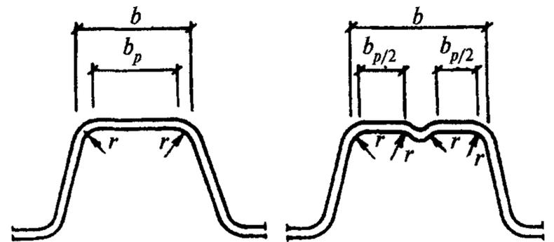
Рис. 5. К определению ширины плоских участков сжатых полок
