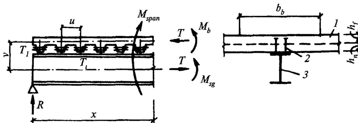
Рис. 17. Схема усилий в комбинированной балке
