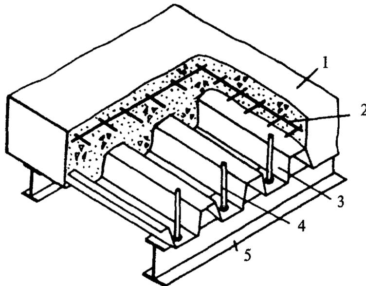
3.3. Длину пролета плиты рекомендуется назначать в пределах 1,5—3 м. Допускаются большие пролеты при устройстве временных опор на период бетонирования и вызревания бетона.
