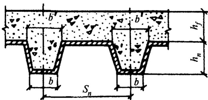
Рис. 4. К определению приведенной толщины бетона
