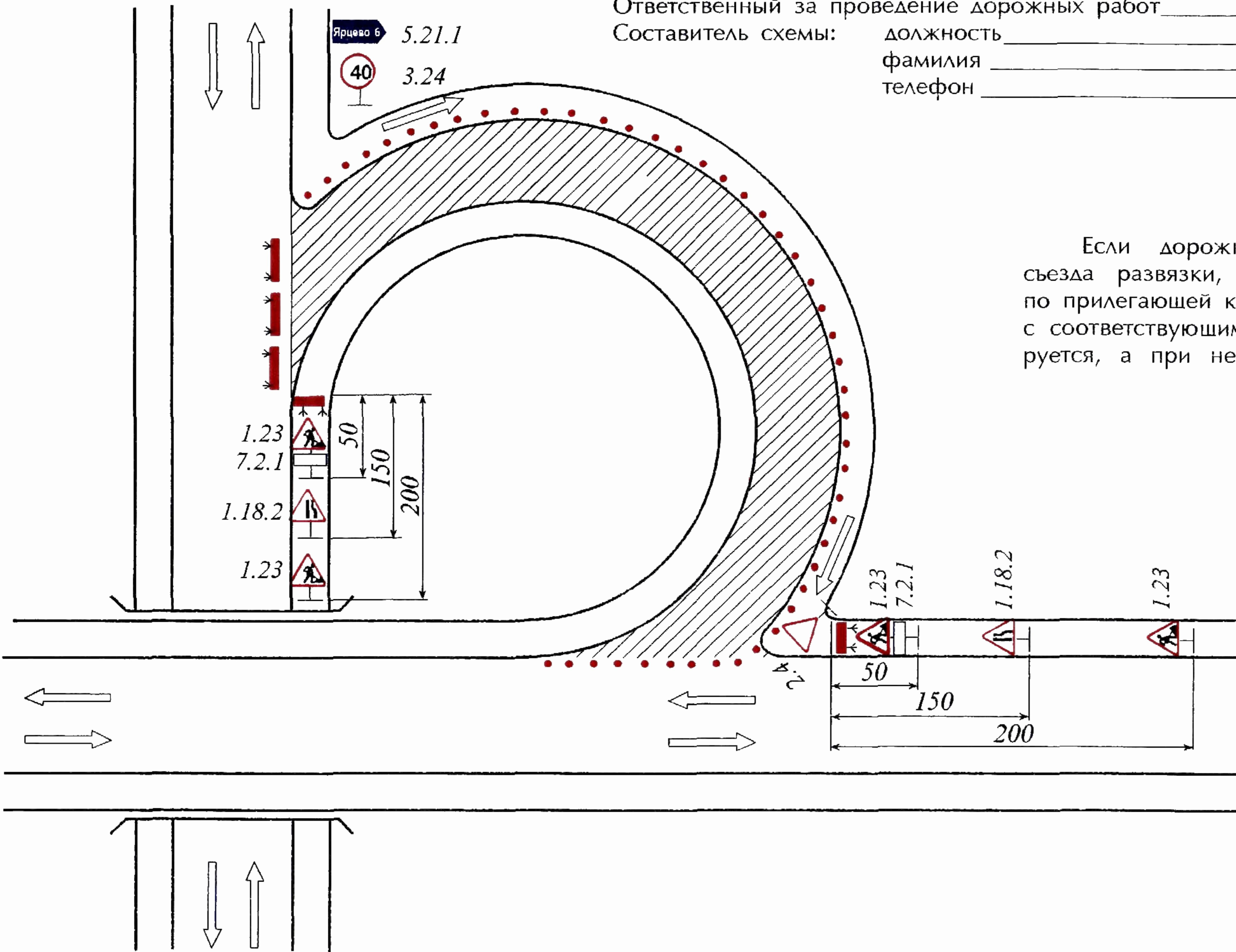
Если дорожные работы проводятся на проезжей части съезда развязки, движение транспортных средств осуществляют по прилегающей к проезжей части обочине (п.3.17 “Инструкции...”) с соответствующим обустройством, которая предварительно планируется, а при необходимости и укрепляется.
