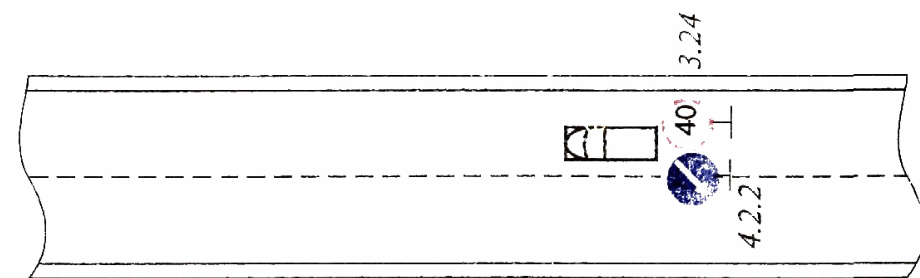
**V. При нанесении линий разметки пешеходных переходов**
