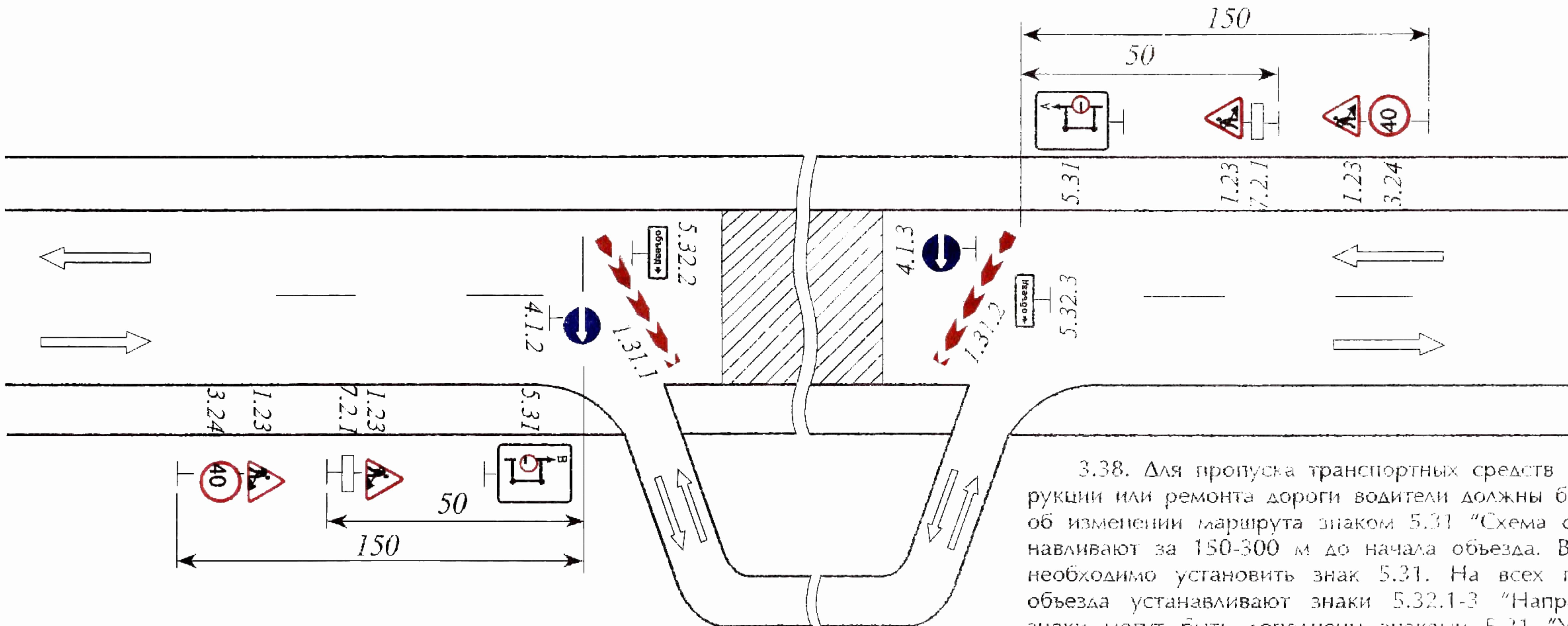
3.35. Участки объездов зон реконструкции и ремонта следует делать по возможности короче, чтобы уменьшить потери времени транспортными средствами на перепроехе и снизить расход топлива.
