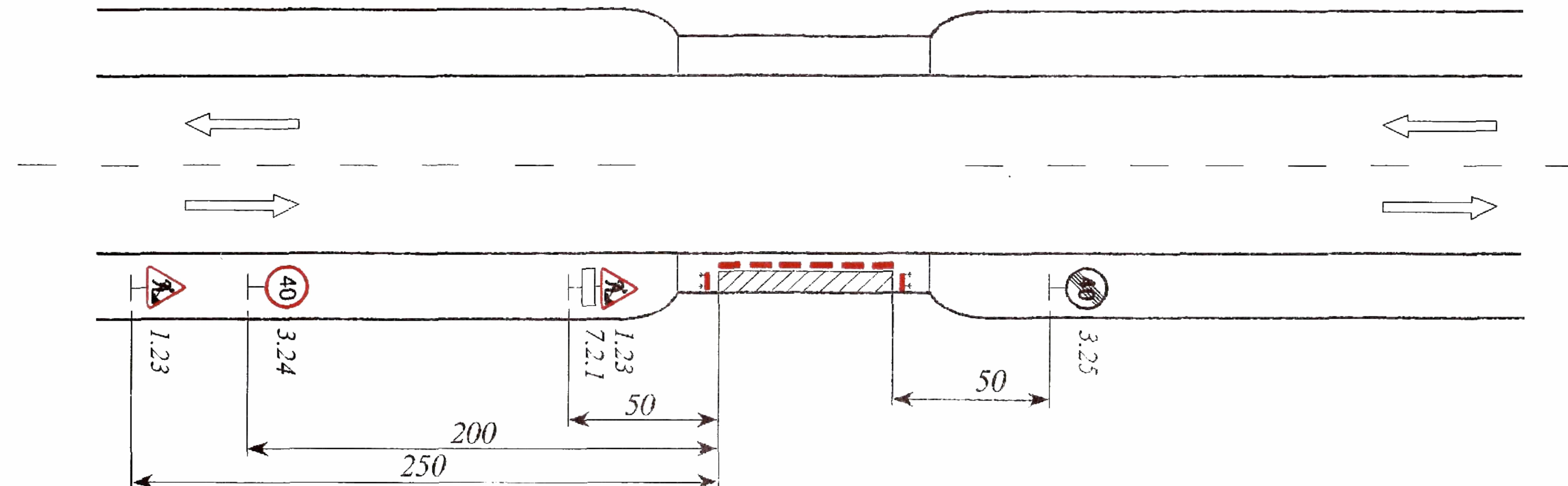
Если дорожные работы производят на части ширины тротуара, когда его оставшаяся ширина достаточна для пропуска пешеходов, оборудуют место работы и организуют движение в соответствии с данной схемой. При этом место работ необходимо оградить сплошными щитами (см. рис. 4.2,е).
