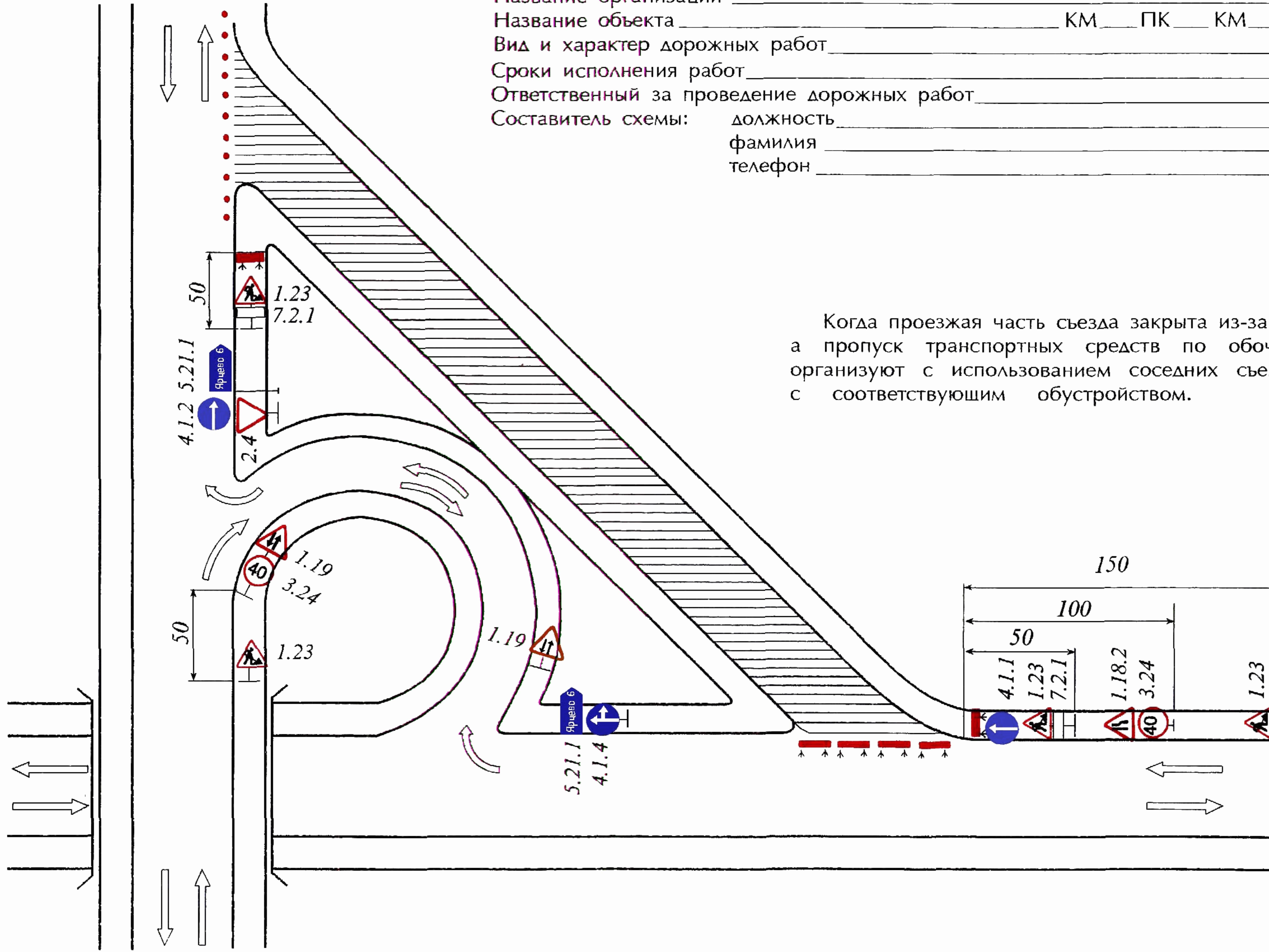
Когда проезжая часть съезда закрыта из-за проведения дорожных работ,
