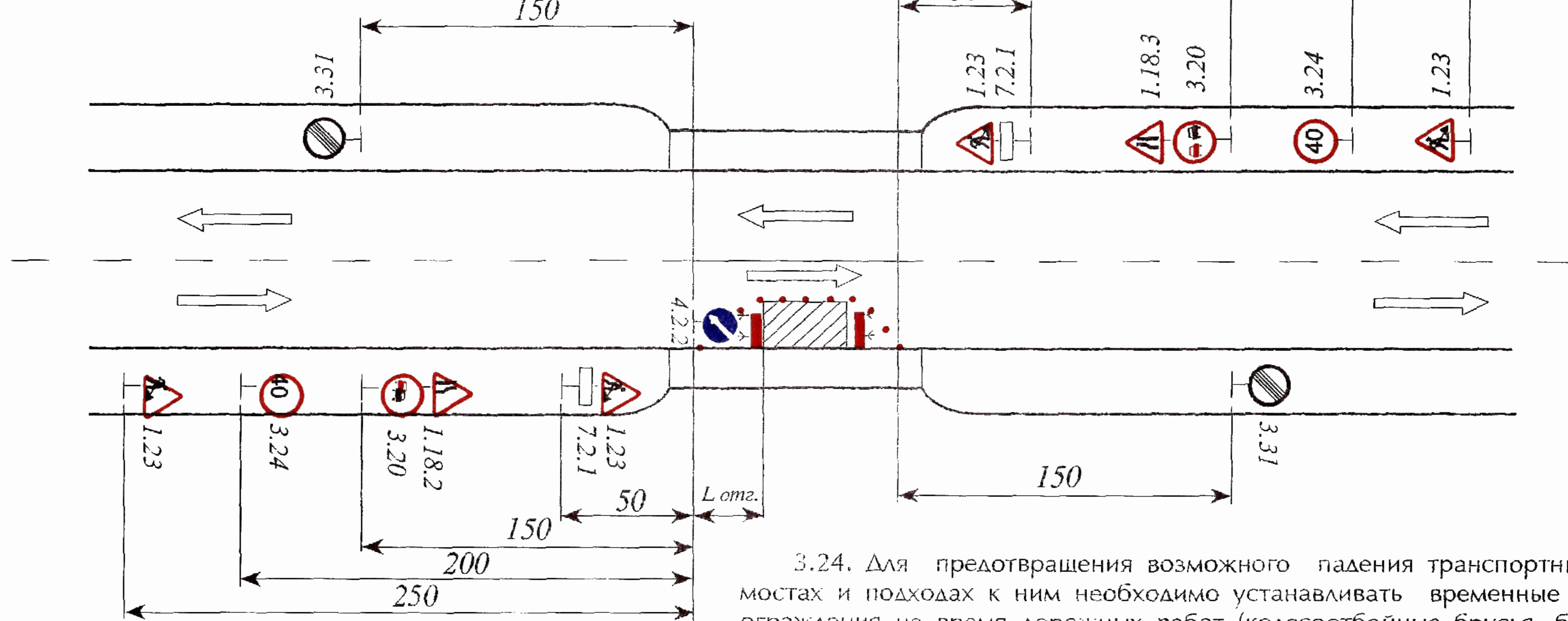
По данной схеме организуют движение, если свободный от ремонтных работ габарит моста не менее 5,5 м и позволяет осуществлять двустороннее движение (п.3.27 “Инструкции...”).
