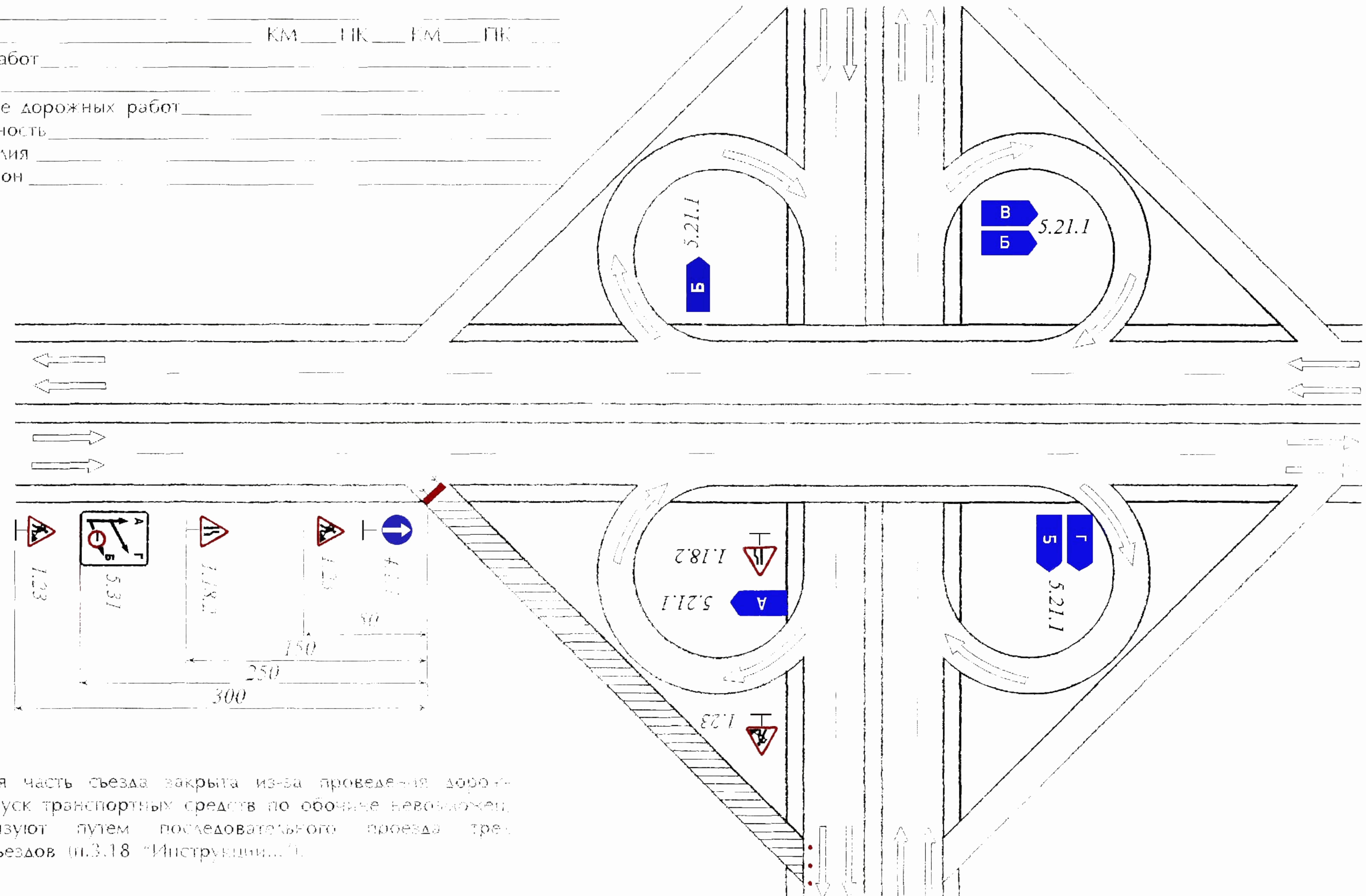
Когда проезжая часть съезда закрыта из-за проведения дорожных работ, а пропуск транспортных средств по обочине невозможен, движение организуют путем последовательного проезда трех левоповоротных съездов (п.3.18 “Инструкции...”).
