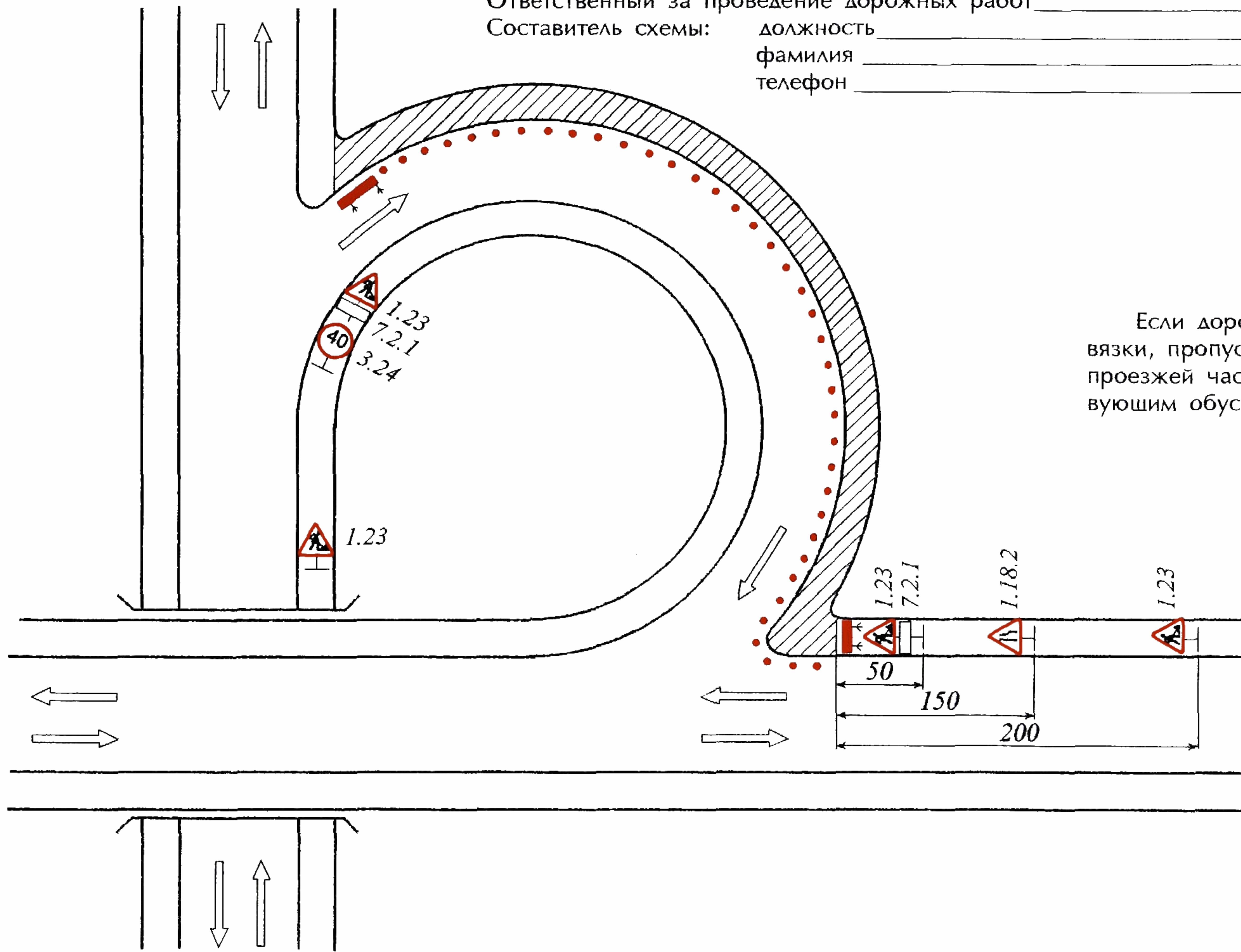
Если дорожные работы ведутся на обочине съезда развязки, пропуск транспортных средств осуществляют по проезжей части съезда (п.3.16 "Инструкции...") с соответствующим обустройством зоны работ.
