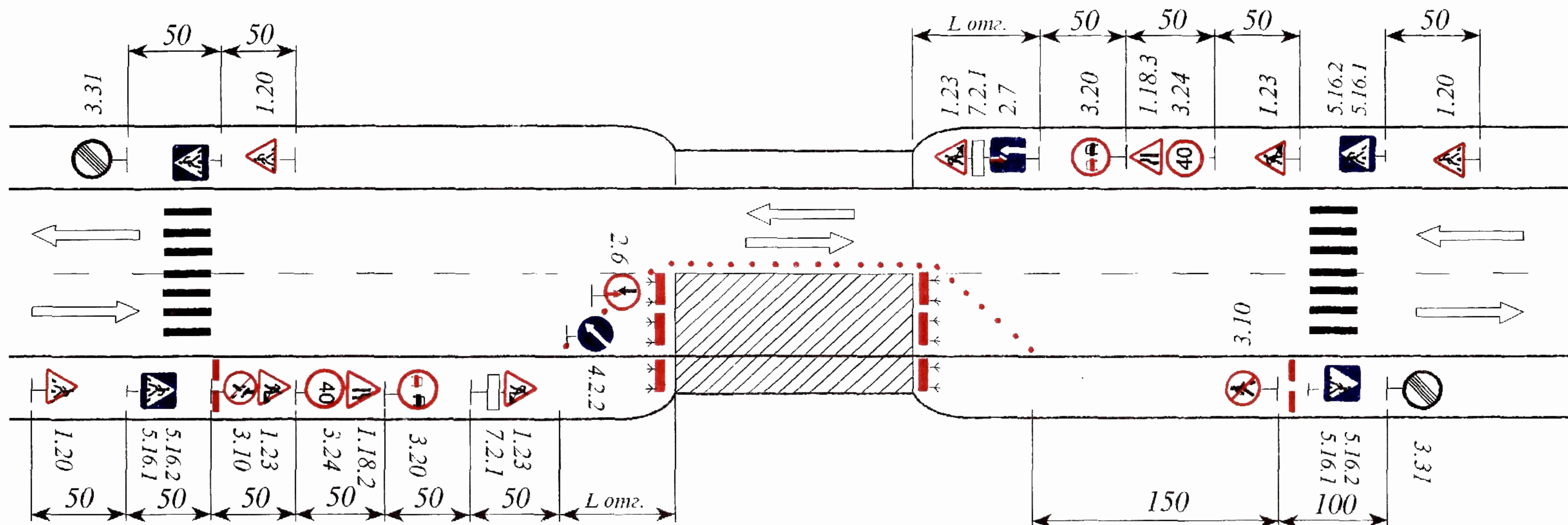
3.24. Для предотвращения возможного падения транспортных средств на мостах и подходах к ним необходимо устанавливать временные удерживающие ограждения на время дорожных работ (колесоотбойные брусья, бетонные блоки или плиты и т.д.).
