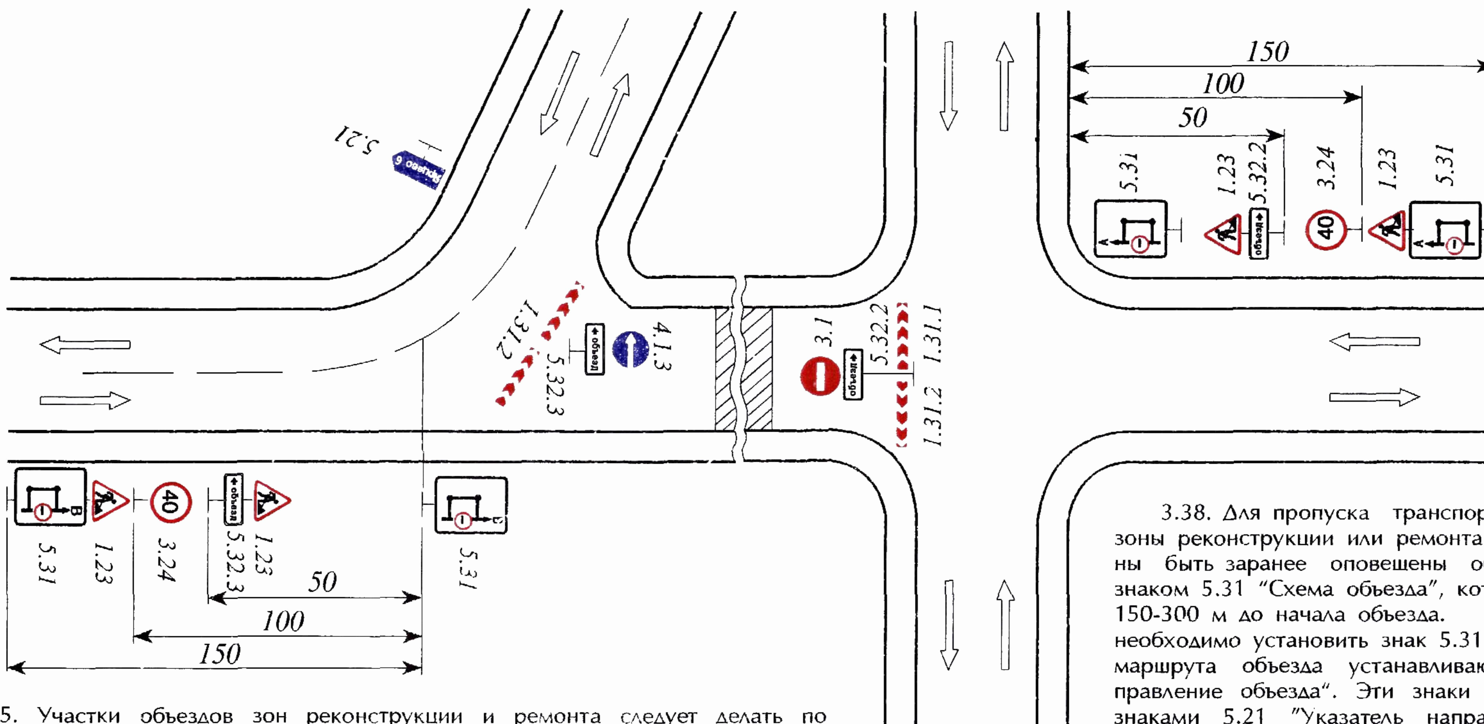
3.35. Участки объездов зон реконструкции и ремонта следует делать по возможности короче, чтобы уменьшить потери времени транспортными средствами на перепроехе и снизить расход топлива.
