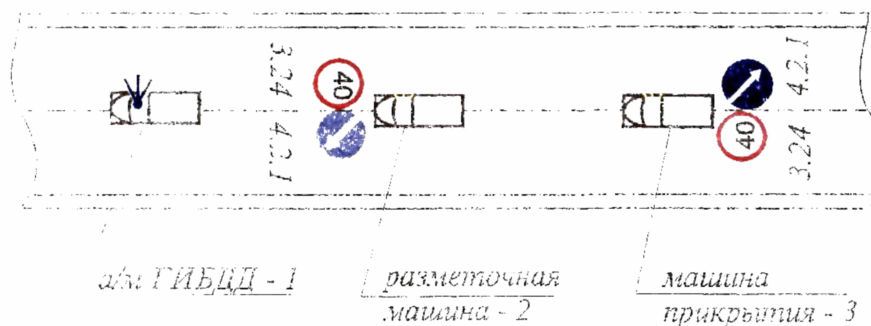
Знаки устанавливаются на заднем борту и бампере автомобиля
