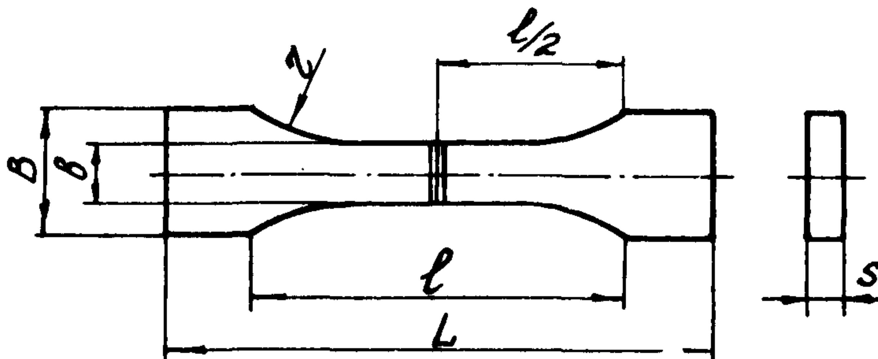
Рис. I. Образец для испытания сварных стыковых соединений на растяжение
