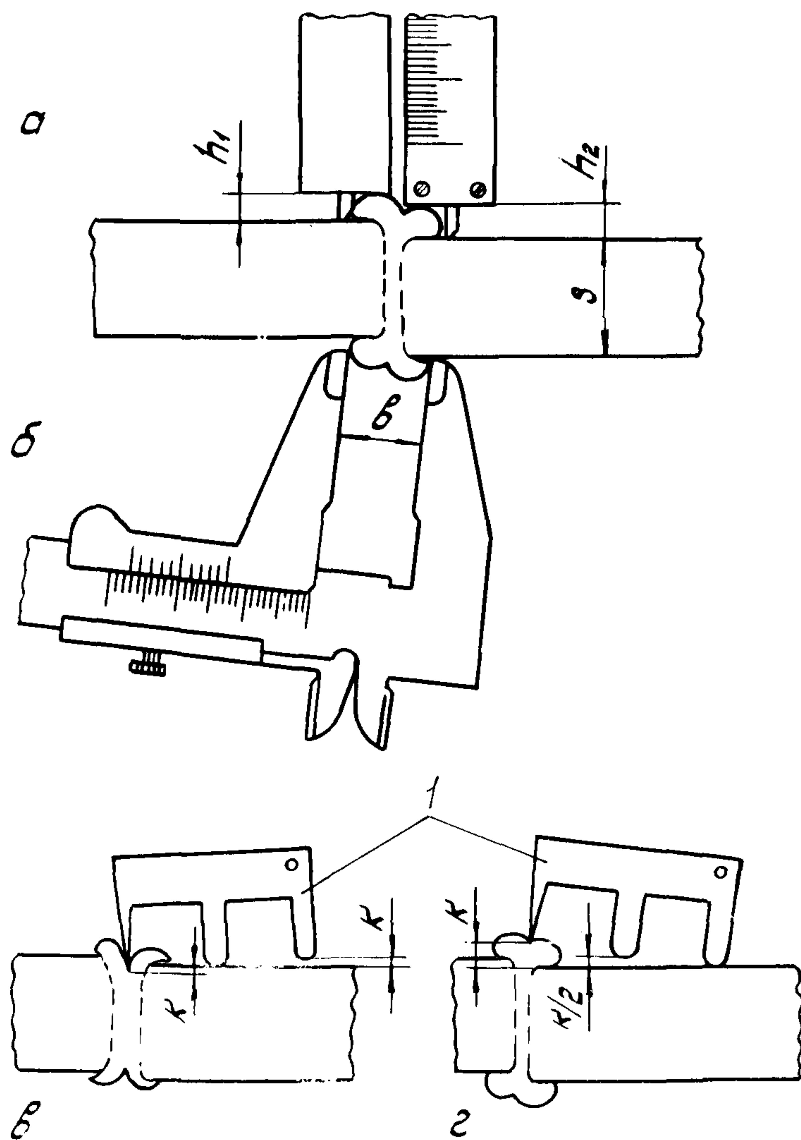
Рис.15. Схема измерения параметров стыкового соединения:
