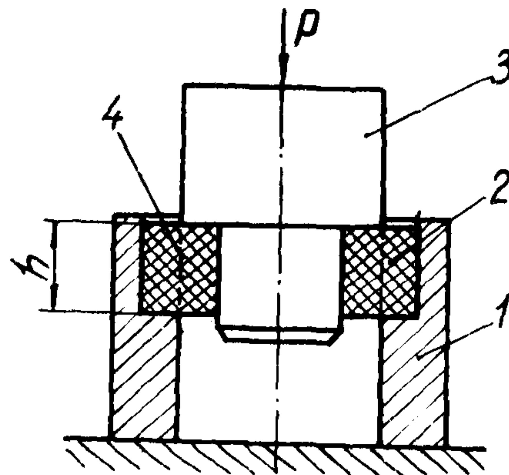
Рис.3. Схема испытания раструбного сварного соединения на сдвиг:
