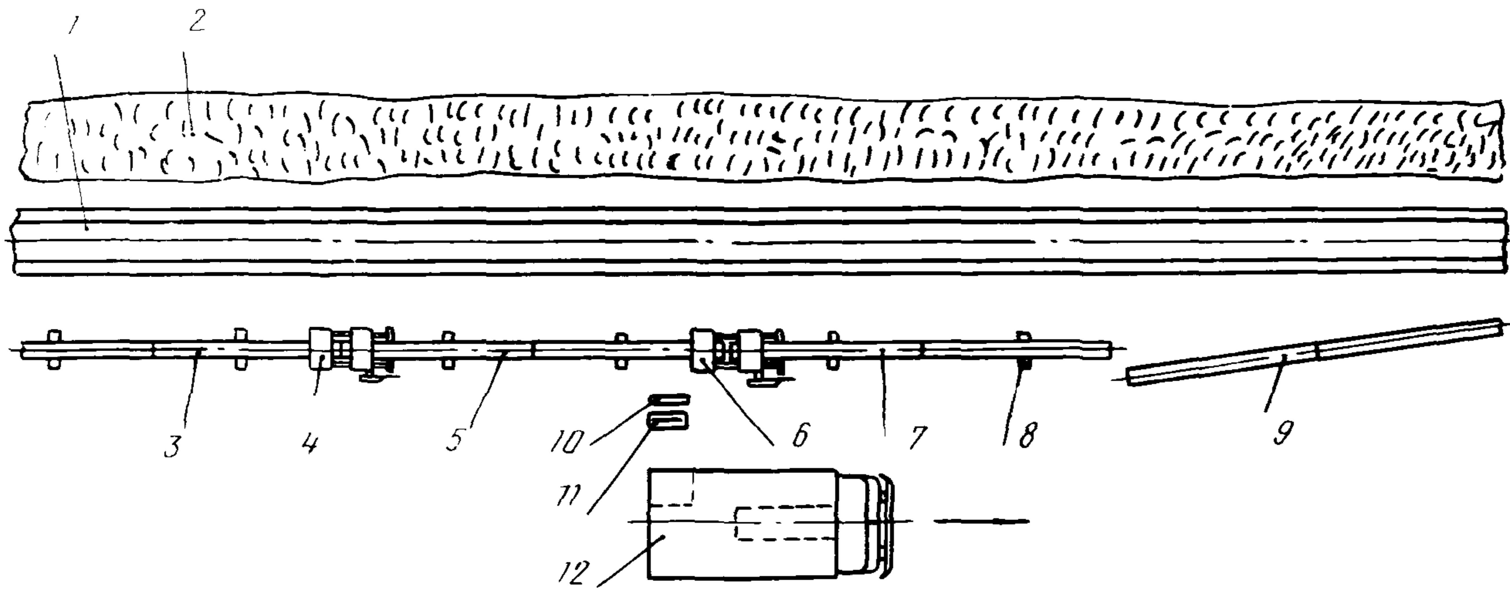
Рис. I3. Схема организации сварочного поста при сварке трубопровода в непрерывную нитку с двумя центраторами:
