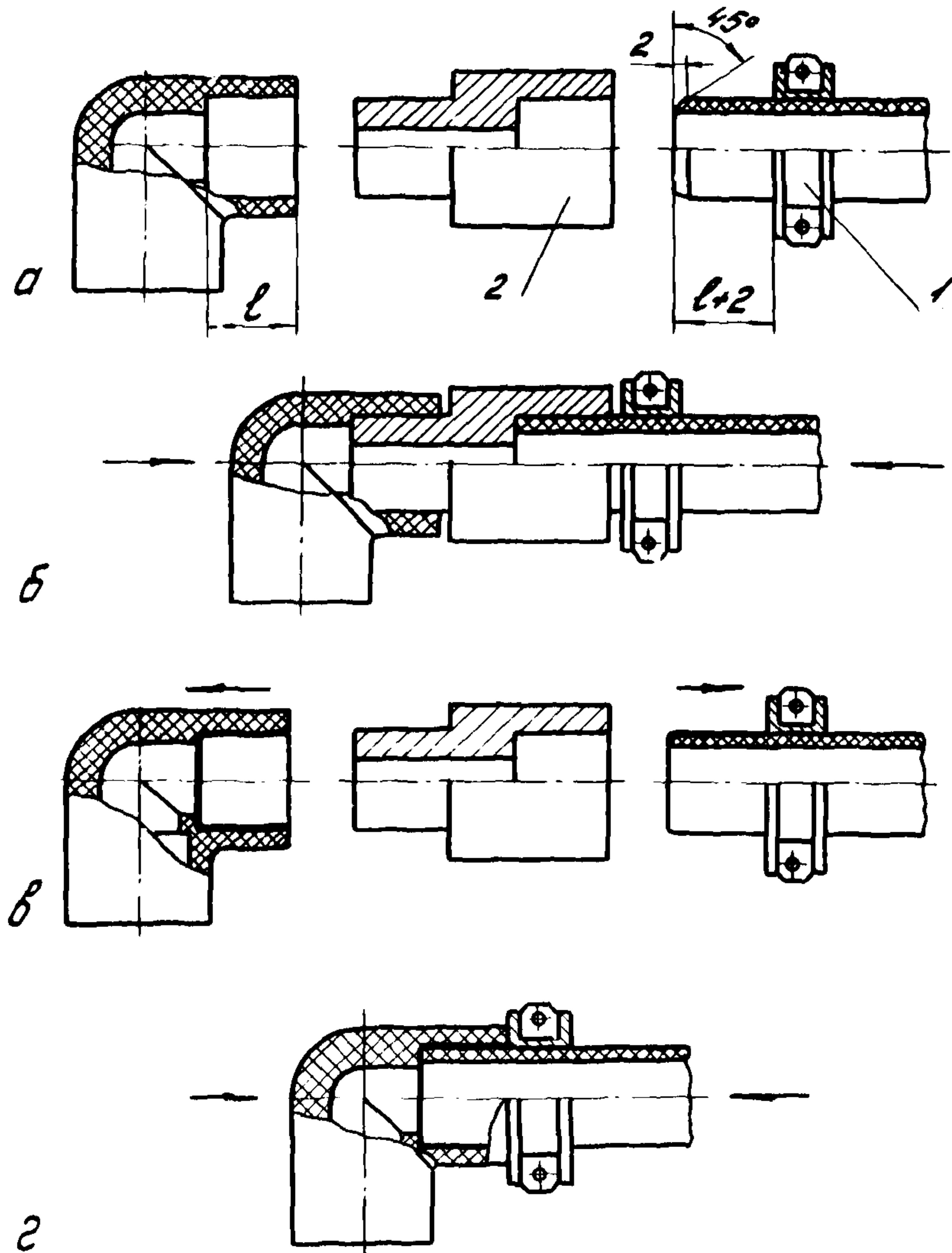
Рис.9. Последовательность процесса контактной сварки враструб
