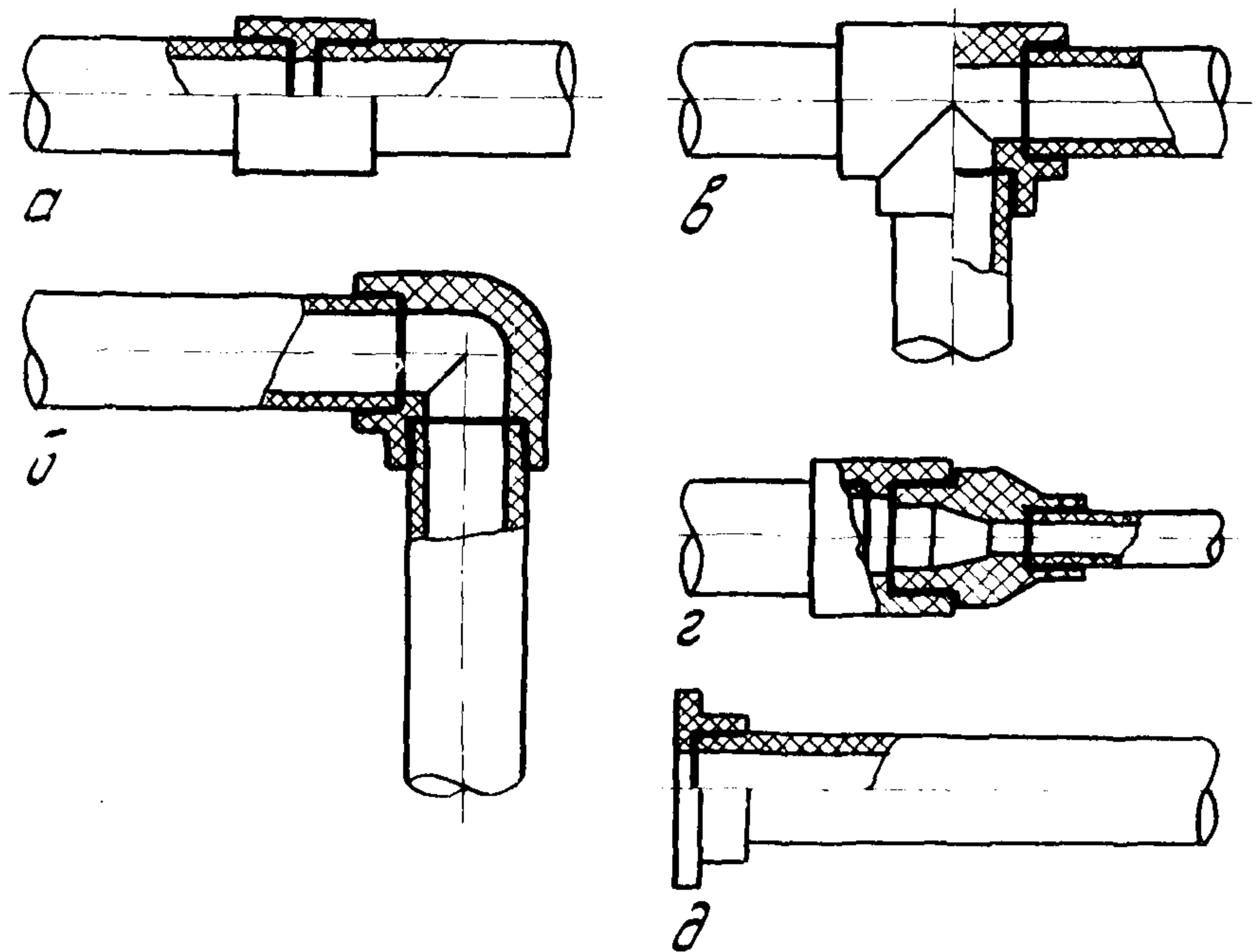
Рис.6. Сварные раструбно-стыковые соединения труб и соединительных деталей из ПВД:
