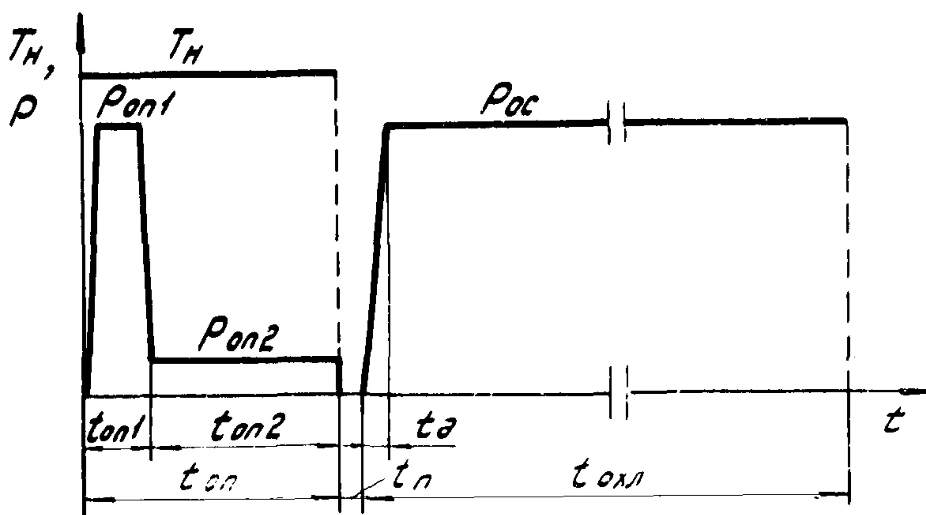
Рис. 8. Циклограмма процесса контактной сварки встык
