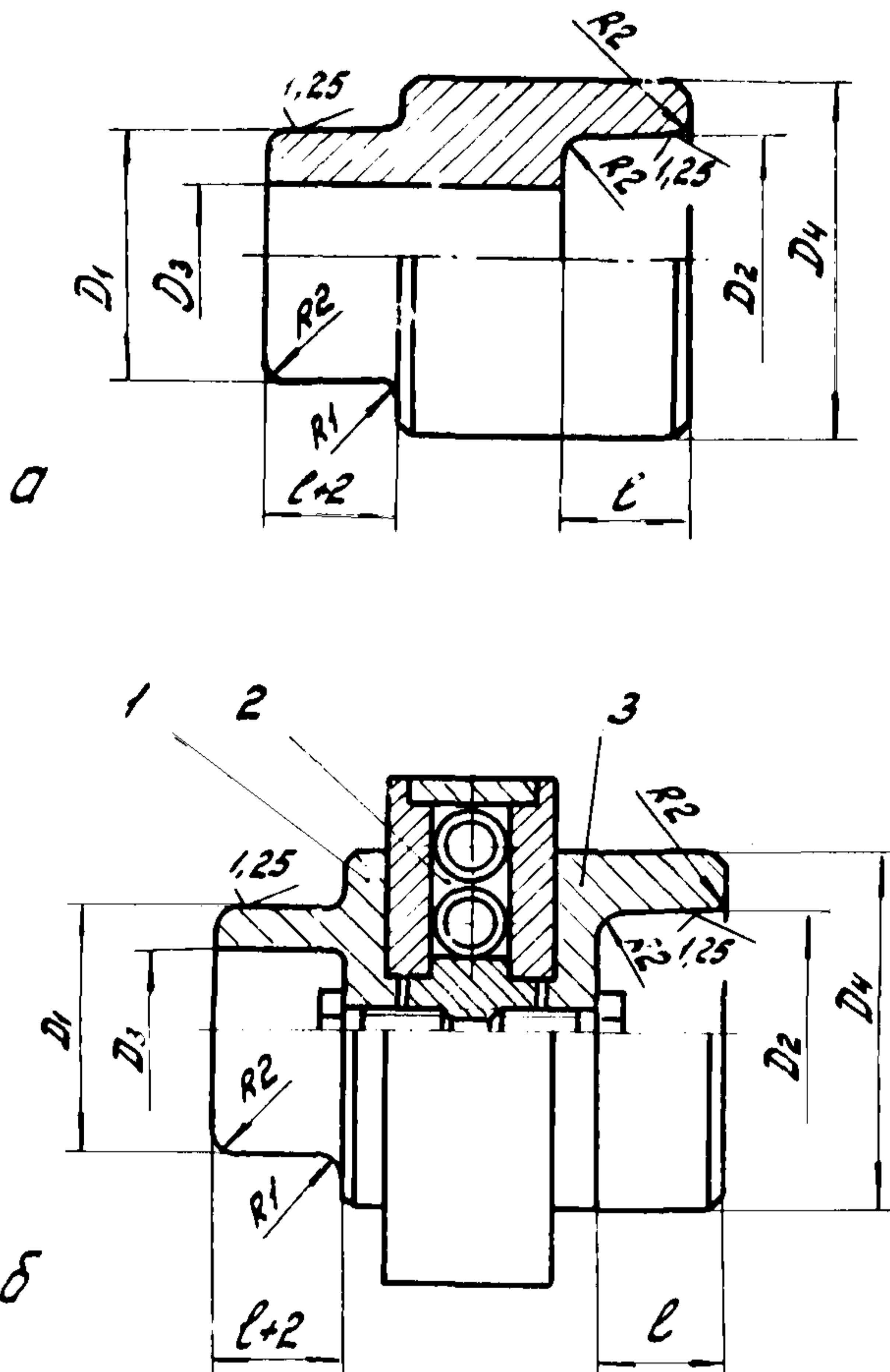
Рис.10. Схема нагревательного инструмента для раструбно-стыковой сварки:
