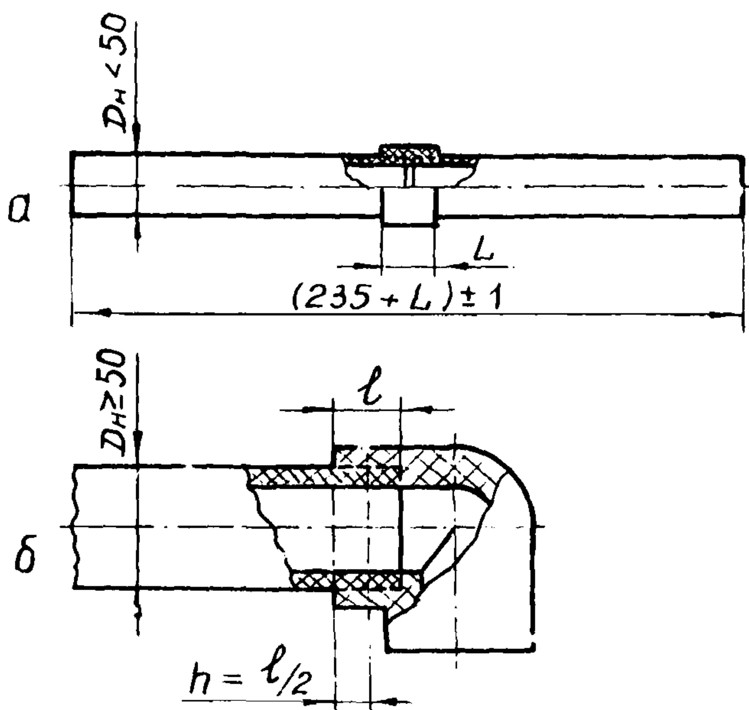
Рис.2. Образцы для испытаний сварных раструбных соединений:
