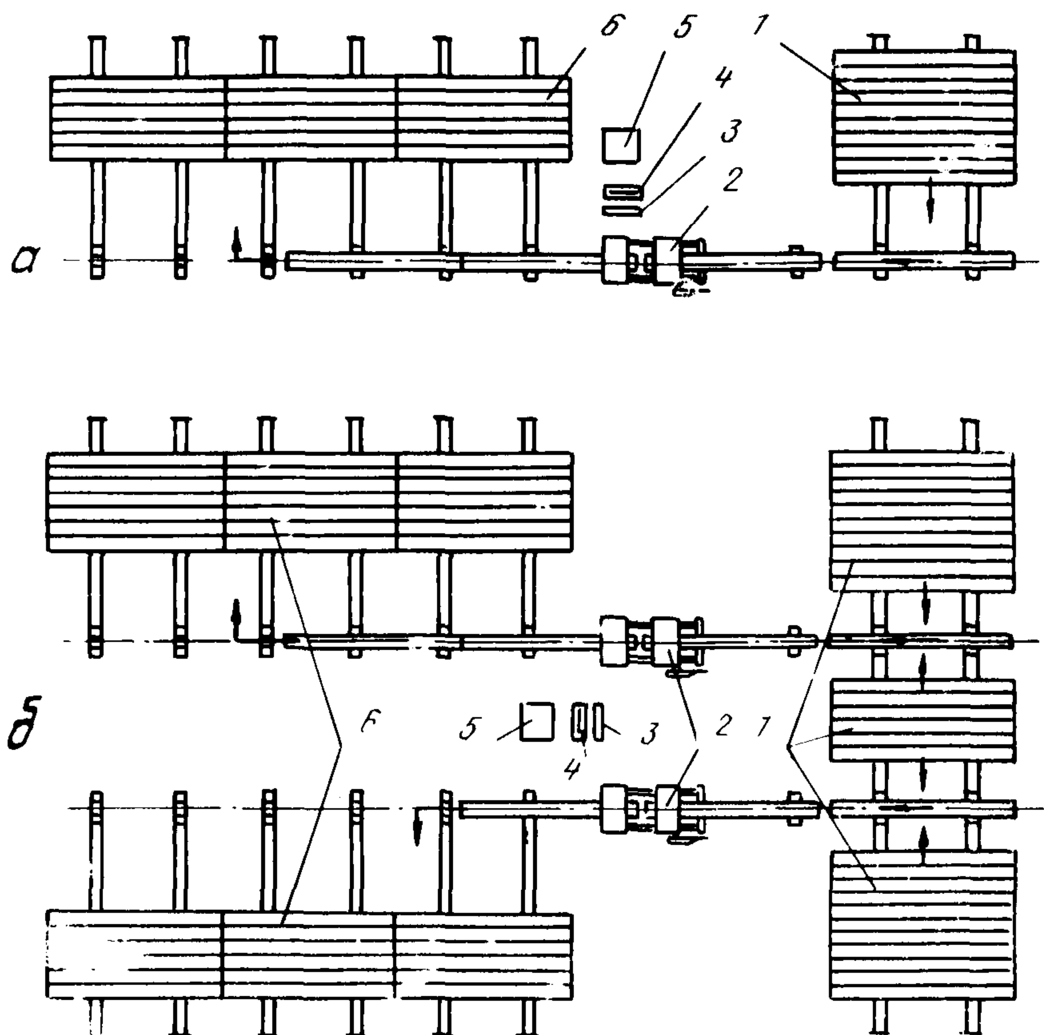
Рис.12. Схема организации сварочных постов при сварке трубных секций в стационарных условиях:
