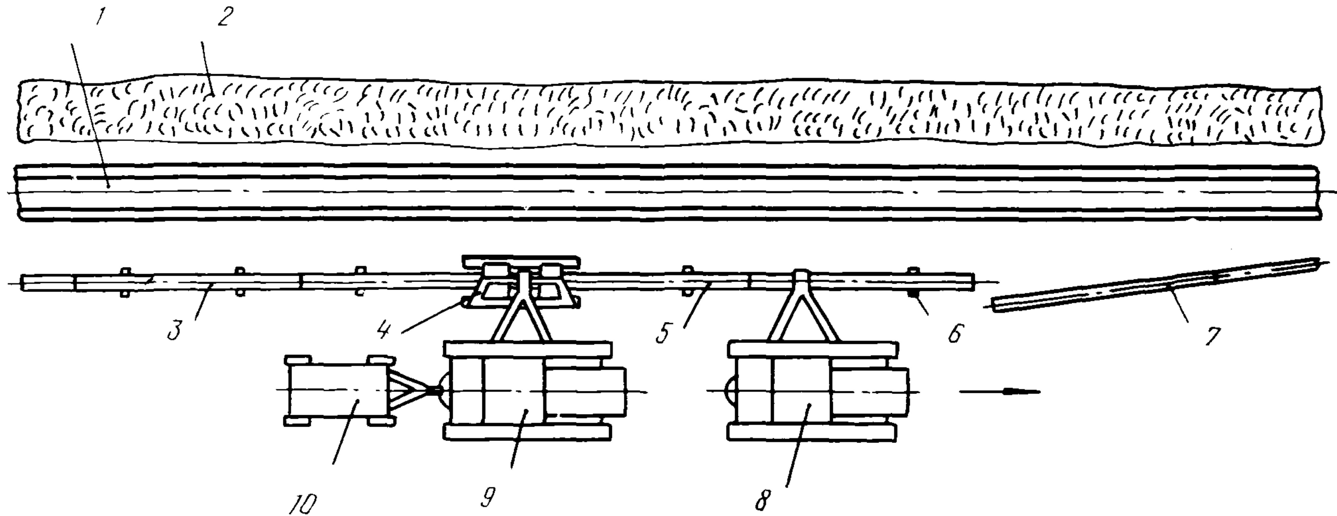
Рис. I4. Схема сварки трубопровода в непрерывную ленту с использованием одного центратора и грузоподъемной техники:
