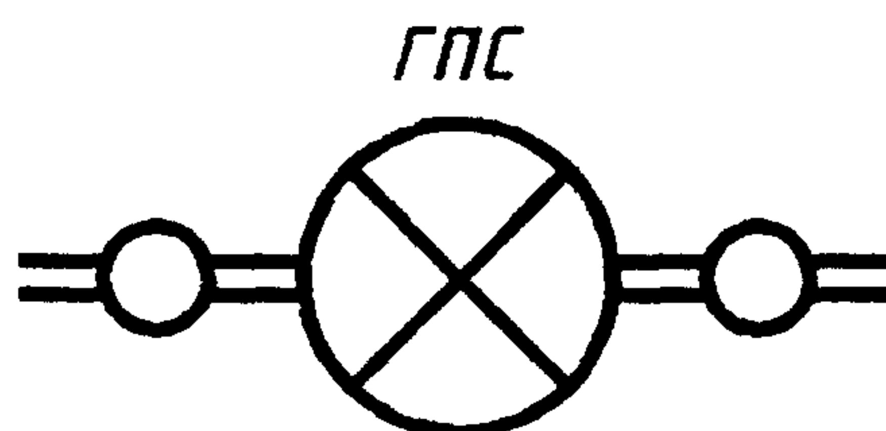
— газопровод с газокомпрессорной станцией
