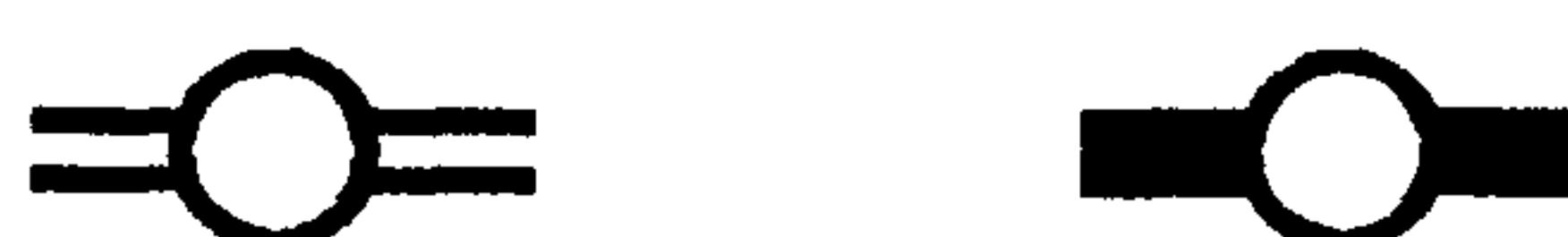
— газопровод подземный (наземный — сплошная линия)
