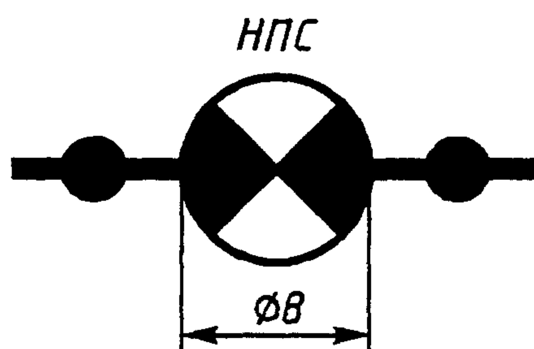
— нефтепровод с перекачивающей станцией
