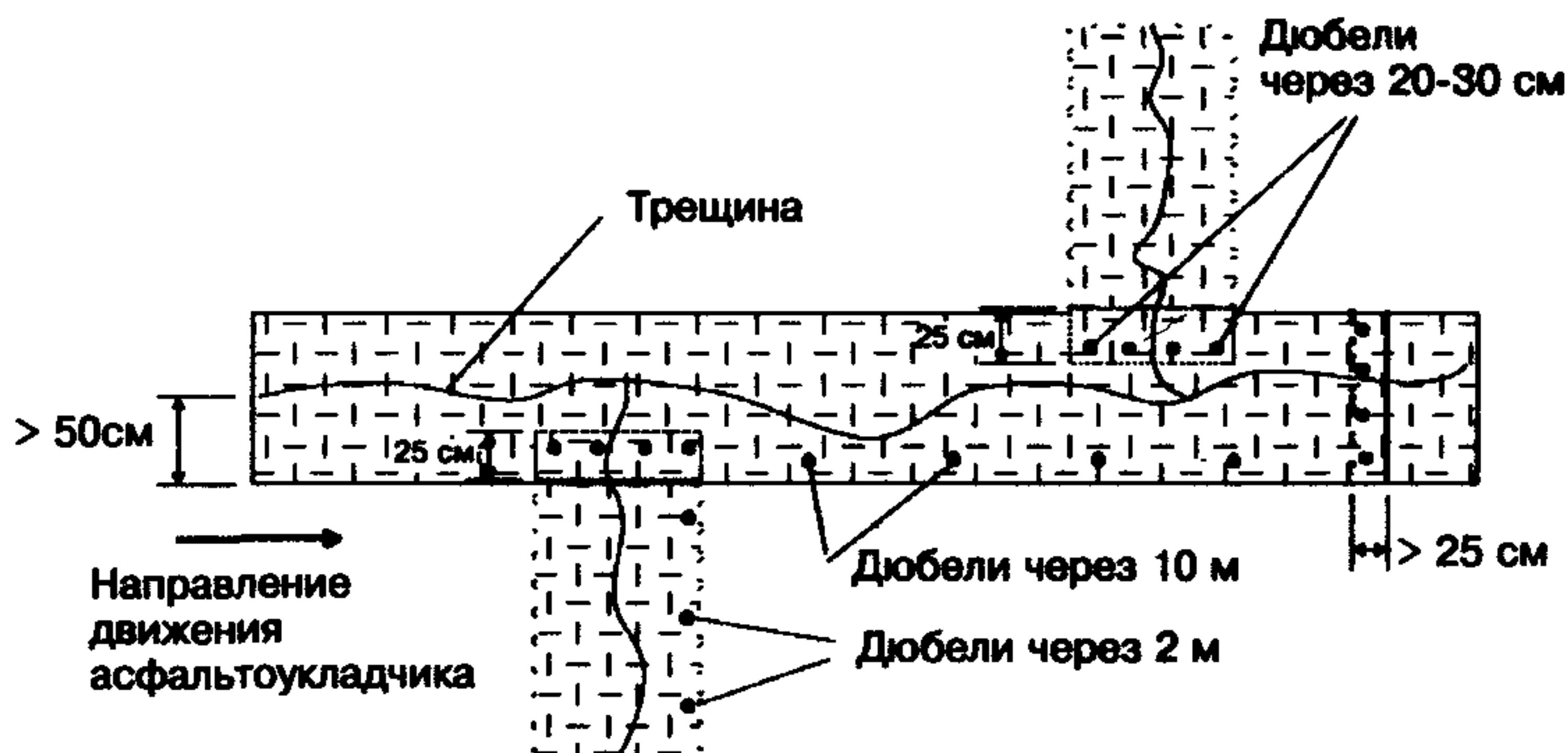
Рис. 2. Схема расположения полотен базальтовых сеток при локальном армировании
