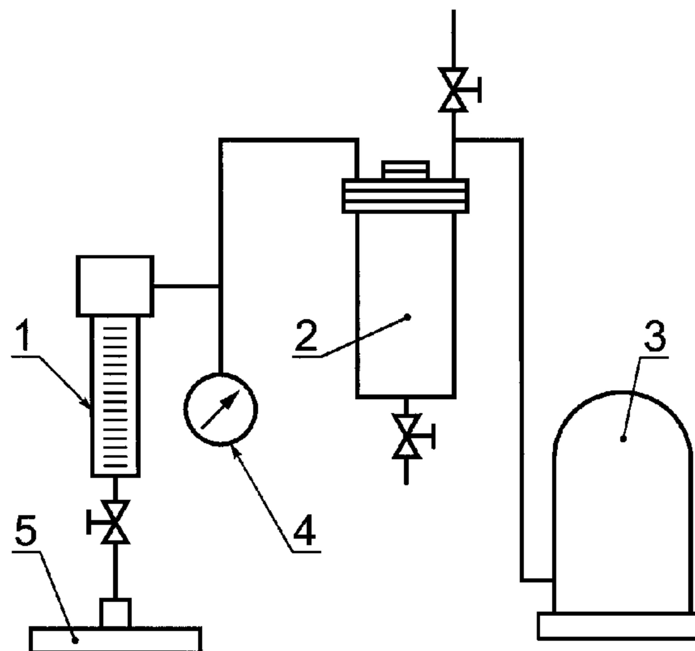
1 — фильтрационная колонка, выполненная из органического стекла, с фильтрационной перегородкой поверхностью 1 см<sup>2</sup>. Фильтрационная перегородка выполнена из нержавеющего штампованныго сита с размером ячейки 100 мкм; 2 — напорный сосуд, выполненный из органического стекла; 3 — компрессор, предназначенный для создания необходимого постоянного давления в фильтрационной колонке; 4 — образцовый манометр для измерения давления в системе; 5 — подвижный столик с мерными цилиндрами
