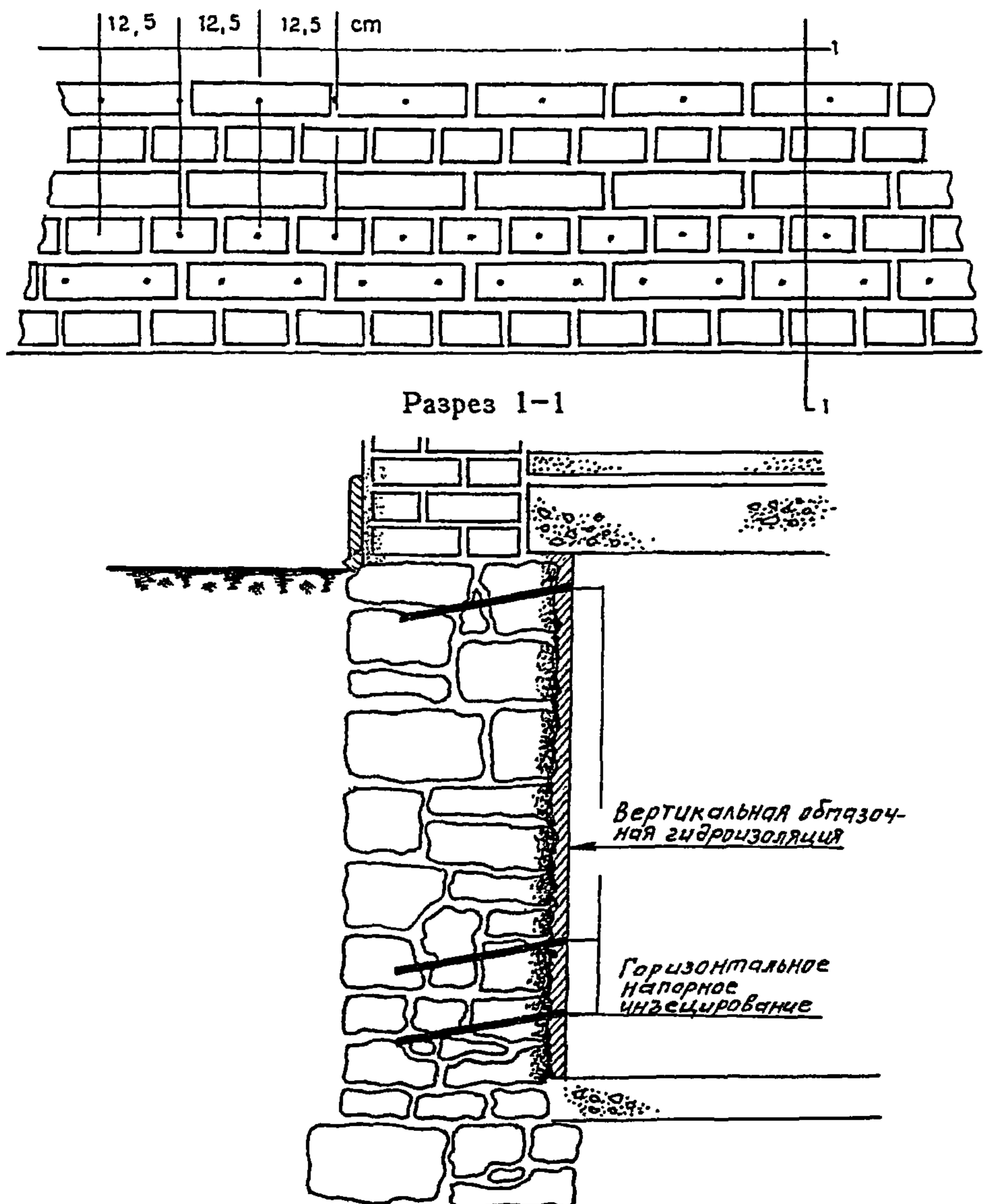
Рис.3.3. Схема гидроизоляции подвала на объекте
