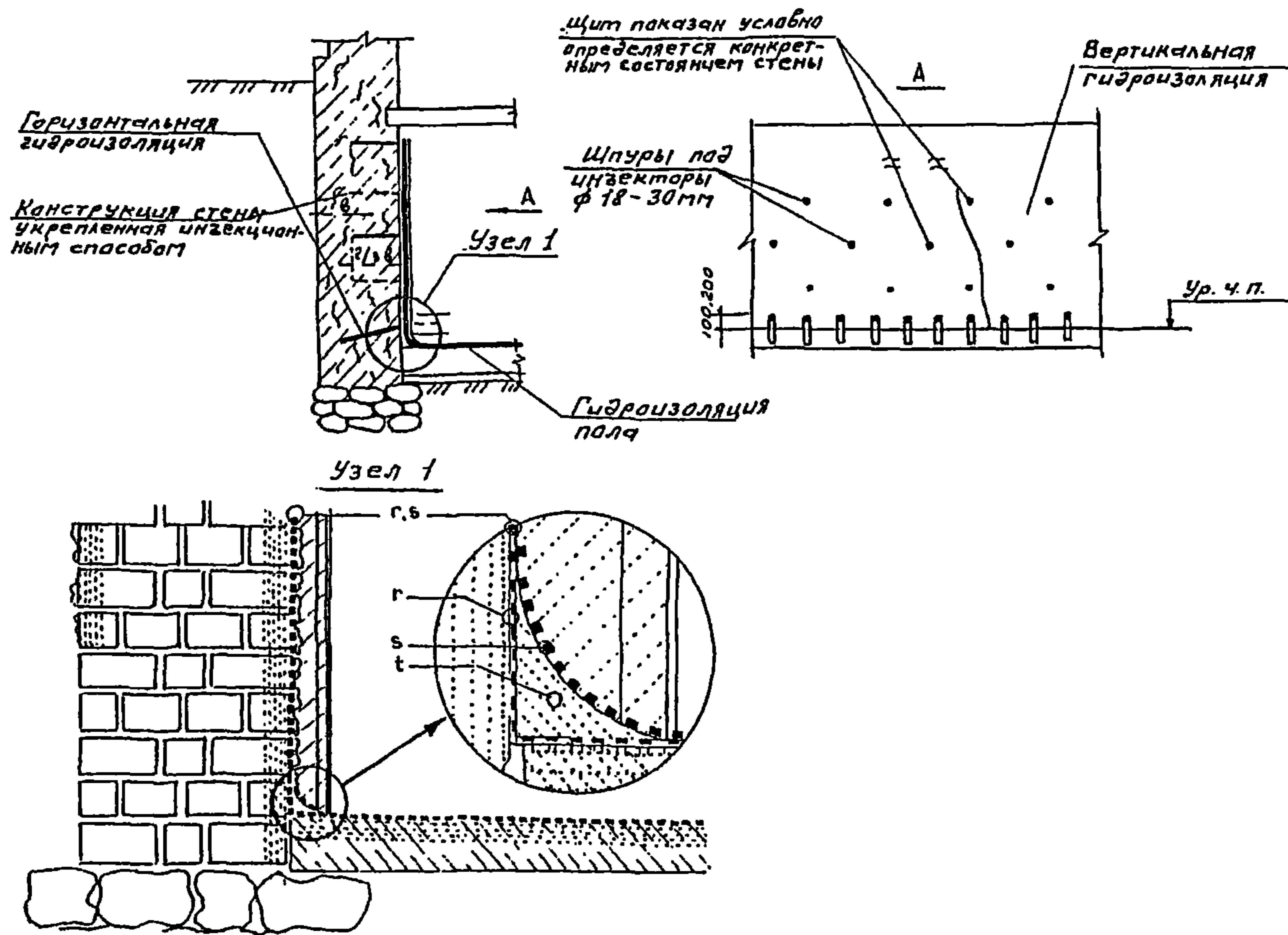
Рис. 3.7. Устройство инъекционной и покровной гидроизоляции
