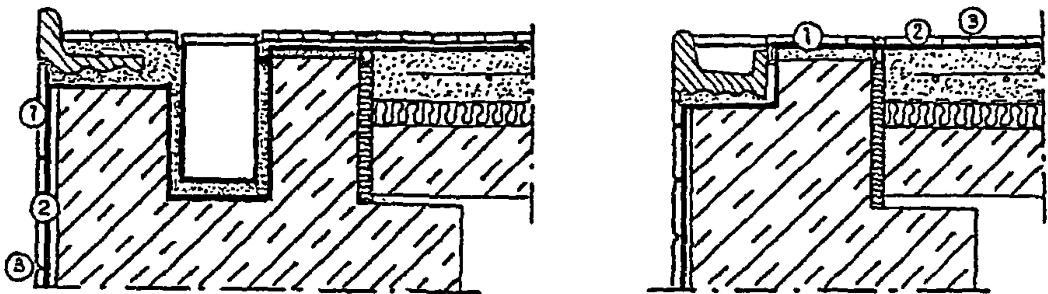
Рис.4.5. Гидроизоляция плавательных бассейнов:
