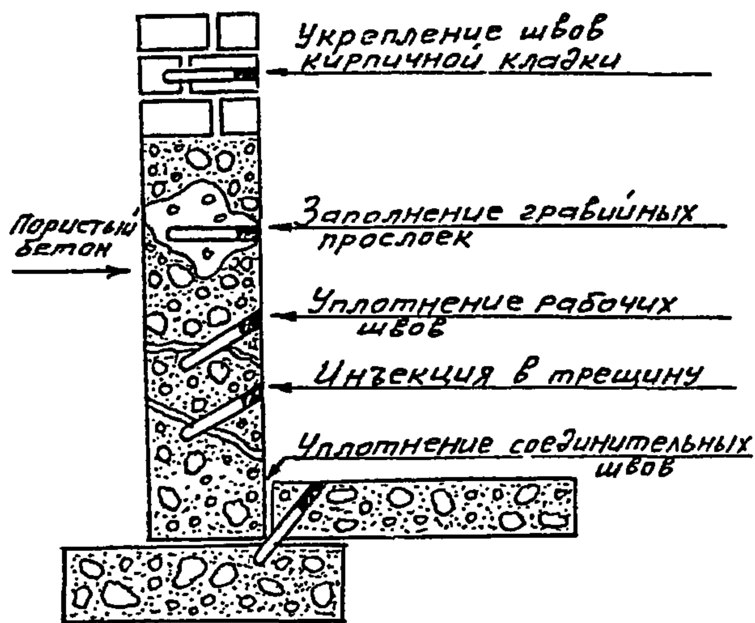
Рис.3.5. Схема уплотнения отдельных негерметичных мест инъекции
