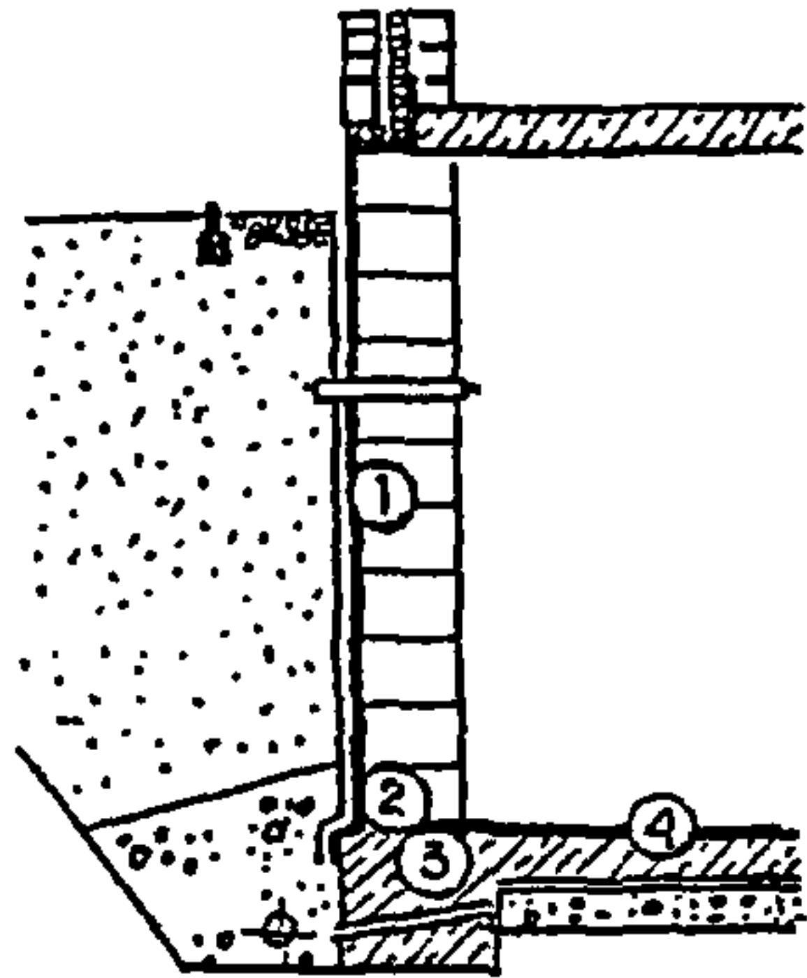
Рис.4.1 Гидроизоляция подвалов и фундаментов в новостройках:
