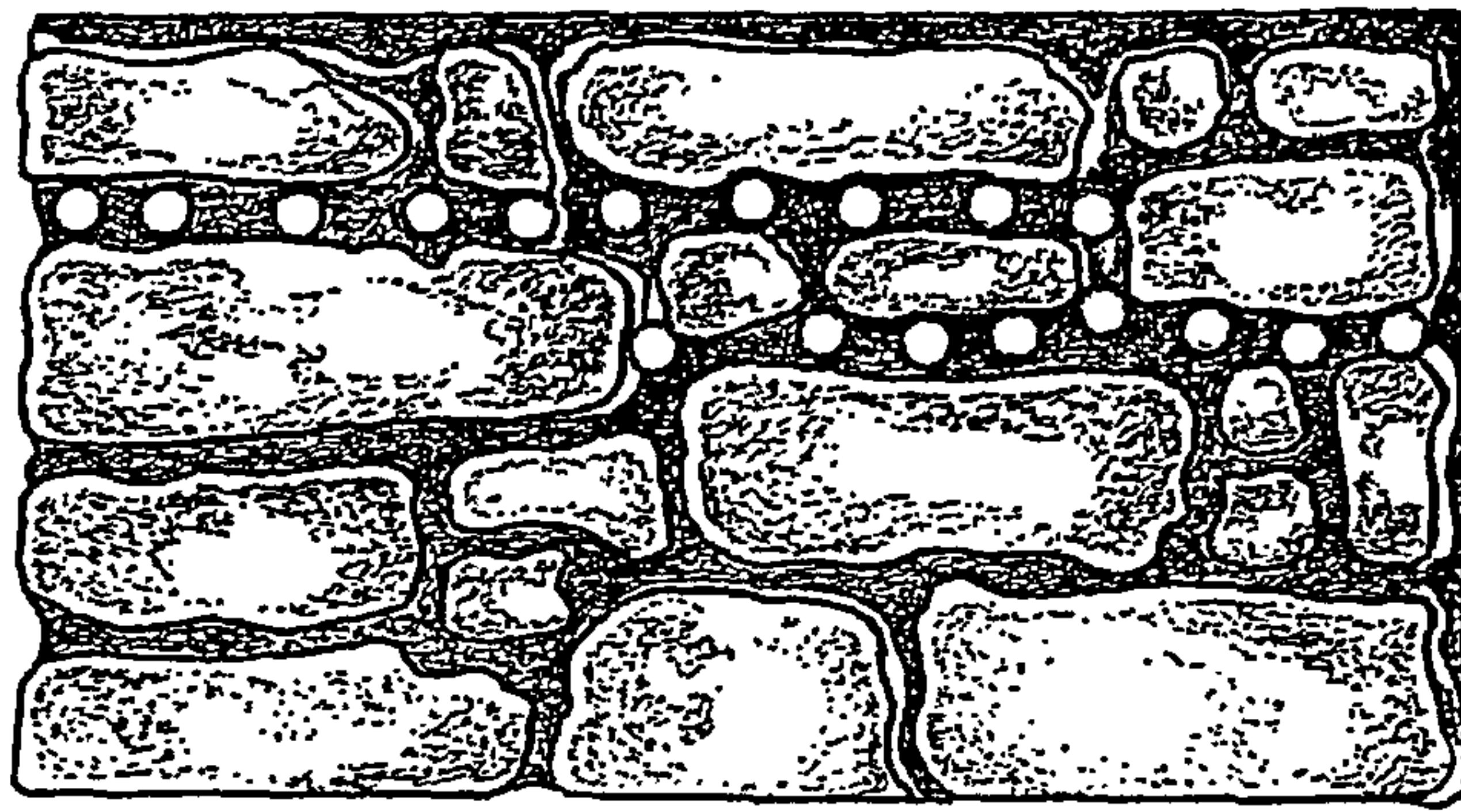
Рис. 3.1. Сверление отверстий в каменных конструкциях
