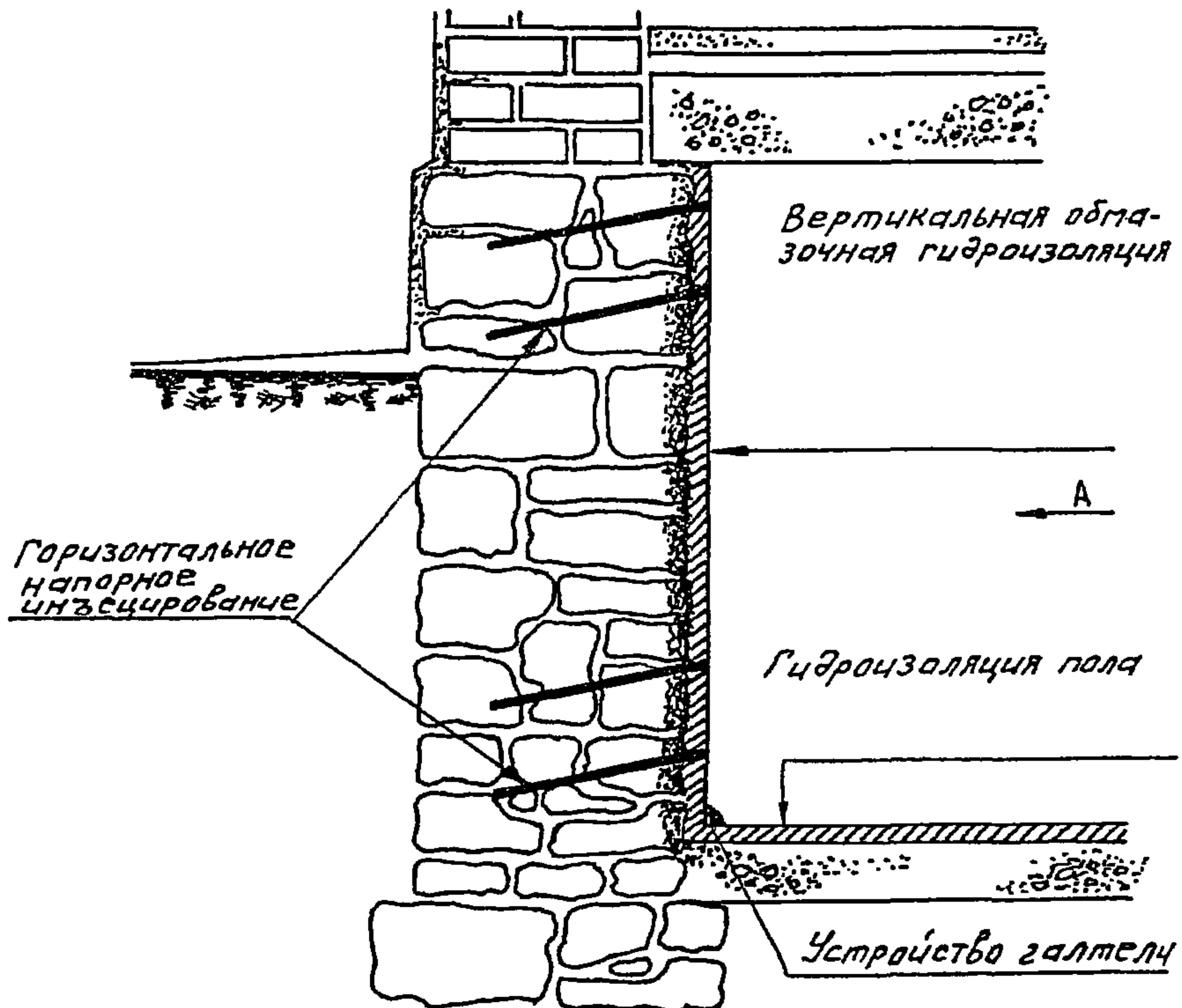
Рис.3.4. Схема гидроизоляции подвала
