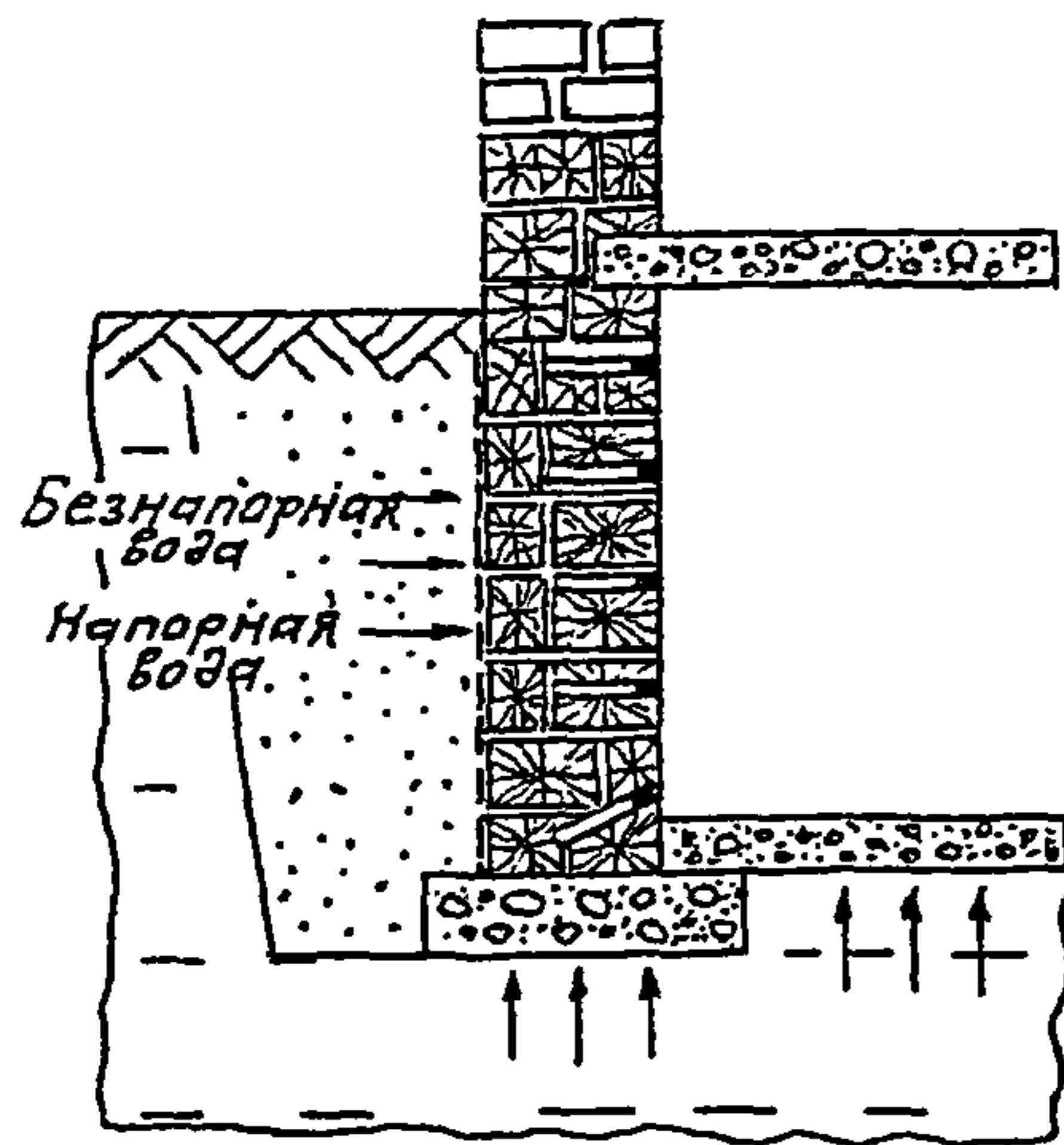
Рис.3.8. Схема укрепления стен
