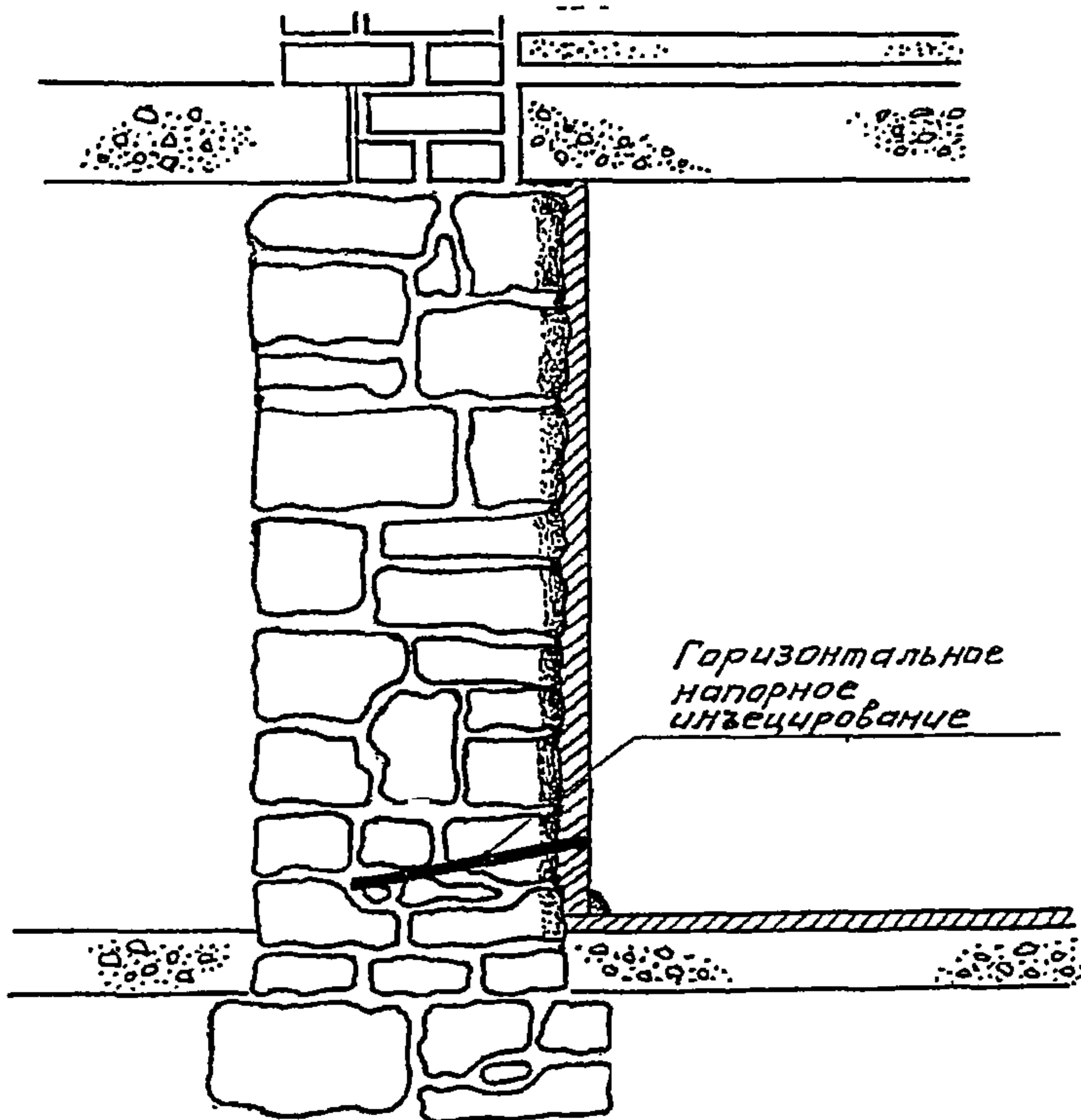
Рис.3.2. Схема гидроизоляции подвала
