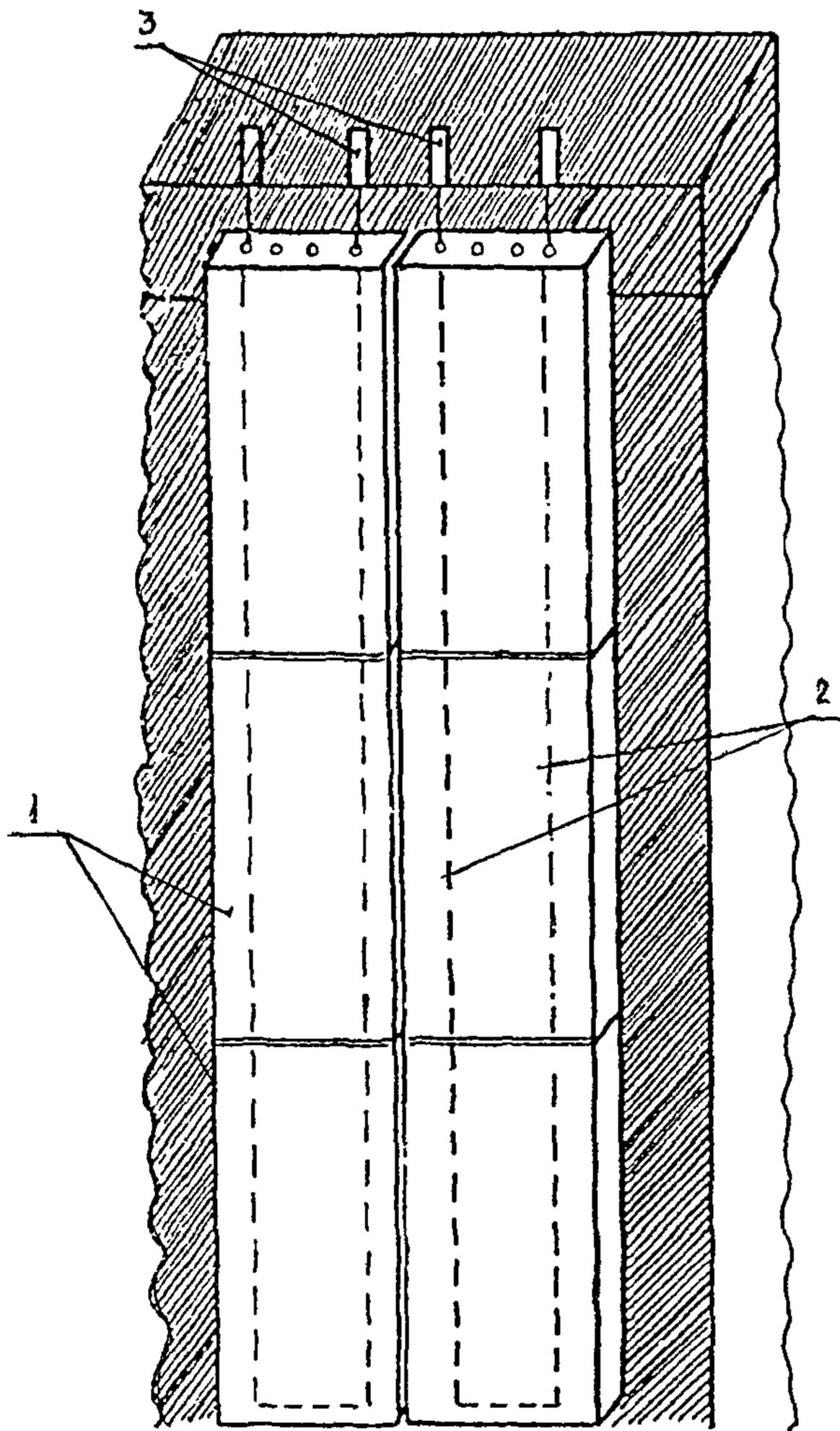
Рис.8. Схема монтажа плит с помощью стального троса:
