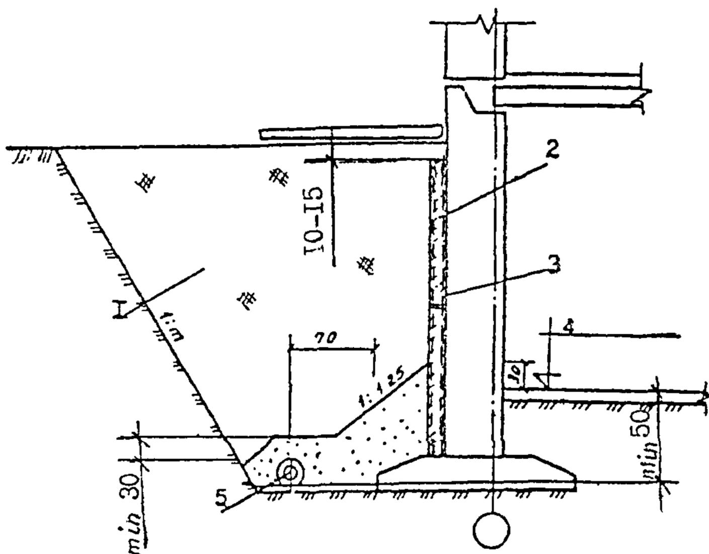
Рис.2. Схема пристенного дренажа здания с сопутствующим дренажом:
