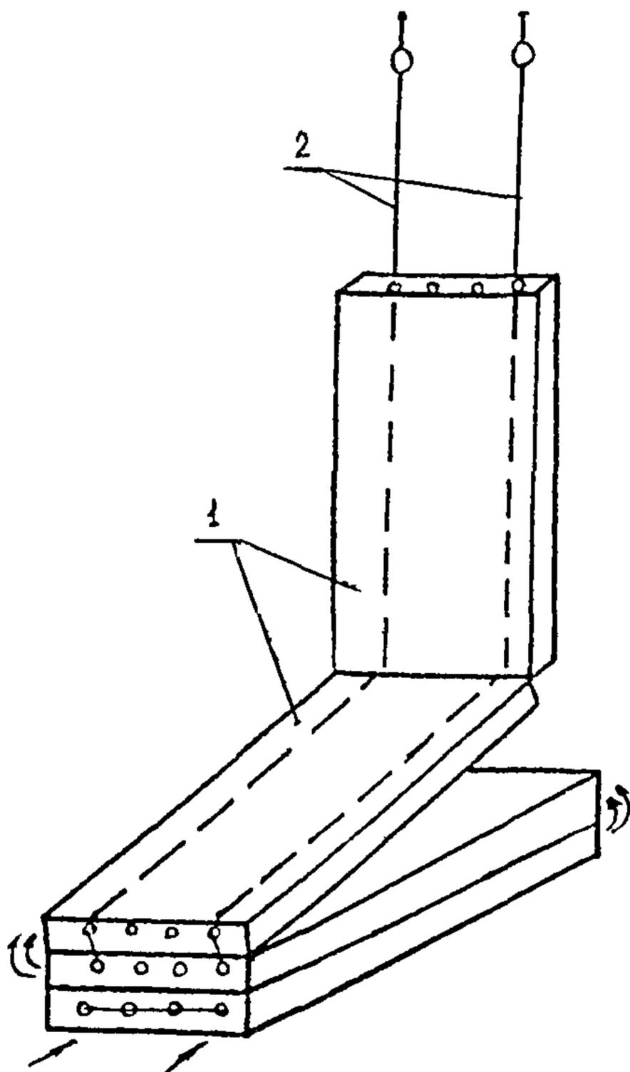
Рис.7. Схема подъема плит, сложенных в штабель:
