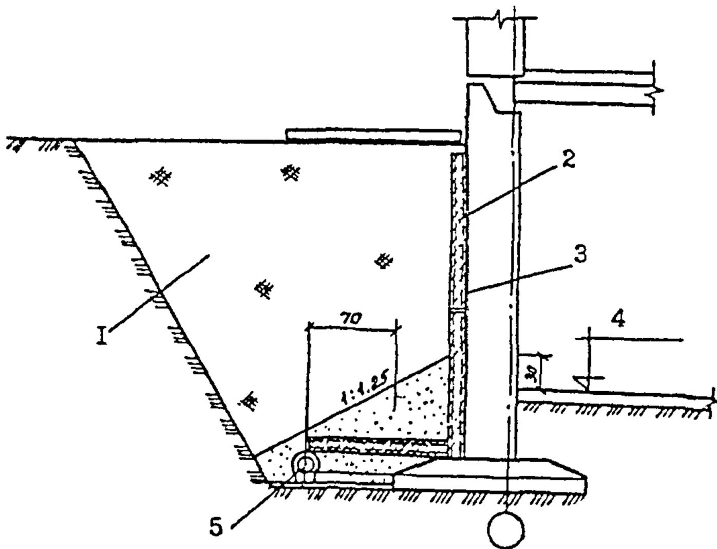
Рис.4. Схема пристенного дренажа здания с сопутствующим кольцевым дренажом:
