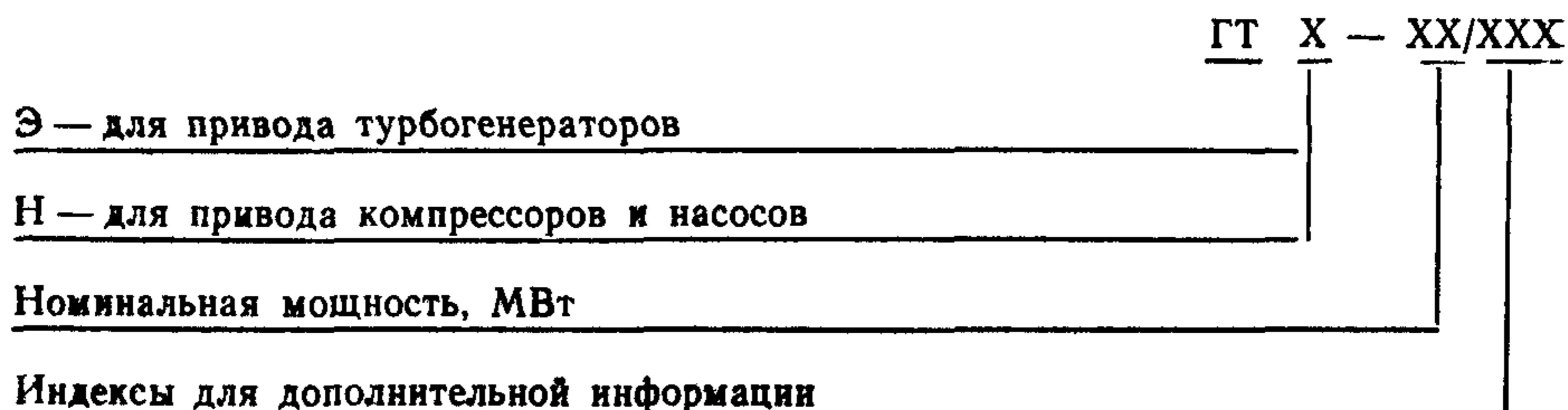
Примечание. Индексы для дополнительной информации изготовитель может использовать для обеспечения модификации газотурбинной установки.
