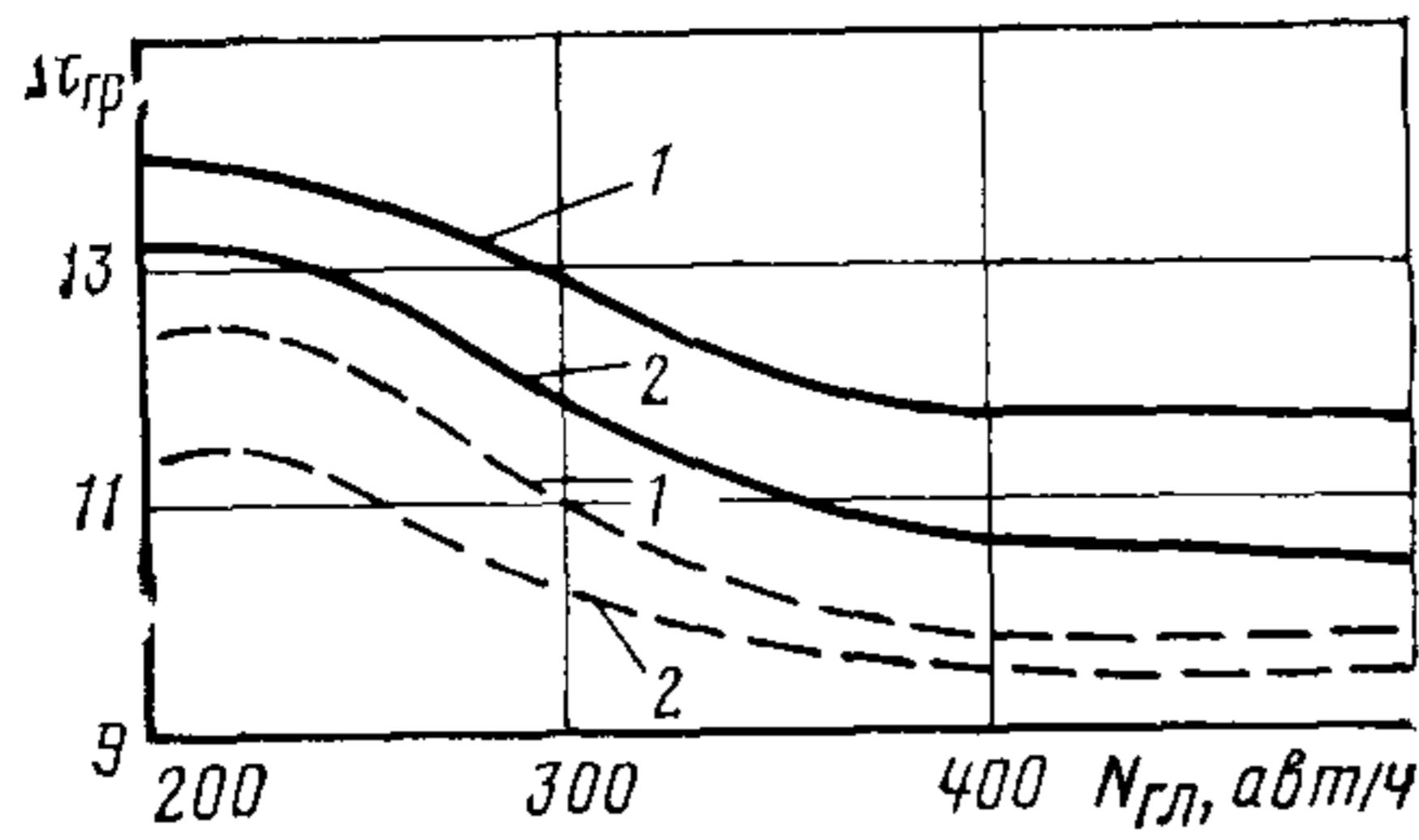
Рис. 3.2. Изменение граничного промежутка времени для левого поворота в зависимости от интенсивности движения по главной дороге:
