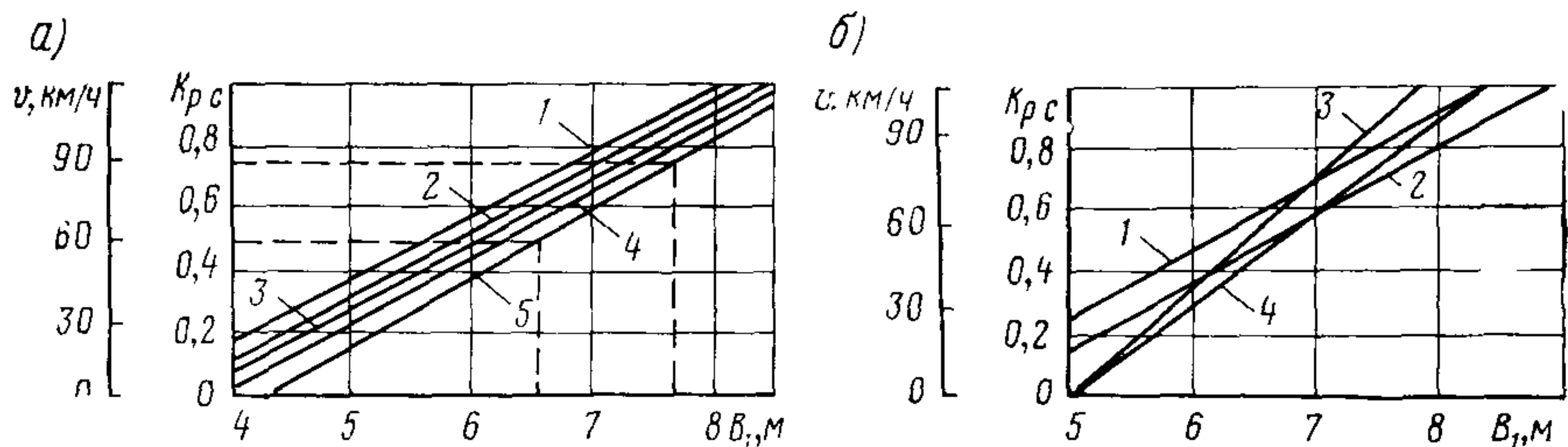
Рис. 2.6. Влияние ширины укрепления на скорость:
