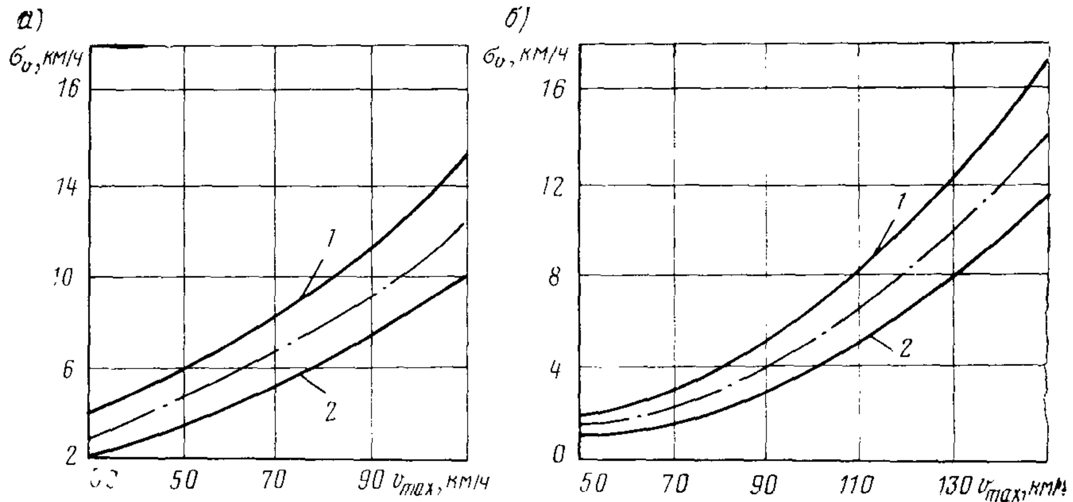
Рис. 2.2. Зависимость среднеквадратичного отклонения от максимальной скорости:
