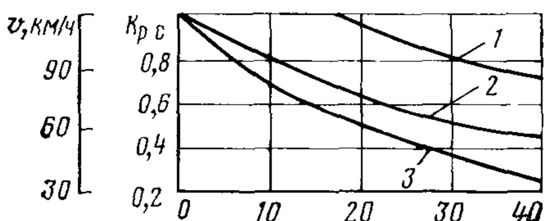
Рис. 2.10. Влияние скорости ветра на обеспеченность расчетной скорости:
