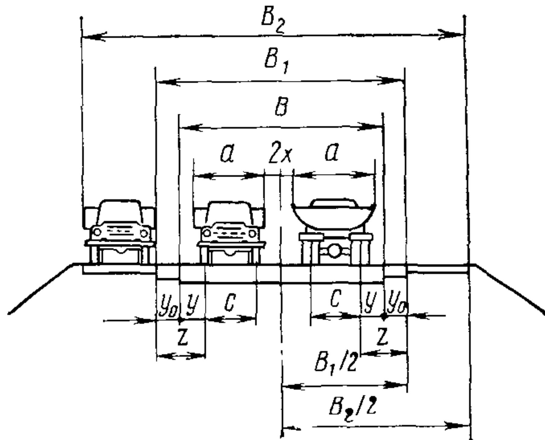
Рис. 2.5. Схема для расчета ширины укрепления
