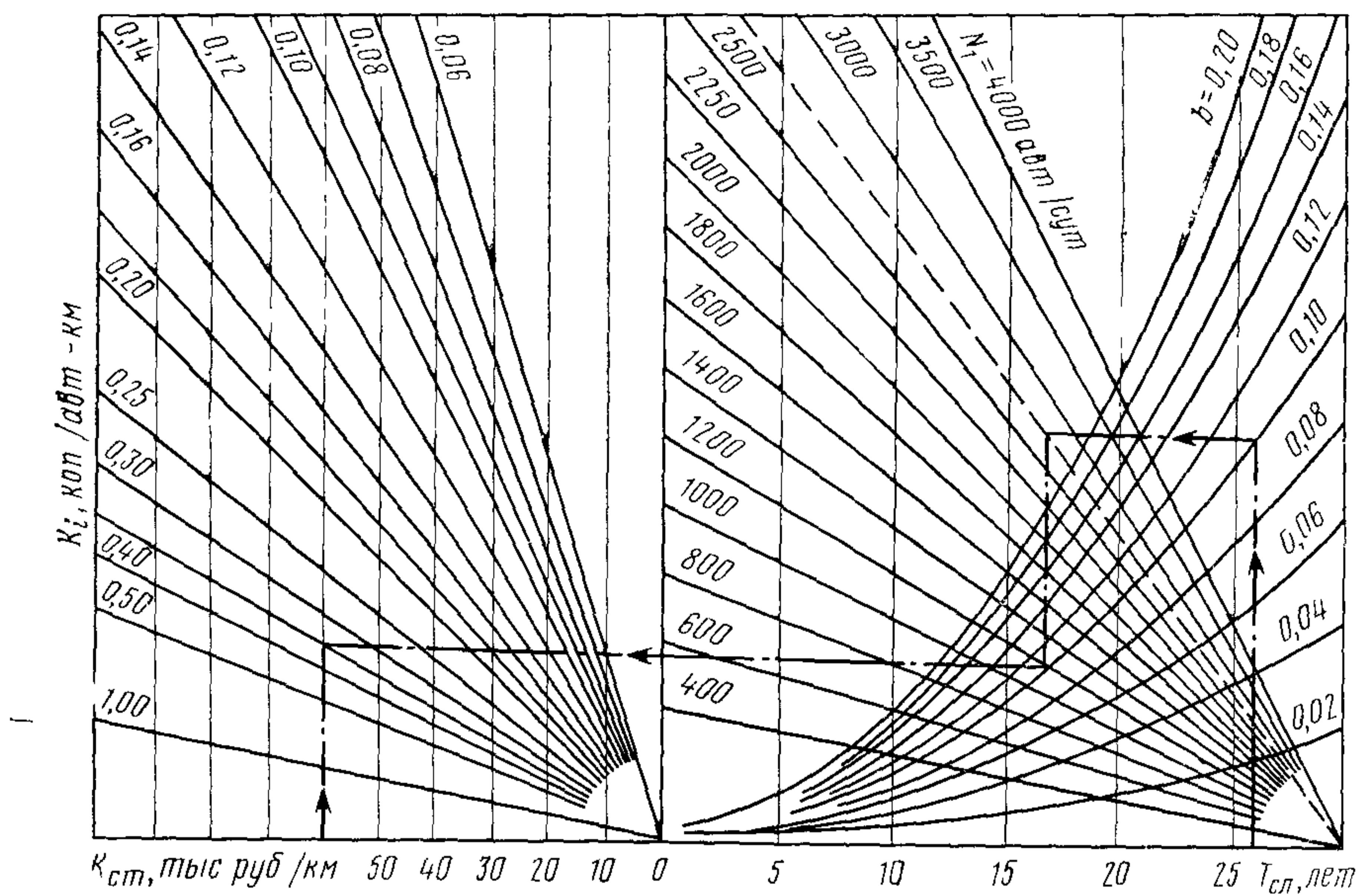
Рис. 2. Номограмма для определения удельных капиталовложений при ежегодном линейном приросте интенсивности движения ( $K_{ст}$  — приведенная за  $T_{сл(1)}$  стоимость строительства одной полосы проезжей части, тыс. руб./км)
