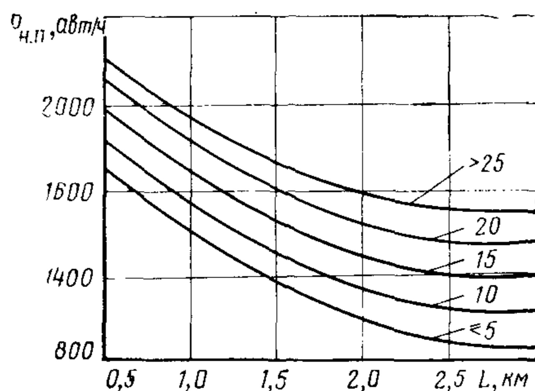
Рис. 5.1. Зависимость пропускной способности дороги от длины населенного пункта и расстояния края проезжей части до линии застройки:
