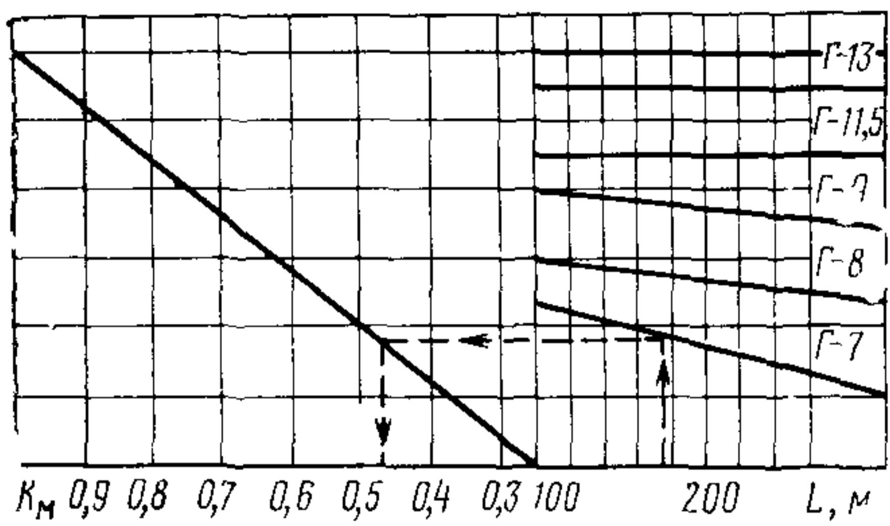
Рис. 5.2. Номограмма для определения коэффициентов снижения пропускной способности полосы движения на больших автодорожных мостах
