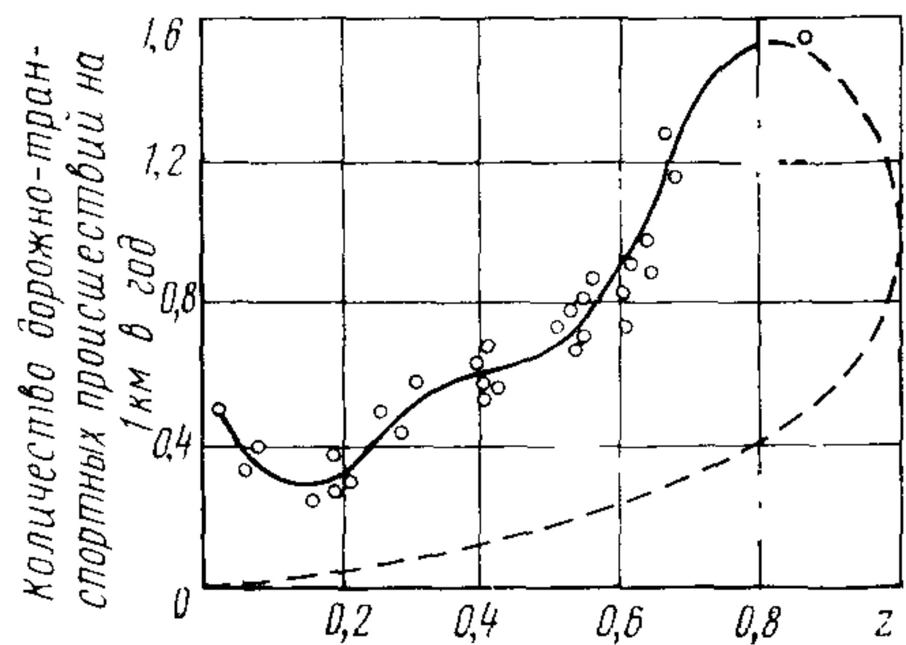
Рис. 1.7. Изменение аварийности с ростом загрузки дороги
