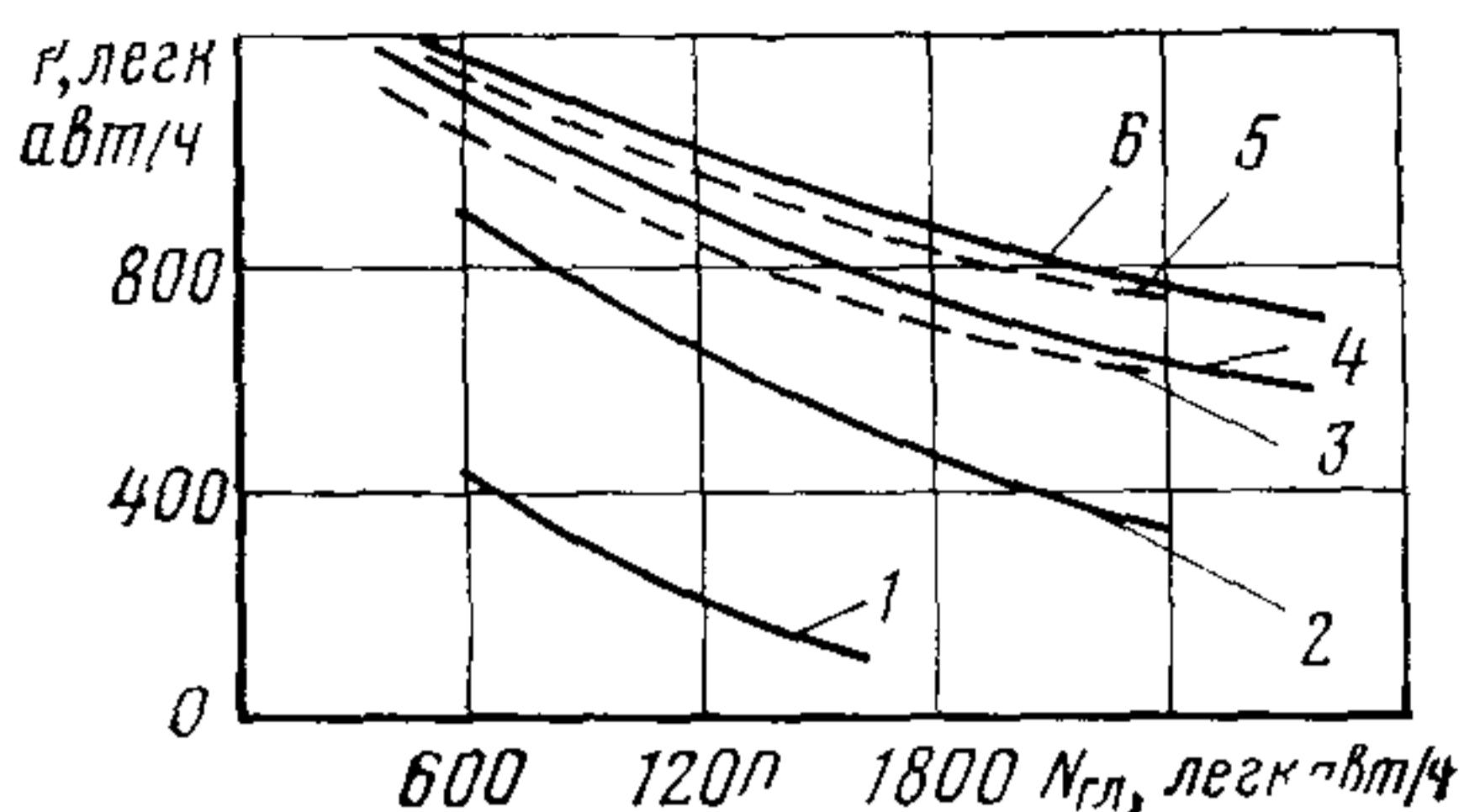
Рис. 3.10. Зависимость пропускной способности каждого направления движения от интенсивности на главной дороге:
