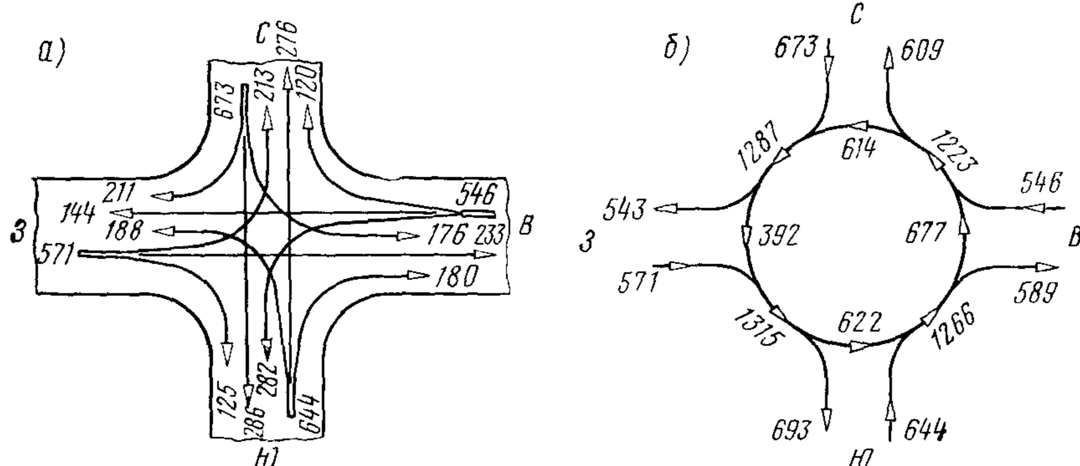
Рис. 3.9. Картограмма интенсивности движения:
