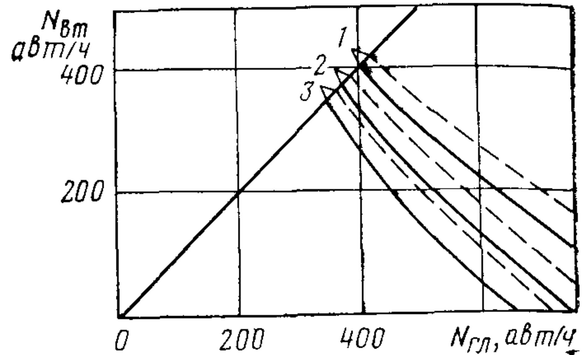
Рис. 3.7. Номограмма для определения пропускной способности нерегулируемых пересечений в одном уровне:
