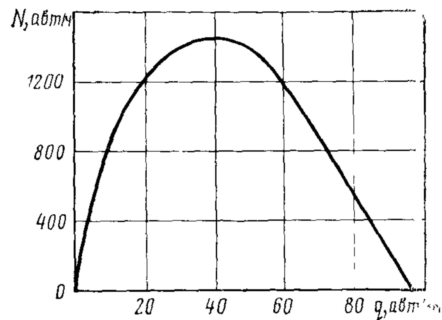
Рис. 1.4. Пример зависимости интенсивность — плотность
