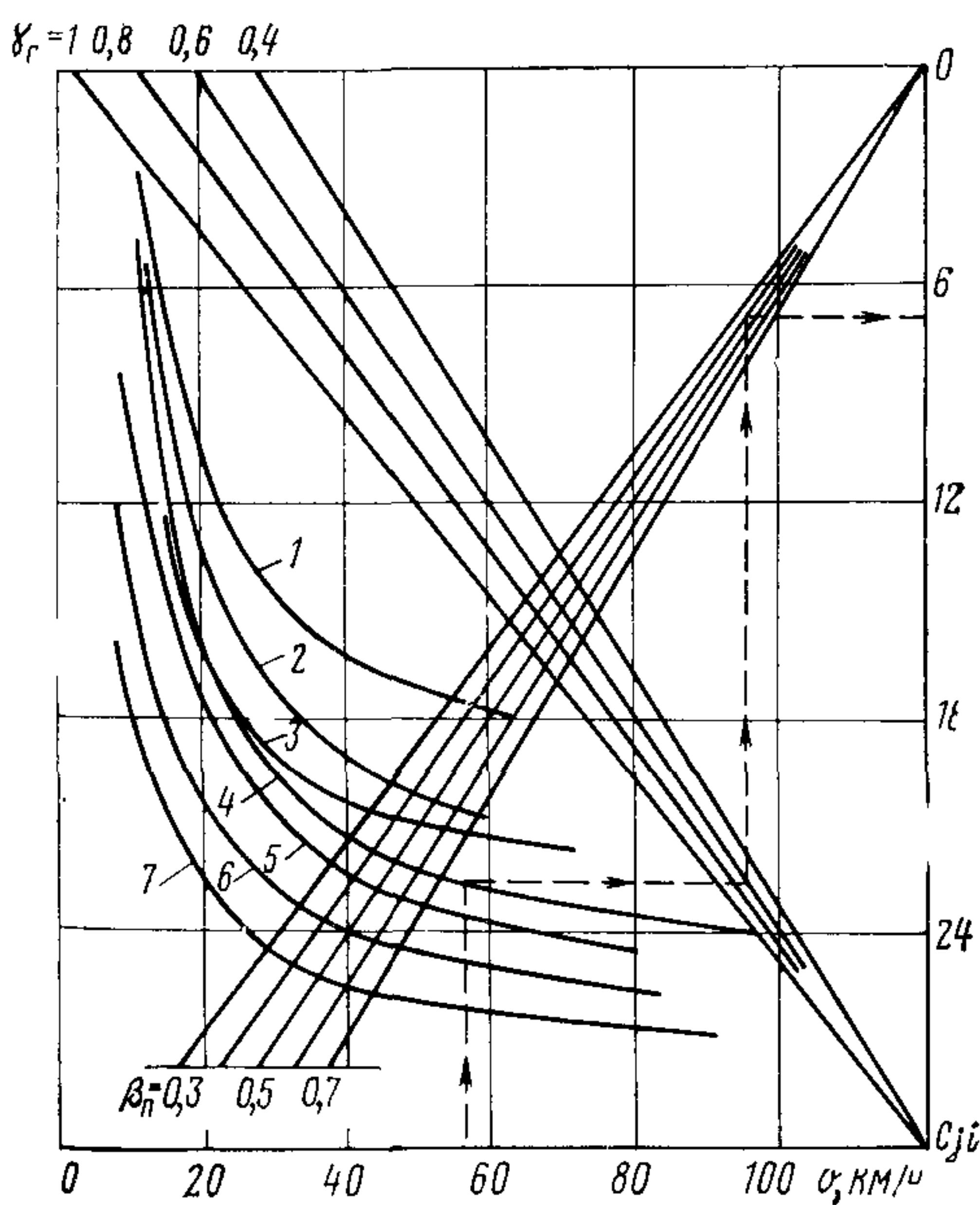
Рис. 5. Номограмма для определения себестоимости 1 авт-км транспортной работы:
