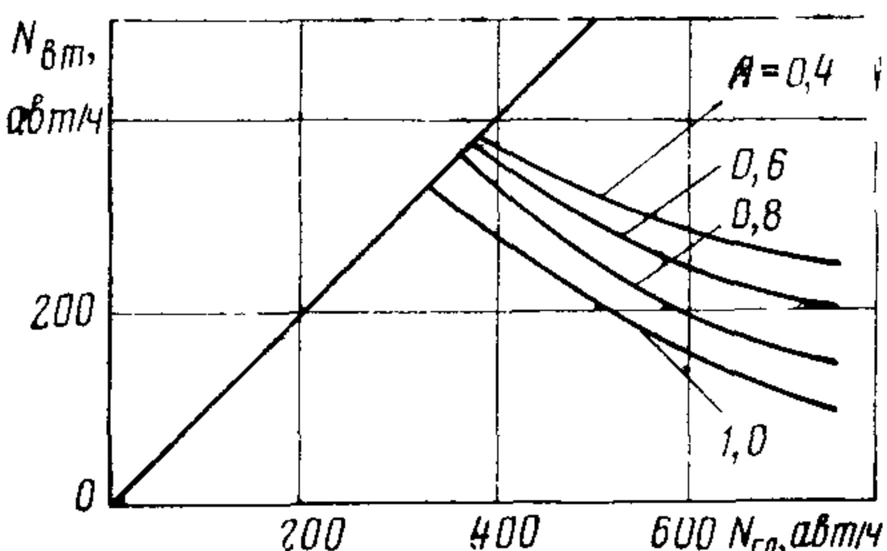
Рис. 3.8. Номограмма для определения практической пропускной способности пересечений в одном уровне
