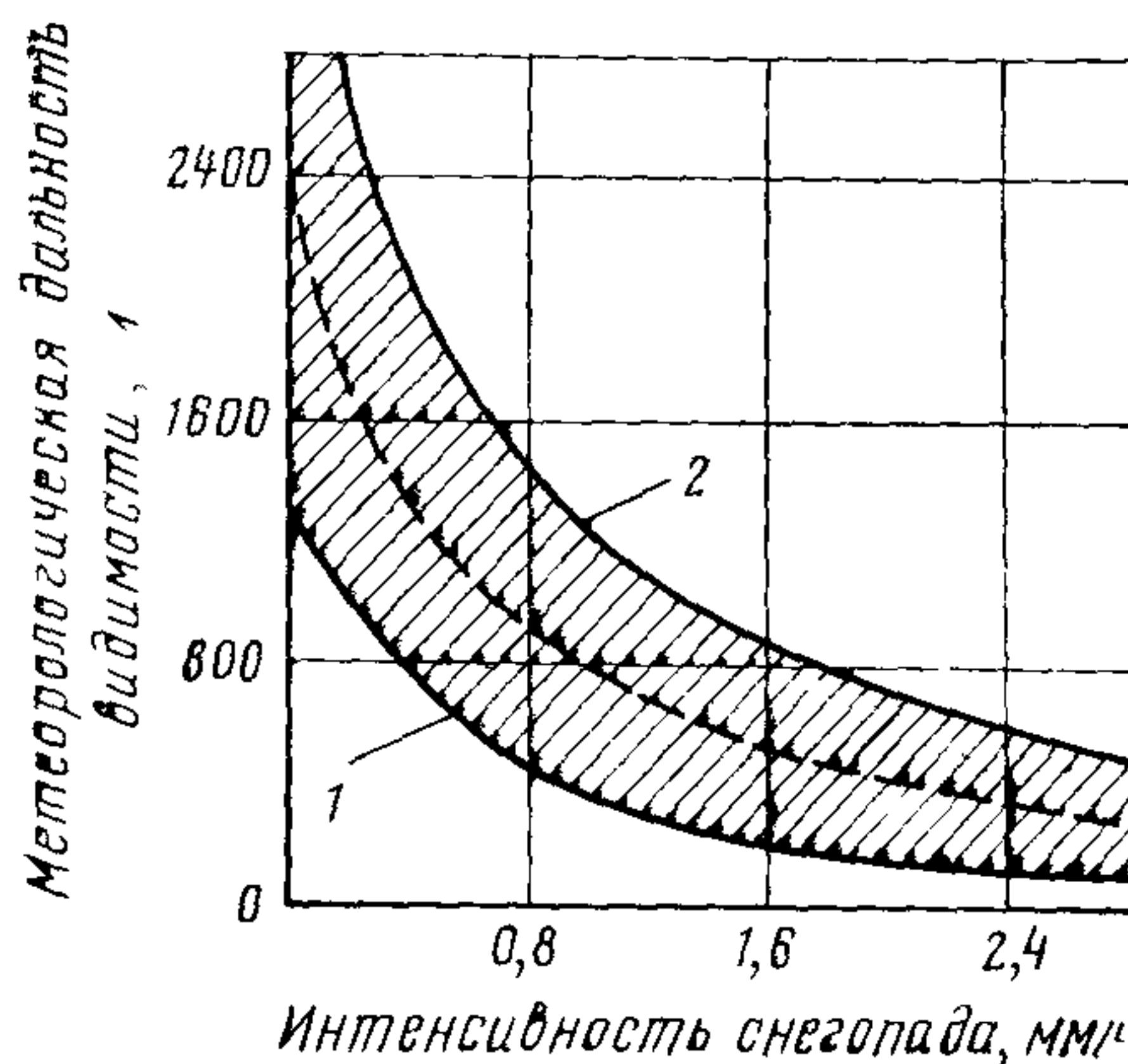
Рис. 2.9. Зависимость метеорологической дальности видимости от интенсивности осадков:
