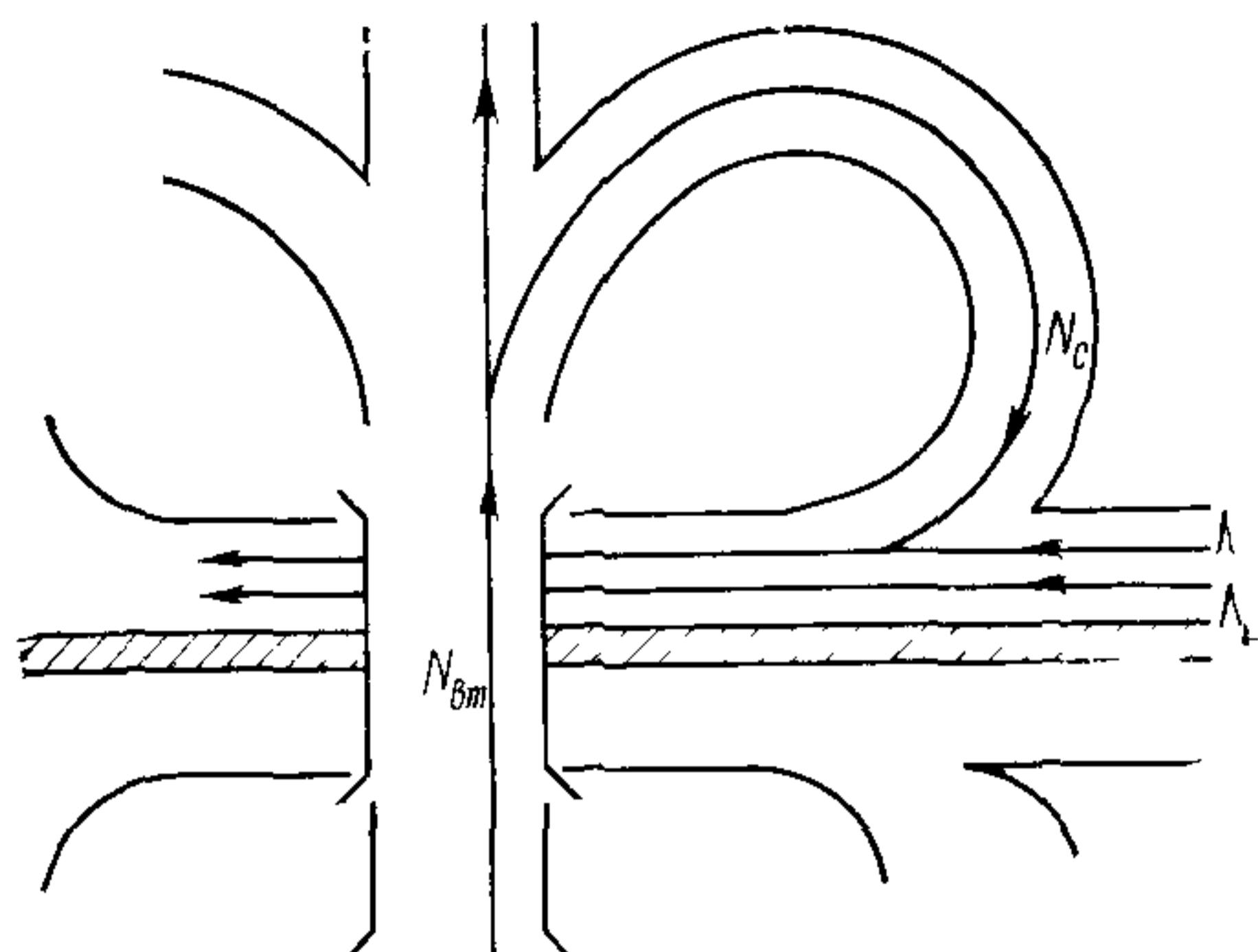
Рис. 2. Схема распределения потоков автомобилей при наличии левоповоротного съезда
