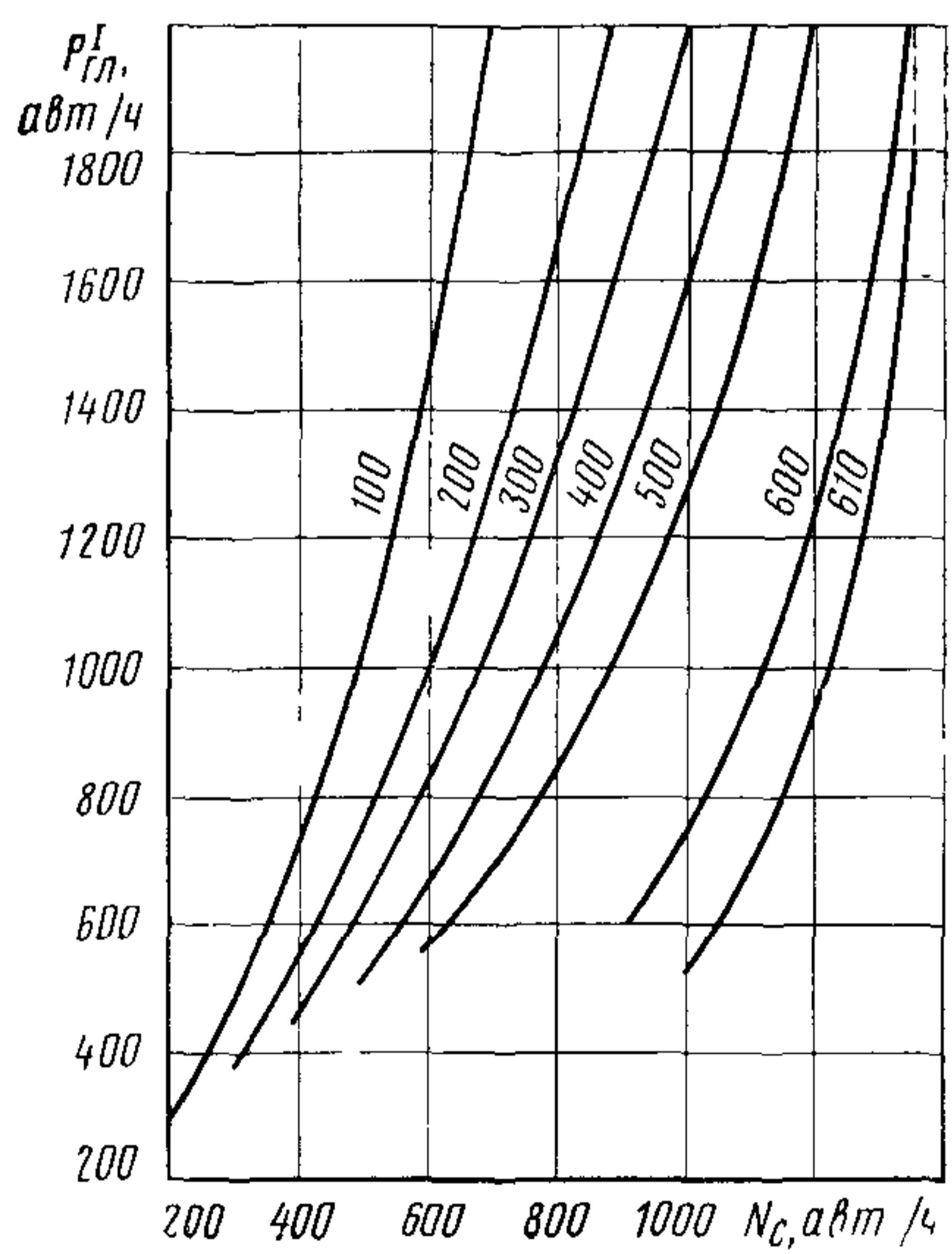
Рис. 4.8. Номограмма для определения пропускной способности за съездом при  $p_R = 0,06 \div 0,08$
