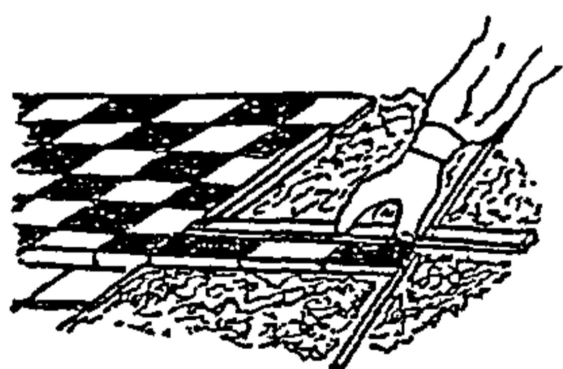
Рис. 5. Укладка полосок из одного ряда плиток по угольнику
