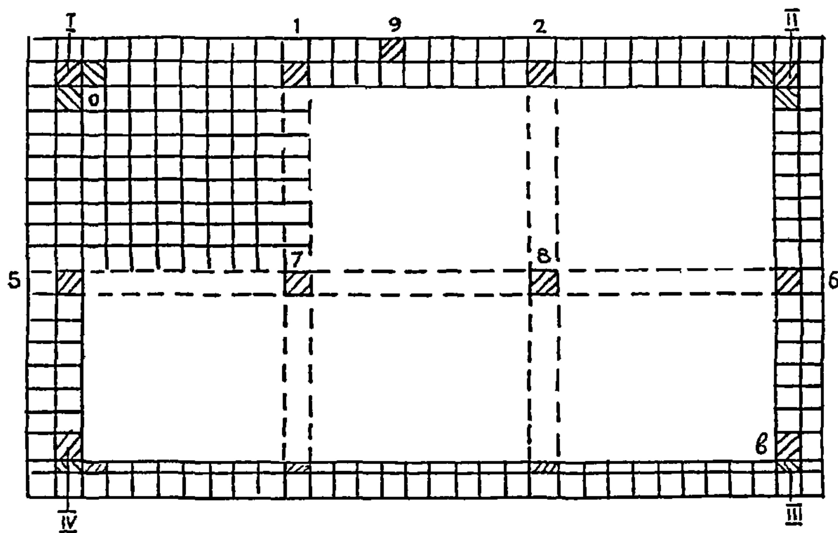
**Рис. 3. Схема размещения маячных плиток при настилке пола:**
