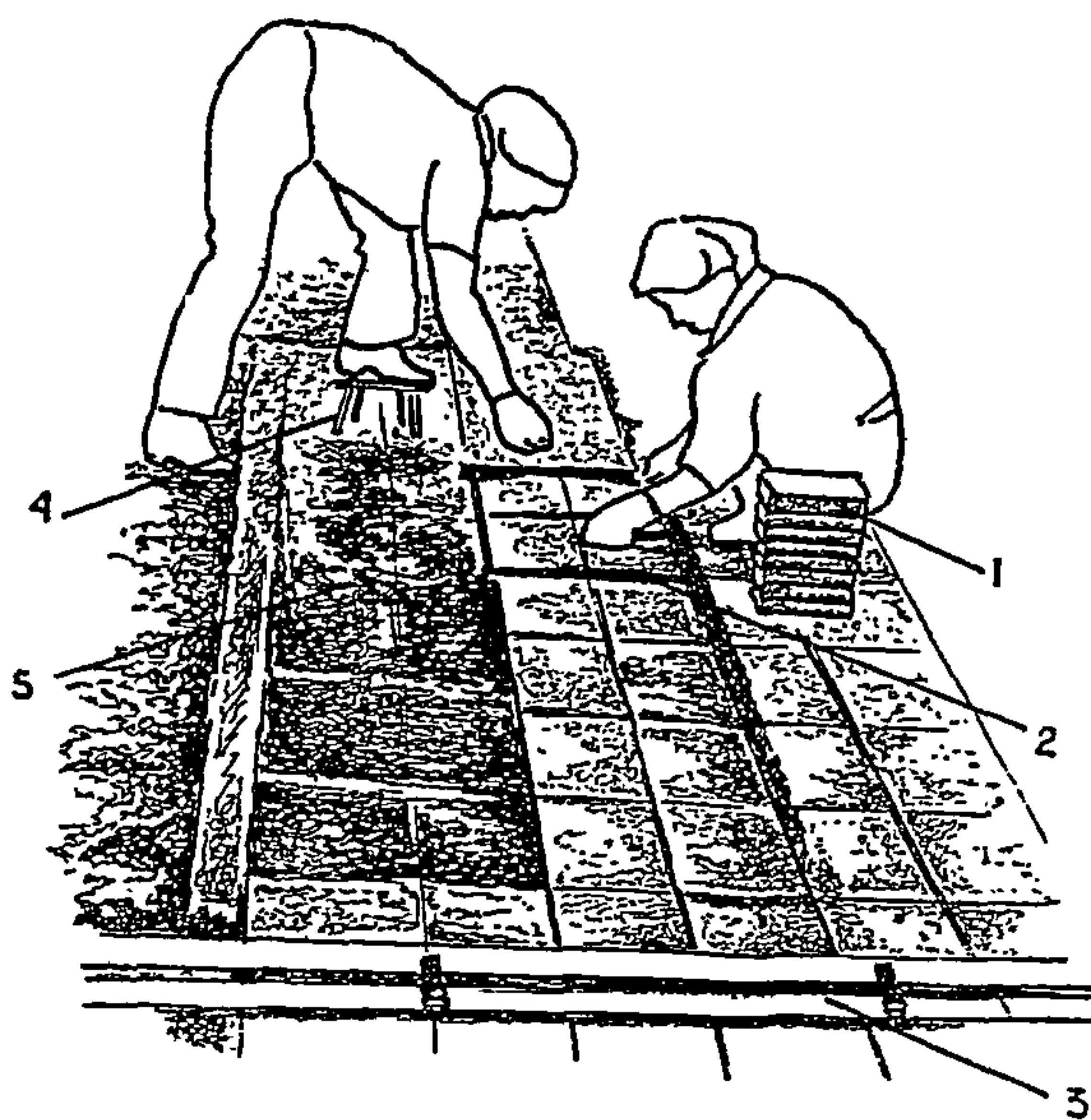
Рис. 6. Укладка плиток на прослойку из растворной смеси при помощи клеточного шаблона:
