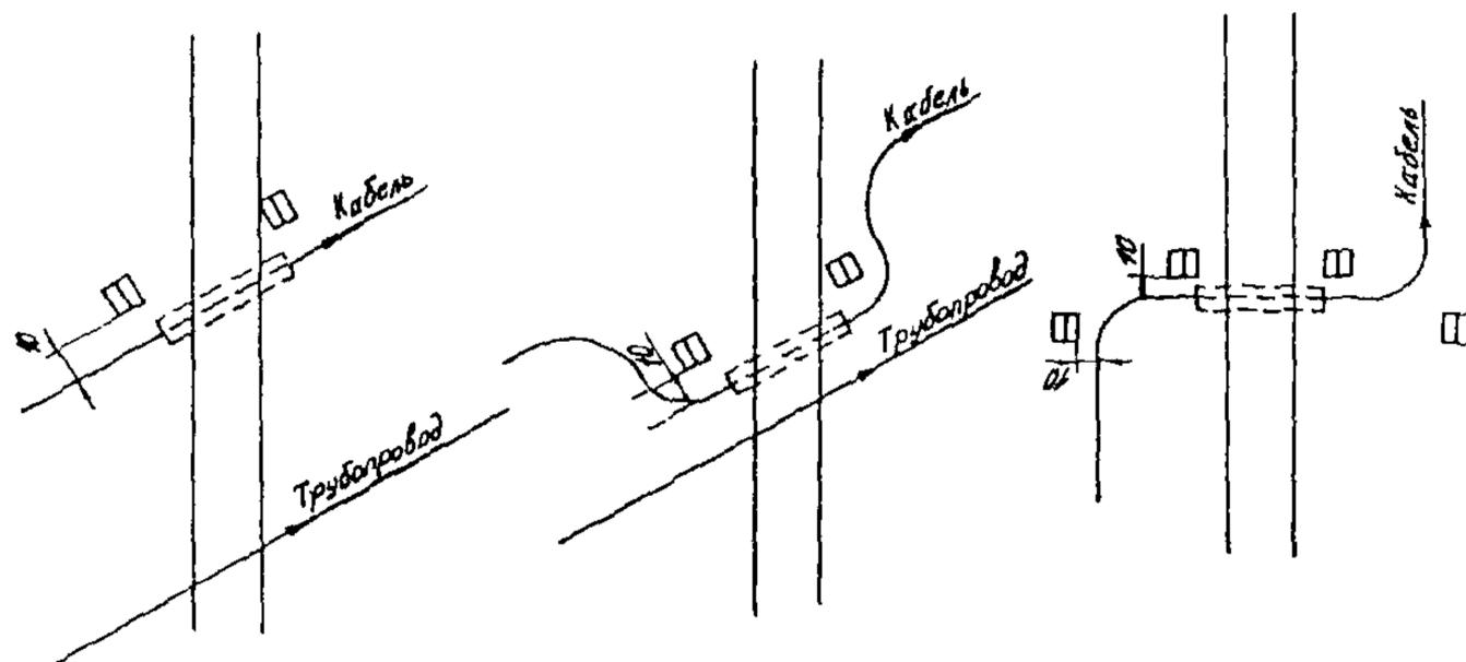
Рис.20. Установка измерных столбиков на переходах кабеля автомобильных и железных дорог в защитных трубах
