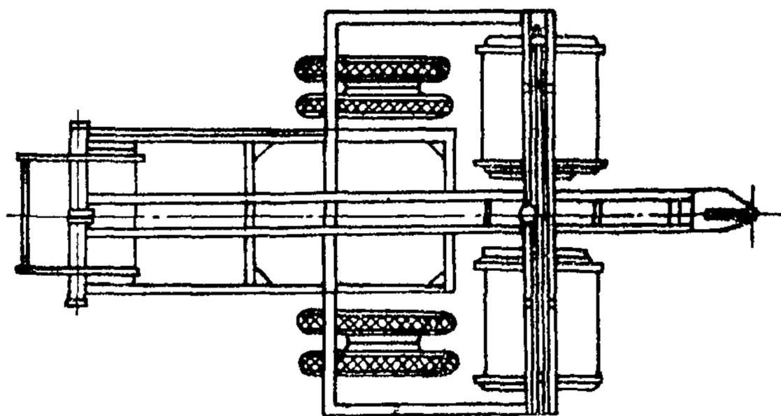
Рис.32. Одноосная трехбарабанная саморазгружающаяся раскаточная тележка грузоподъемностью 3 т; габариты: 4550хх2790х2100 мм
