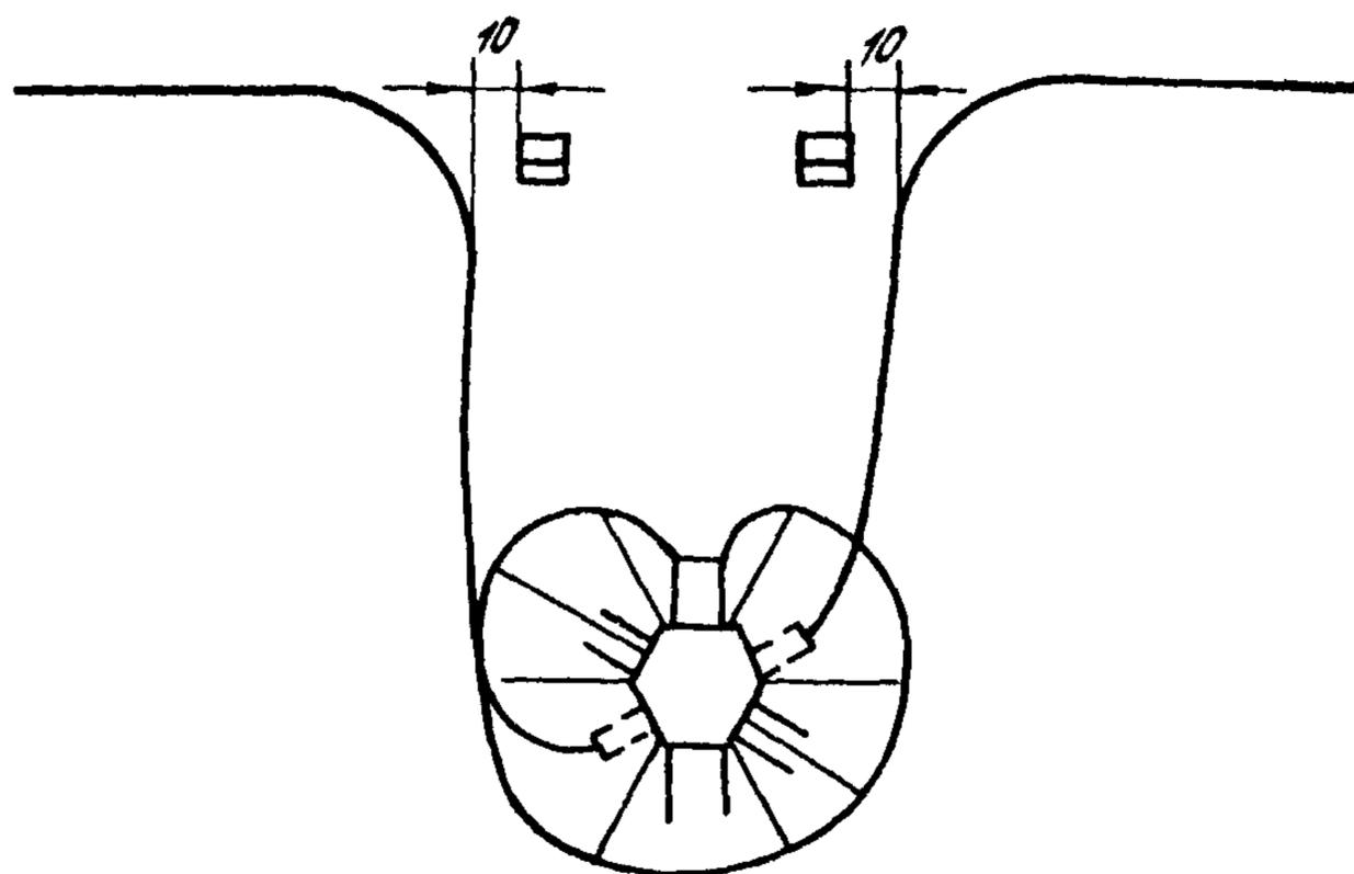
Рис.21. Установка дополнительных столбиков у НУПа
