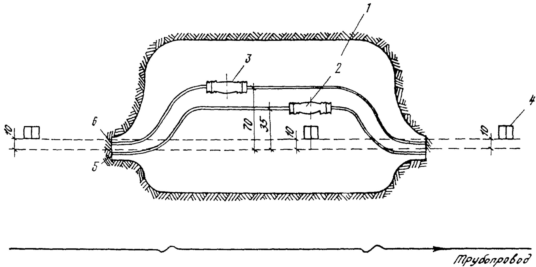
Рис.16. Установка измерного столбика у муфт на двухкабельной линии связи:
