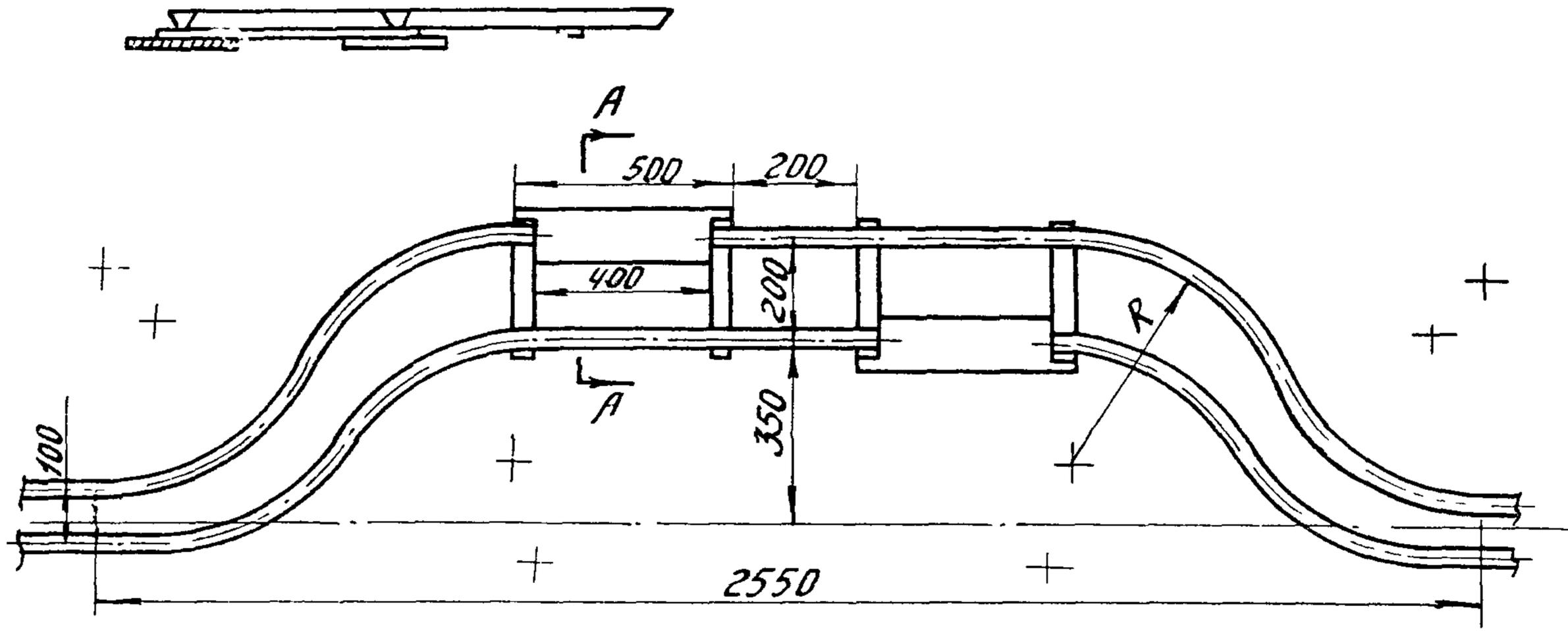
Рис.23. Рама для закрепления выкладки кабеля
