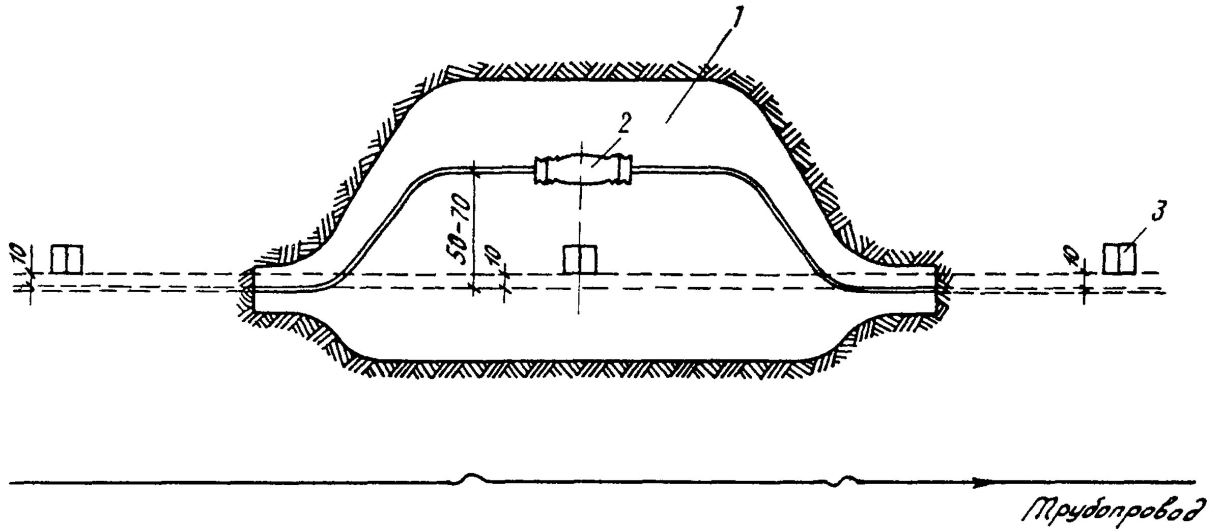
Рис.15. Установка измерного столбика у муфты на однокабельной линии связи:
