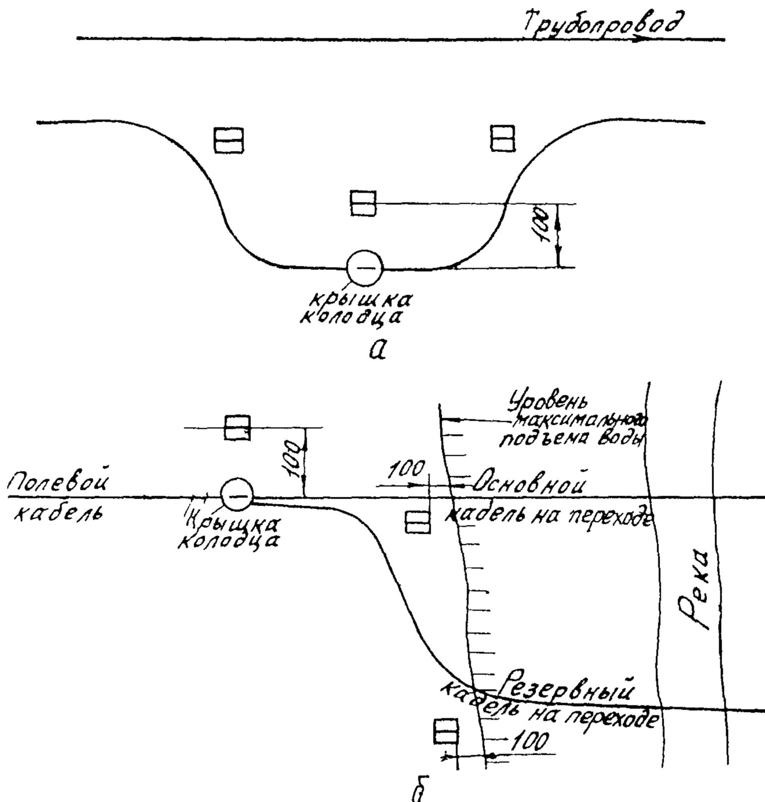
Рис.17. Установка измерных столбиков у колодцев:
