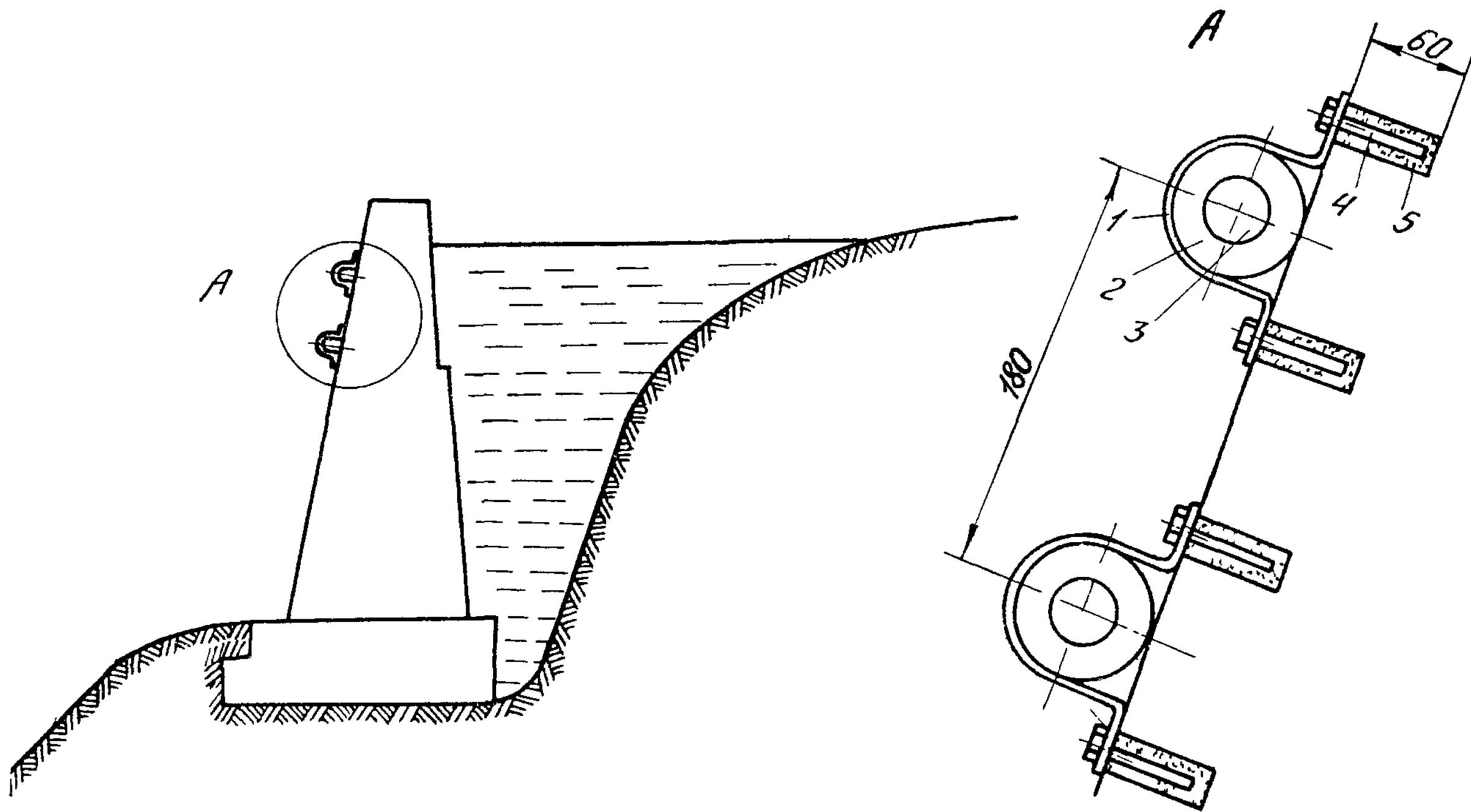
Рис. II. Схема прокладки кабеля по подпорной стене:
