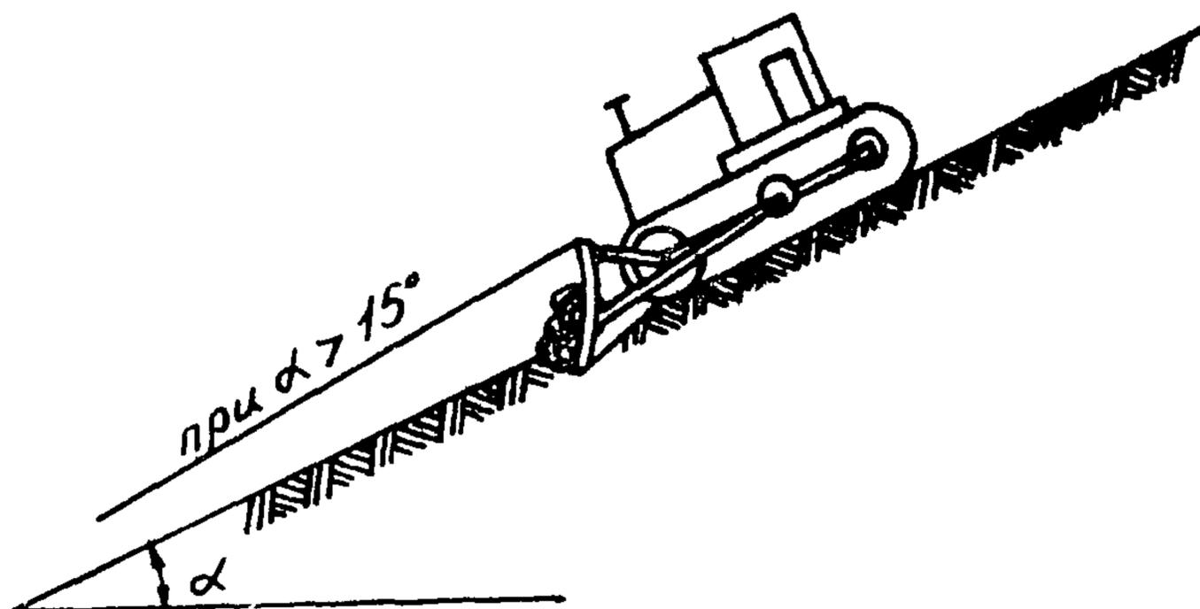
Рис.10. Схема использования бульдозера как якоря на уклоне
