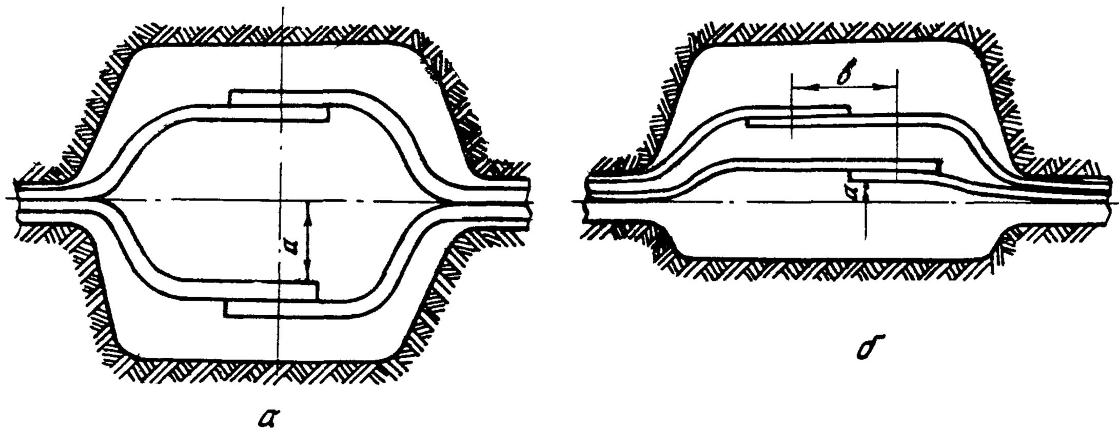
Рис.22. Выкладка кабелей в котловане:
