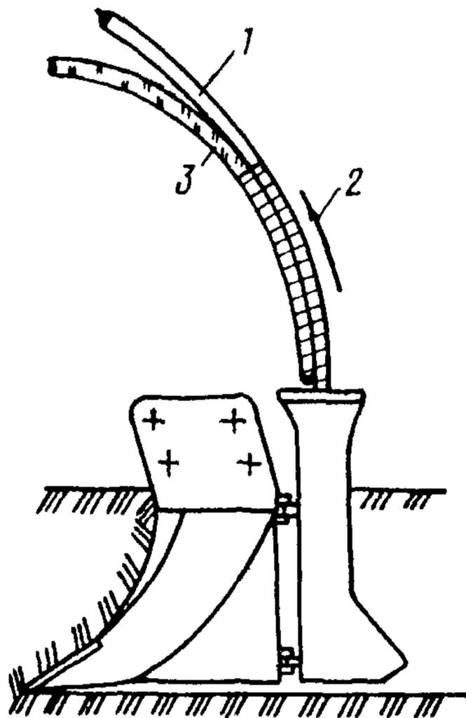
Рис.6. Связывание концов строительных длин кабеля: 1-конец проложенной строительной длины; 2-направление обмотки лентой; 3-конец прокладываемой строительной длины
