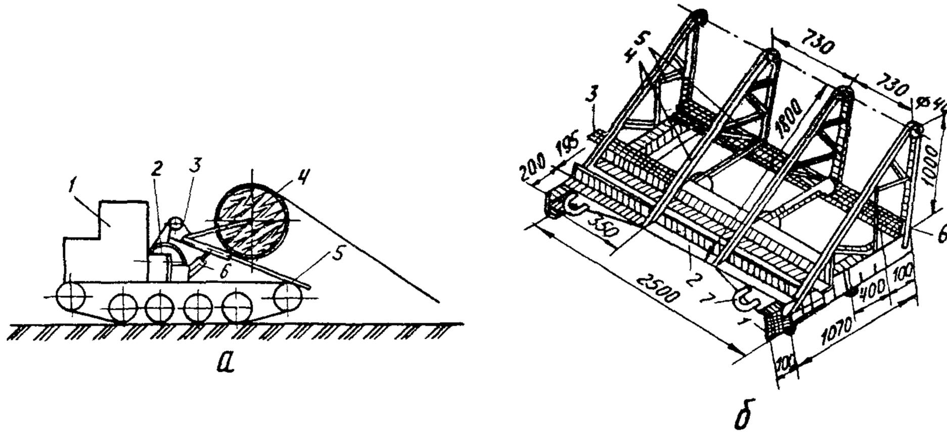
Рис.31. Раскаточное устройство:
