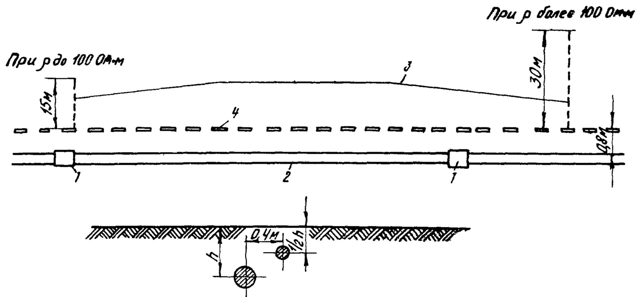
Рис.24. Схема прокладки одного защитного провода (троса):
