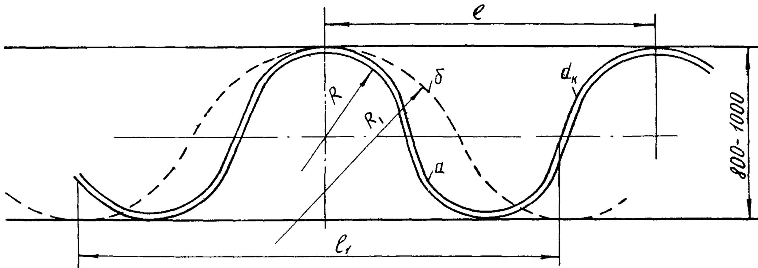
Рис. 12. Прокладка кабеля в широкой траншее змейкой:
