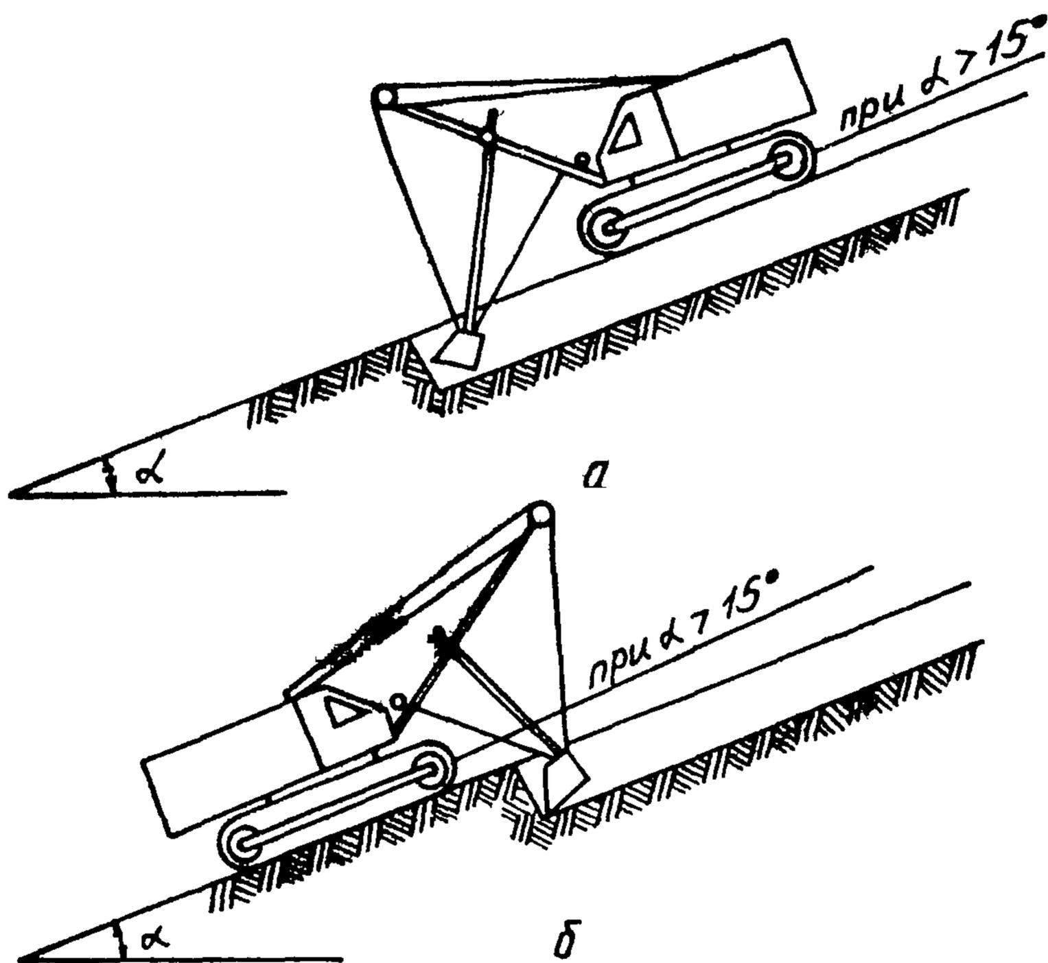
Рис.8. Схема работы на уклоне одноковшового экскаватора:
