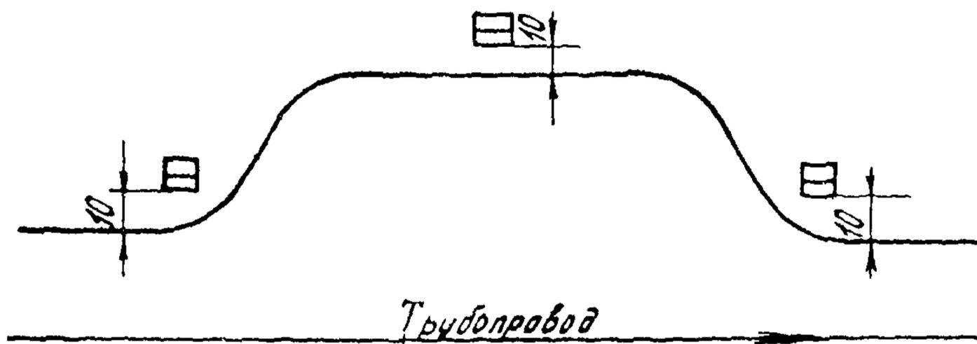
Рис.19. Установка дополнительных столбиков на неперодолжительных отклонениях трассы кабеля
