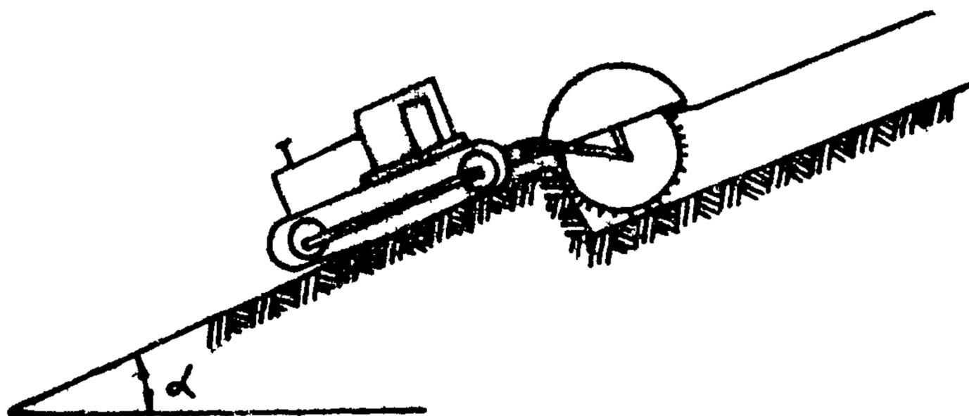
Рис.9. Схема работы на уклоне траншейного экскаватора
