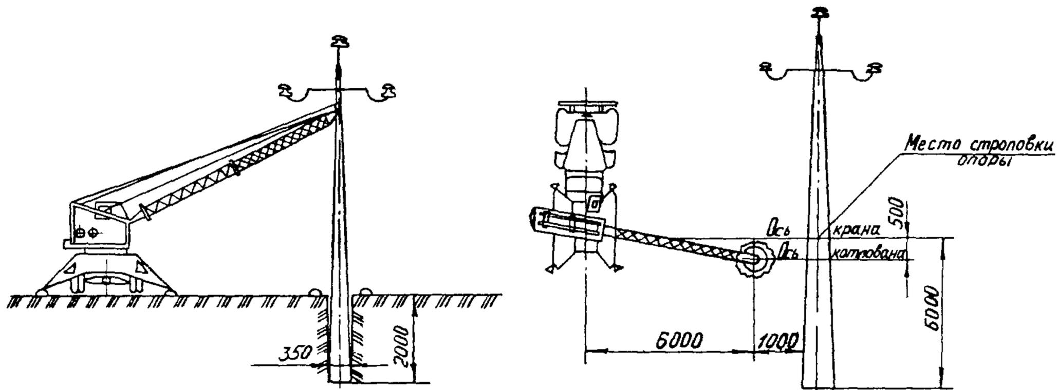
Рис.28. Установка одностоечных опор ВЛ-6-10 кВ с помощью автомобильного крана
