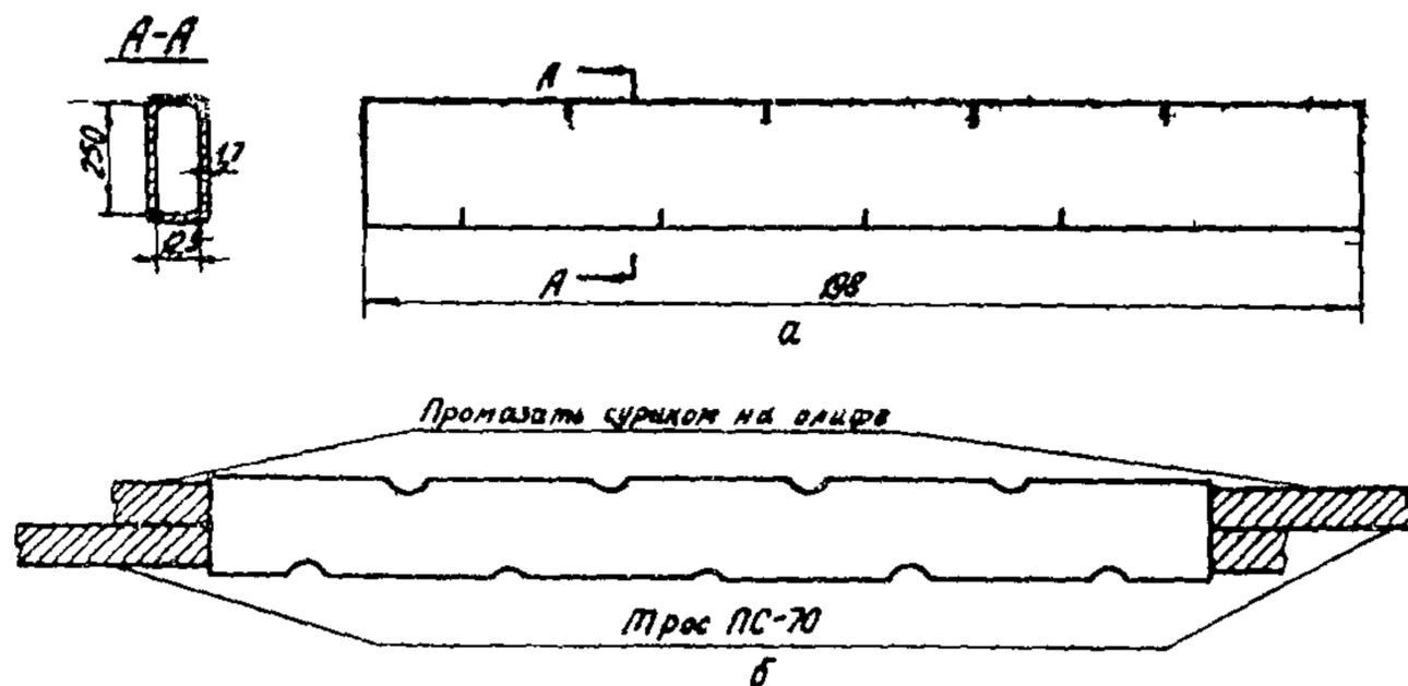
Рис. 25. Сращивание троса ПС-70 с помощью овального соединителя:
