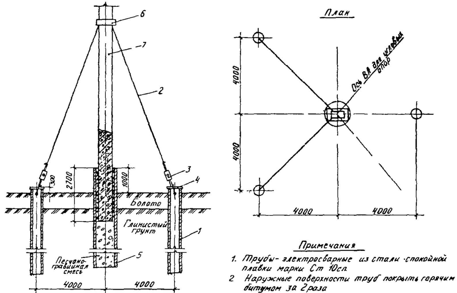
Рис.30. Закрепление анкерно-угловых опор на болотах и пучинистых грунтах:
