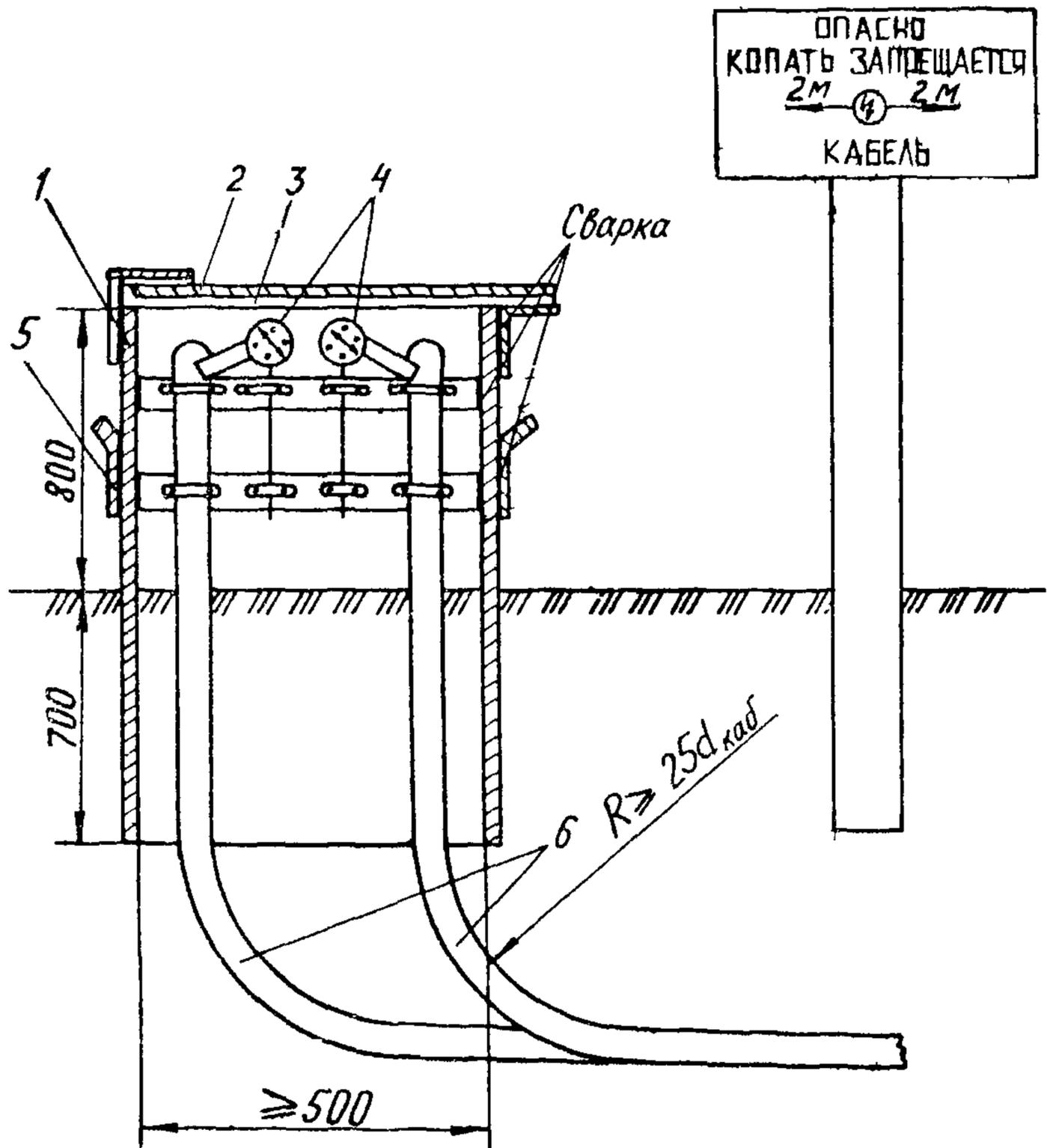
Рис. I. Оголовник для кабеля связи на подводных переходах (рекомендуемая конструкция):
