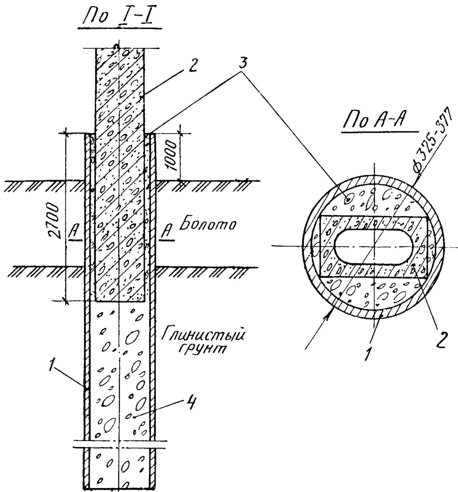
Рис.29. Закрепление промежуточных опор на сваях:
