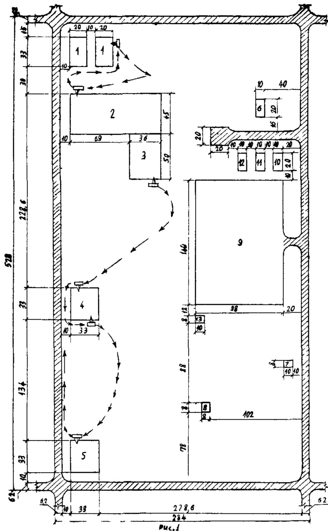
Рис. I. Примерная схема расположения оборудования и строений на трубосварочной базе (размеры даны в метрах):
