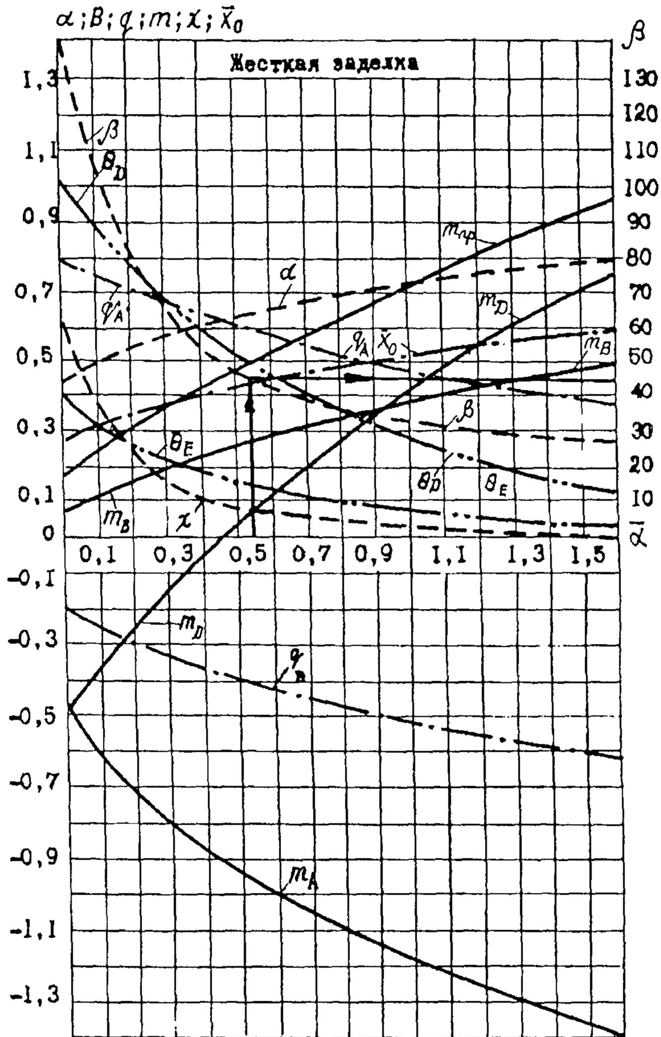
Рис. 10. График зависимости коэффициентов  $\alpha, \theta, q, m, \chi$  и  $\bar{\chi}_0$  (левая шкала) и  $\beta$  (правая шкала) от коэффициента  $\bar{\alpha}$  при жесткой заделке голов свай в ростверк
