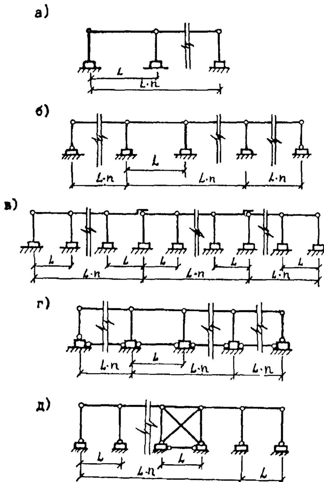
Рис. 13. Схемы поперечных рам одноэтажных каркасных зданий
