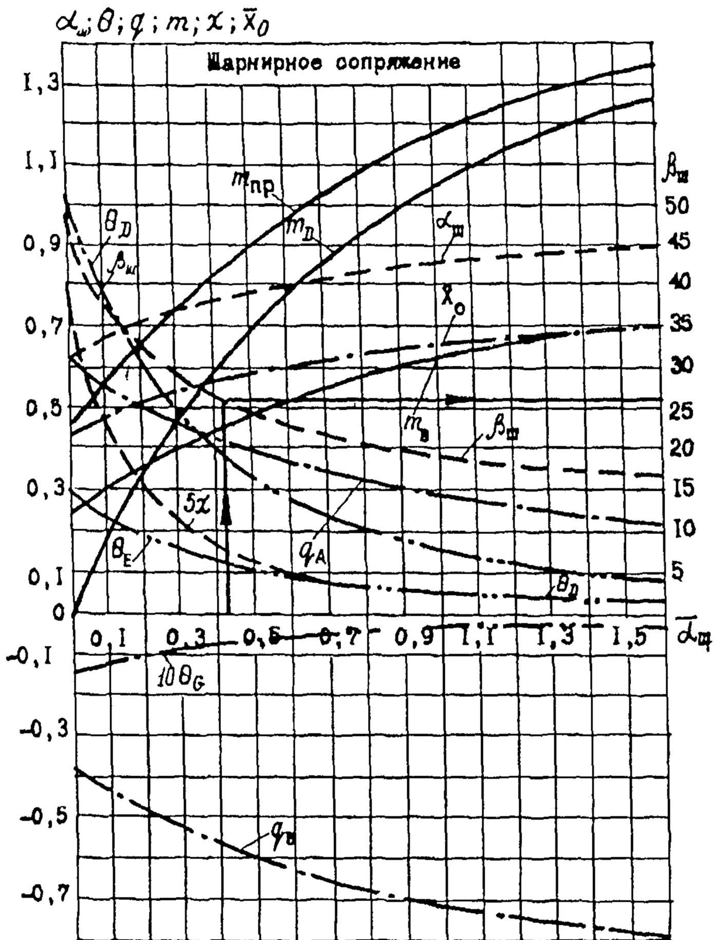
Рис. 11. График зависимости коэффициентов  $\alpha_{\omega}$ ,  $\theta$ ,  $q$ ,  $m$ ,  $\chi$  и  $\bar{\chi}_0$  (левая шкала) и  $\beta$  (правая шкала) от коэффициента  $\bar{\alpha}_{\omega}$  при шарнирном сопряжении голов свай с ростверком
