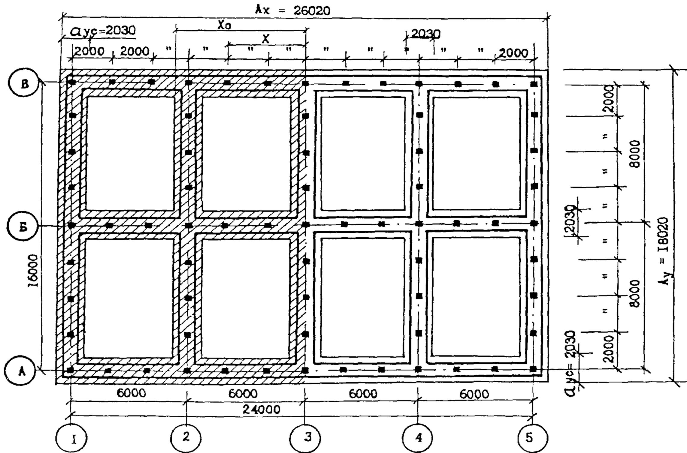
Рис. 12. План свайного поля и условных фундаментов
