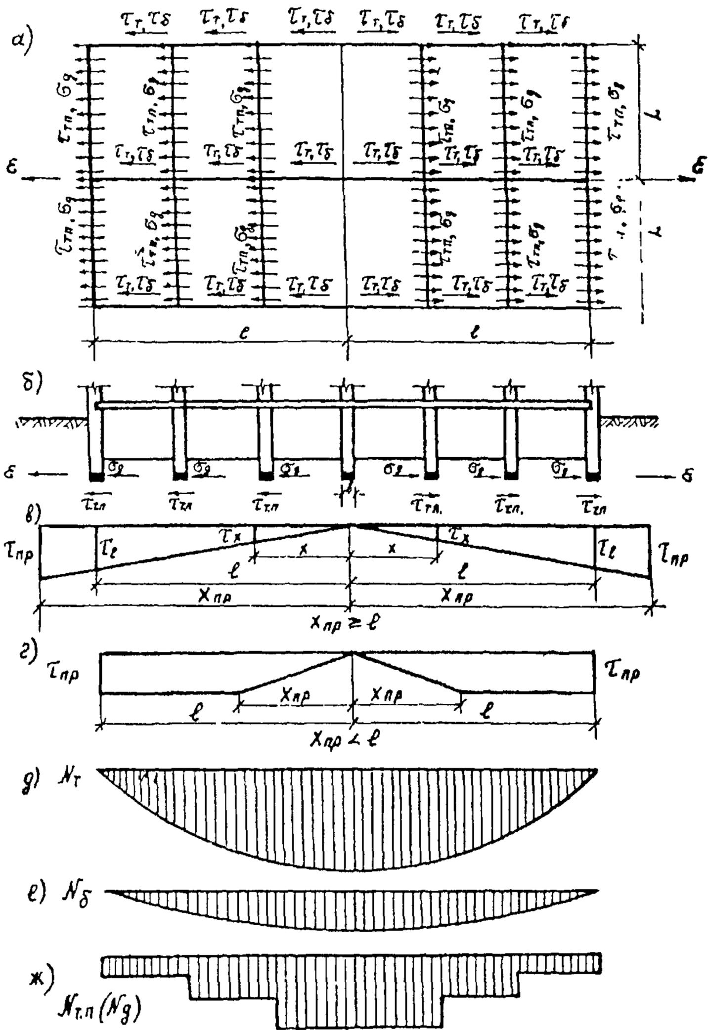
Рис. 3. Нагрузки на заглубленную часть жесткого фундамента от воздействия деформаций в зоне растяжения
