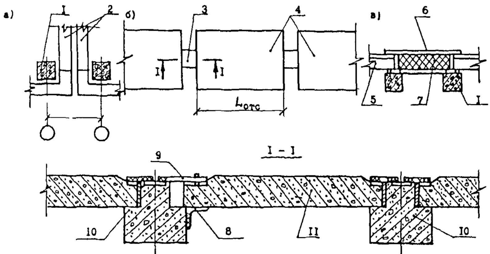
Рис. 16. Заполнение деформационных швов
