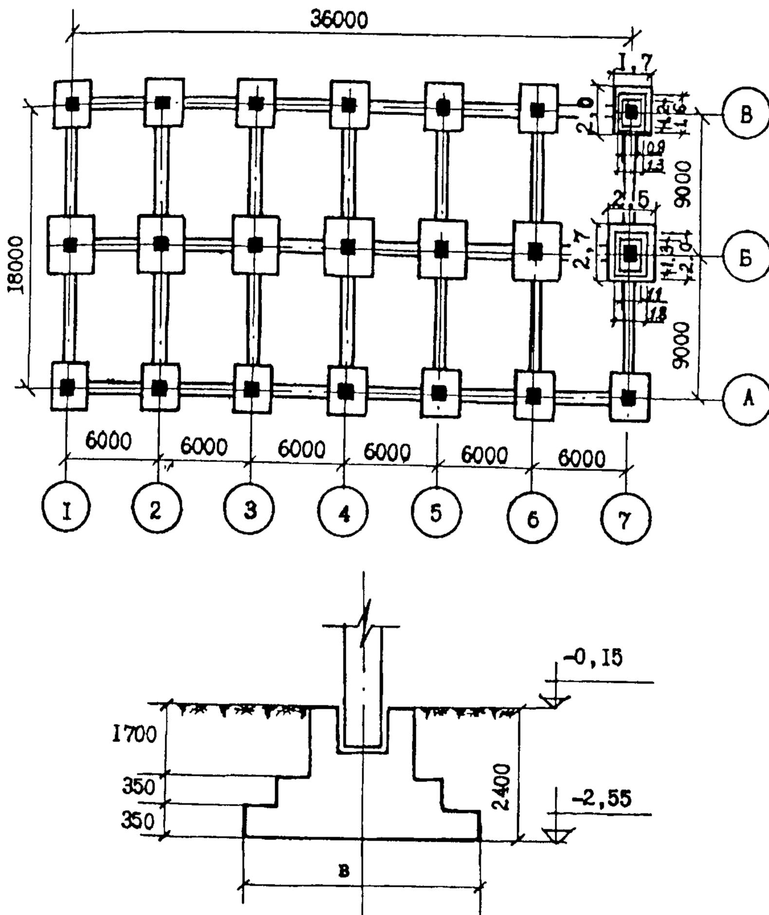
Рис. 17. План и сечение отдельно стоящих фундаментов каркасного здания
