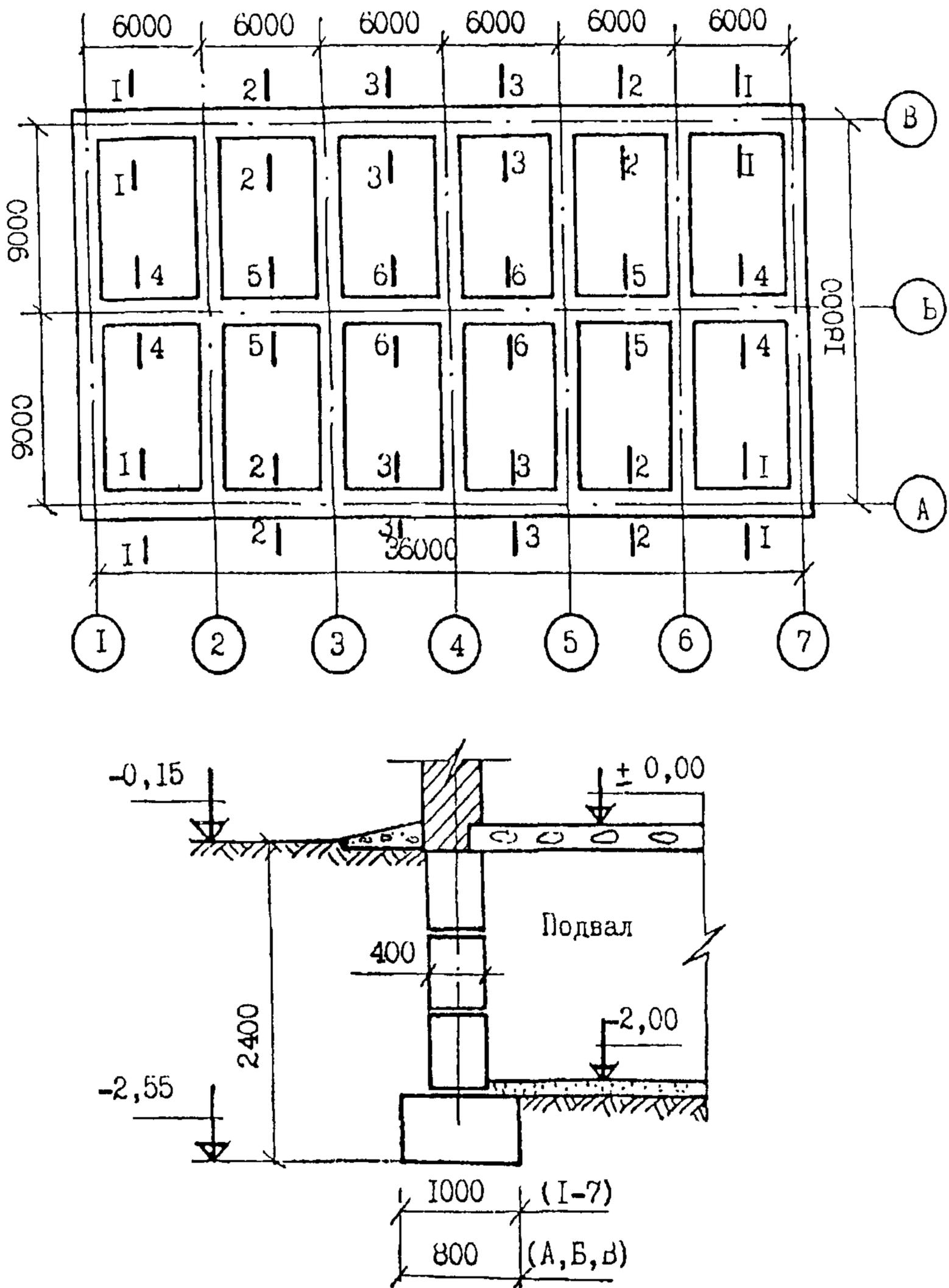
Рис. 6. План и сечение ленточных фундаментов бескаркасного здания
