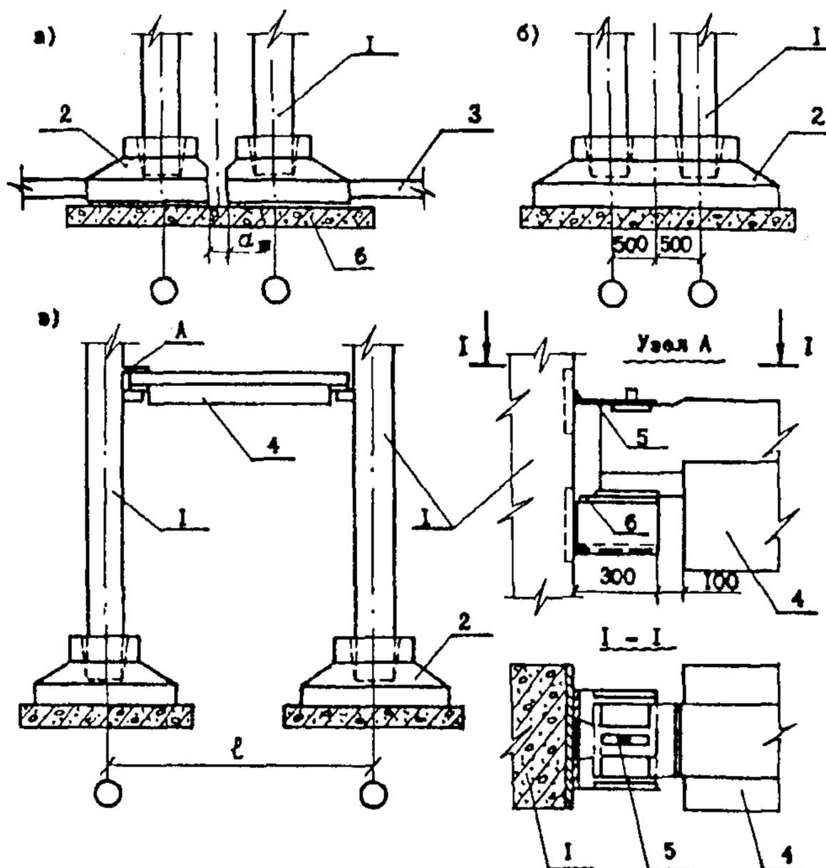
Рис. 15. Конструкция деформационных швов.
