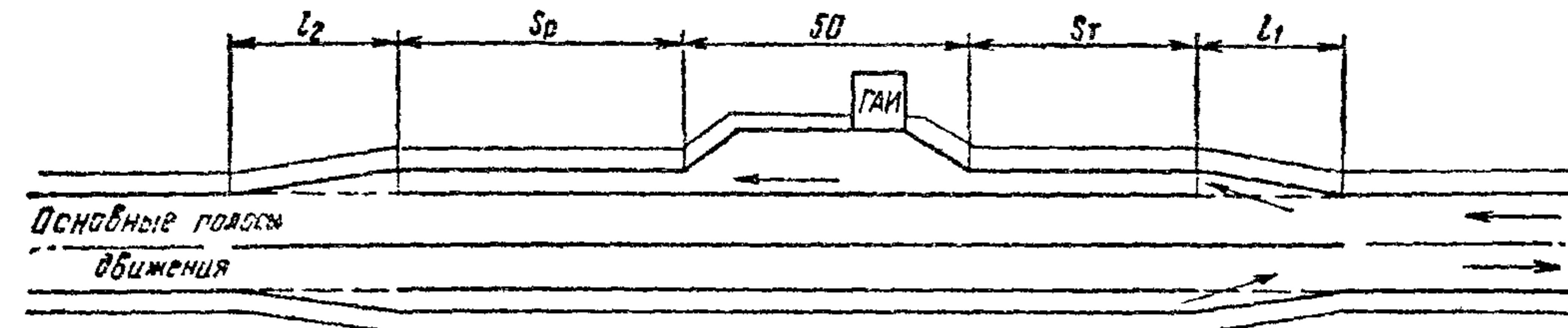
Рис 11 Пример (схема) размещения пункта ГАИ
