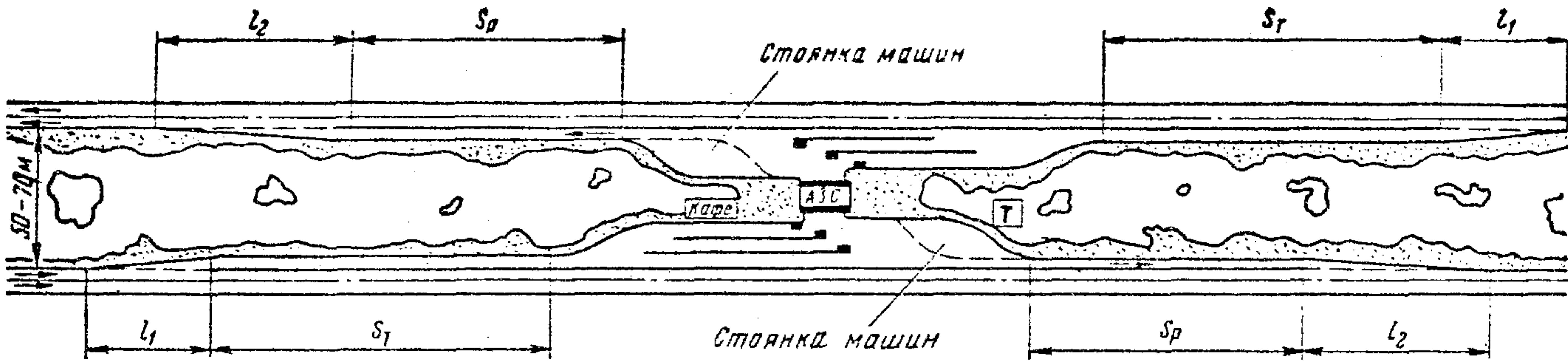
Рис. 6. Пример (схема) островного размещения автозаправочной станции на дороге I категории.
