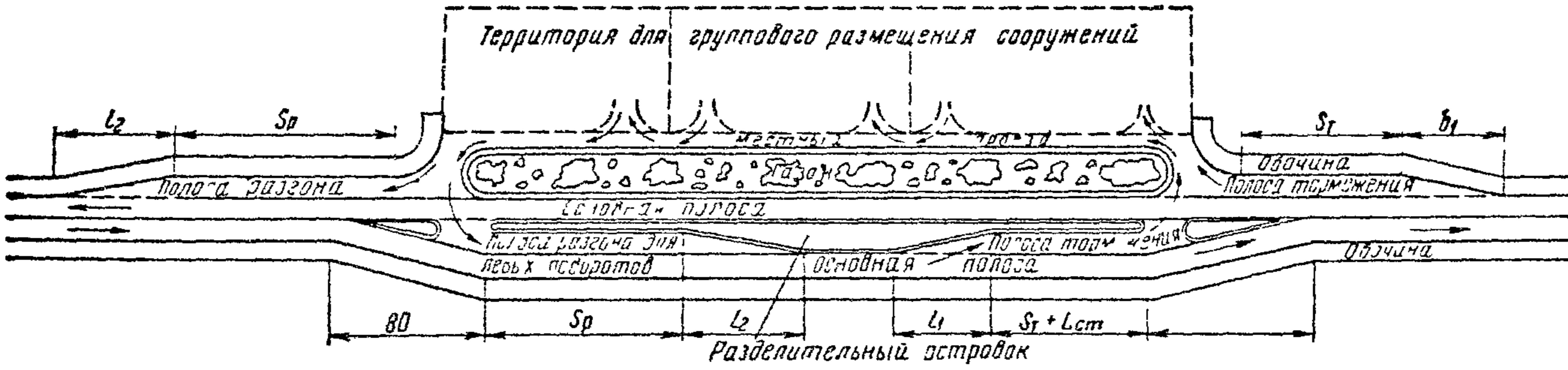
Рис. 10 Пример (схема) съезда и въезда с дороги III категории в район группового размещения сооружений с местным проездом.
