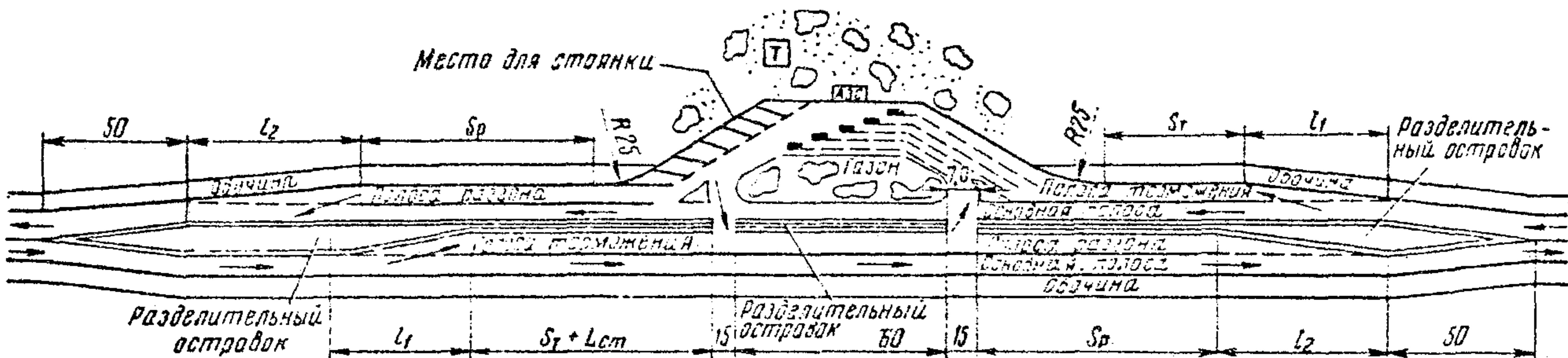
Рис. 7. Пример (схема) размещения автозаправочной станции на дороге II категории при интенсивности до 4000 автомобилей в сутки и на дороге III категории.
