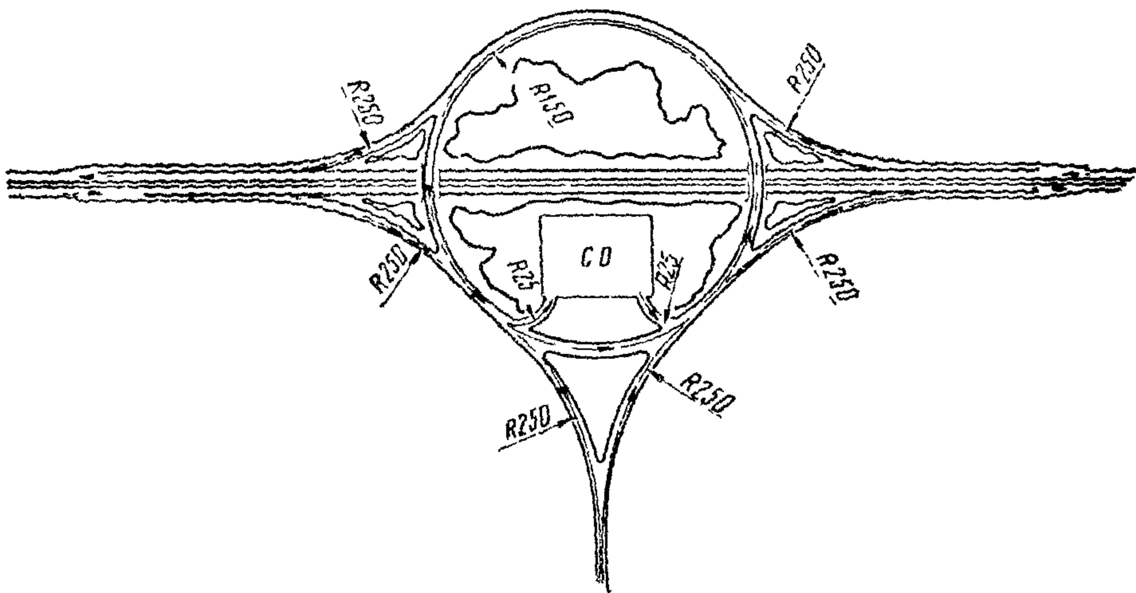
Рис. 8. Пример (схема) размещения станции обслуживания автомобилей, автозаправочной станции на прямых съездах дороги III категории к дорогам I—II категорий
