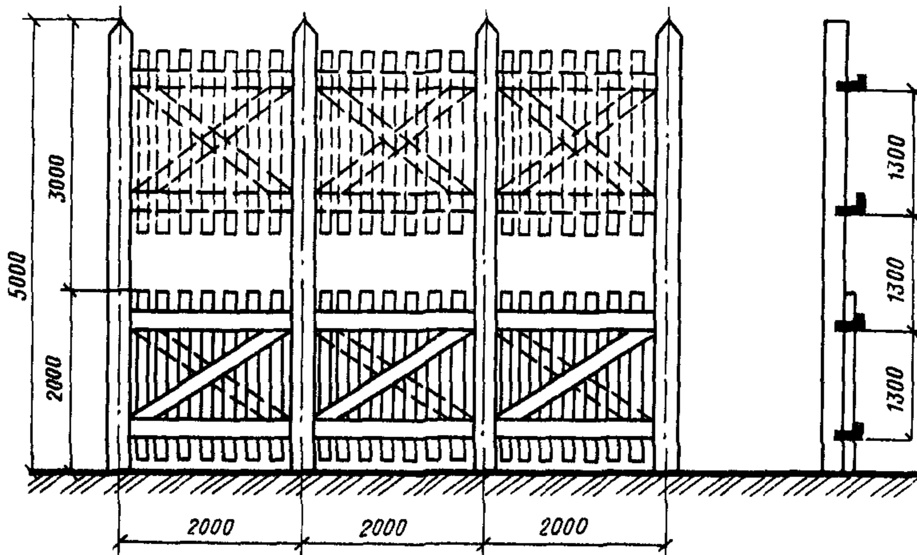
Рис. 30. Деревянный забор со съемными щитами
