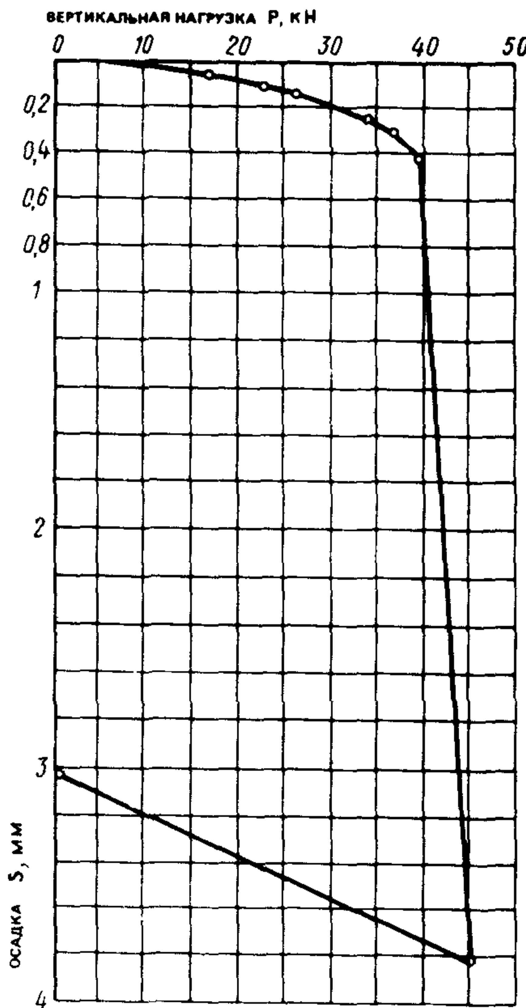
Рис. 2. График "осадка–нагрузка"
