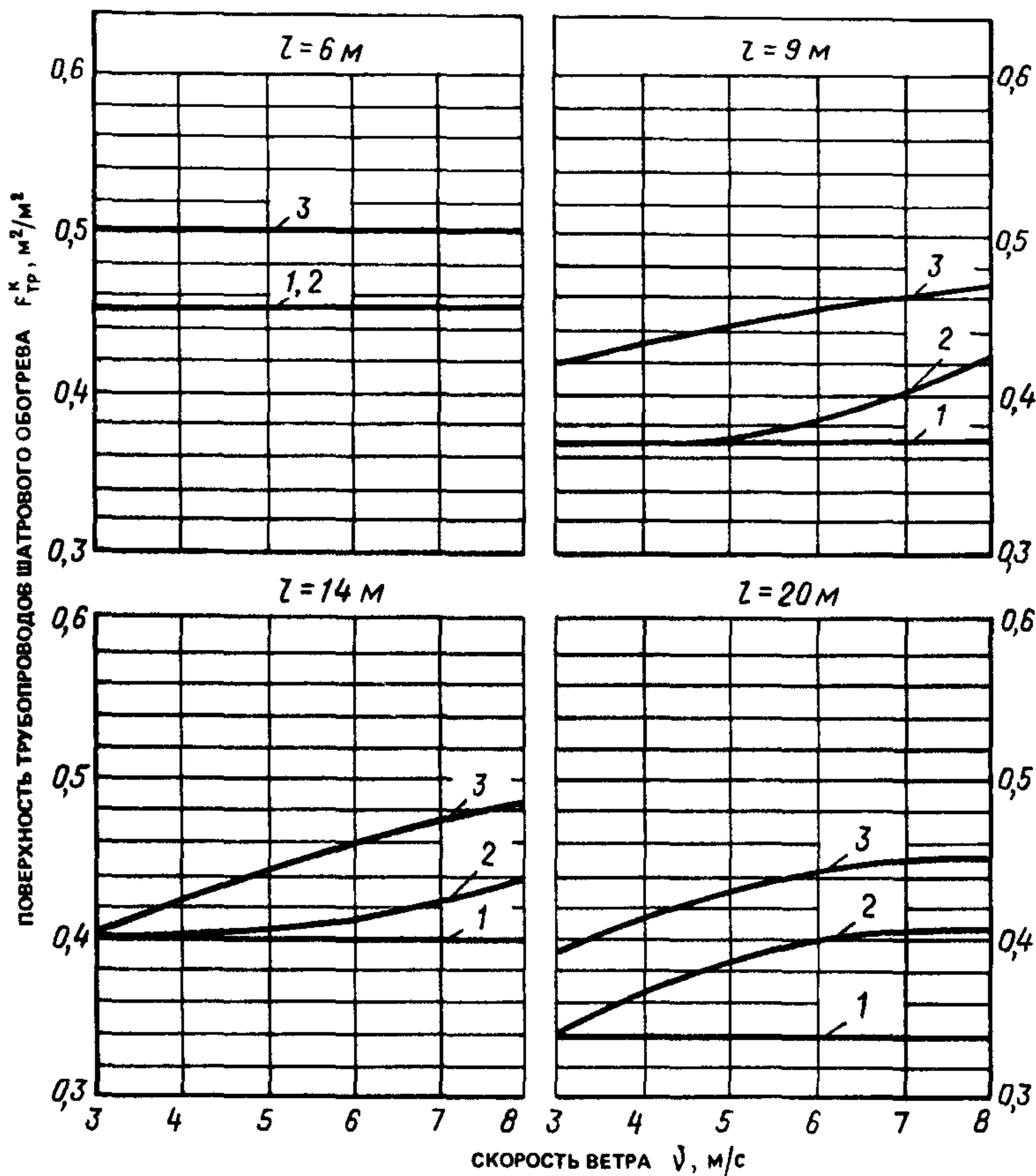
Рис. 23. Графики для определения требуемой поверхности трубопроводов шатрового обогрева при максимальной мощности калориферного обогрева и шаге трубопроводов подпочвенного обогрева  $S = 0,4\text{ м}$
