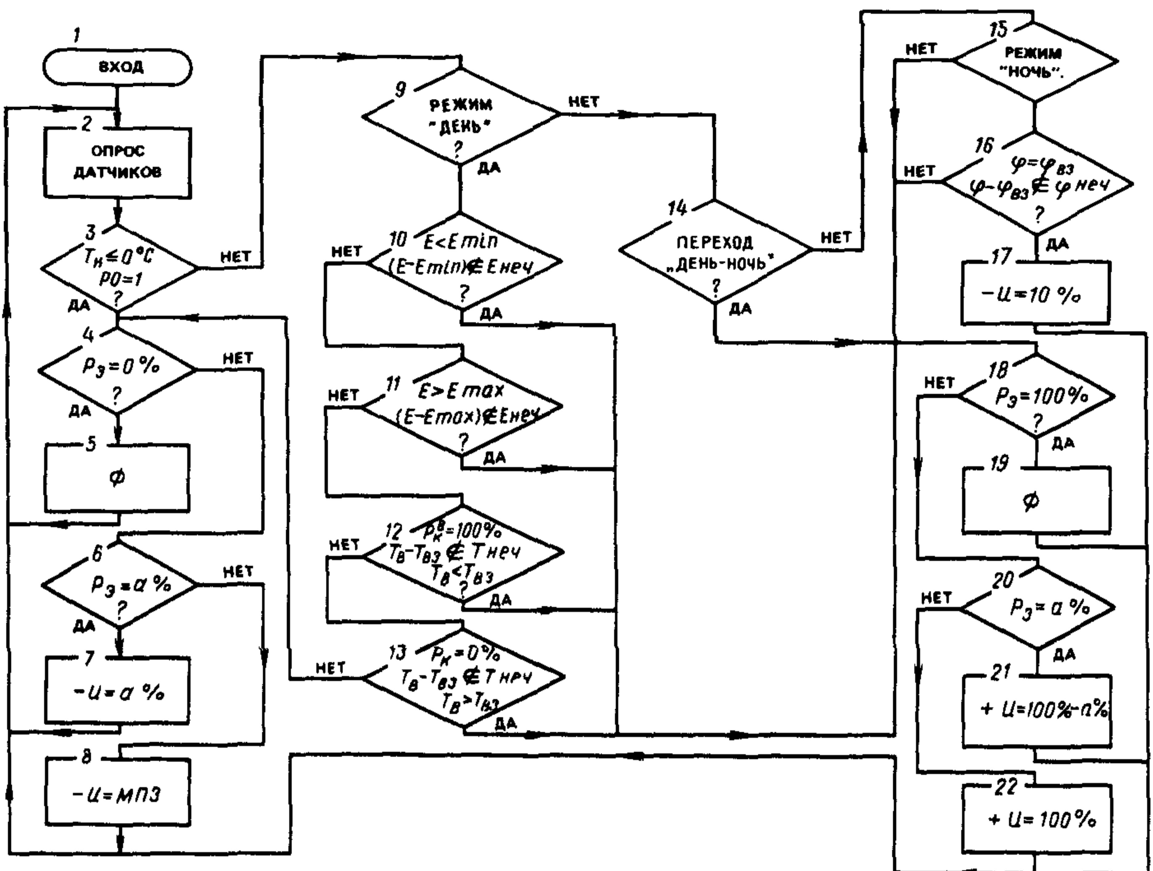
Рис. 11. Блок-схема алгоритма формирования управляемых воздействий в системе экранирования теплицы
