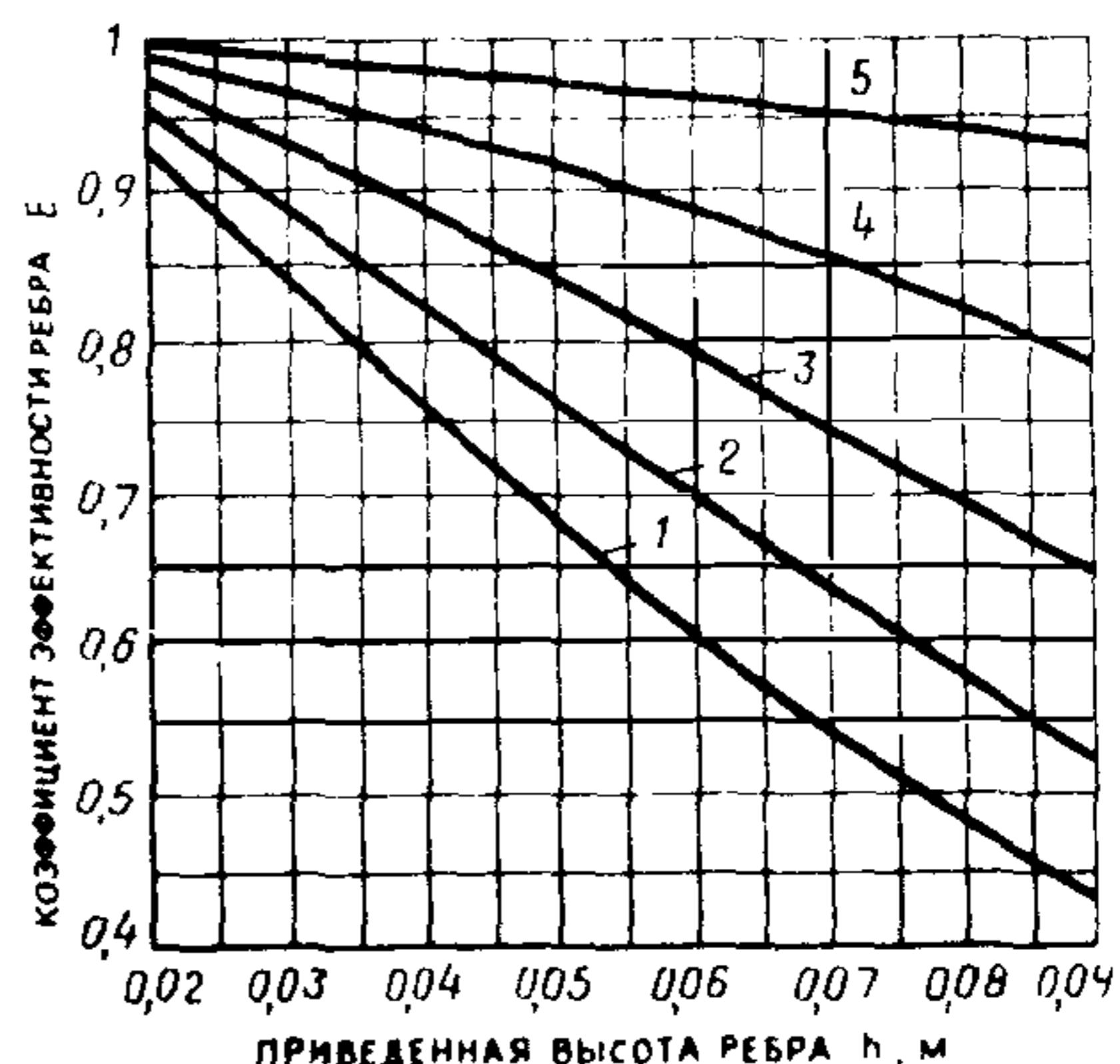
Рис. 20. График для определения коэффициента термической эффективности ребра  $E$
