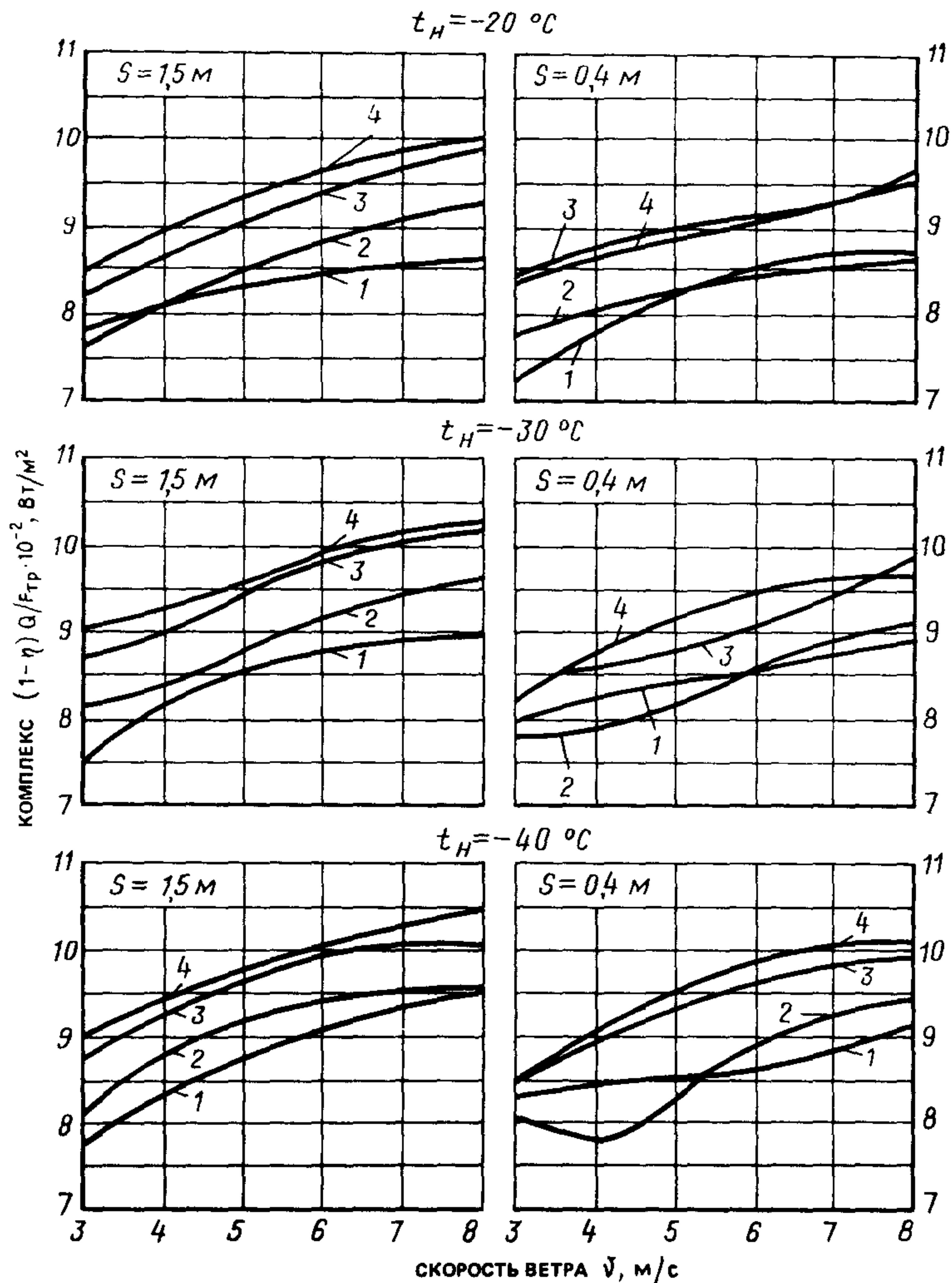
Рис. 24. Графики для определения максимальной мощности калориферного обогрева  $\eta$
