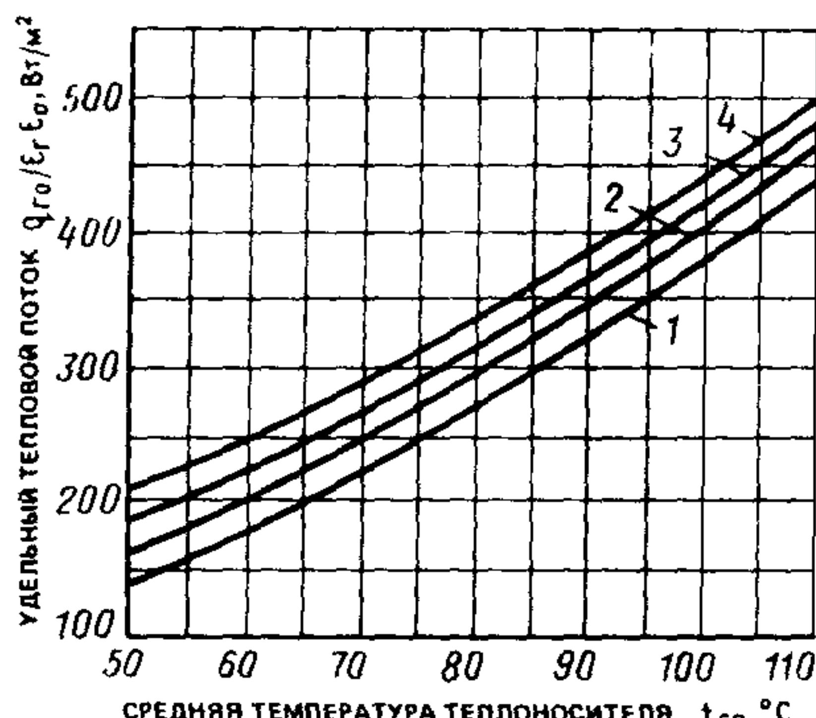
Рис. 17. График для определения удельного теплового потока излучением от гладкой трубы на ограждение
