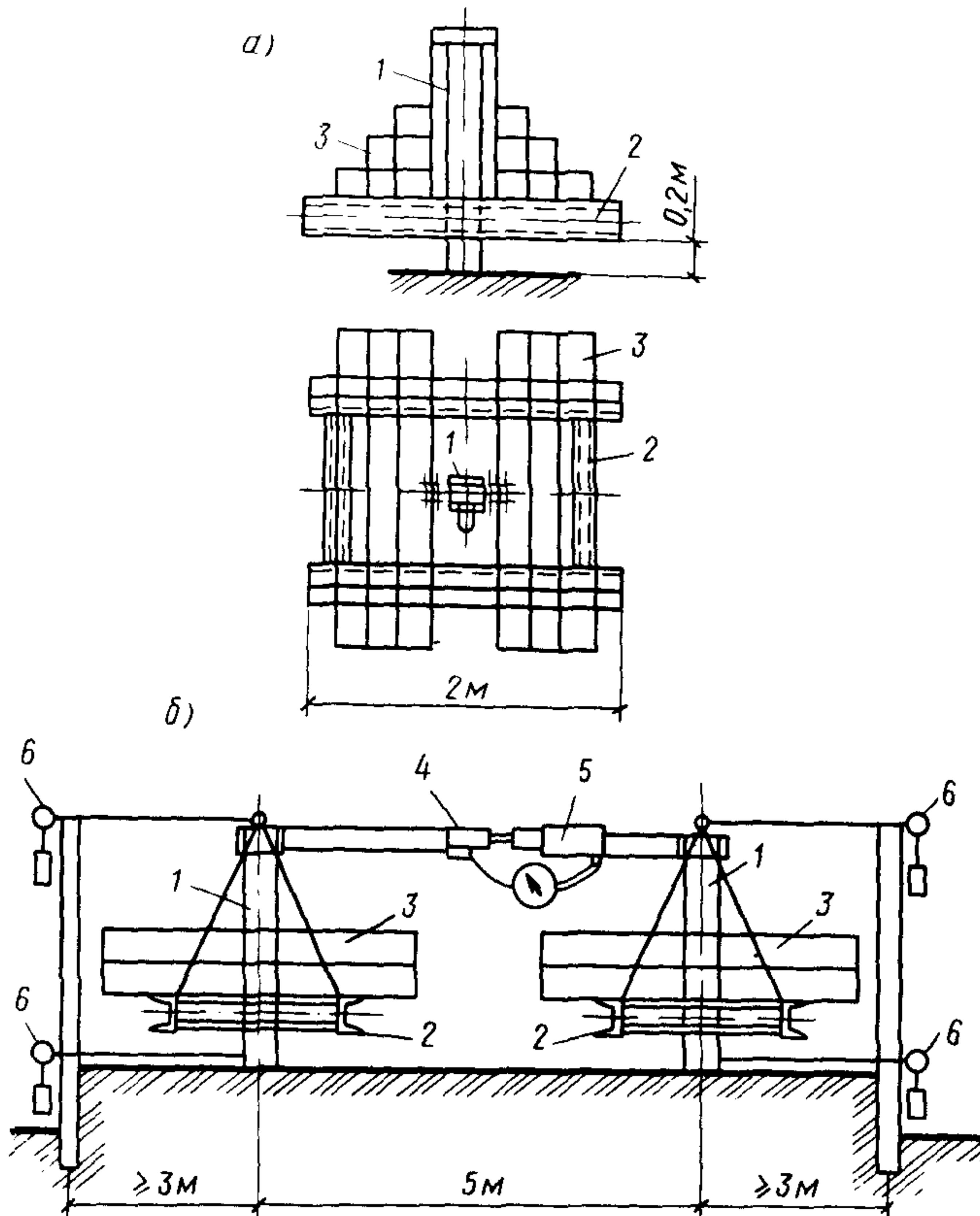
Рис. 1. Схемы загружения свай
