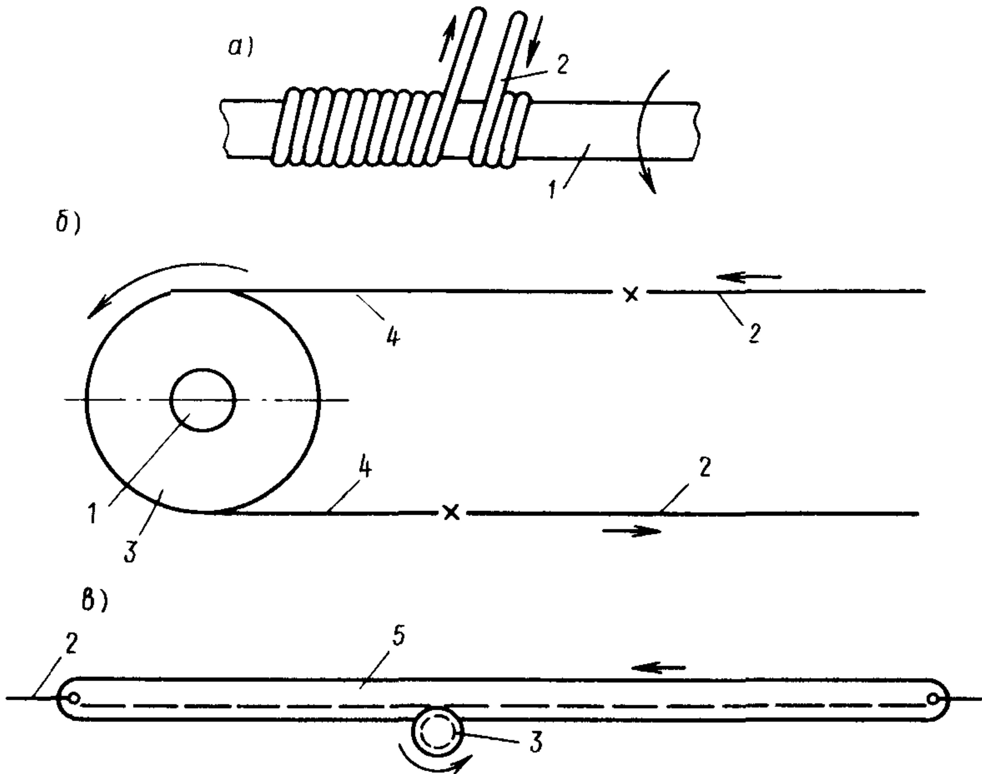
Рис. 8. Способы передачи усилия от приводного вала к приводным тросам
