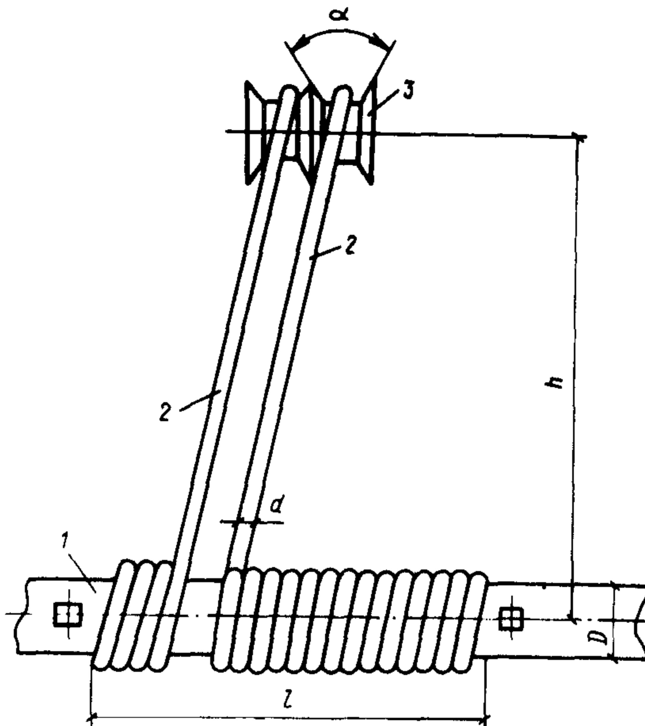
Рис. 9. Схема к расчету привода системы экранирования
