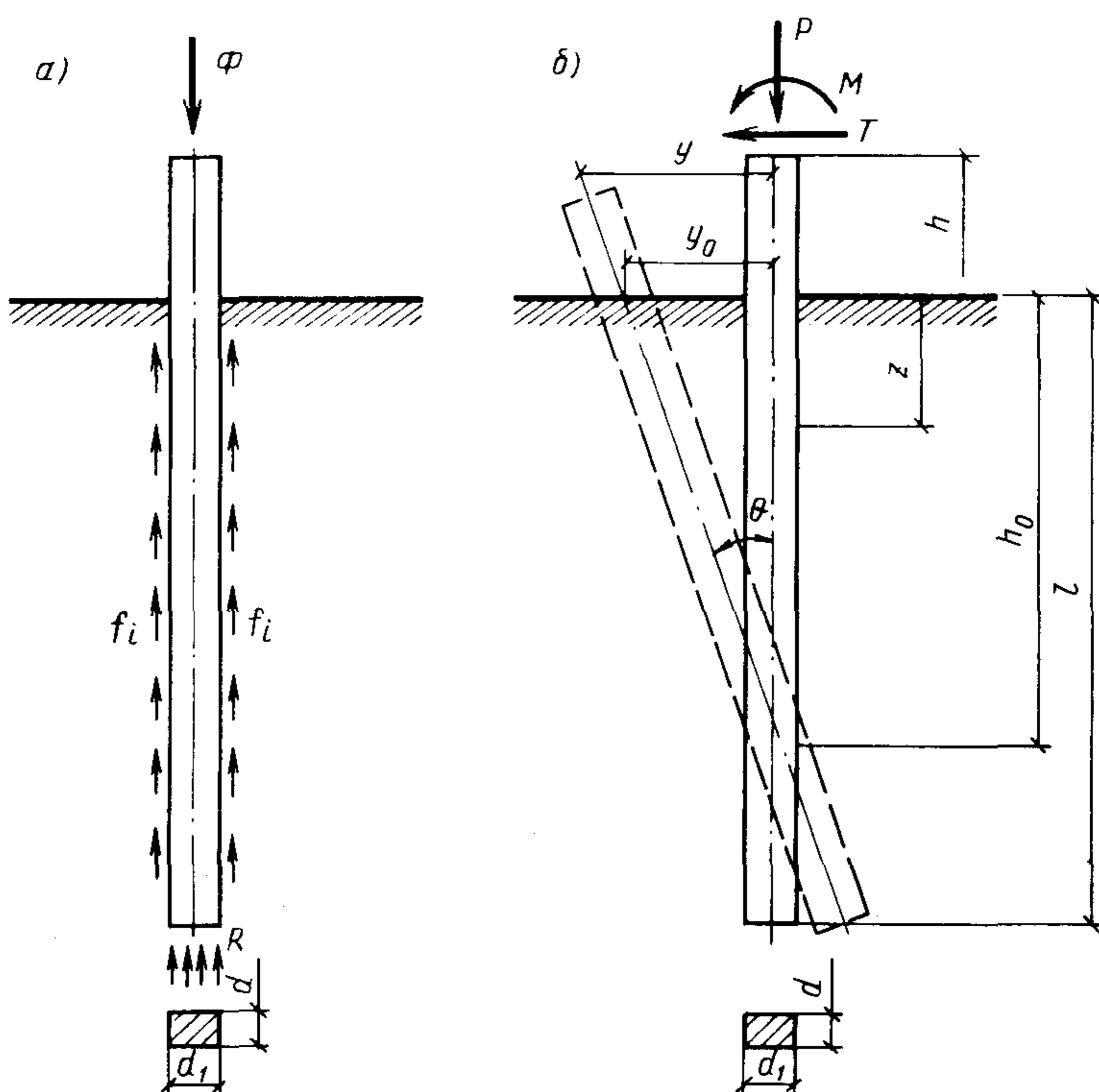
Рис. 3. Расчетные схемы микросвайных фундаментов теплиц
