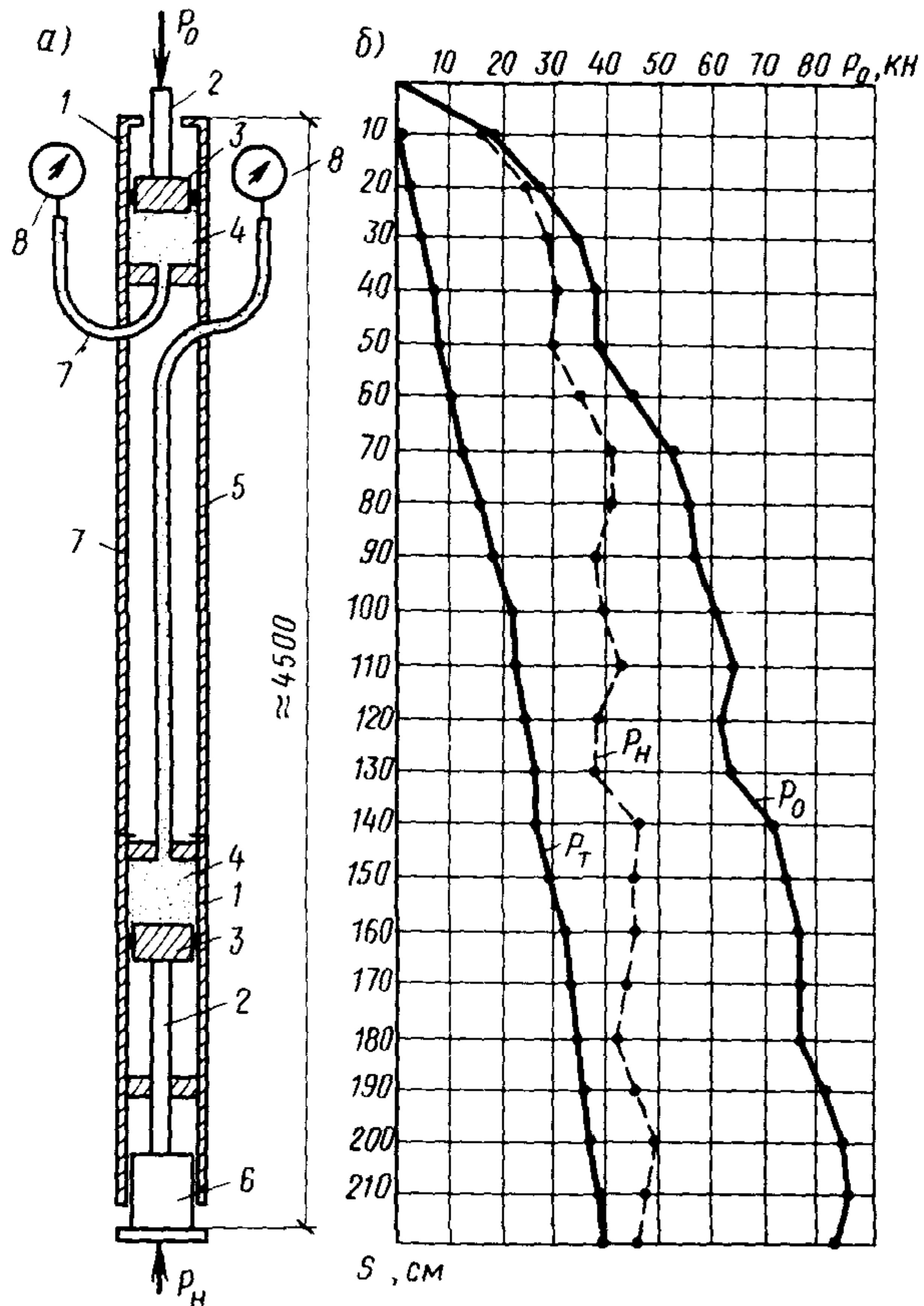
**Рис. 4. Свай – штамп и ходограммы ее нагружения**
