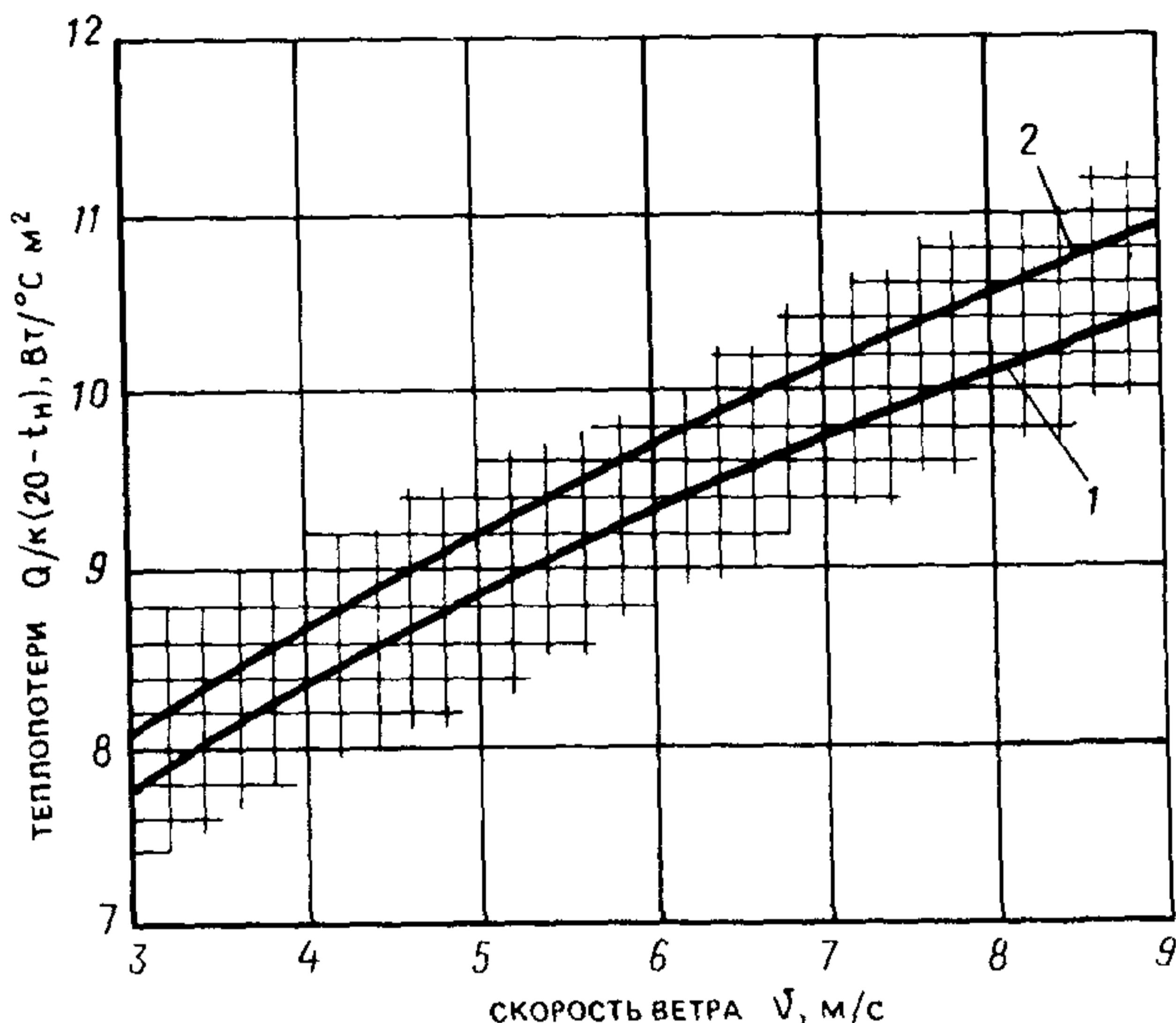
Рис. 21. График для определения теплопотерь теплицы с комбинированной системой обогрева при максимальной мощности калориферного обогрева
