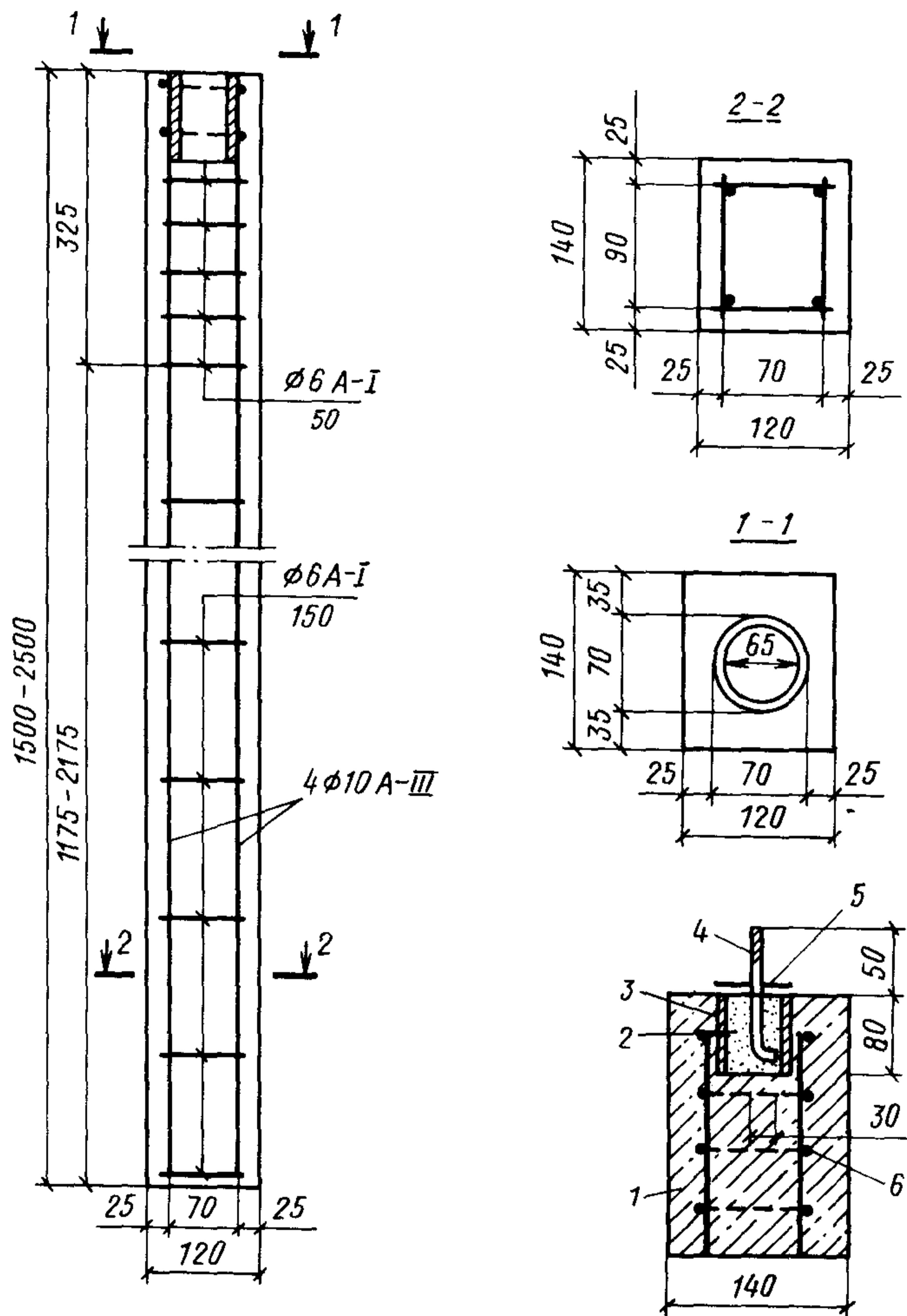
**Рис. 1. Пример конструктивного решения свайного фундамента**
