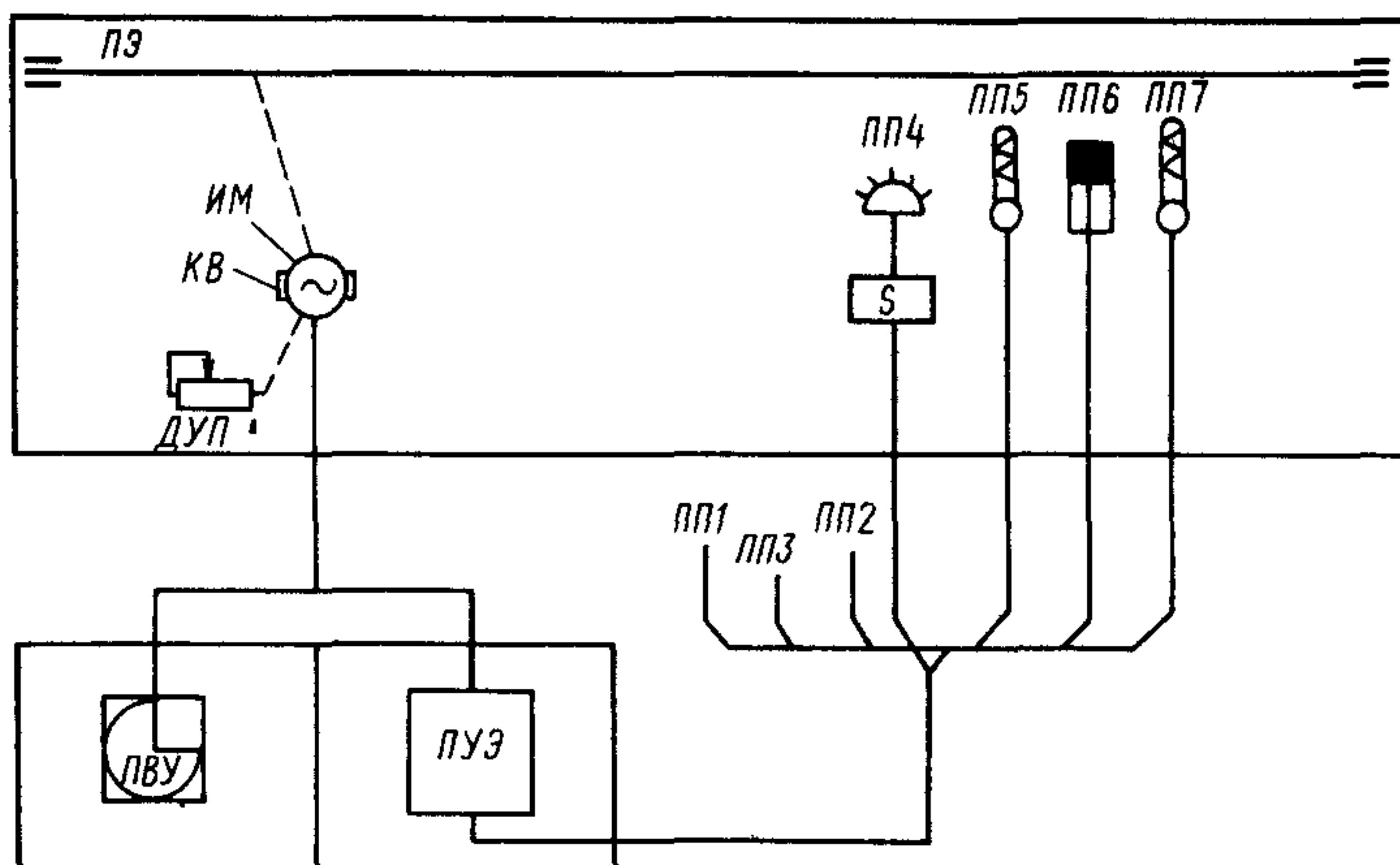
Рис. 10. Технологическая схема управления теплозащитным экраном
