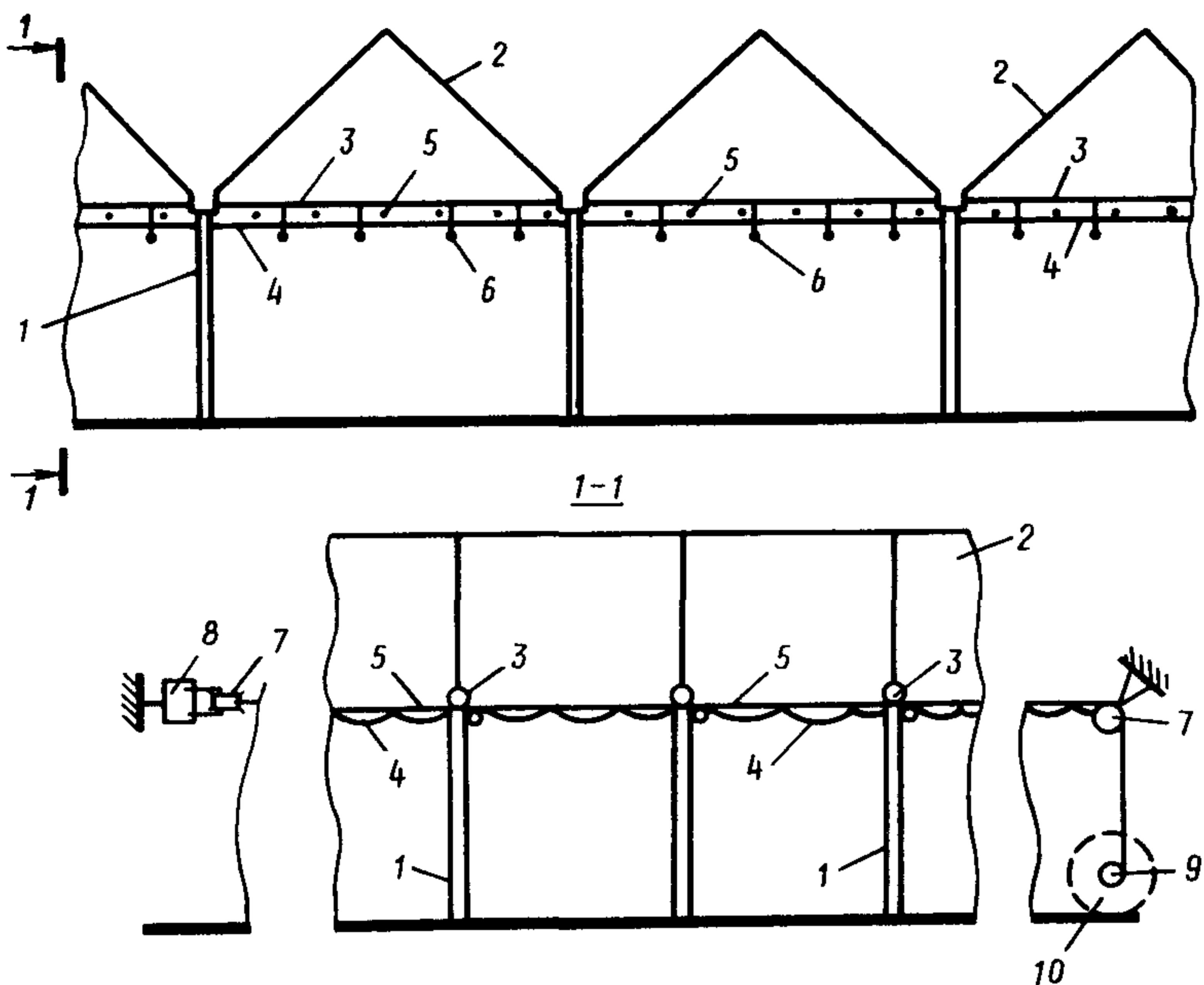
**Рис. 7. Вариант схемы системы экранирования в многопролетной теплице**
