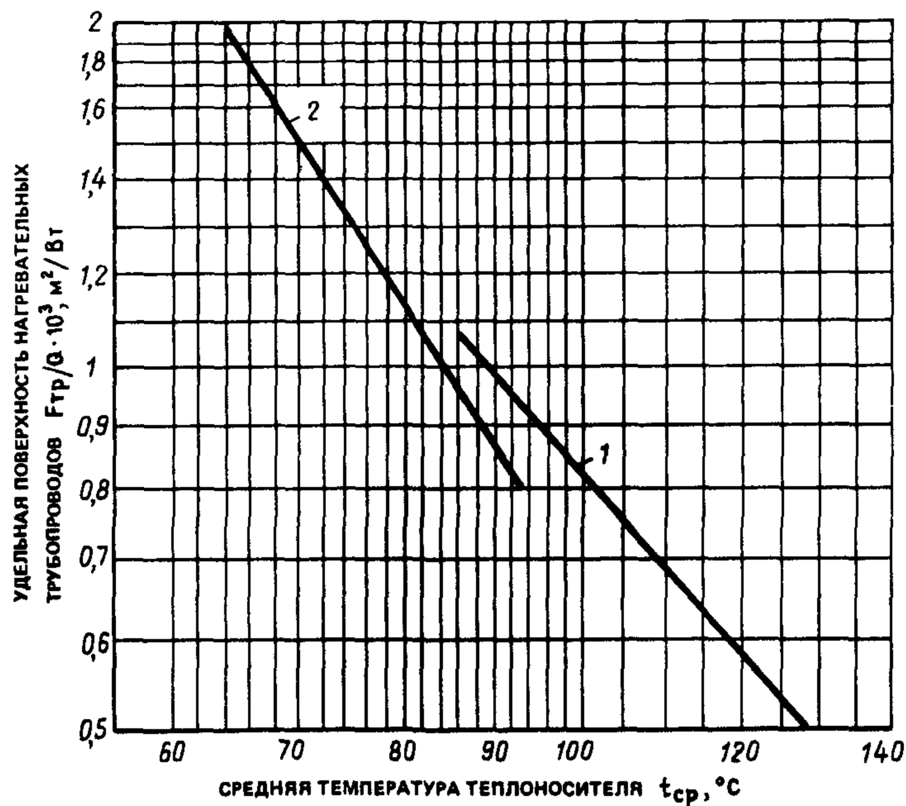
Рис. 13. График для определения требуемой поверхности нагревательных трубопроводов
