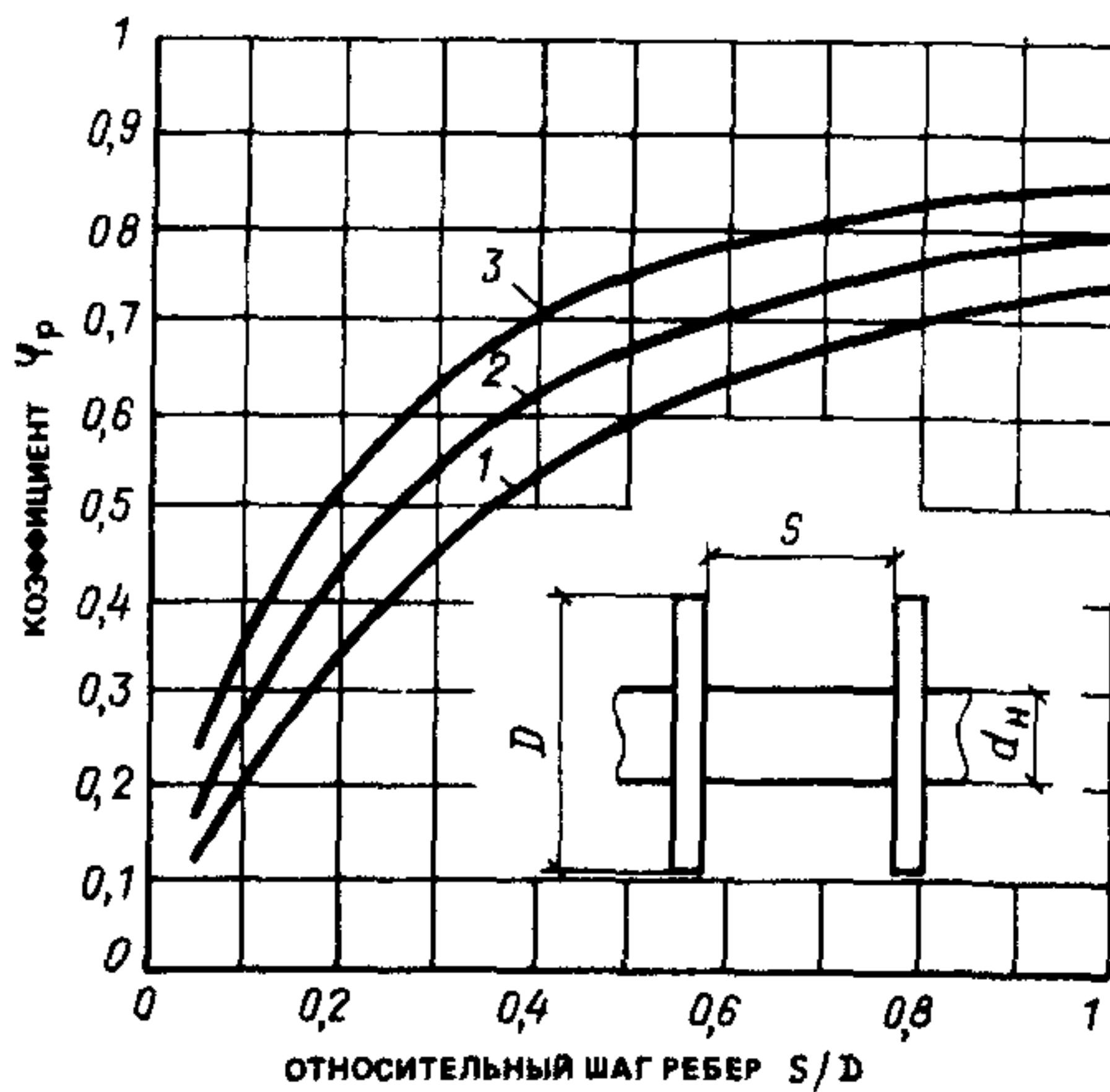
Рис. 18. График для определения коэффициента  $\varphi_p$
