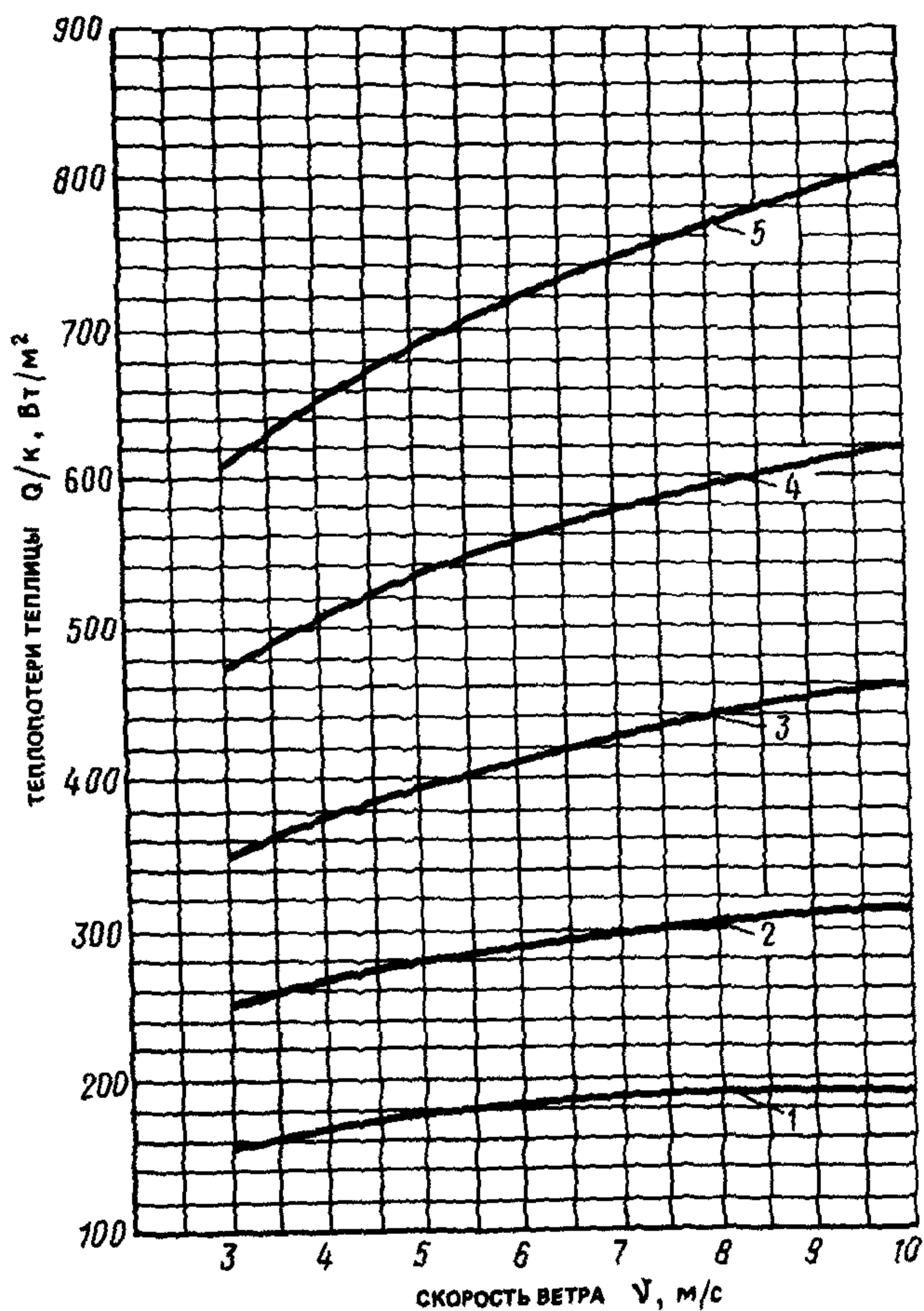
**Рис. 12. График для определения теплопотерь теплицы**
