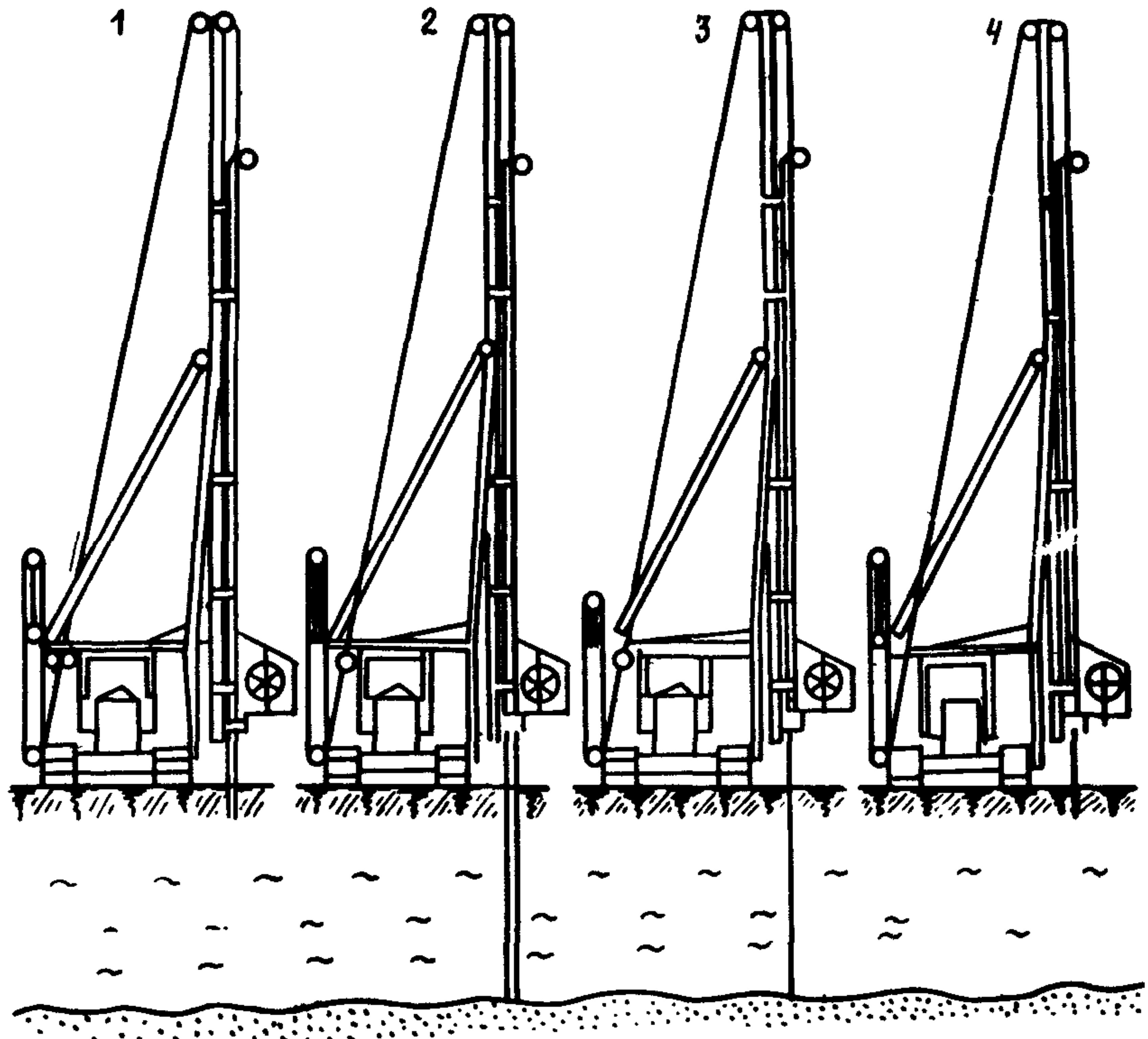
Рис.4. Технология погружения дрены:
