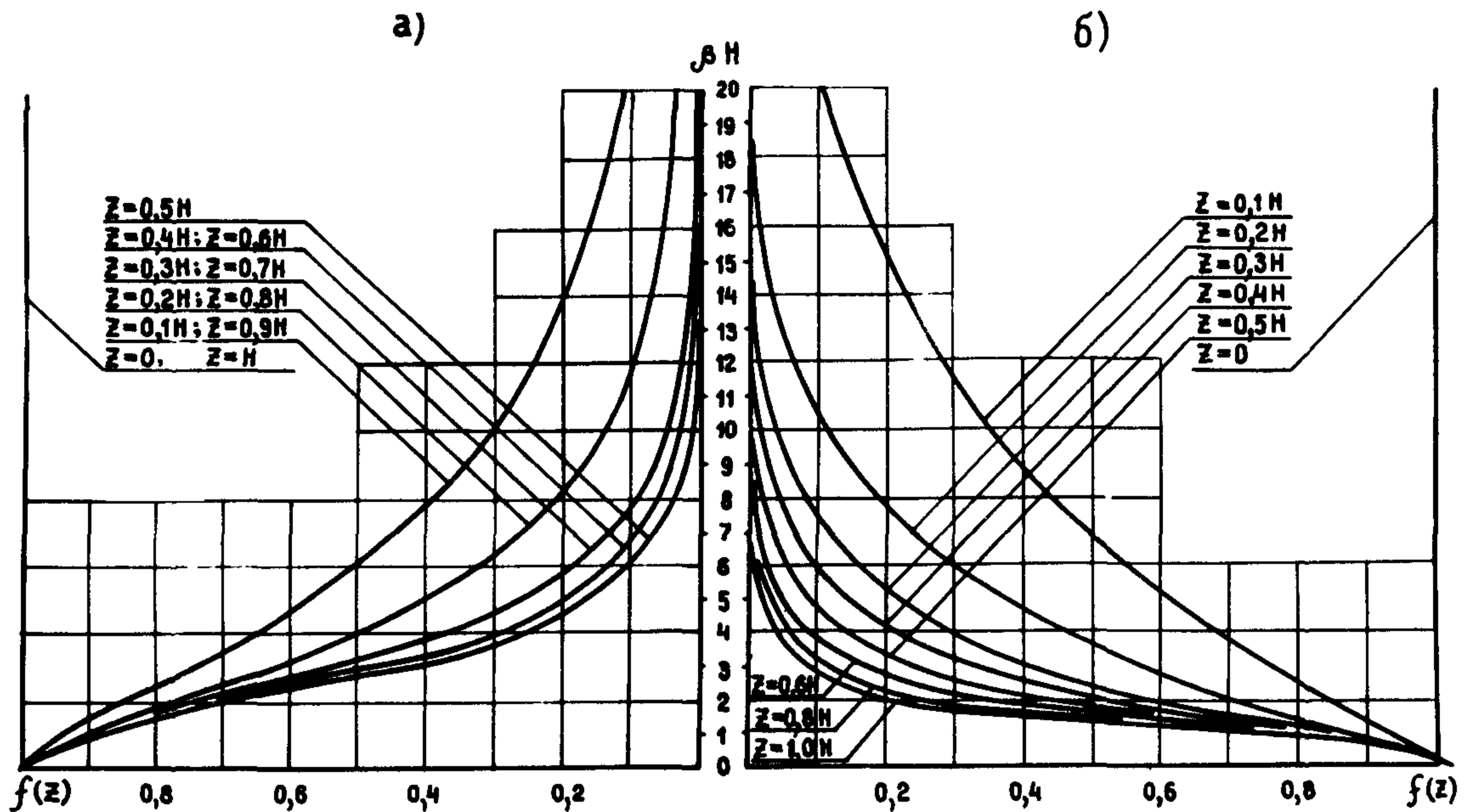
Рис.2. График для определения  $f(z)$  при двустороннем (а) и одностороннем (б) отводе воды из дрены
