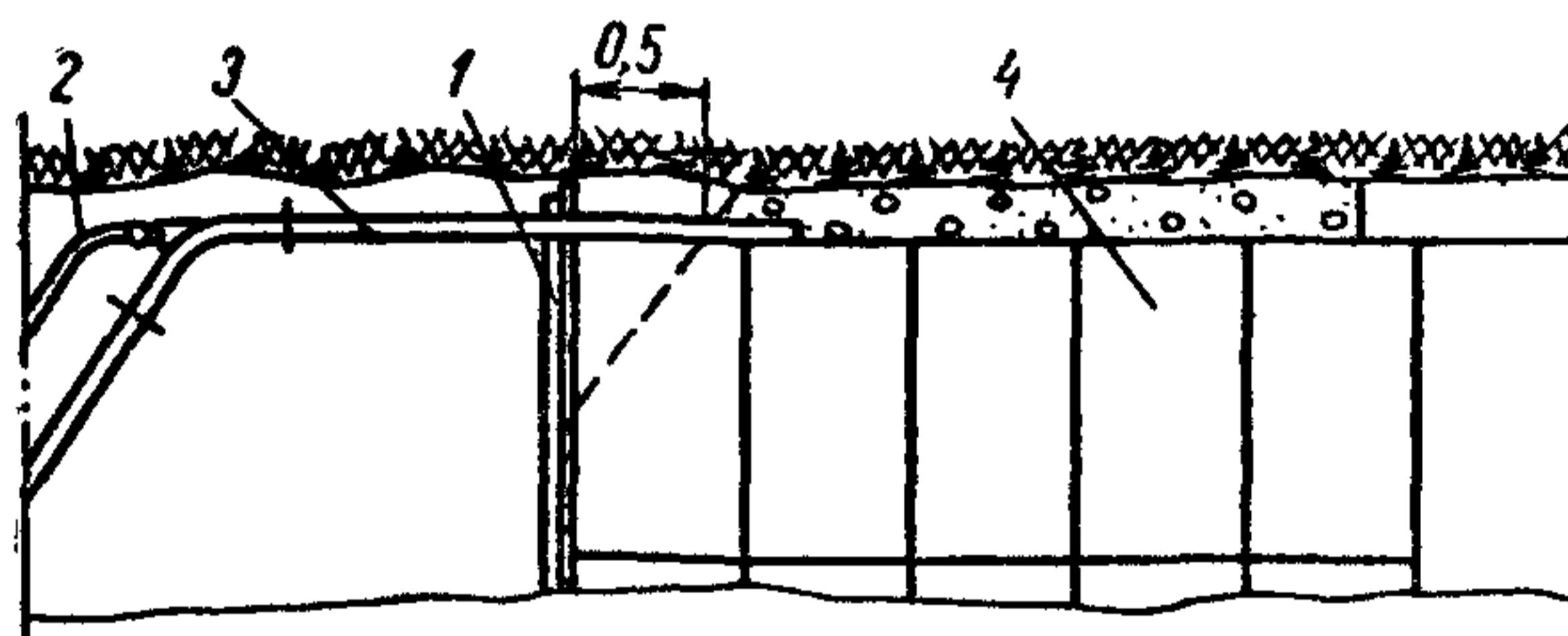
Рис. 17. Укладка бетонной смеси в свод обделки:
