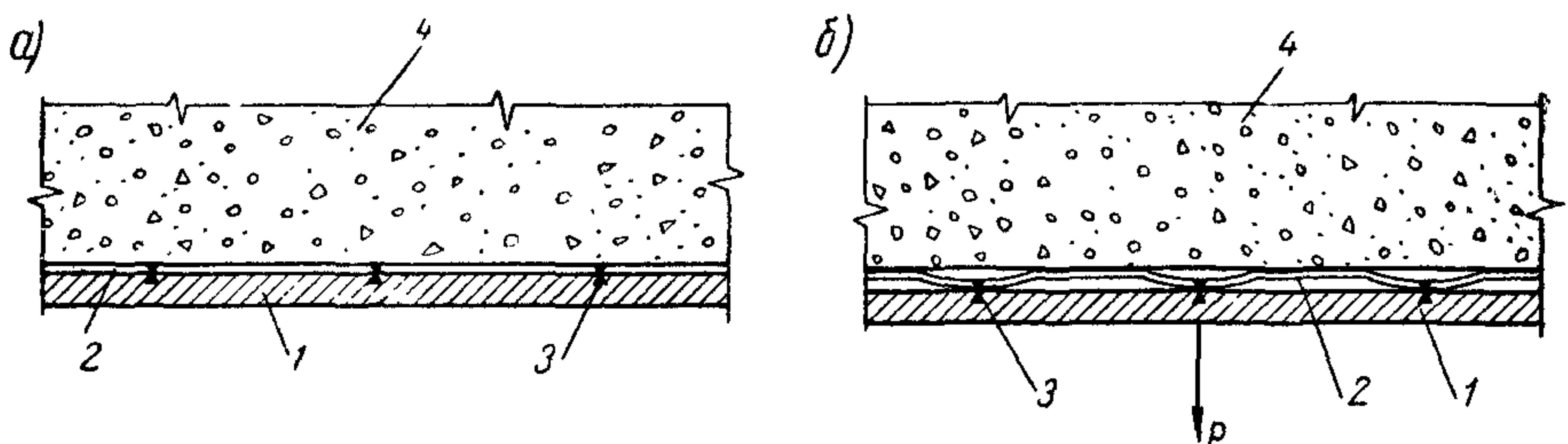
Схема конструкции опалубки с упругим покрытием:
