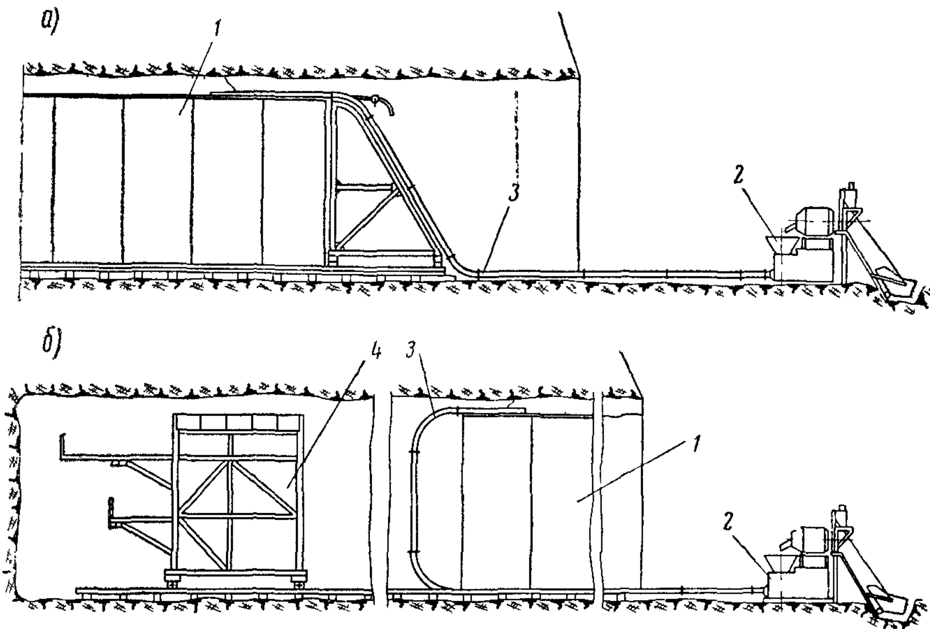
Технологическая схема возведения обделки при стационарном расположении бетоноукладочной установки:
