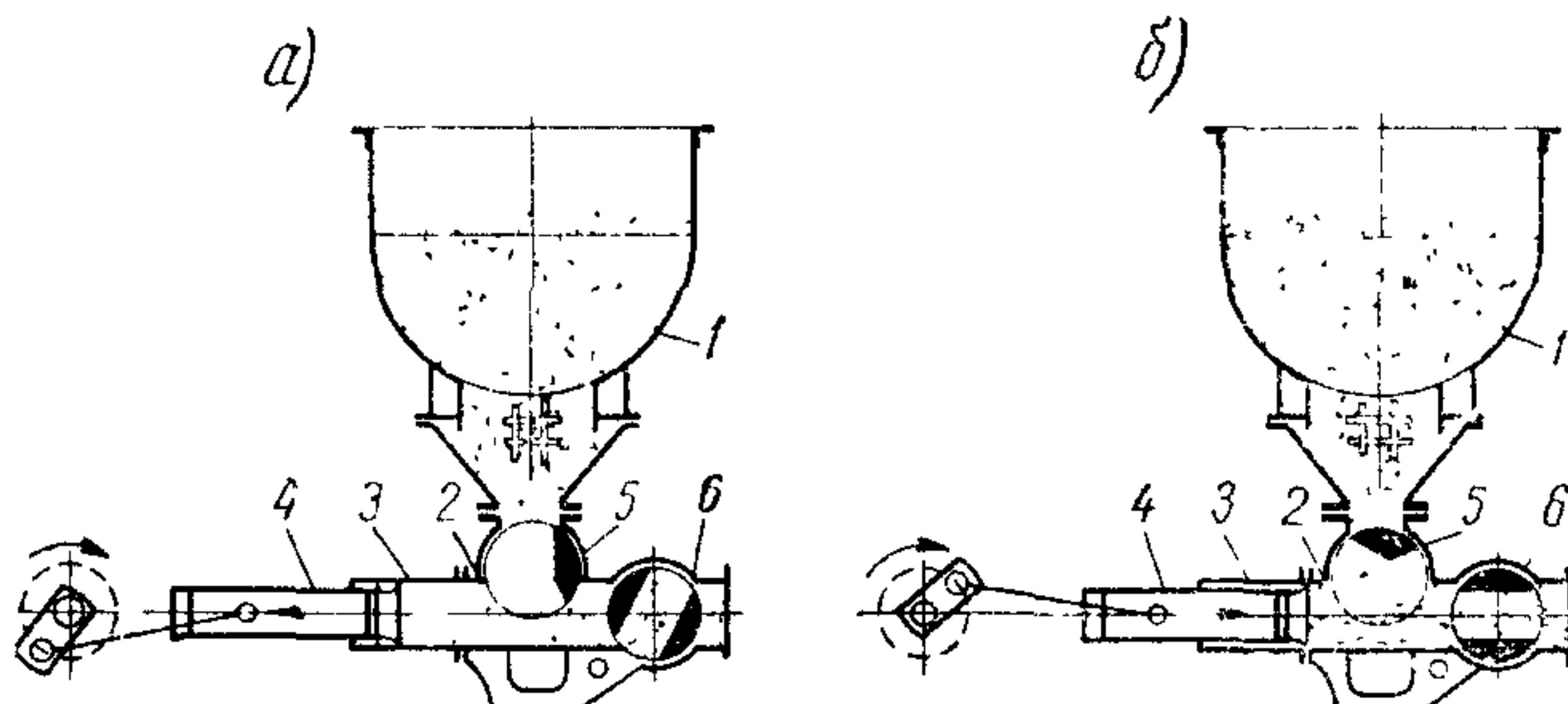
Принцип действия бетононасоса С-296:
