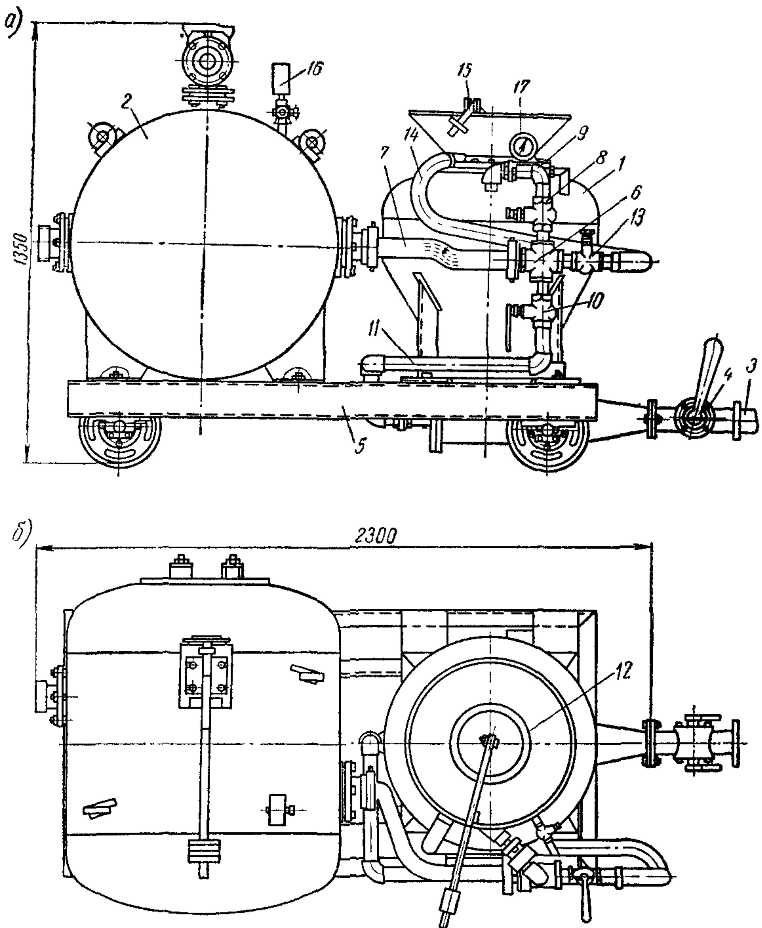
Рис. 4. Общий вид пневматической установки С-862:
