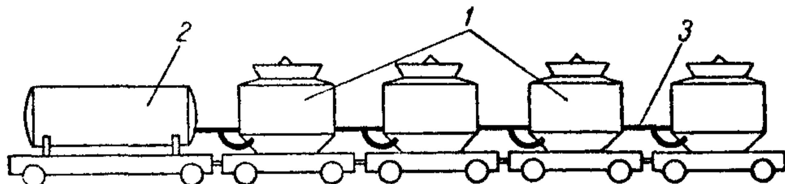
Рис. 13. Транспортирование бетонной смеси в тоннель в передвижных пневмобетононагнетателях:
