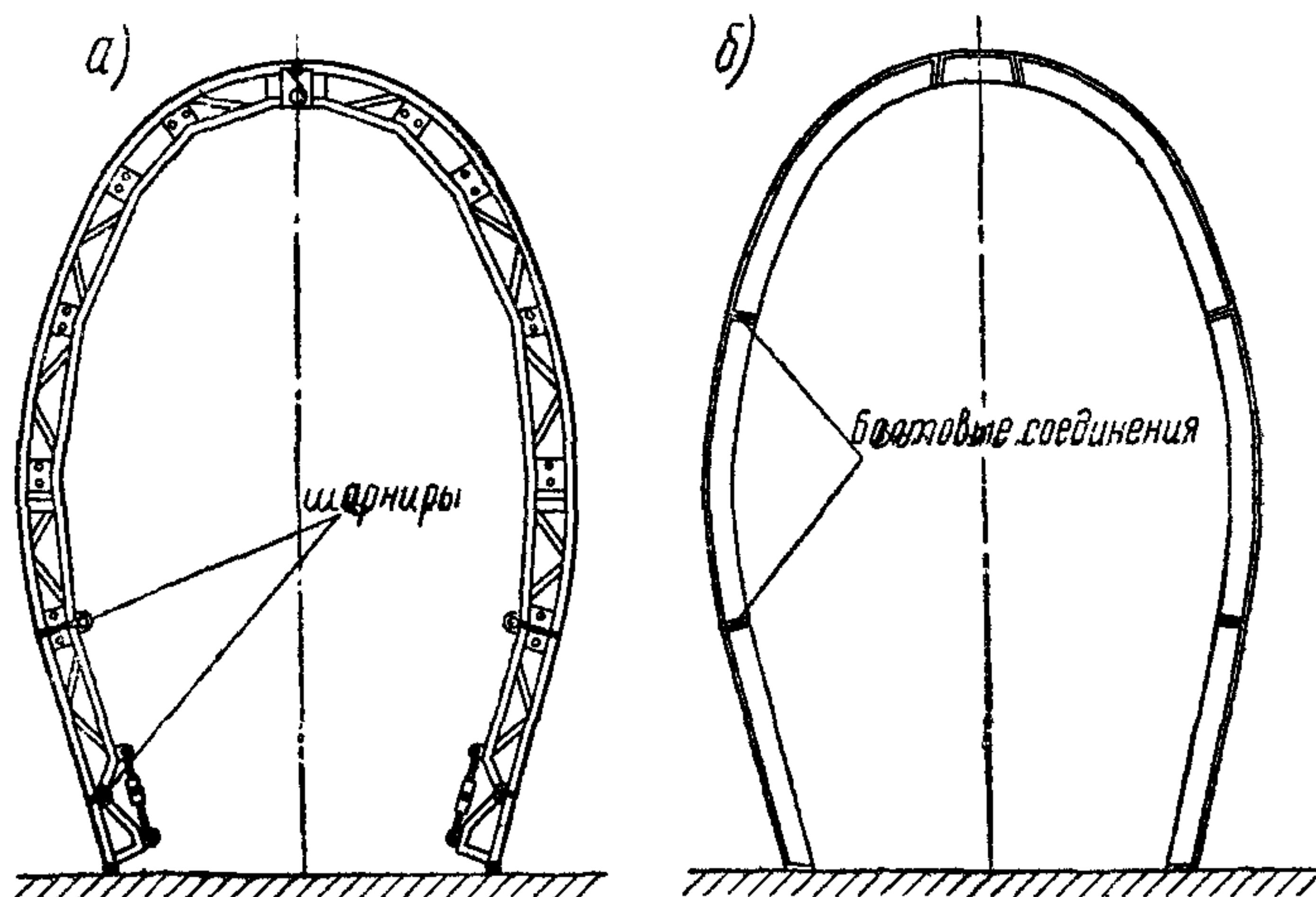
Рис. 1. Типы опалубочных секций:
