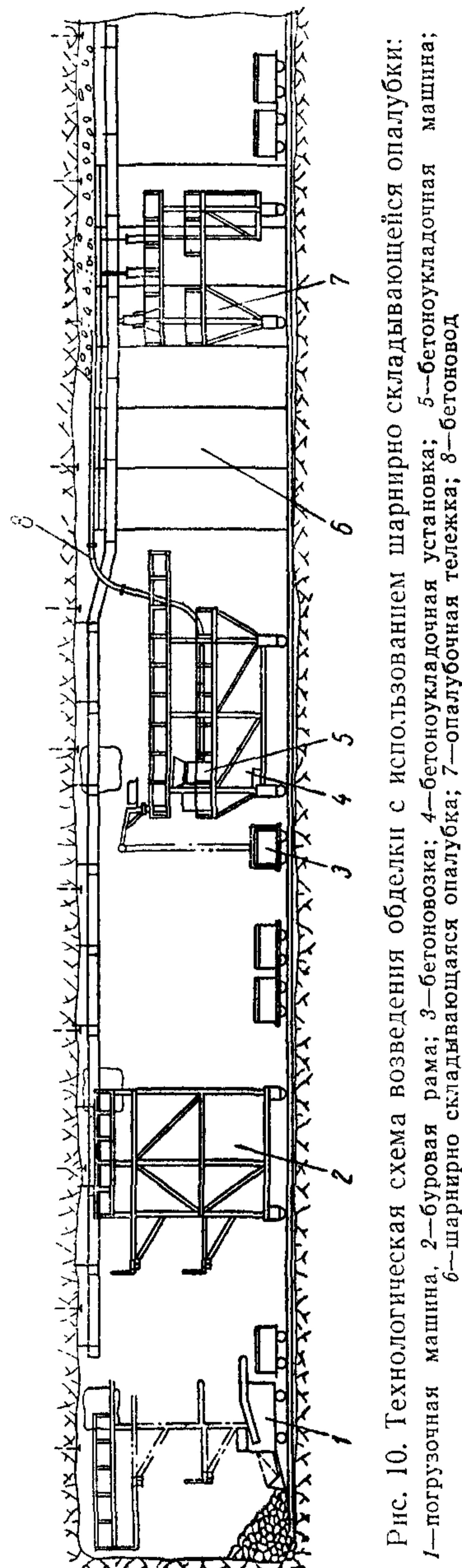
Рис. 10. Технологическая схема возведения обделки с использованием шарниро складывающейся опалубки:
