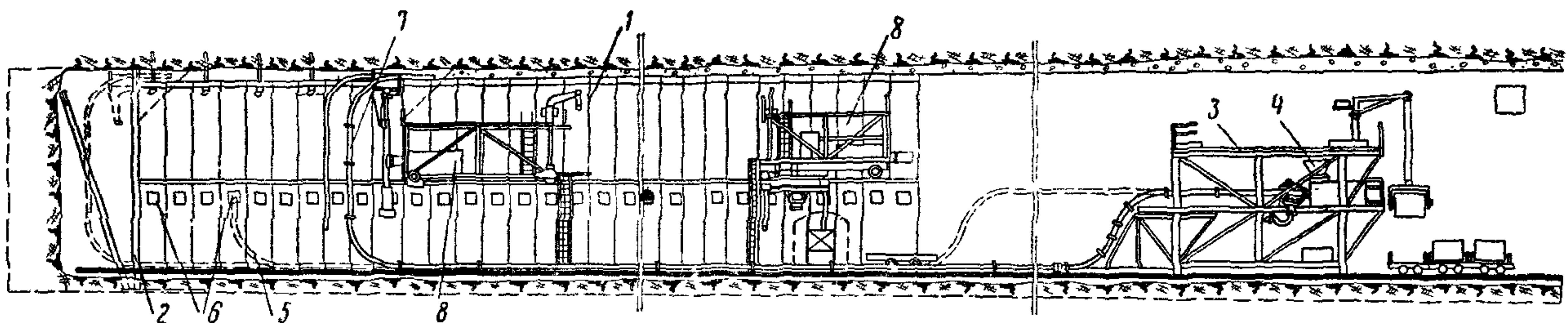
Рис. 12. Технологическая схема возведения обделки с применением сборно-разборной опалубки у забоя:
