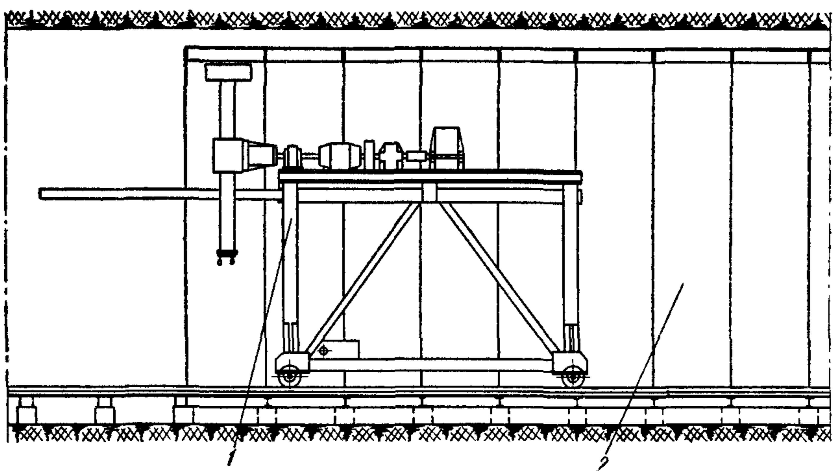
Рис. 3. Снятие и установка элементов сборно-разборной опалубки при помощи одного перестановщика:
