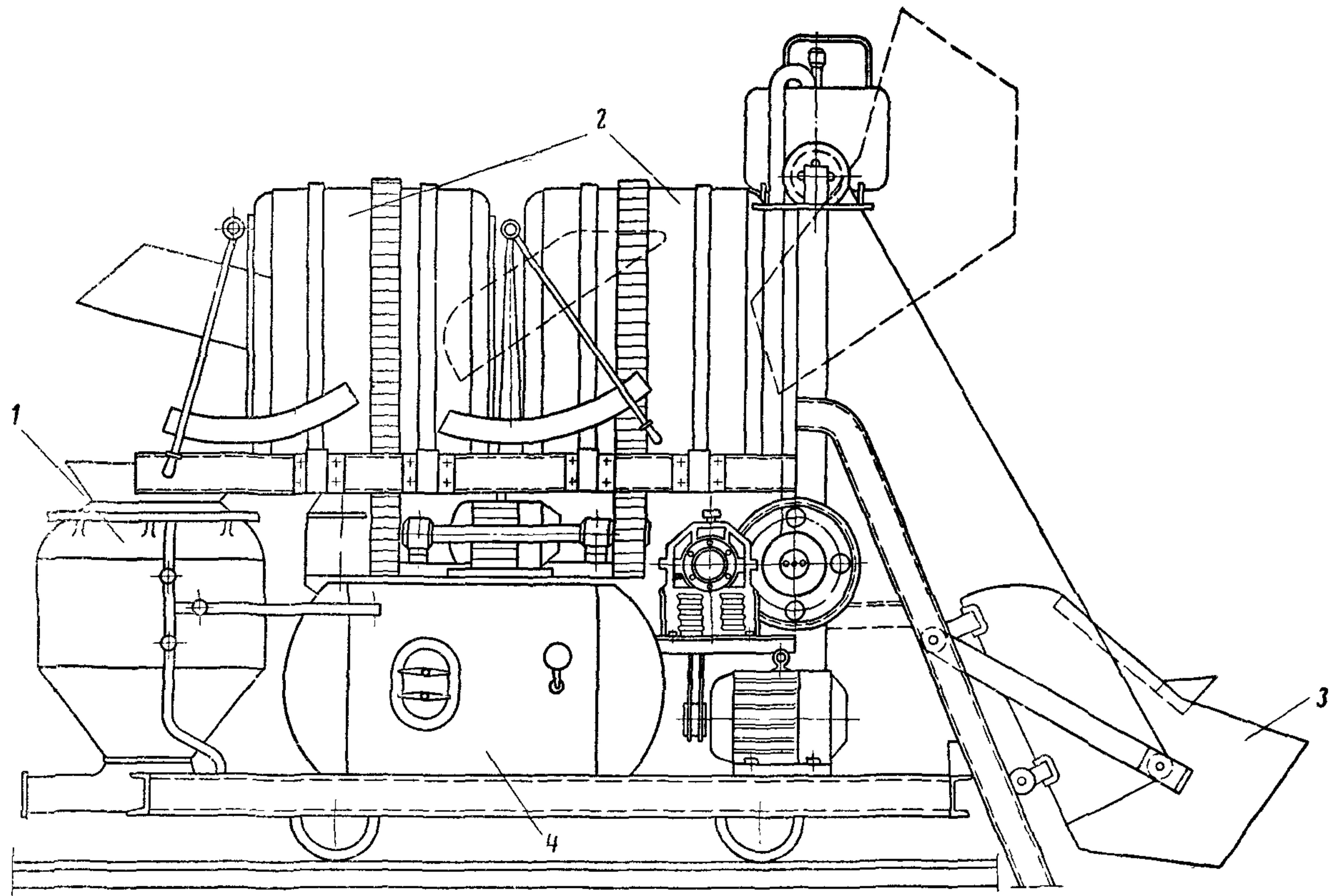
Рис. 2. Бетоноукладочный агрегат с пневмобетононагнетателем:
