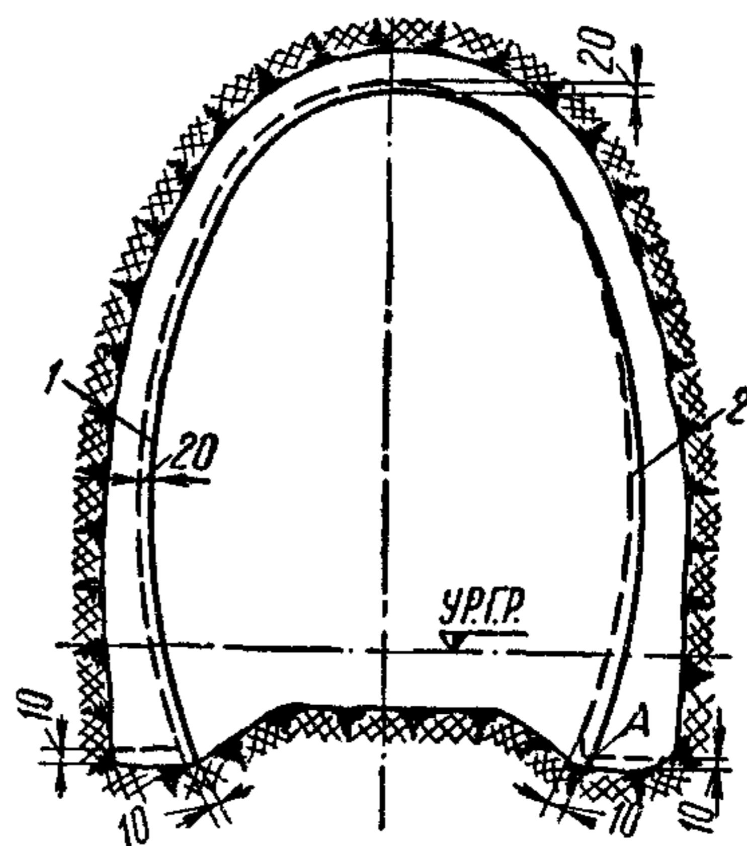
Рис. 15. Допускаемые отклонения в мм установленной сборно-разборной опалубки от проектного положения:
