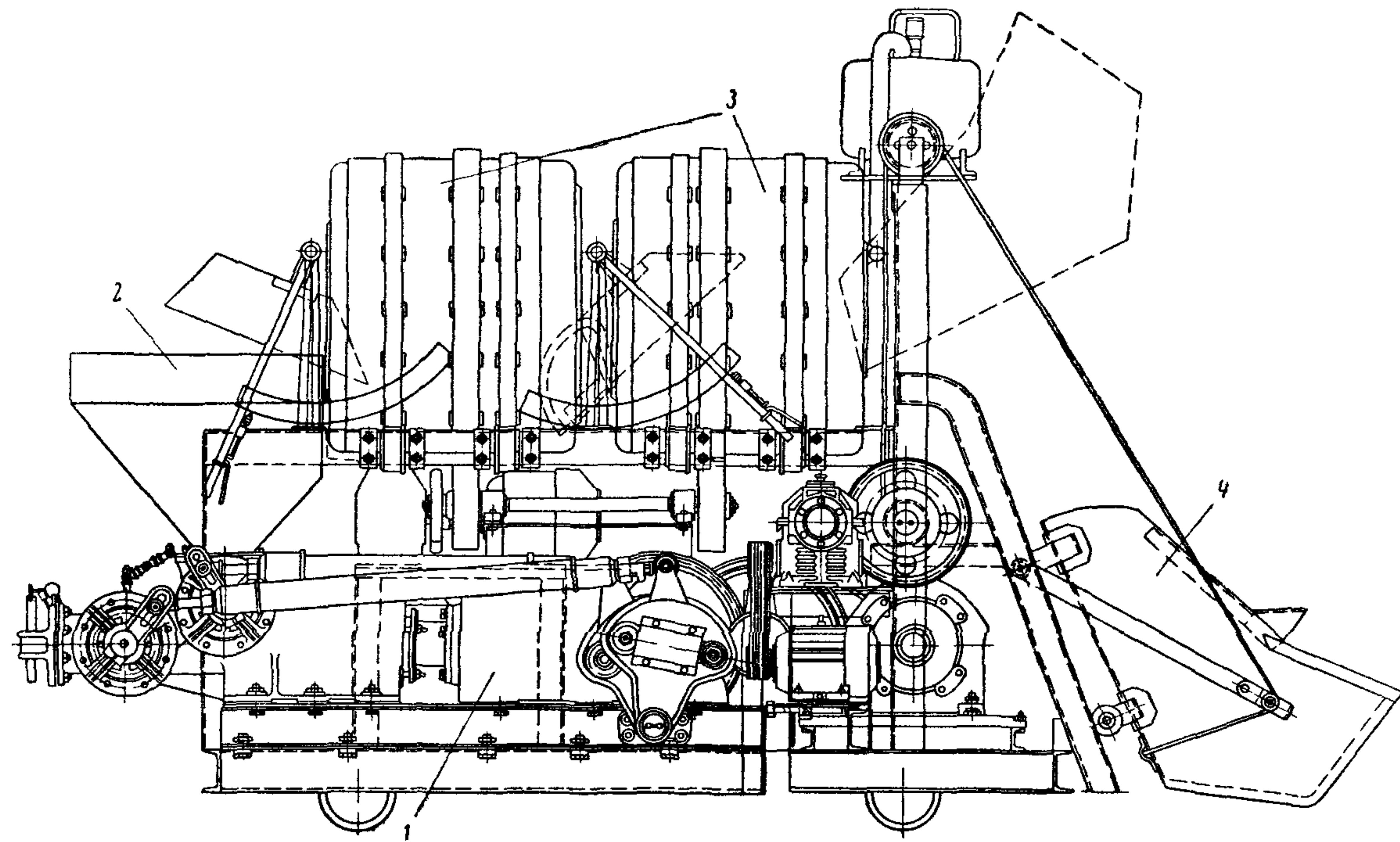
Рис. 1. Бетоноукладочный агрегат с бетононасосом:
