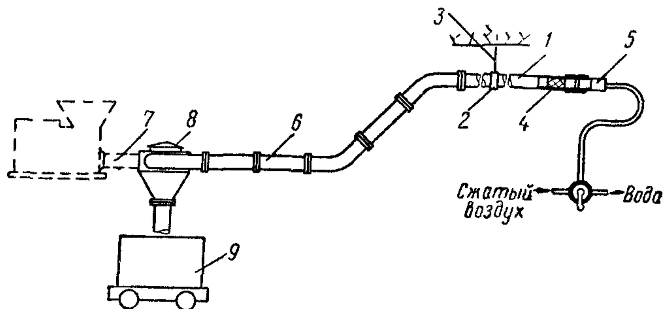
Рис. 18. Схема очистки и промывки бетоновода:
