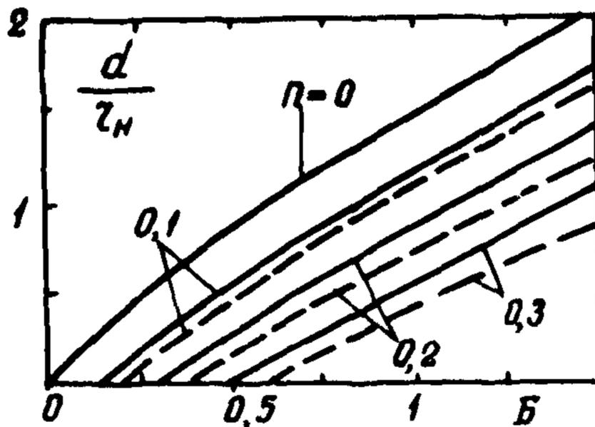
График зависимости  $d/z_H$  от параметров  $Б, n$  и  $d$  при  $A=0$ . Сплошными линиями показаны зависимости при  $d=20$ , пунктирными - при  $d=40$
