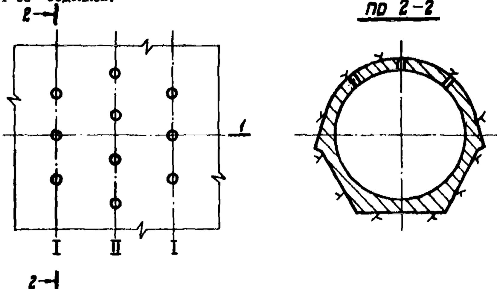
Черт. 1. Схема расположения цементационных скважин при **заполнительной** цементации за монолитную обделку: 1 - ось свода;
