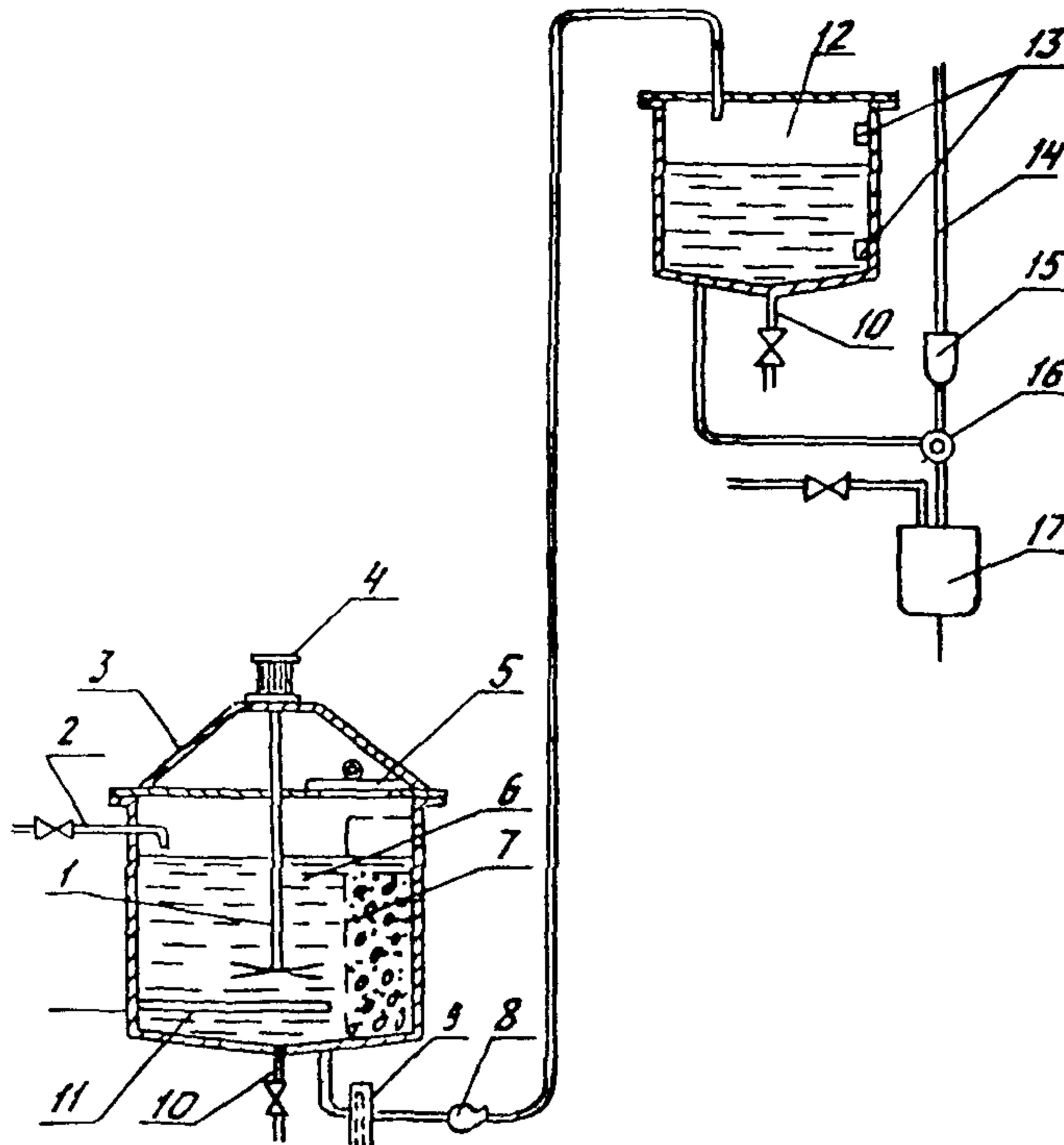
Схема установки для приготовления водных растворов химических добавок:
