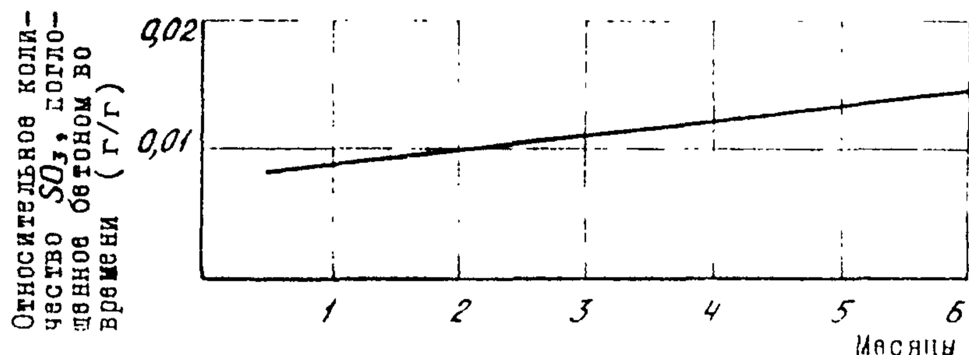
Эталонная кривая поглощения цементным бетоном ионов  $SO_4^{2-}$  в пересчете на  $SO_3$
