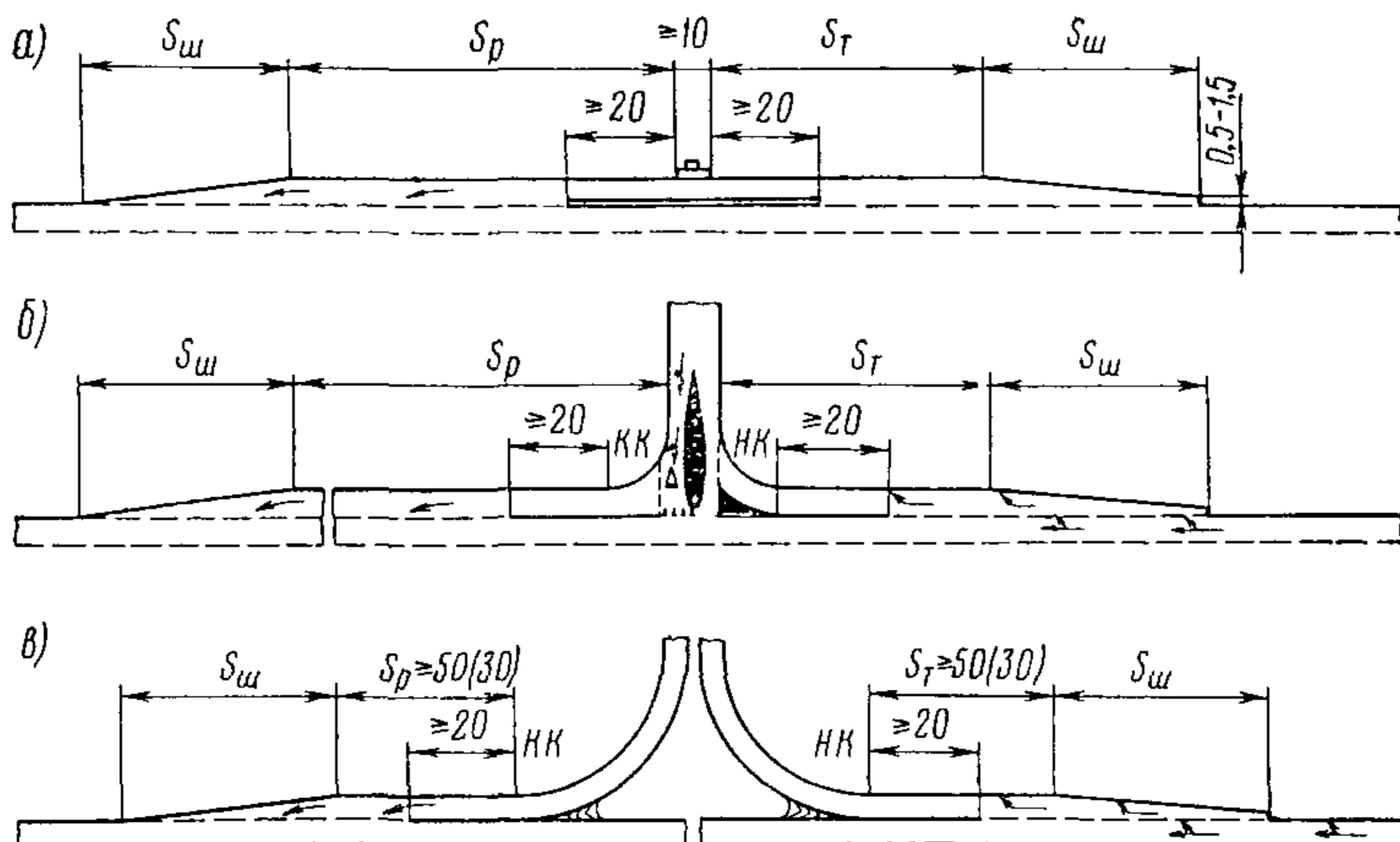
Рис. 15. Схемы переходно-скоростных полос:
