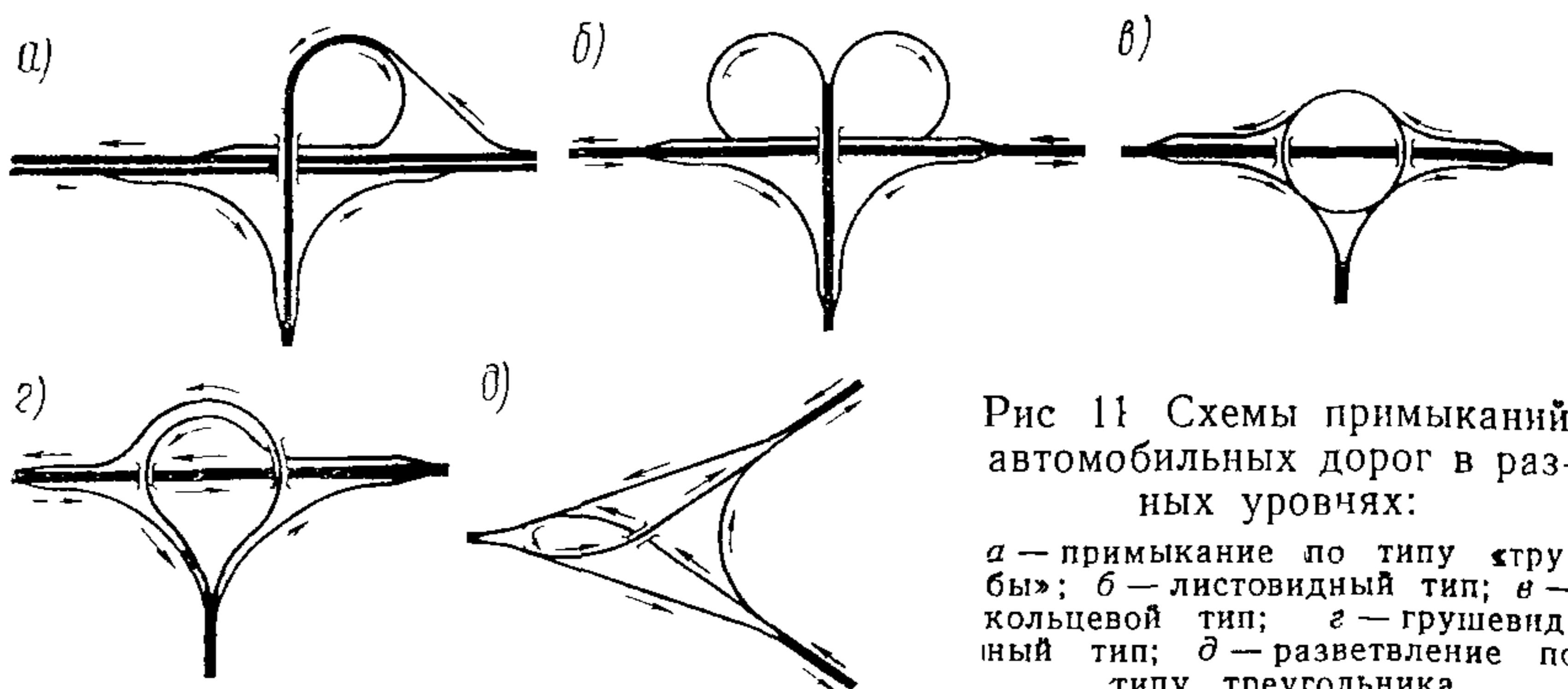
Рис 11 Схемы примыканий автомобильных дорог в разных уровнях:
