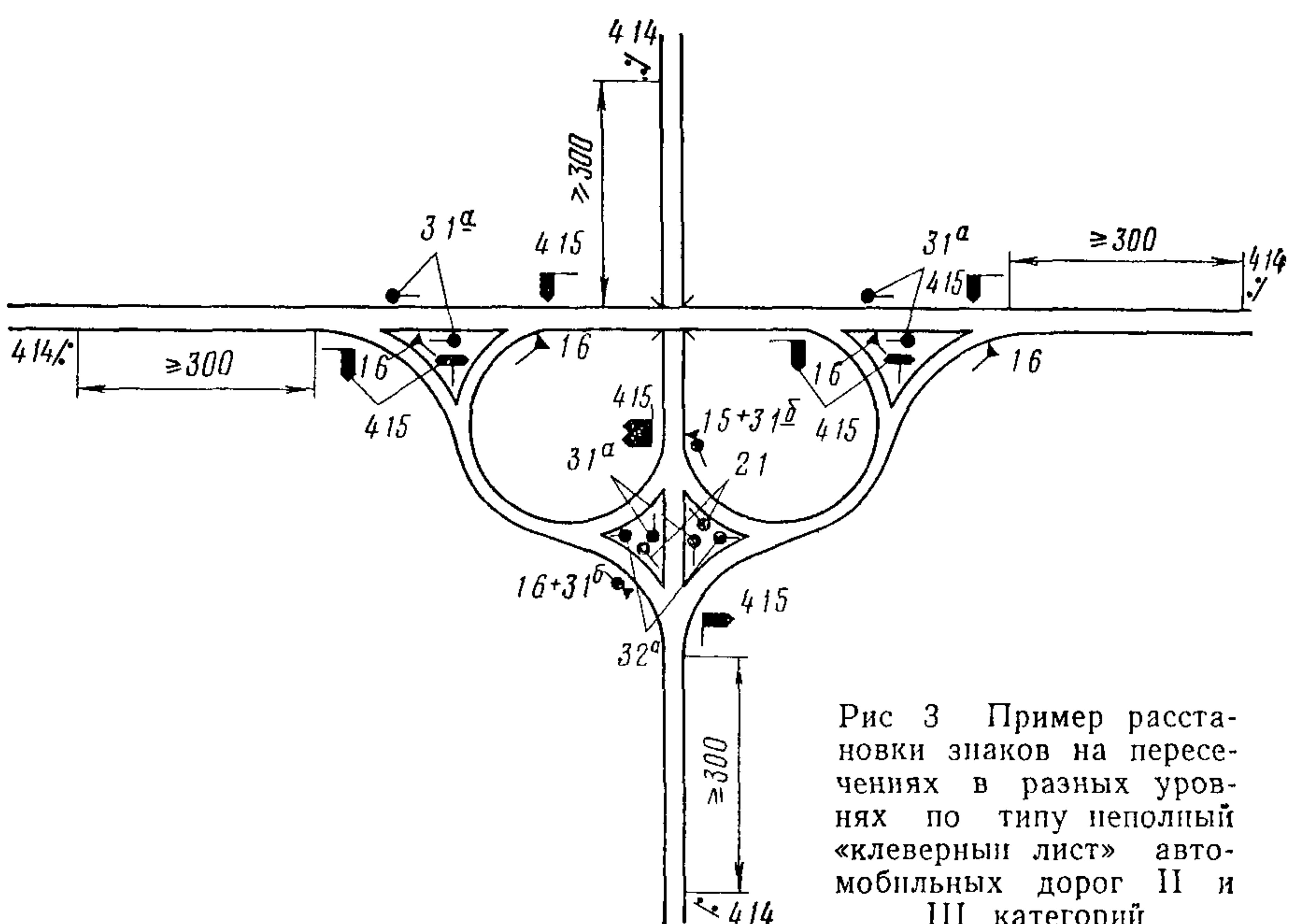
Рис 3 Пример расстановки знаков на пересечениях в разных уровнях по типу неполный «клеверный лист» автомобильных дорог II и III категорий
