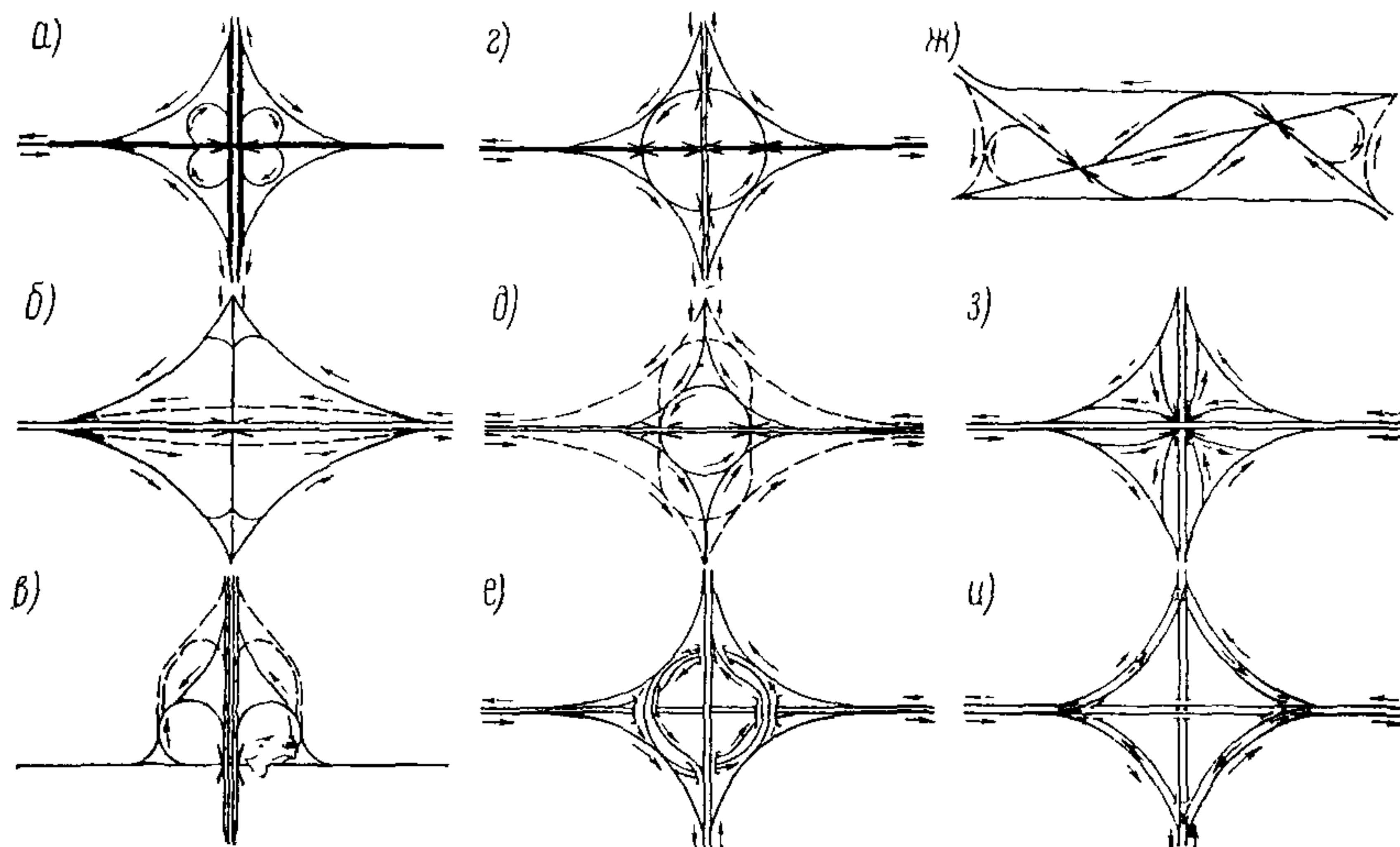
Рис. 10. Схемы пересечений автомобильных дорог в разных уровнях
