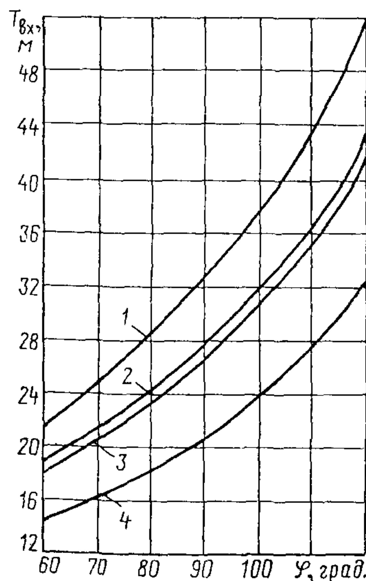
Рис. 2 Зависимость величины тангенса  $T_{вх}$  начала входной кривой от угла поворота  $\phi$  на съездах для различных категорий дорог
