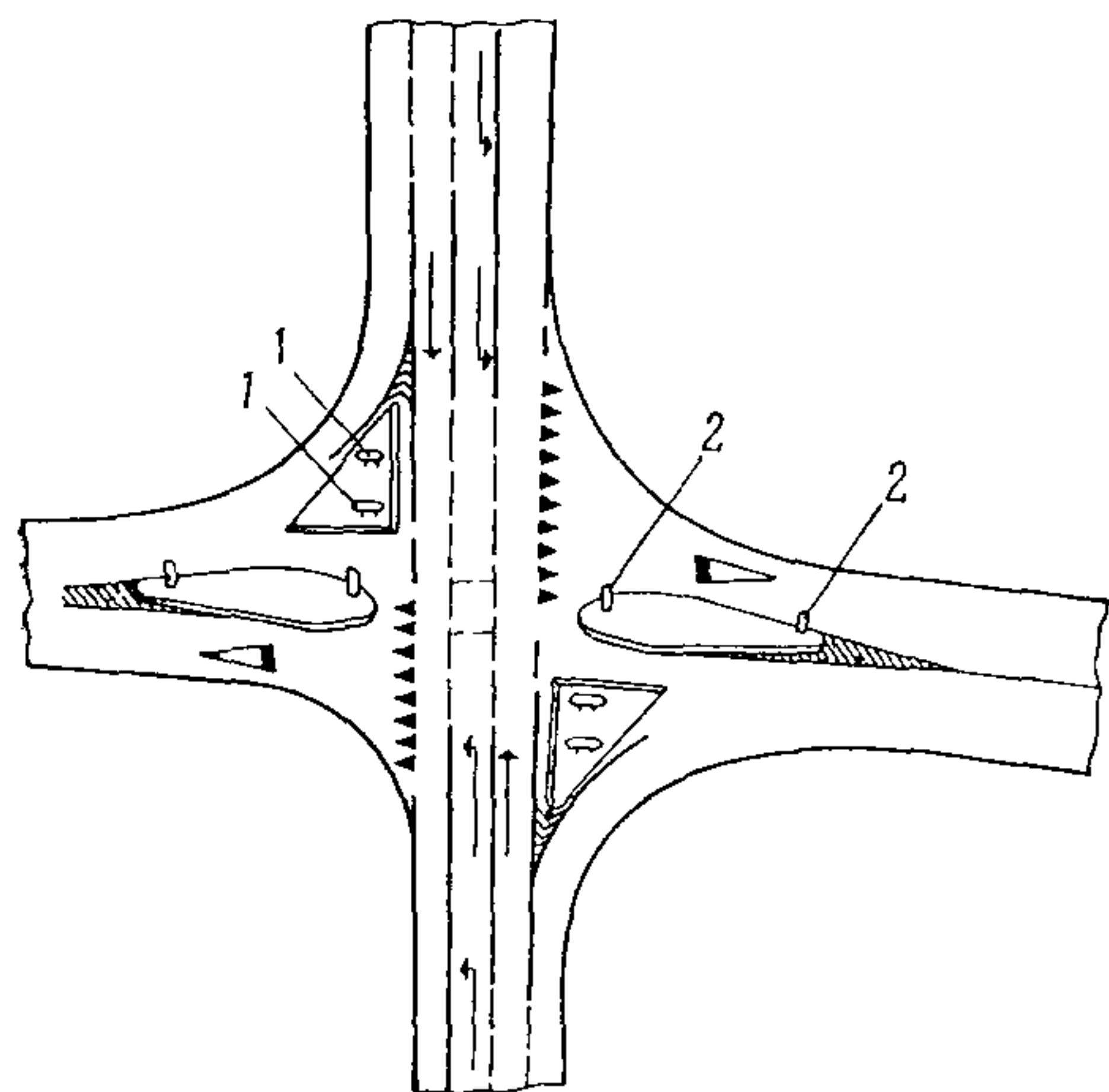
Рис. 9. Пример расположения указательных знаков на треугольных и каплевидных островках:
