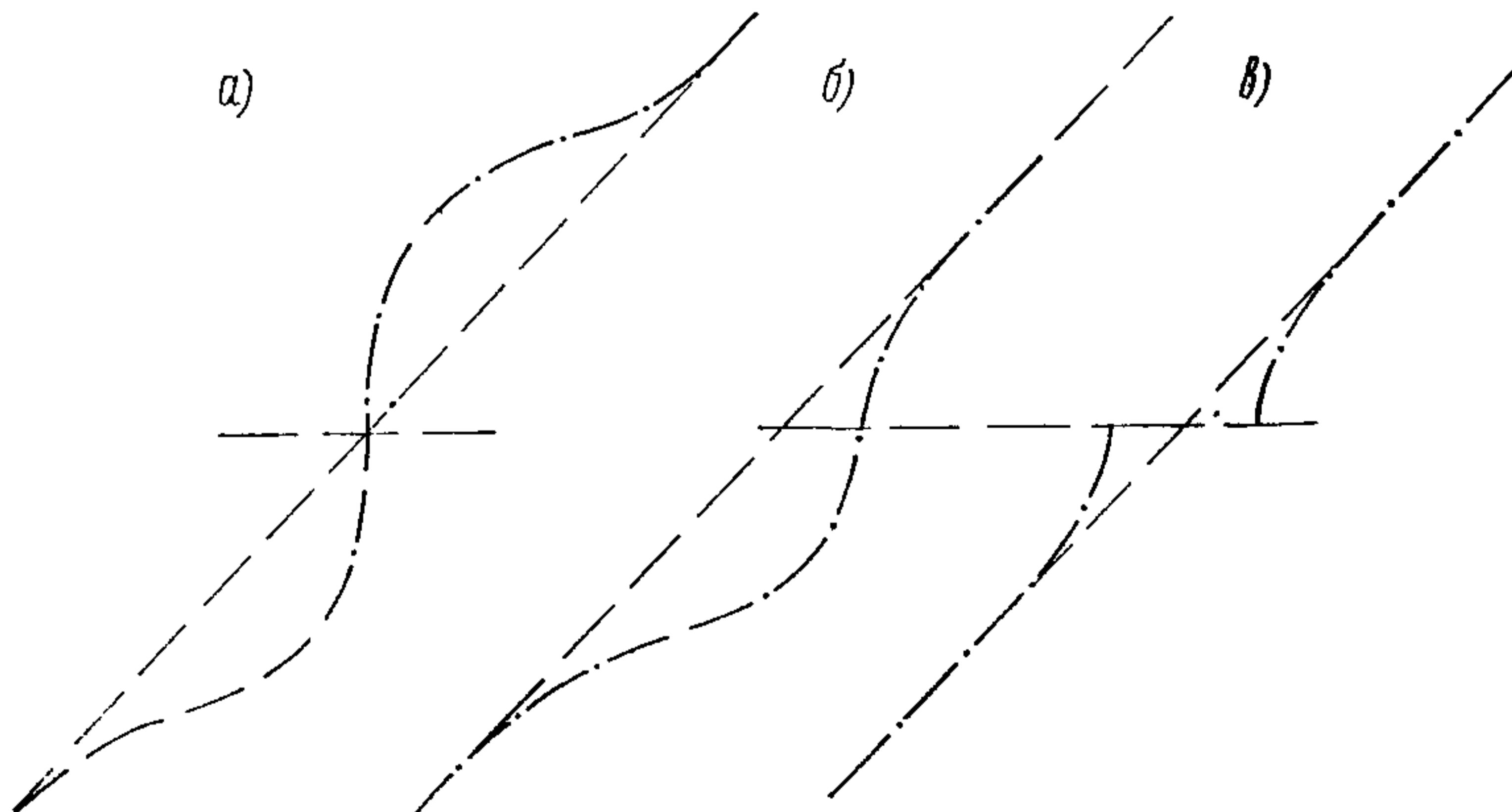
Рис. 1. Спрямление угла пересечения дорог:
