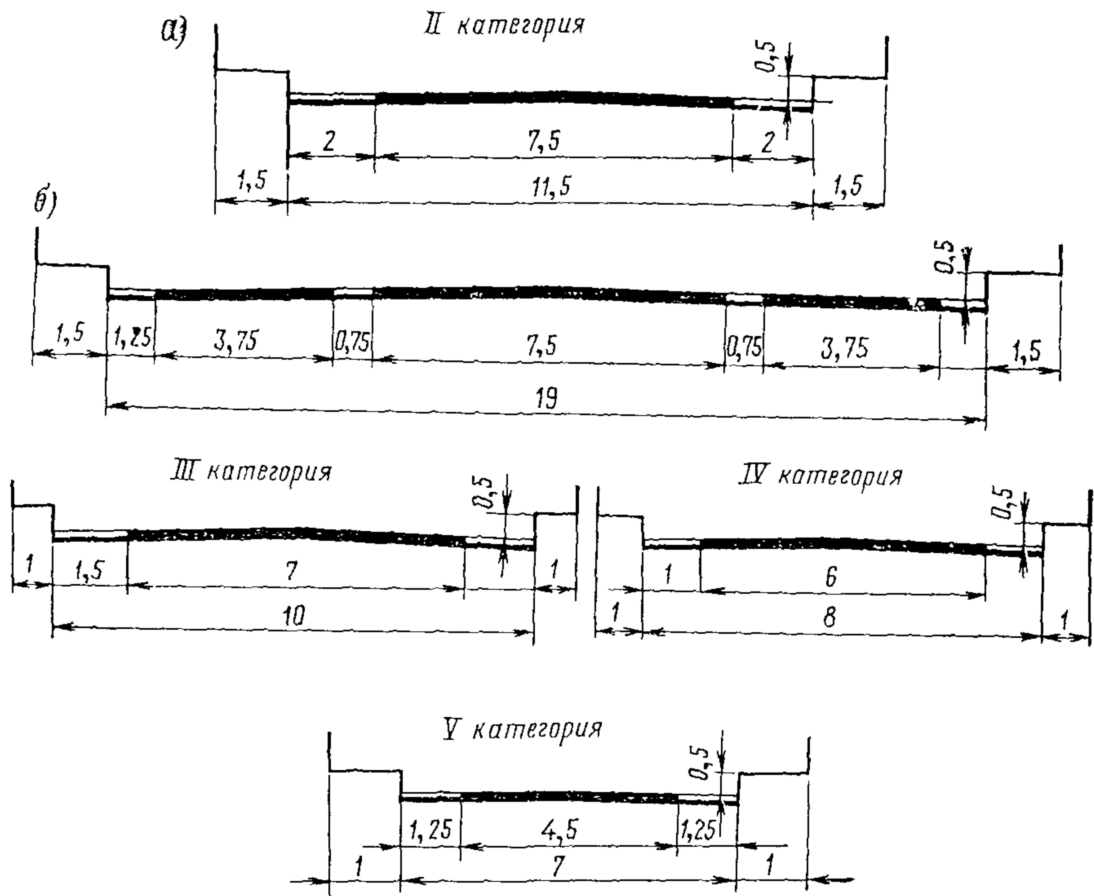
Рис 13 Схемы поперечных сечений путепроводов для дорог II—V категорий:
