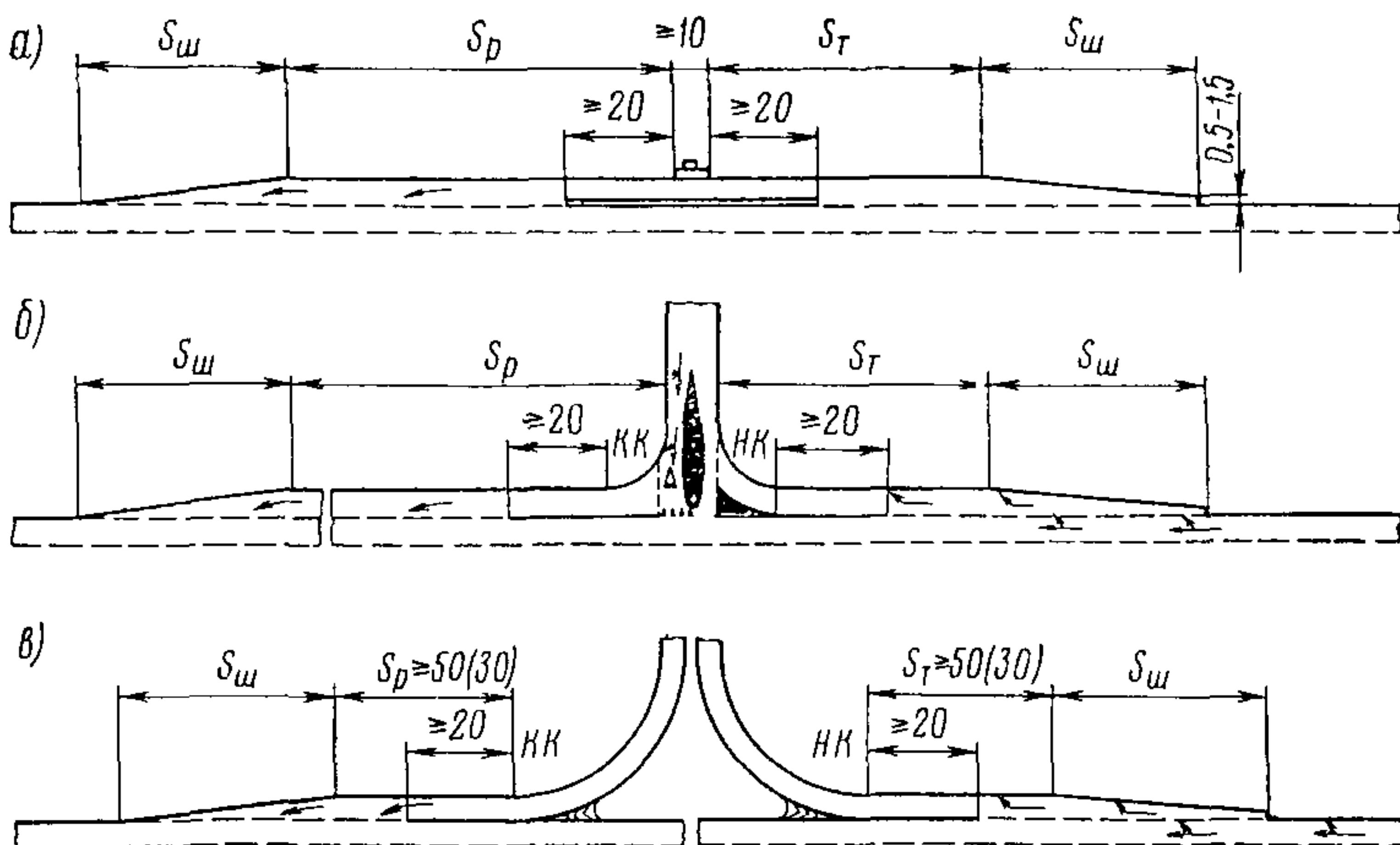
Рис. 15. Схемы переходно-скоростных полос:
