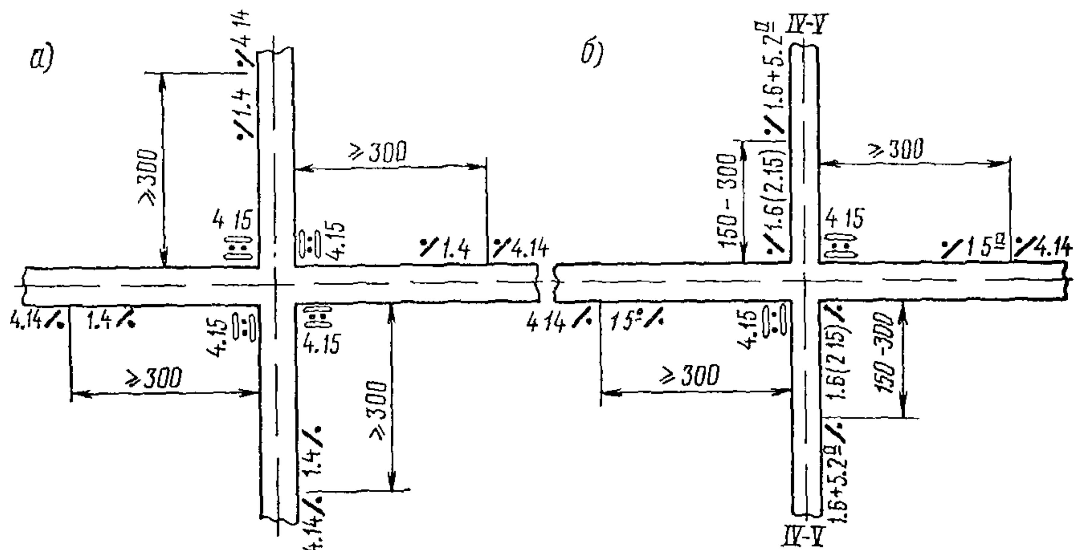
Рис. 1 Пример расстановки знаков на пересечениях в одном уровне:
