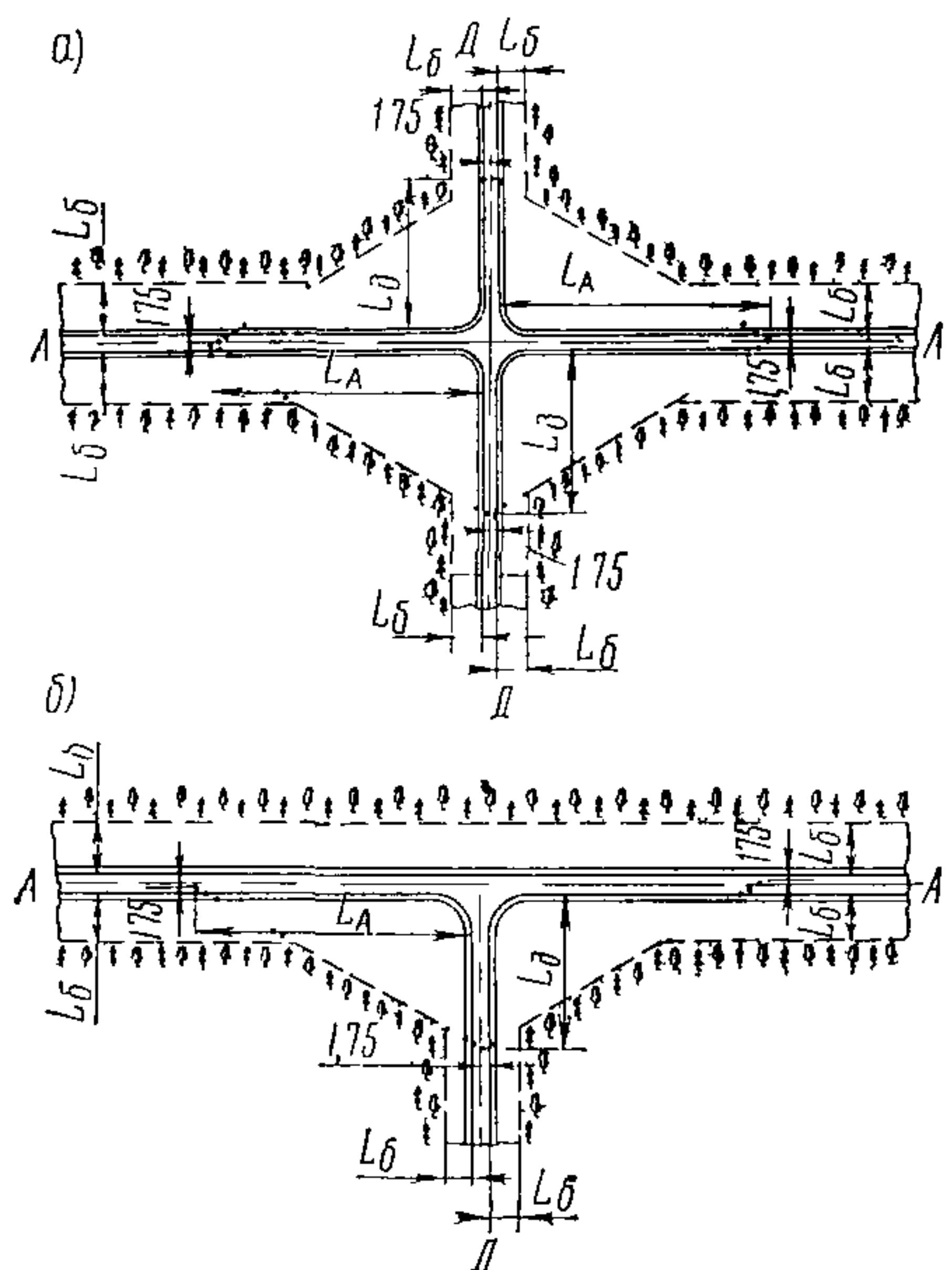
Рис 6 Схемы обеспечения видимости
