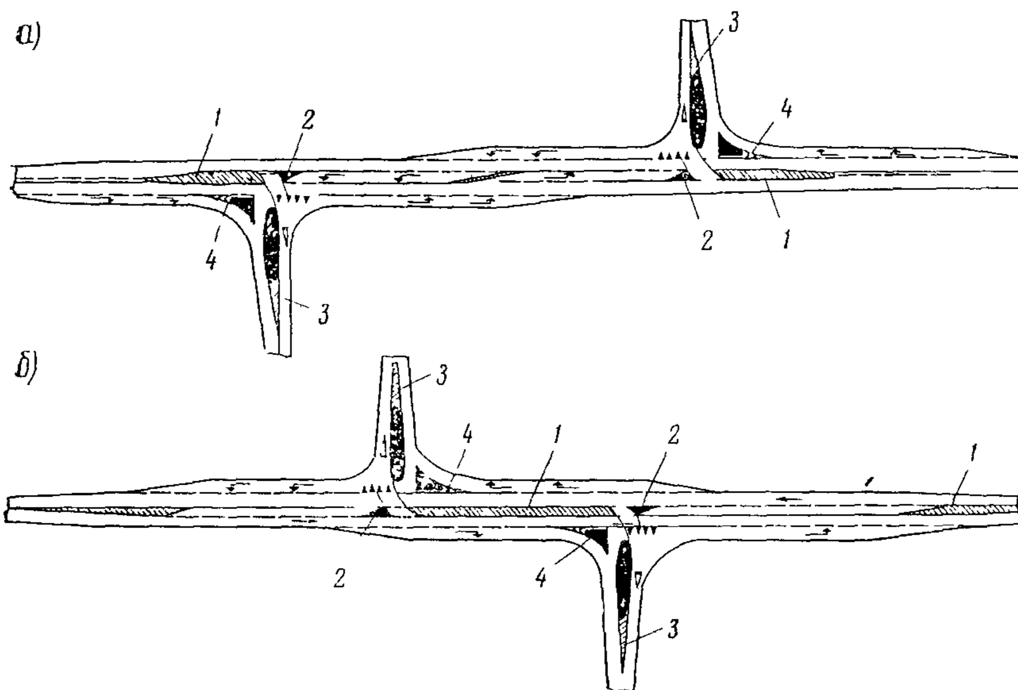
Рис 5 Примеры смещения примыканий второстепенных дорог:
