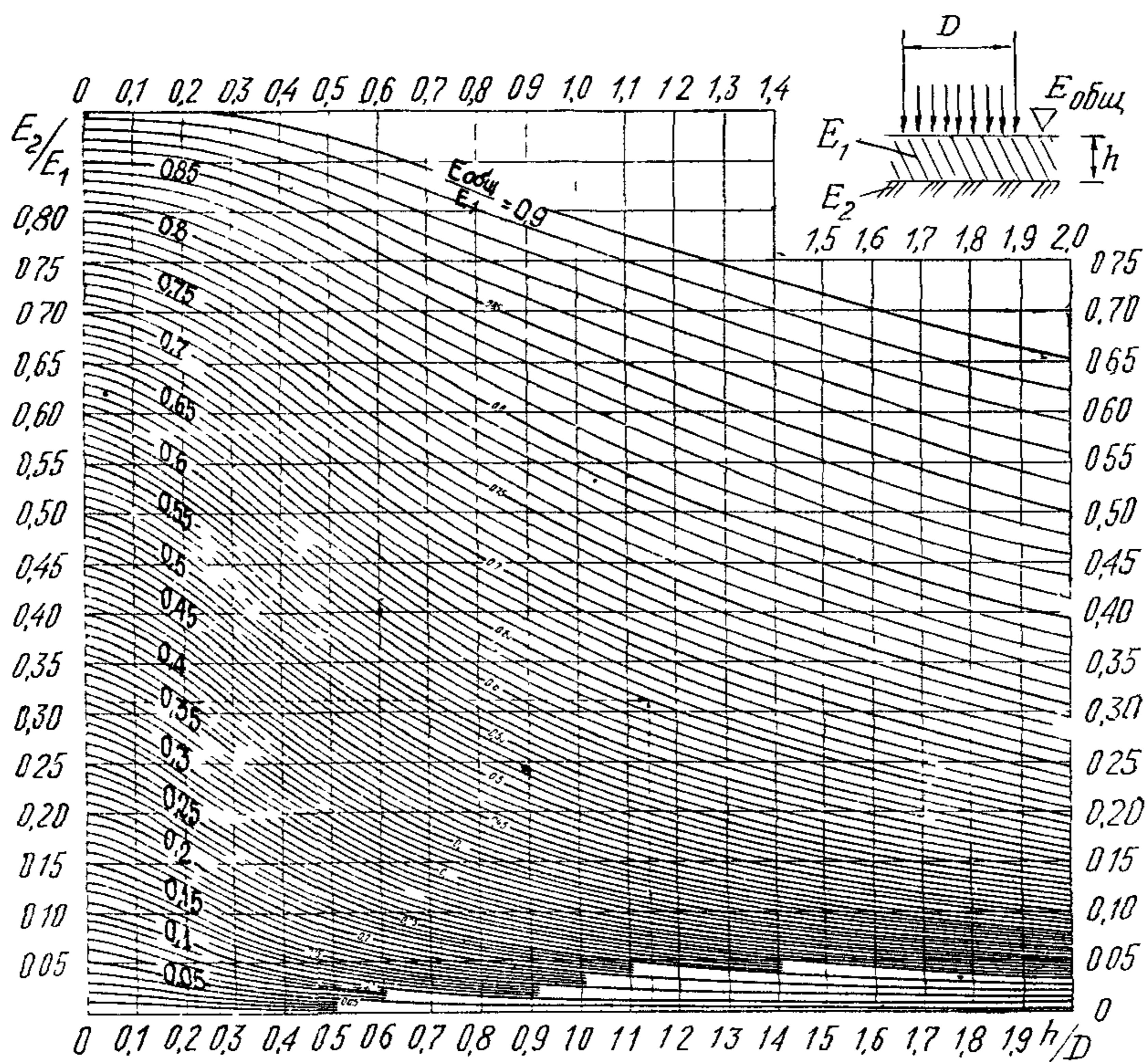
Рис.2. Номограмма для определения общего модуля упругости двухслойной системы  $E_{\text{общ}}$
