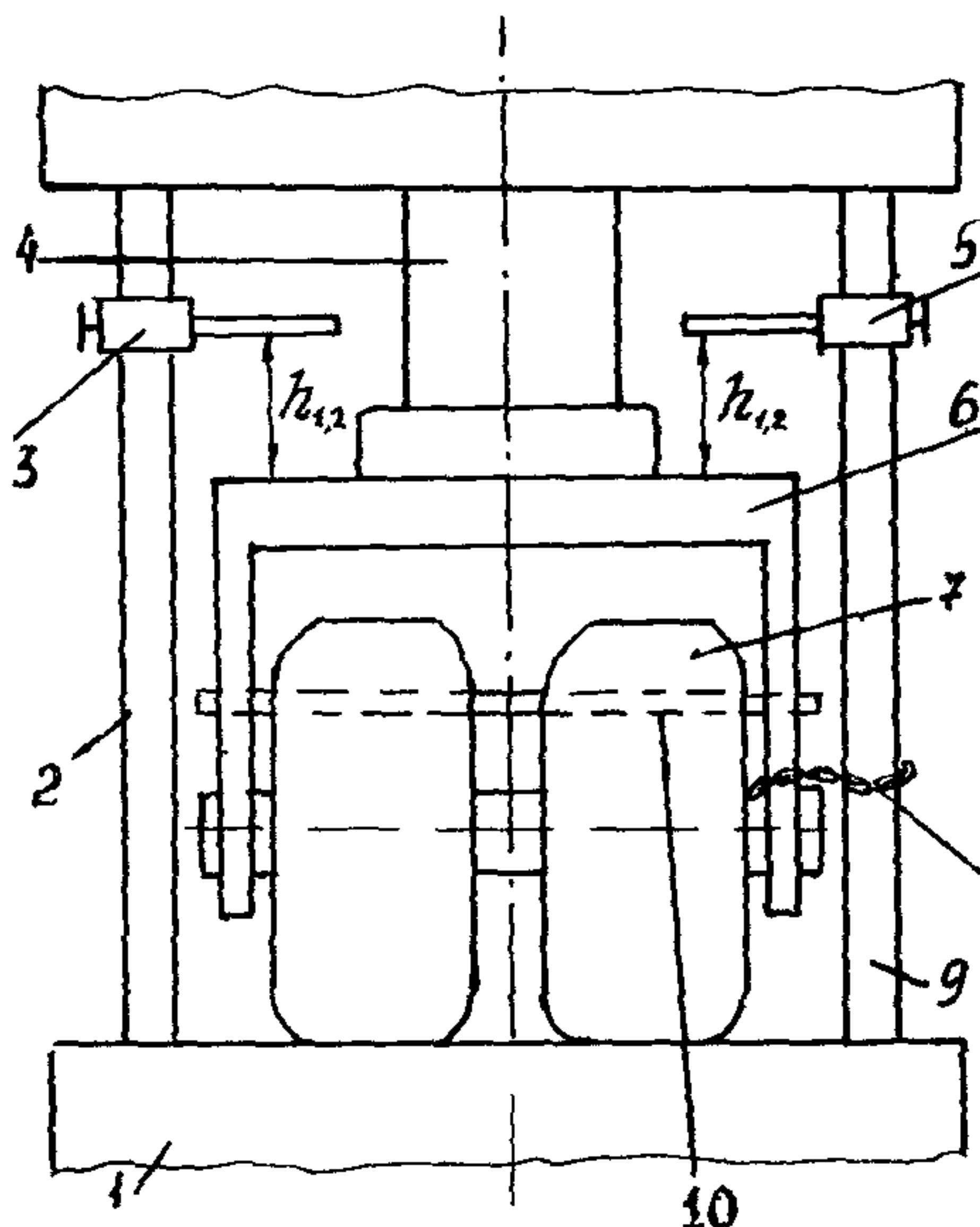
Рис.3. Схема тарировки колеса для установки УДН-НК:
