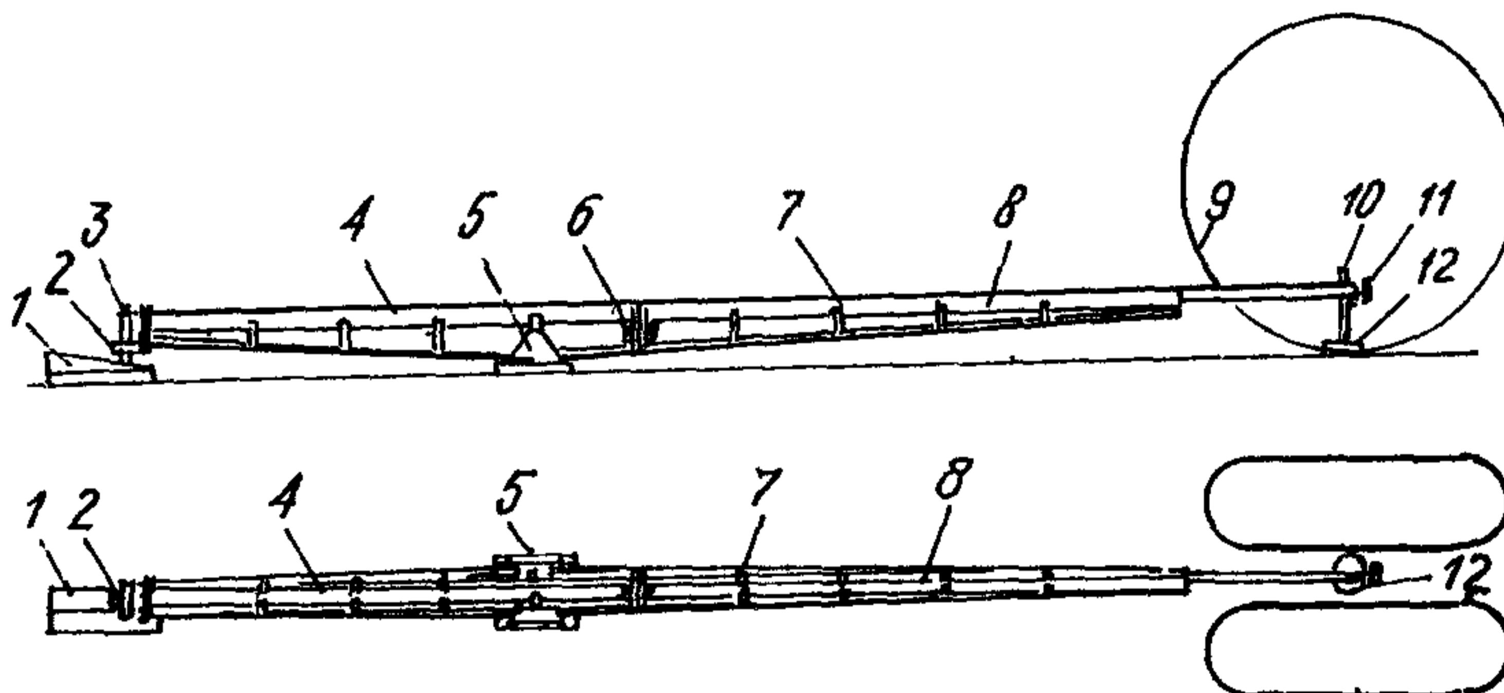
Рис.I. Схема длиннобазового рычажного прогибомера
