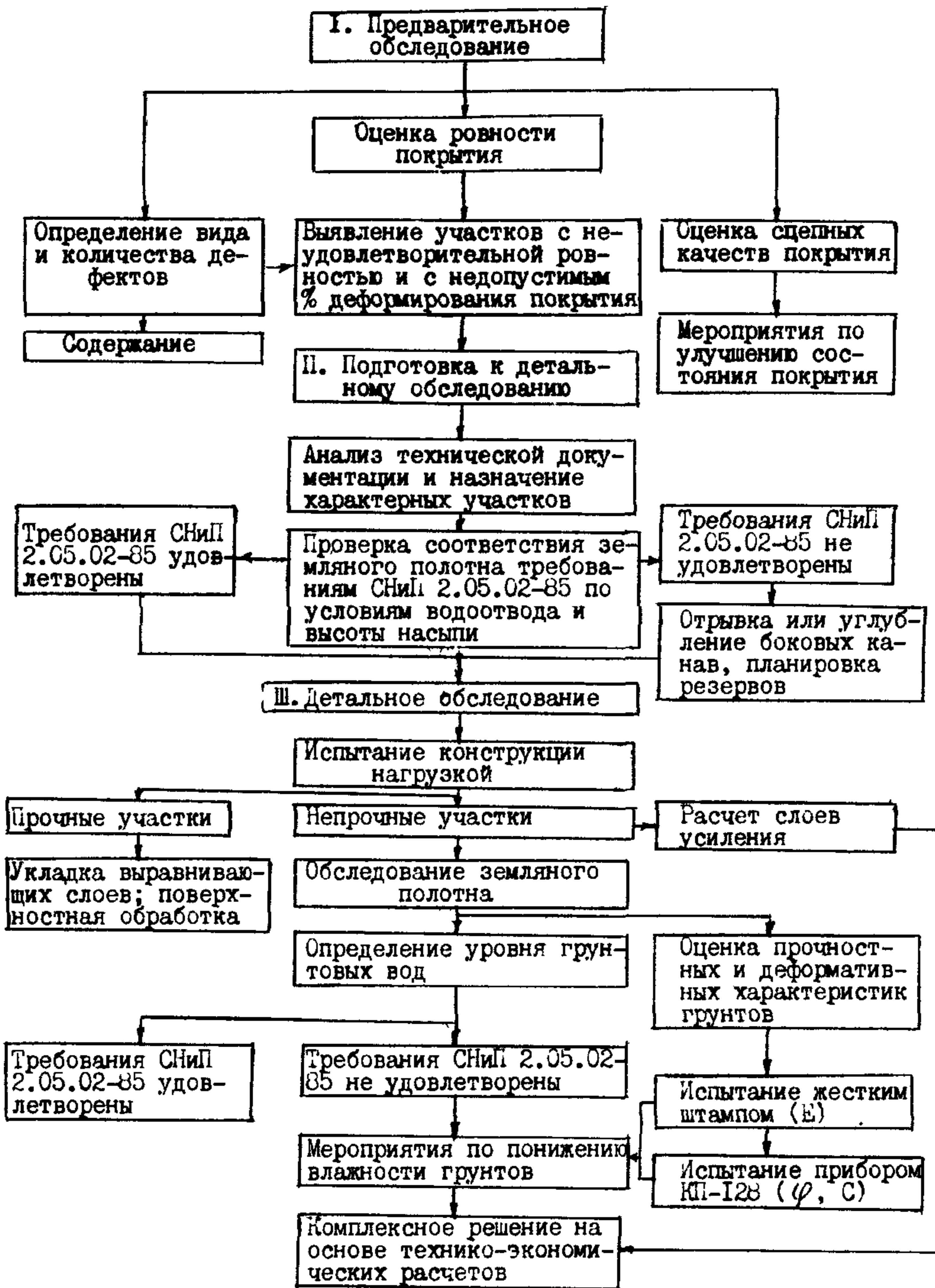
Рис. 2 .I. Порядок обследования дорожных конструкций с не僵硬ыми покрытиями для оценки и улучшения их состояния:
