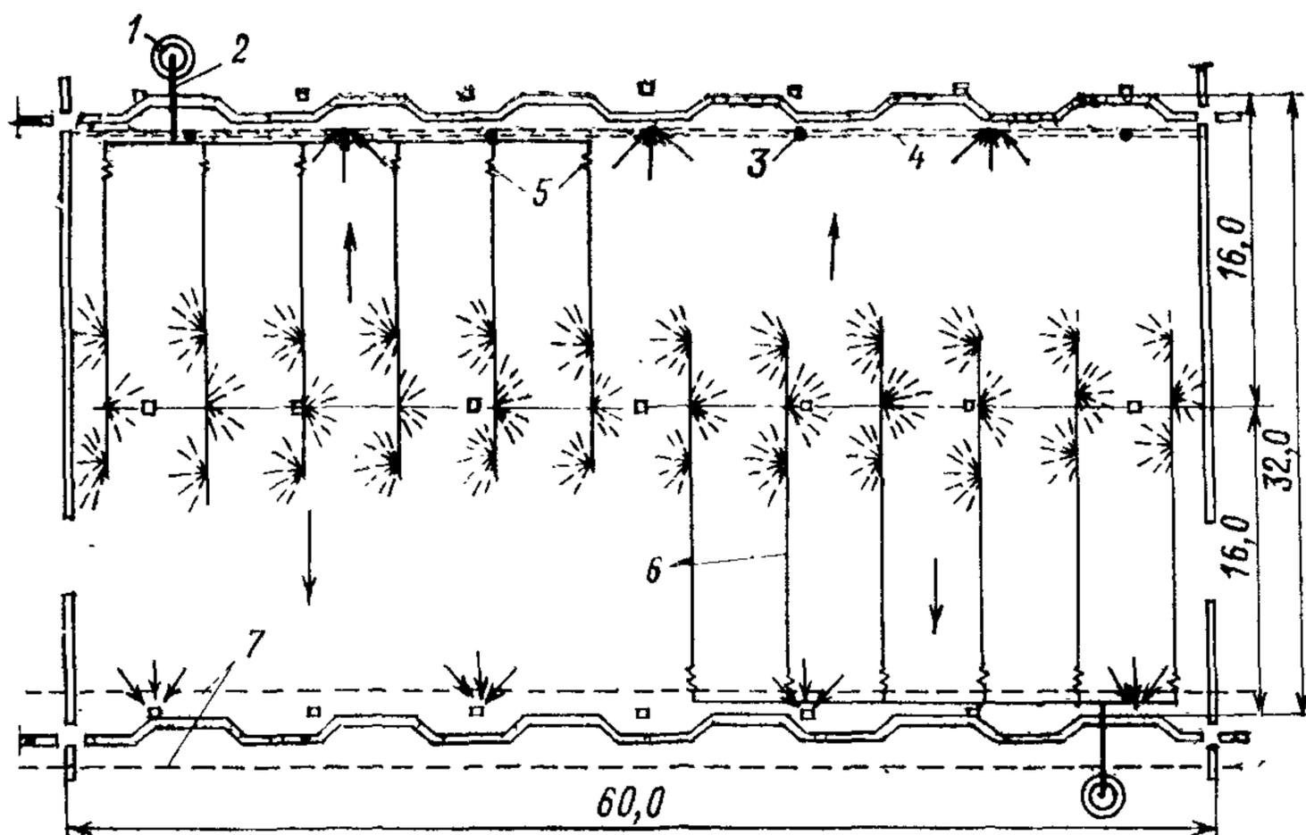
Схема системы поверхностного полива и отвода воды из блока
