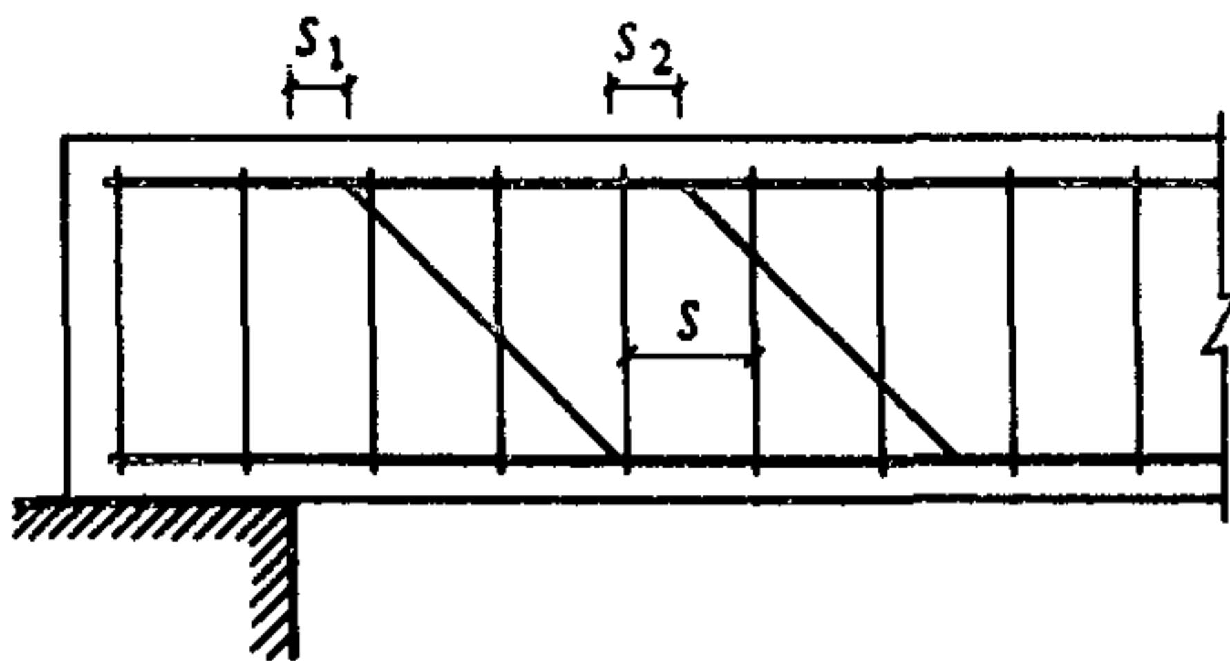
Поперечные усилия  $Q_{sw}$  и  $Q_{s, inc}$  определяются как сумма проекций на нормаль к продольной оси элемента предельных усилий соответственно в хомутах и отгибах, пересекающих опасную наклонную трещину.
