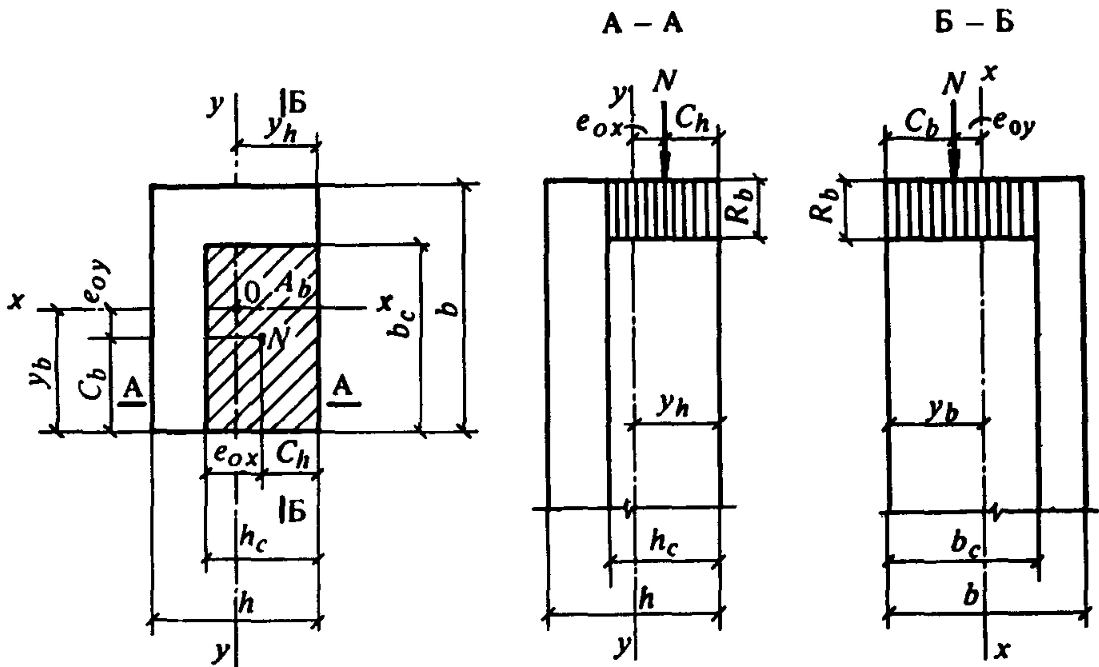
Черт. 3. Схема расположения усилий и эпюра напряжений в поперечном сечении бетонного элемента при косом внеклентренном сжатии
