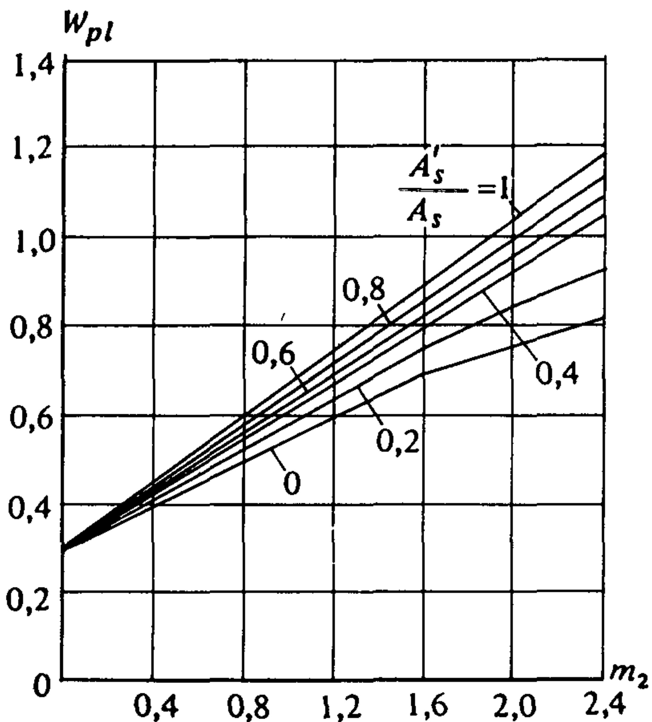
Черт. 4. График значений коэффициента  $W_{pl}$  для определения момента появления трещин  $M_{pl}$  в изгибающихся элементах прямоугольного сечения при  $\delta = 0,2$
