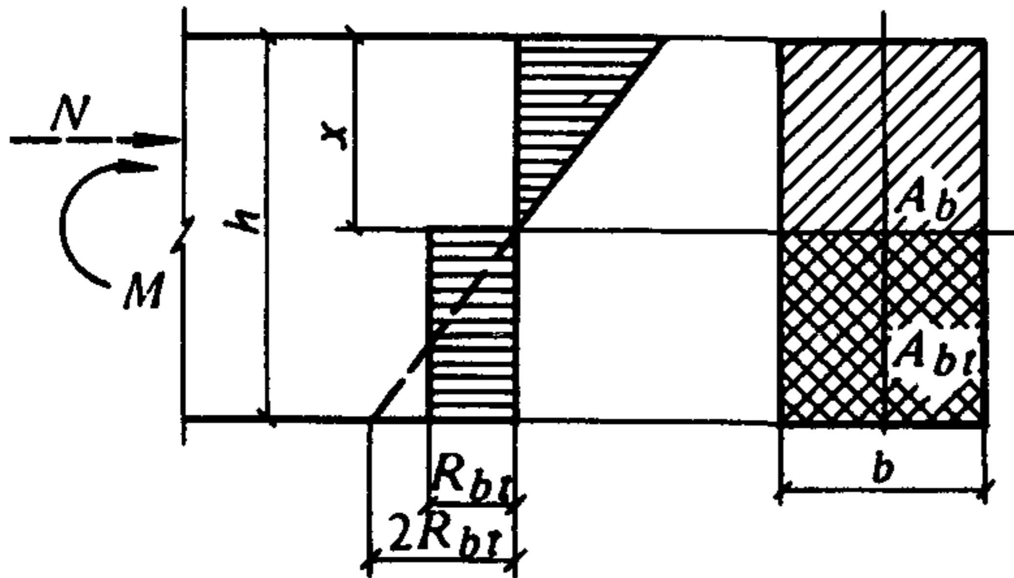
Черт. 2. Схема усилий и эпюра напряжений в сечении, нормальному к продольной оси изгибающегося (внеклентренно скатого) бетонного элемента, рассчитываемого по прочности с учетом сопротивления растянутой зоны бетона
