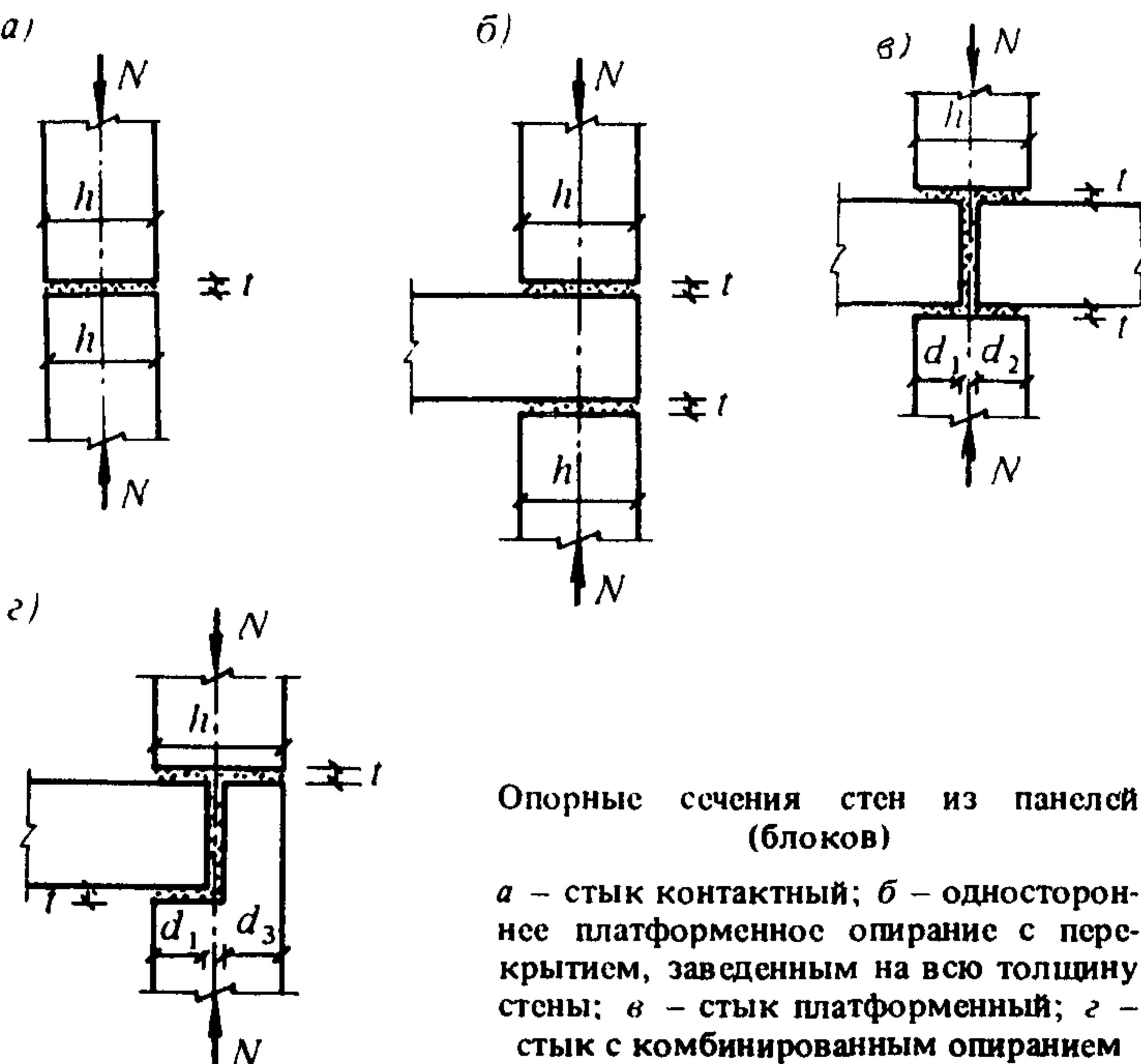
Опорные сечения стен из панелей (блоков)
