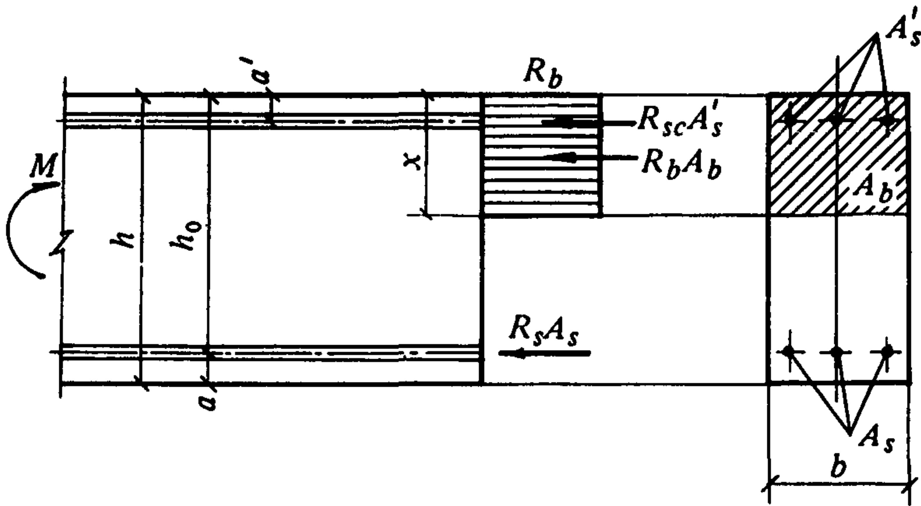
**Черт. 4. Схема усилий и эпюра напряжений в сечении, нормальном к продольной оси изгибающего железобетонного элемента, при расчете его по прочности**
