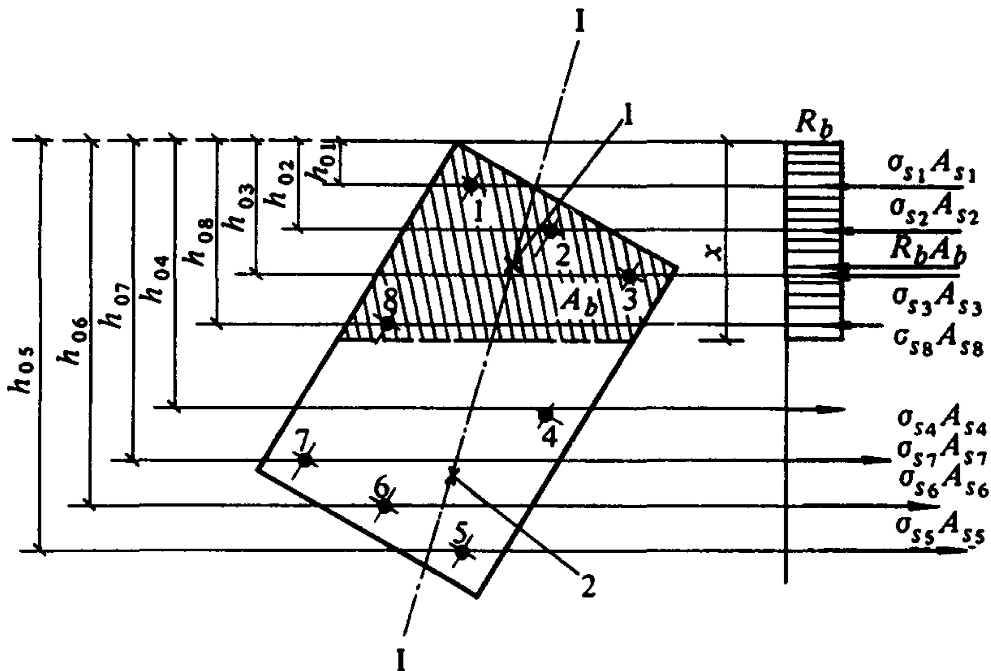
Черт. 6. Схема усилий и эпюра напряжений в сечении, нормальному к продольной оси железобетонного элемента, в общем случае расчета по прочности
