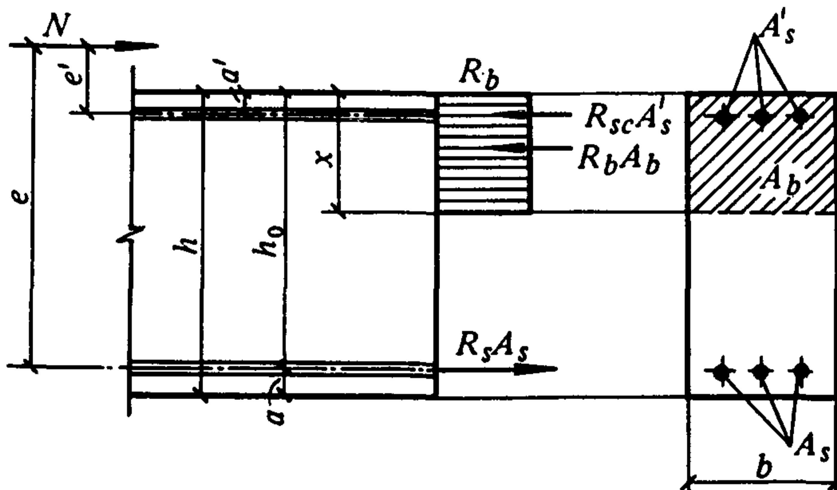
Черт. 5. Схема и эпюра напряжений в сечении, нормальном к продольной оси внеклентренно сжатого железобетонного элемента, при расчете его по прочности
