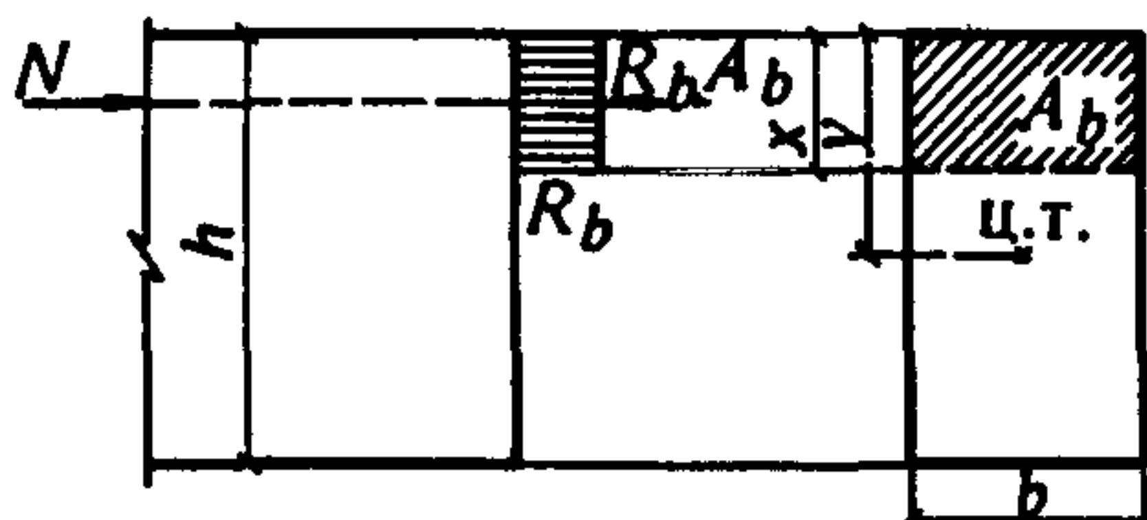
Черт. 1. Схема усилий и эпюра напряжений в сечении, нормальному к продольной оси внецентренно сжатого бетонного элемента, рассчитываемого по прочности без учета сопротивлений бетона растянутой зоны
