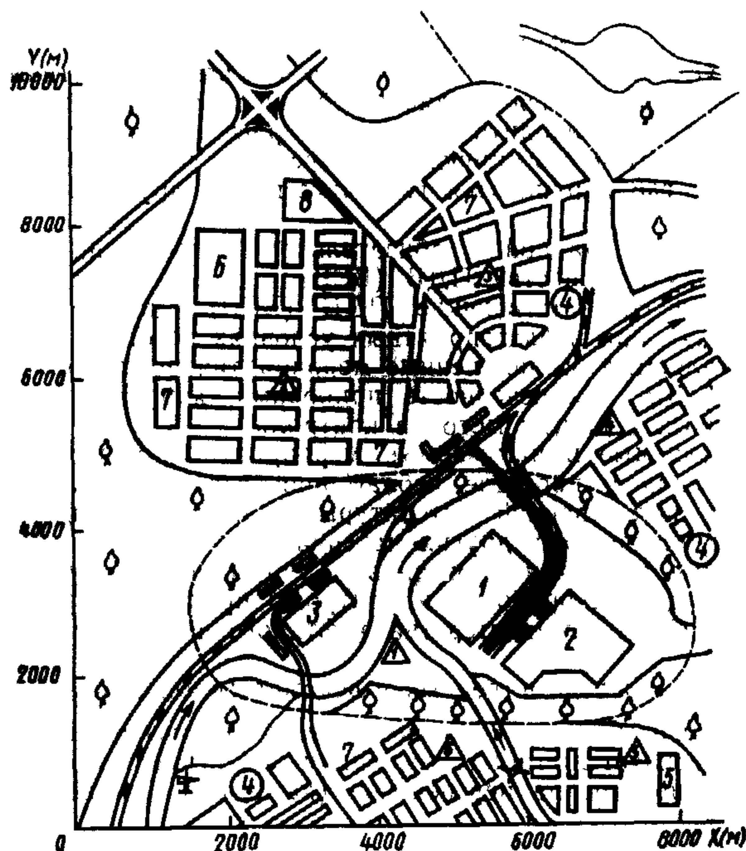
1 — металлургический завод; 2 — азотно-туковый завод; 3 — ГРЭС; 4 — районные отопительные котельные; 5 — цементный завод; 6 — машиностроительный завод; 7 — предприятие легкой промышленности; 8 — домостроительный комбинат.
