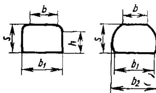
$b$ —ширина верхней пласти;  $b_1$ —ширина нижней пласти,  $b_2$ —ширина шпалы по непропиленным сторонам;  $s$ —толщина шпалы;  $h$ —высота пропиленной части боковой стороны
