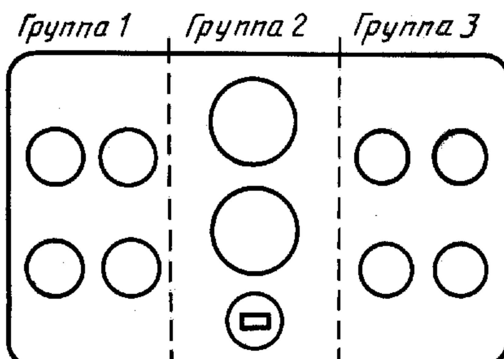
**5.2. Прочие приборы, относящиеся к двигателю (группа 1), например, указатель температуры двигателя, указатель давления масла в двигателе, или к трансмиссии (группа 3), например, указатель**
