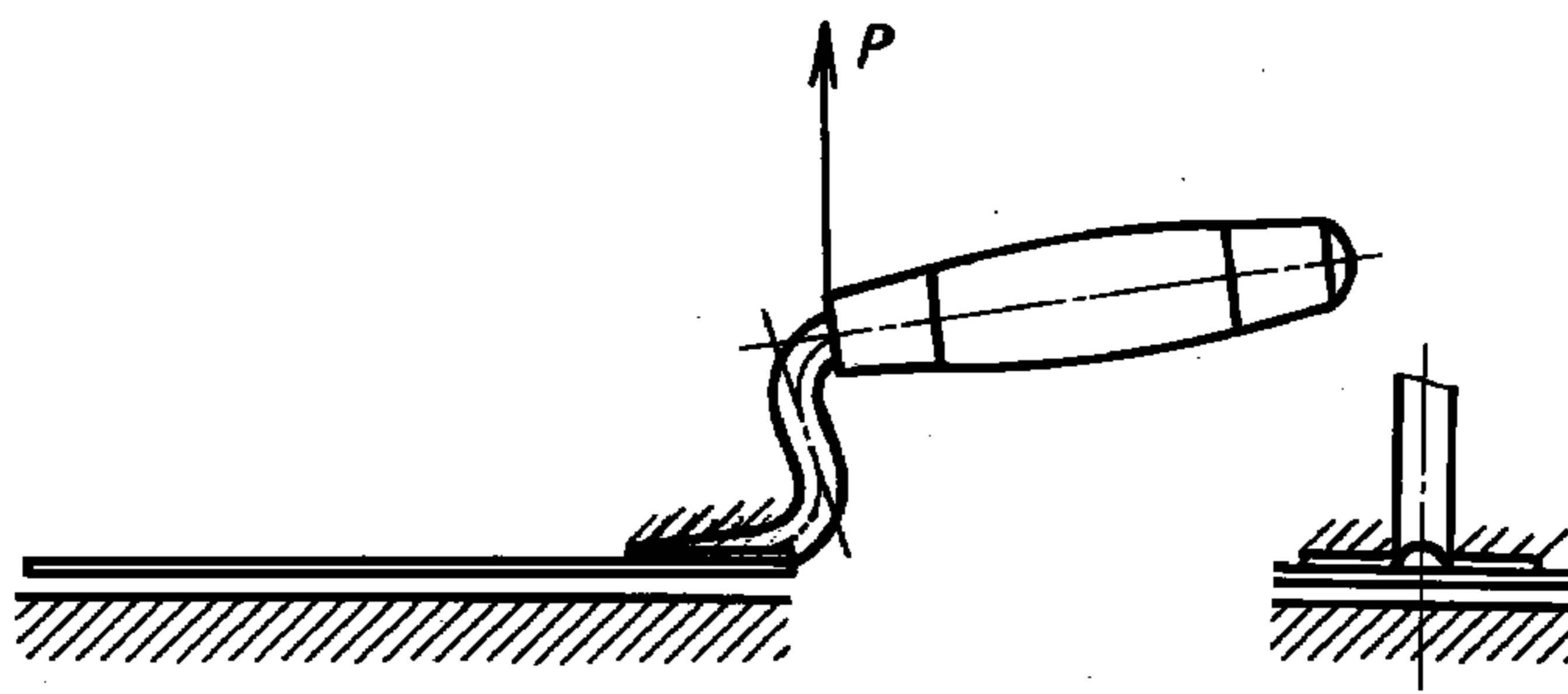
4.6. Сопротивление прокручиванию ручки и прочность соединения ручки с кронштейном (п. 2.10) проверяют на специальных приспособлениях при помощи динамометра общего применения 2-го класса точности методом статической нагрузки в течение 2 мин. При проверке изделий на прочность соединения ручки с кронштейном нагрузка должна быть приложена вдоль оси ручки.
