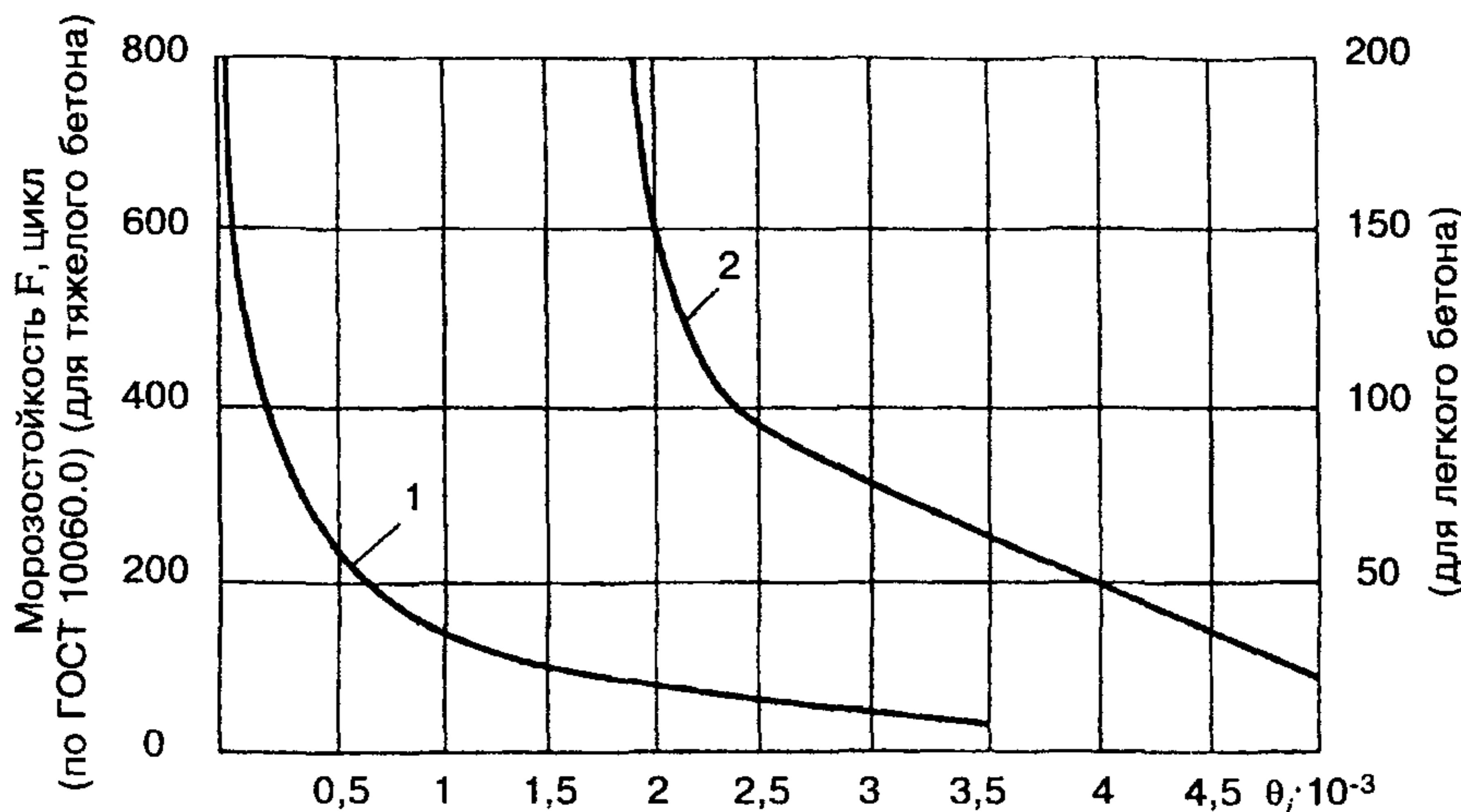
1 — для тяжелого бетона; 2 — для легкого бетона
