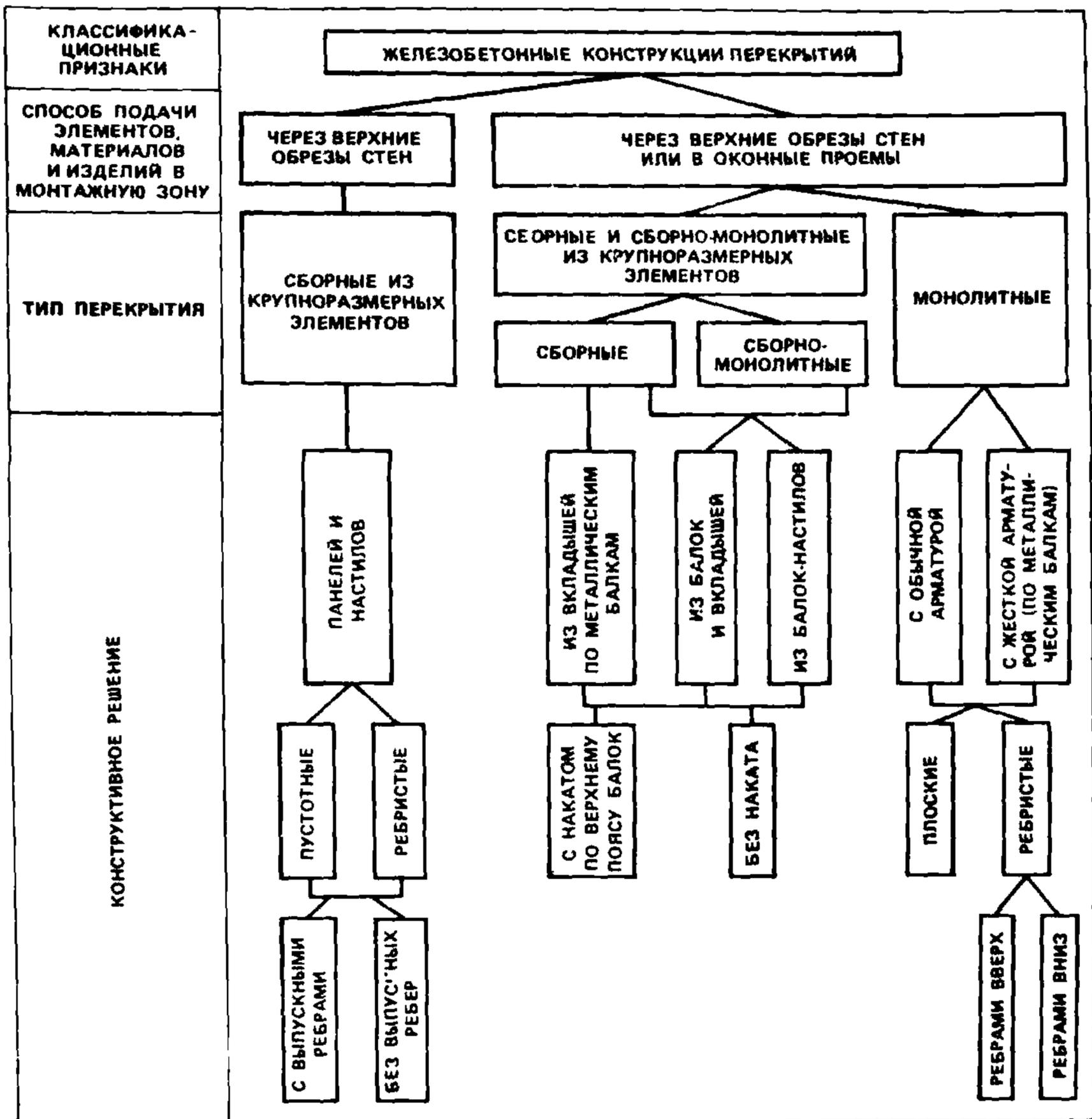
Классификация железобетонных конструкций перекрытий, применяемых при капитальном ремонте жилых зданий
