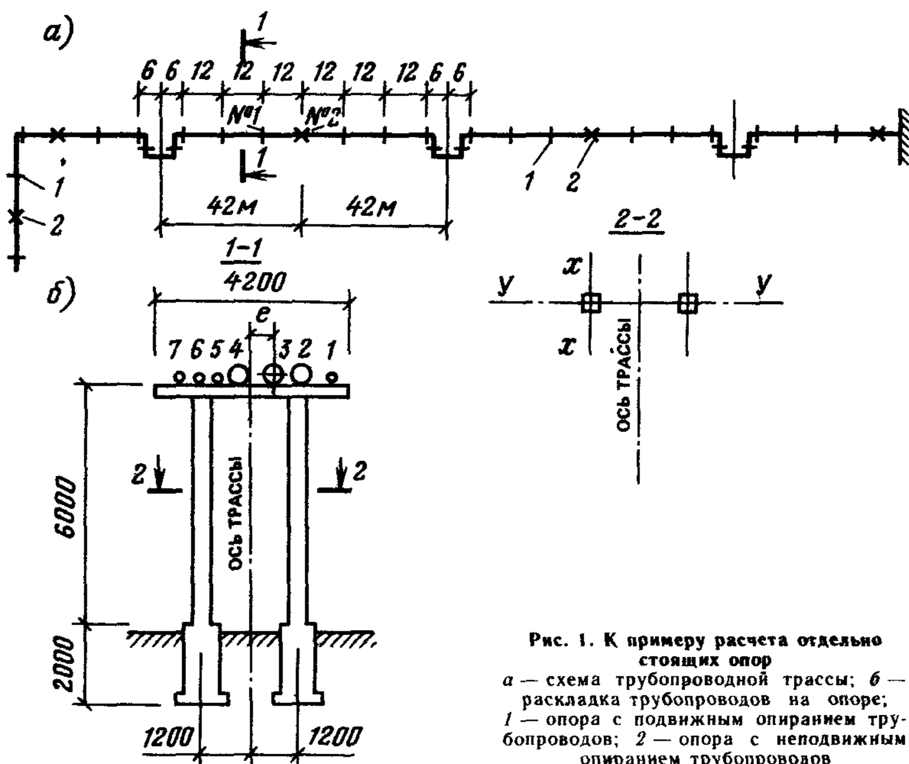
Рис. 1. К примеру расчета отдельно стоящих опор
