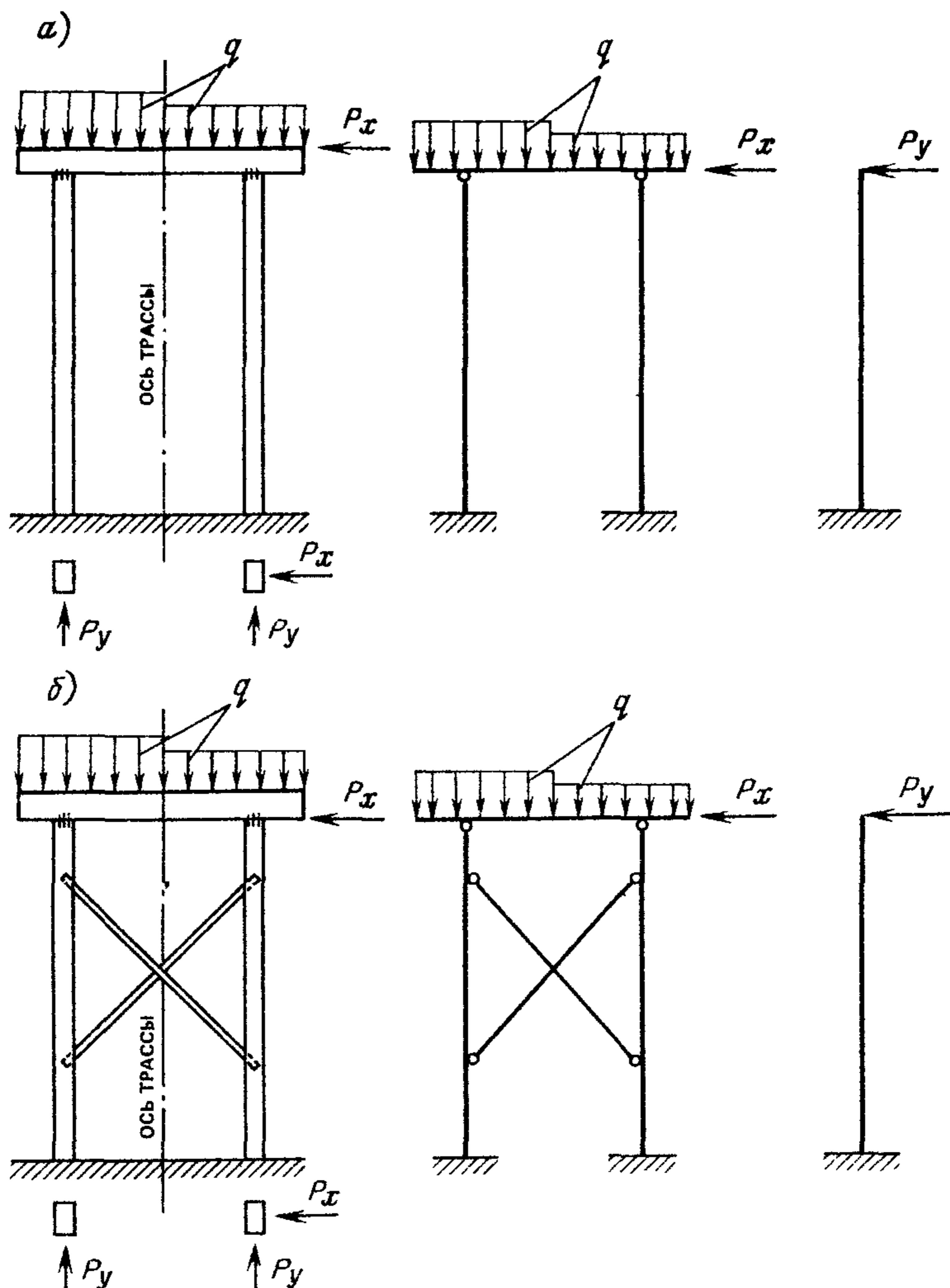
**Рис. 29. Расчетные схемы железобетонных опор**
