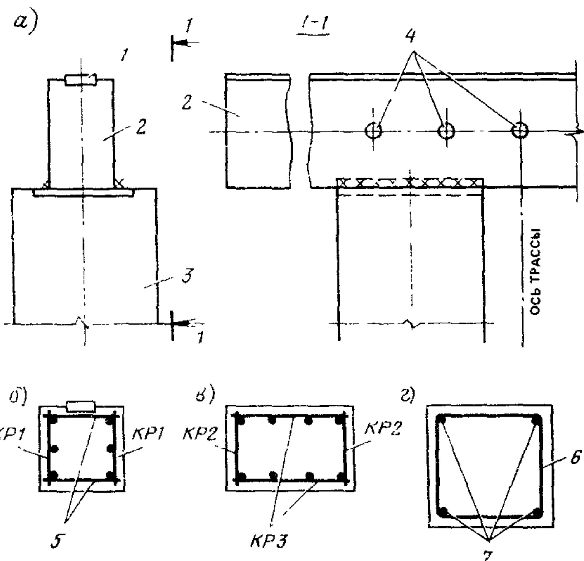
**Рис. 4. Конструкции железобетонных отдельно стоящих опор**
