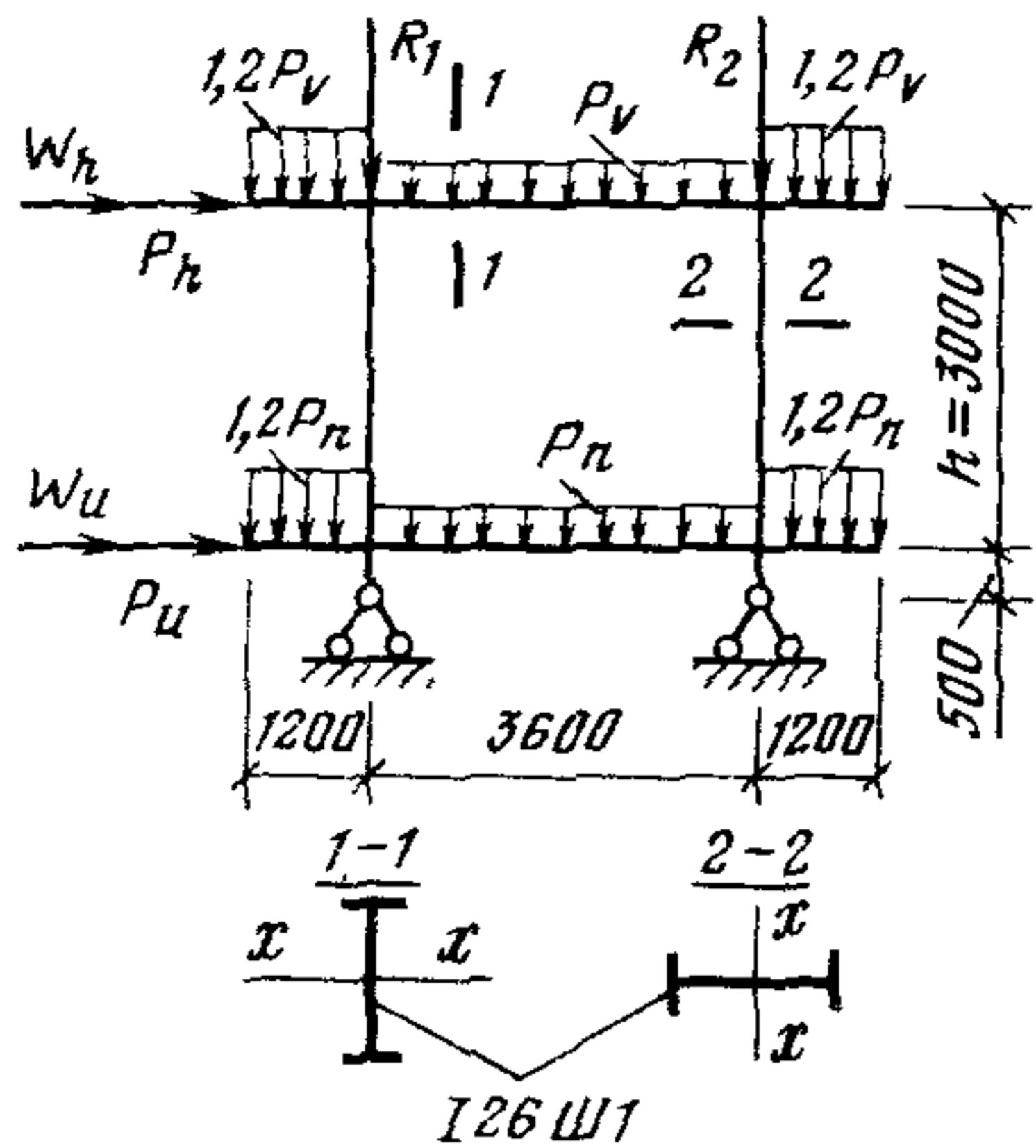
Рис. 14. Расчетная схема надколонника
