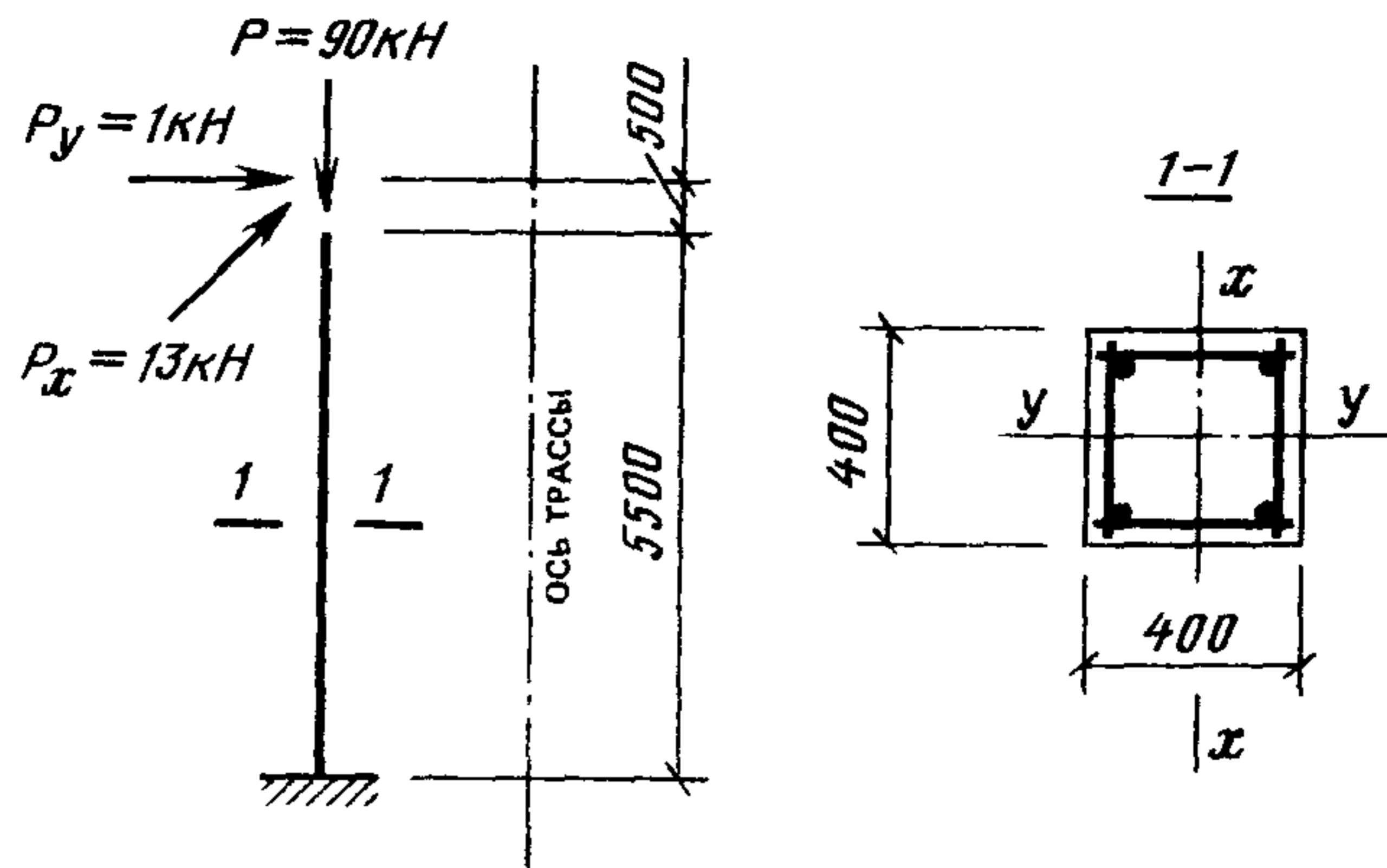
Рис. 8. Расчетная схема колонны анкерной опоры
