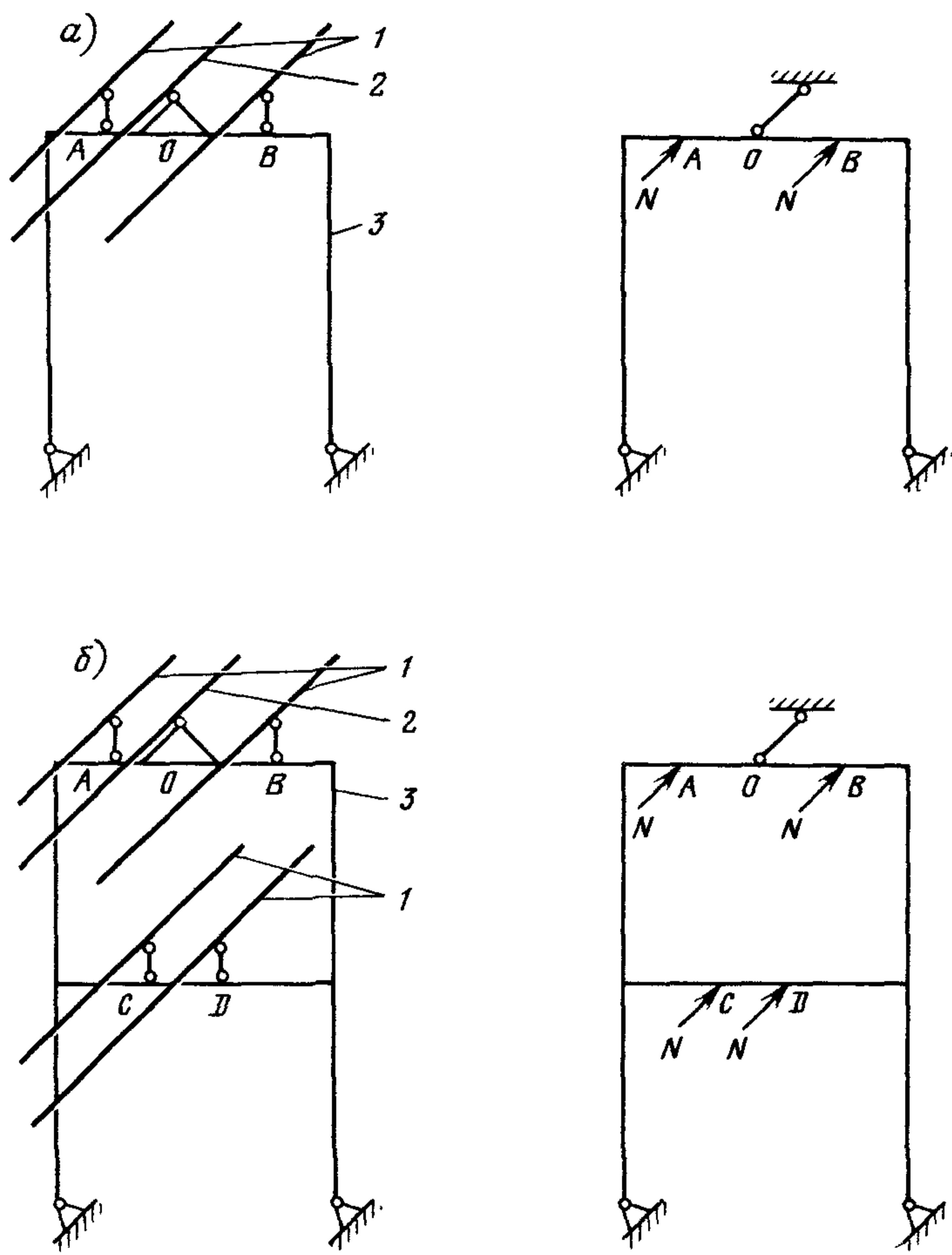
**Рис. 32. Расчетные схемы двухшарнирных опор**
