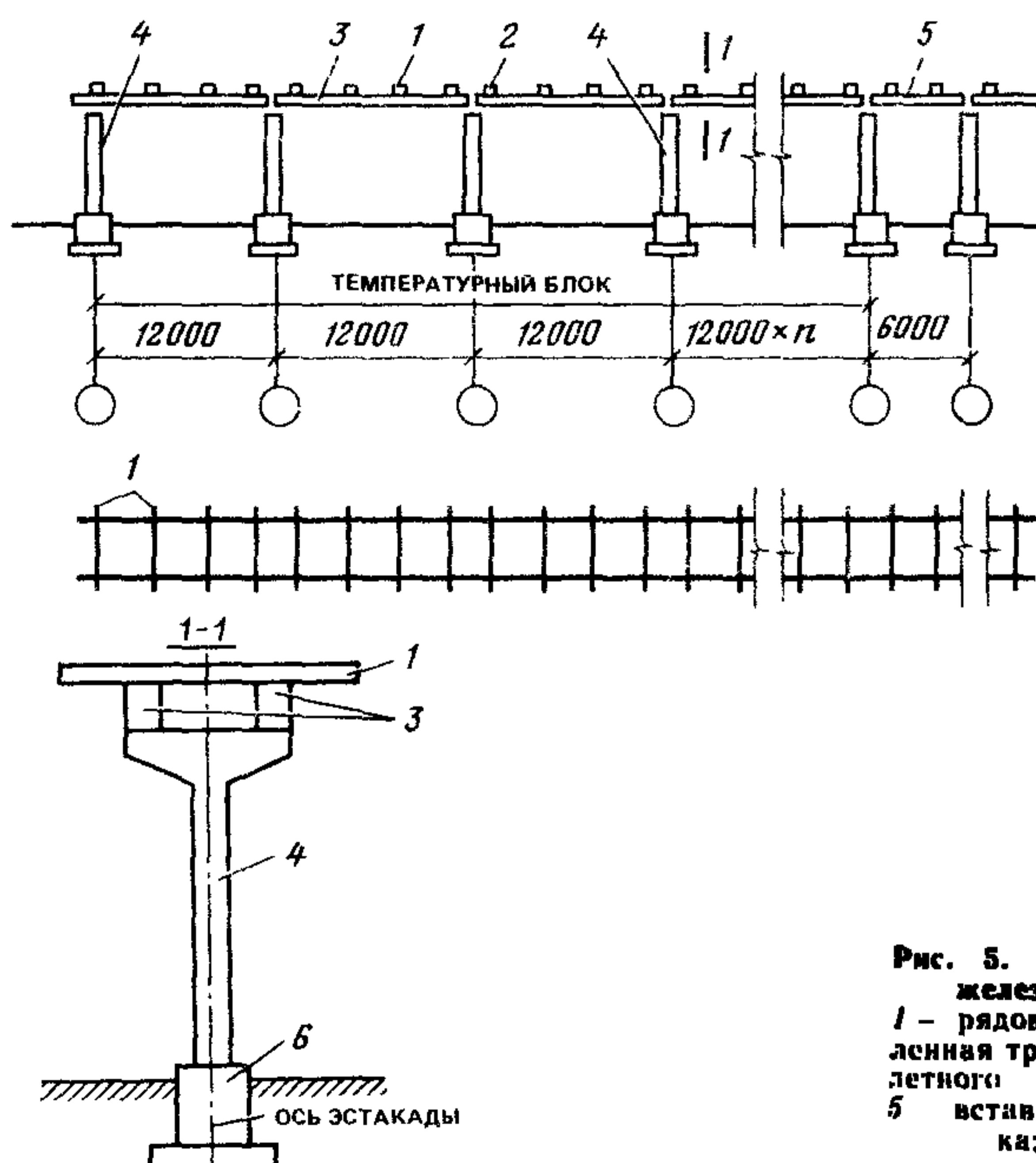
**Рис. 5. Конструктивная схема железобетонных эстакад**
