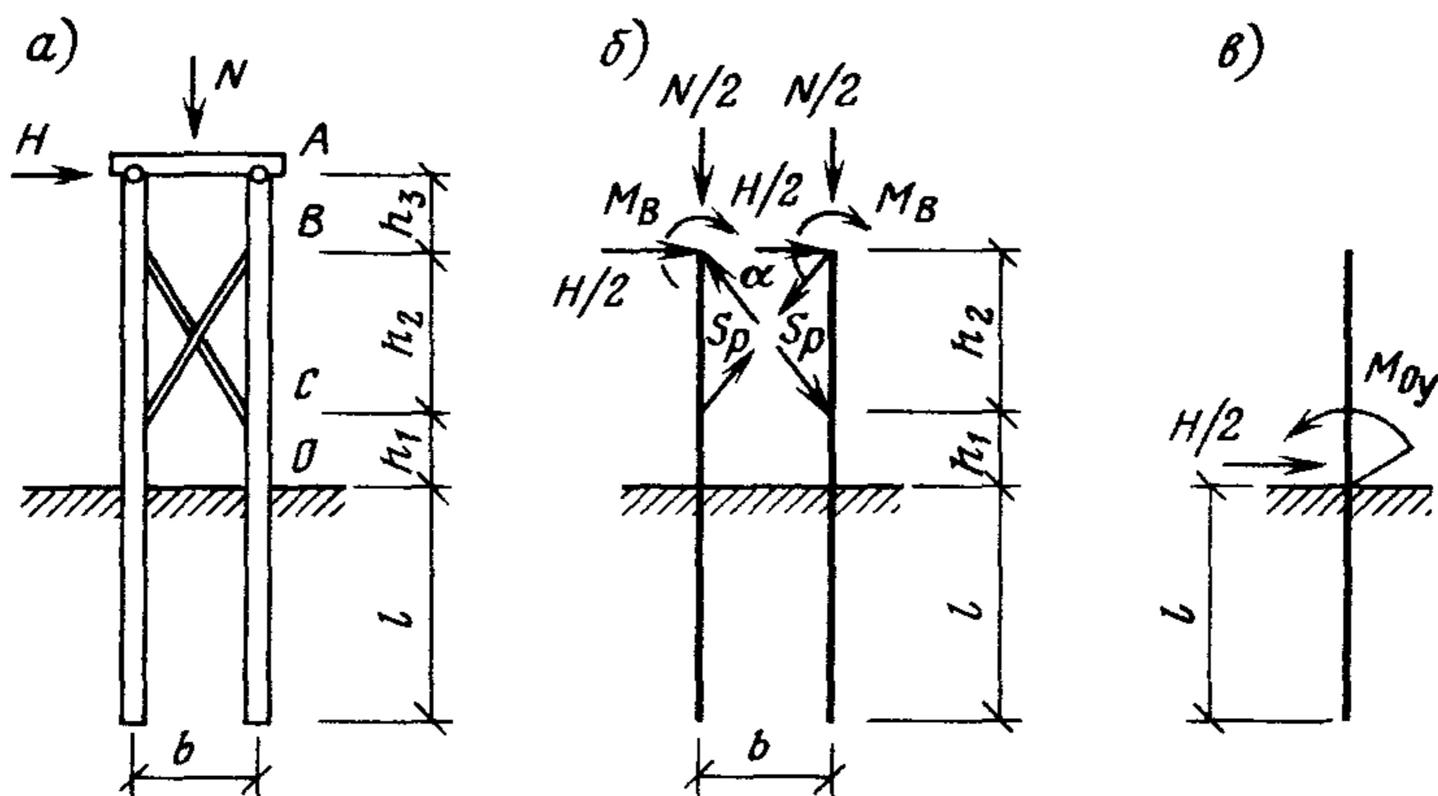
Рис. 33. Расчетная схема опоры с применением свай-колонн
