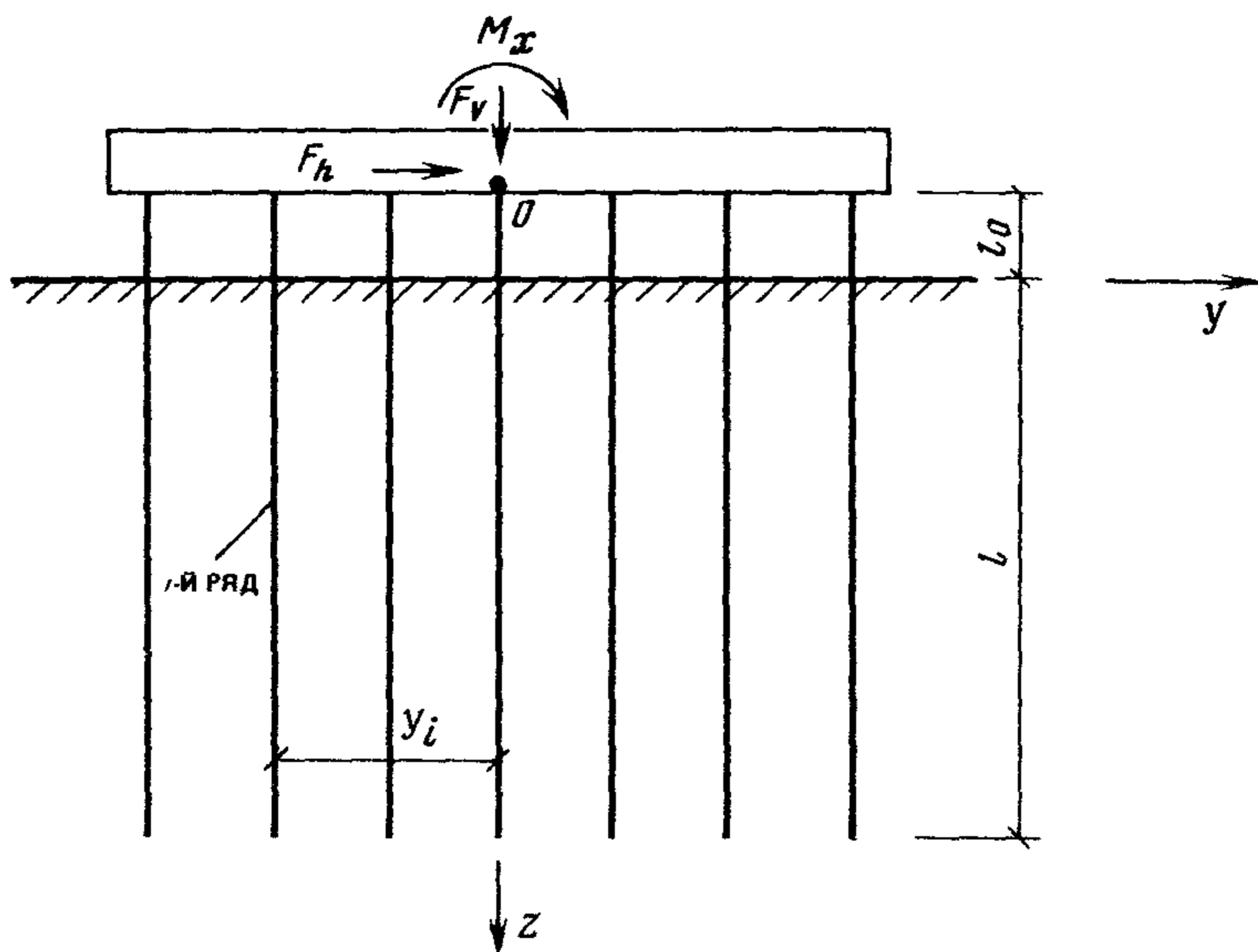
Рис. 34. Расчетная схема свайного ростверка
