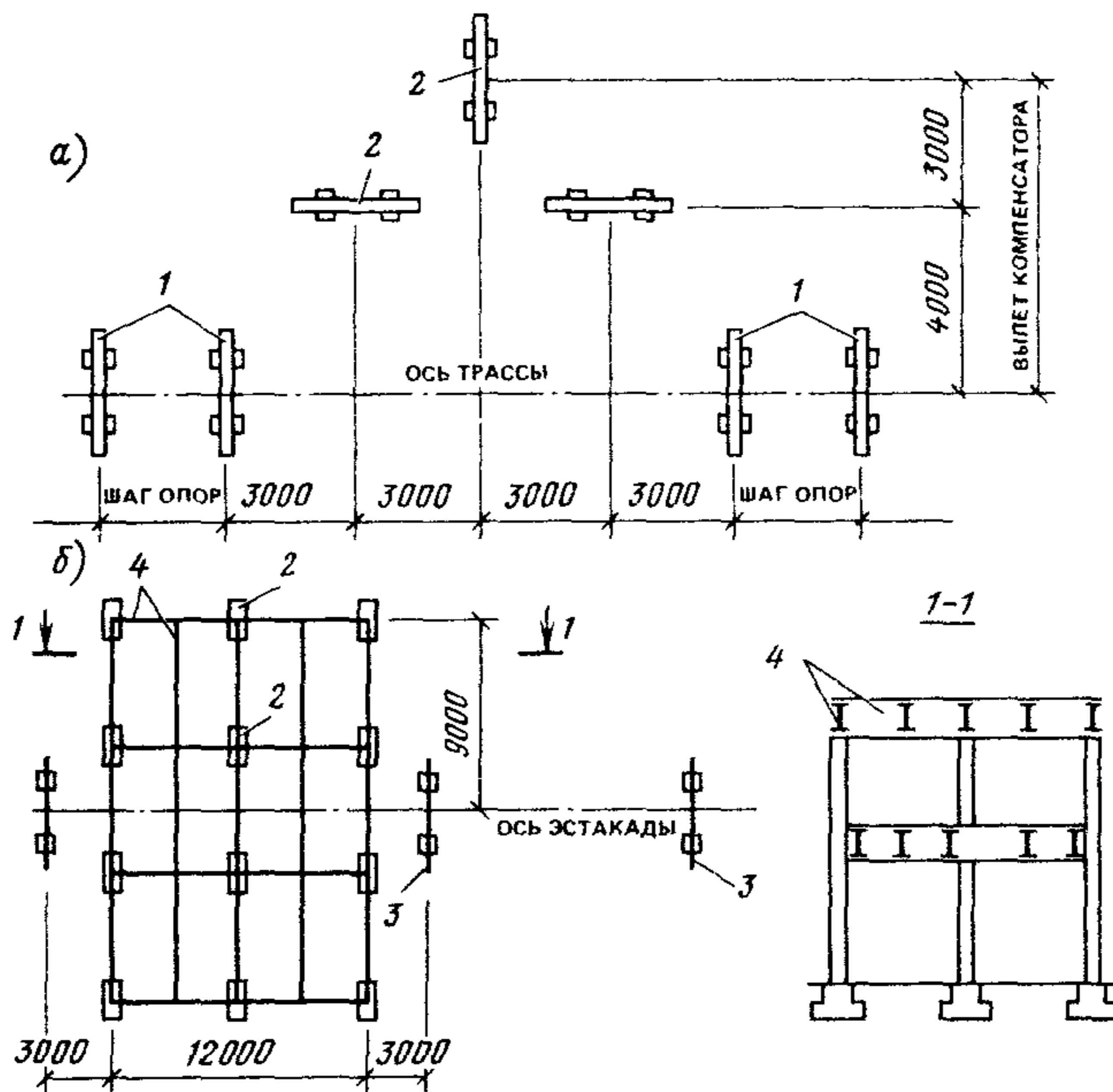
Рис. 9. Пример решения опор под компенсаторы
