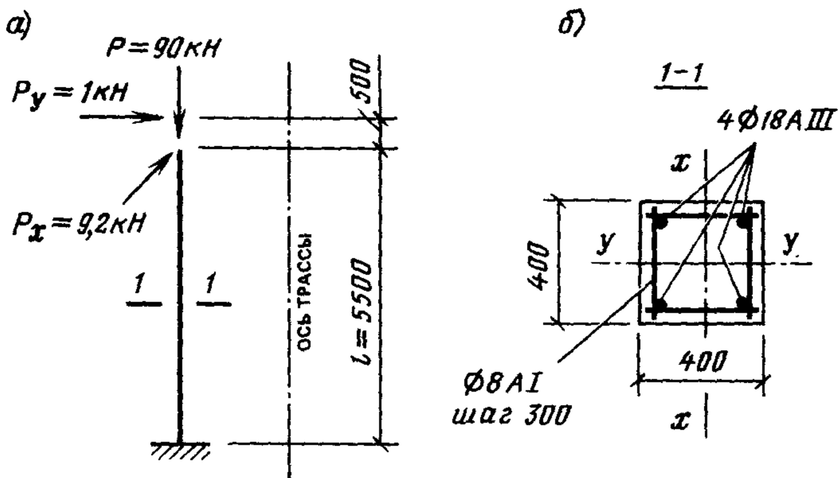
Рис. 5. К расчету колонны опоры
