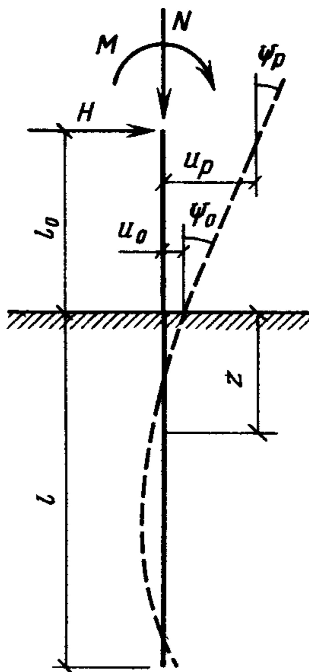
3. Расчетные величины горизонтального перемещения сваи в уровне подошвы ростверка  $u_p$ , м, и угол ее поворота  $\Psi_p$ , рад, следует определять по формулам:
