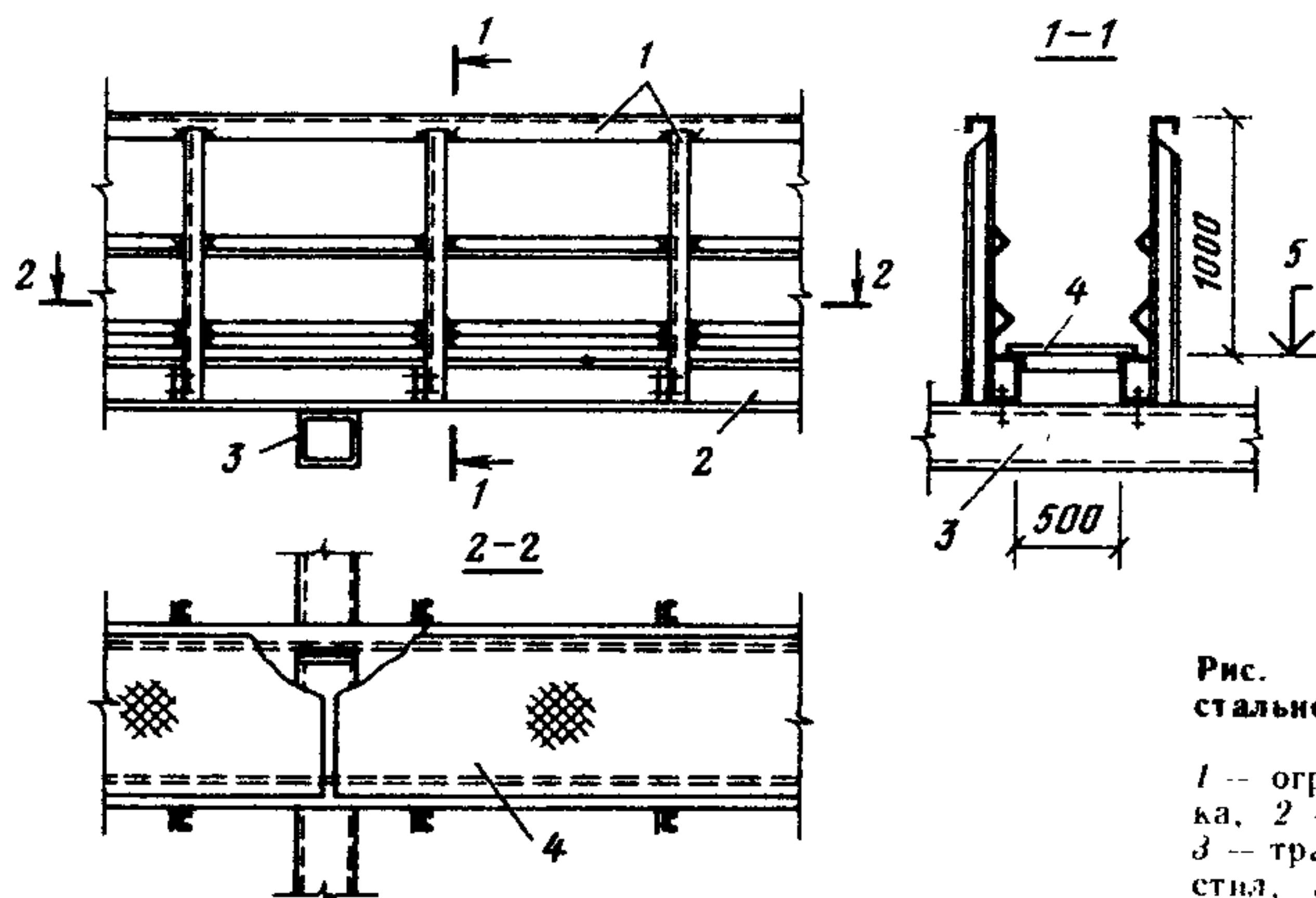
**Рис. 15. Конструкция стального проходного мостика**
