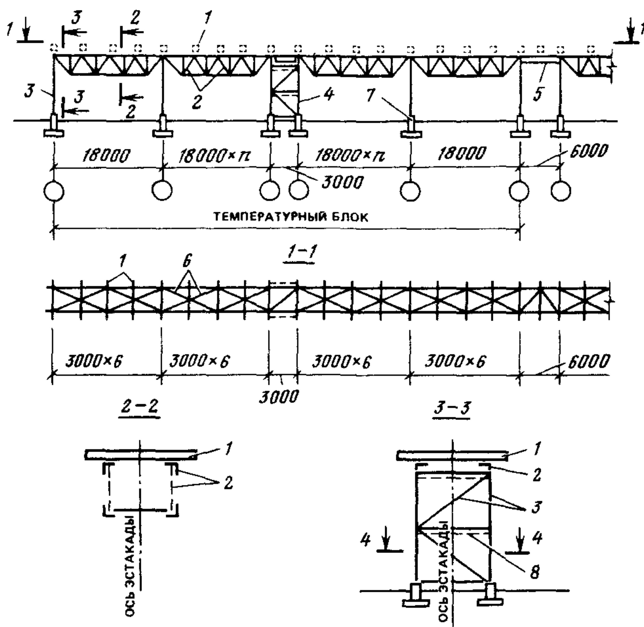
Рис. 7 Конструктивная схема одноярусной стальной эстакады
