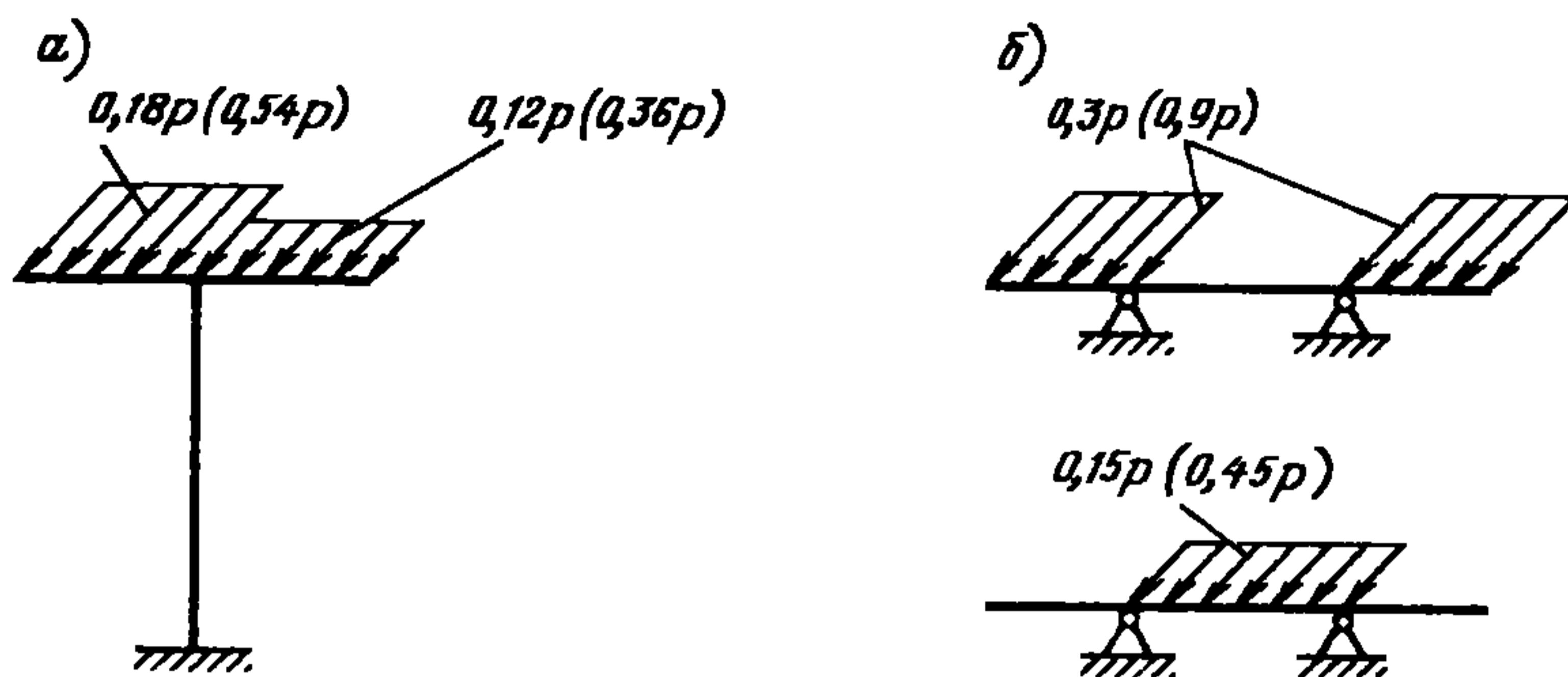
**Рис. 22. Распределение интенсивности горизонтальной технологической нагрузки при расчете траверс отдельно стоящих опор и эстакад под технологические трубопроводы**
