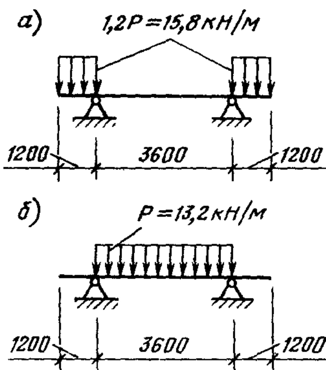
Рис. 10. К расчету рядовой траверсы эстакады на вертикальные нагрузки
