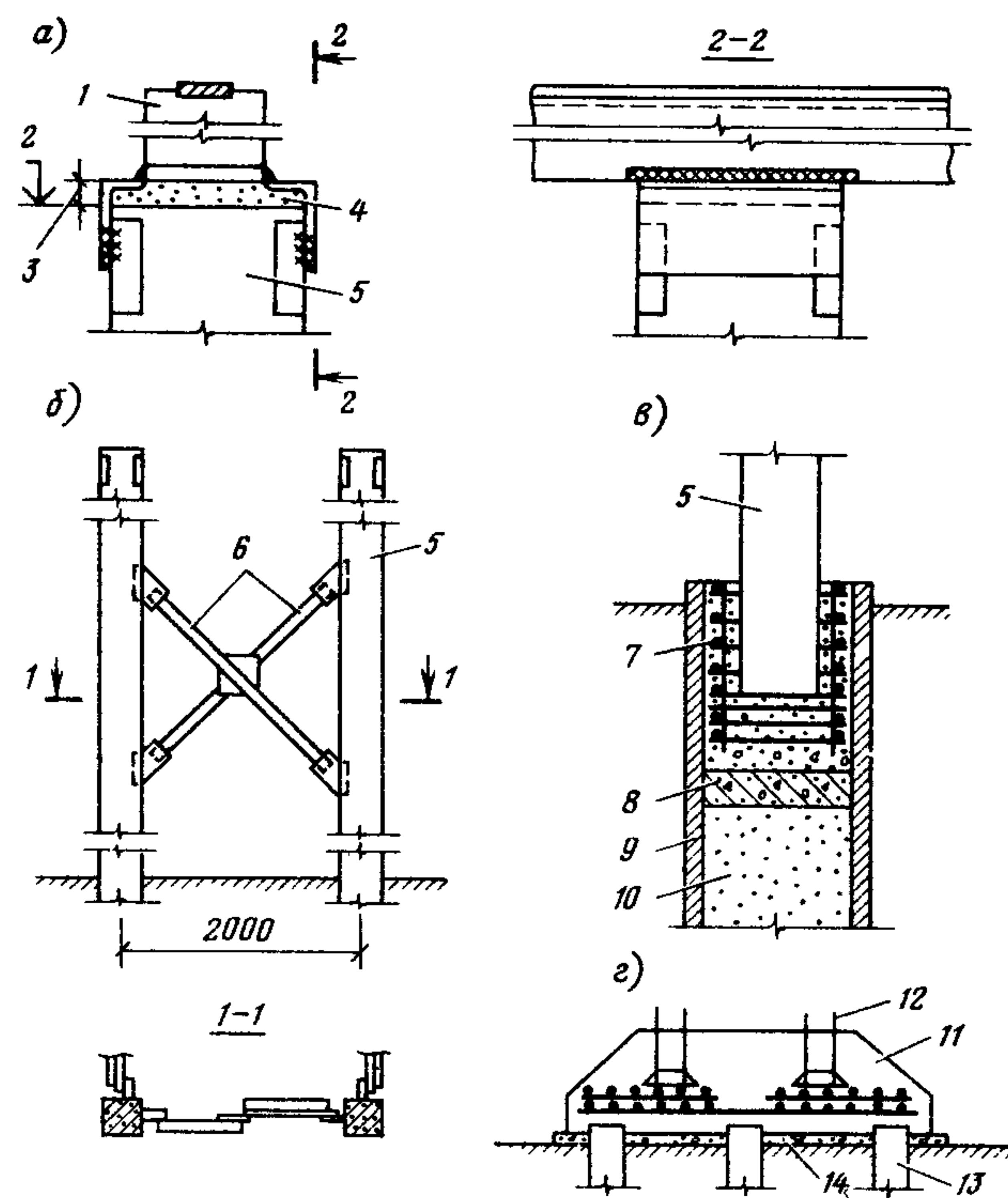
**Рис. 14. Узлы опор с применением свай**
