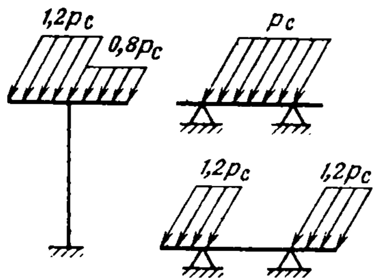
Рис. 25. Распределение интенсивности сейсмической нагрузки при расчете траперс анкерных отдельно стоящих опор
