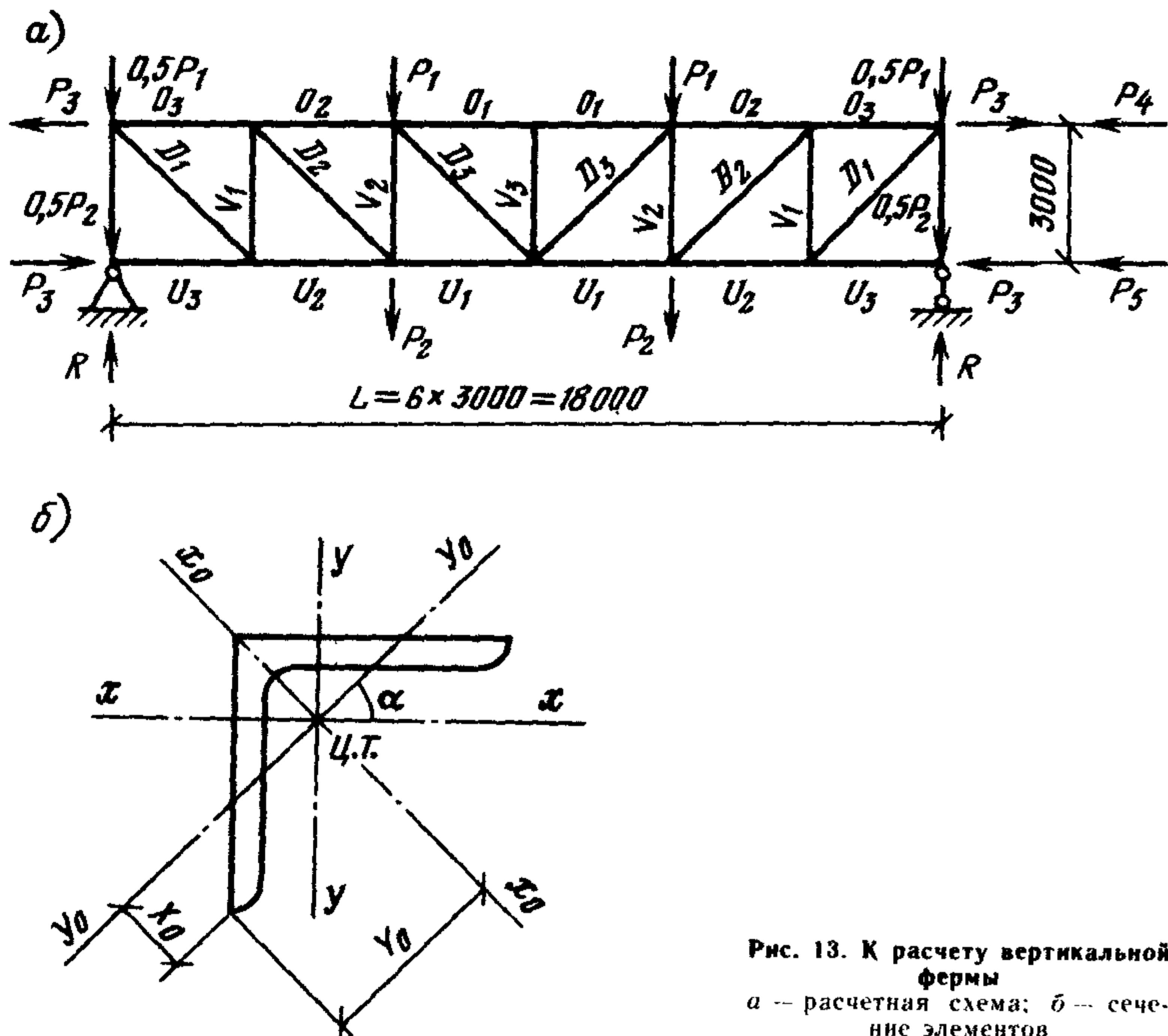
Рис. 13. К расчету вертикальной фермы
