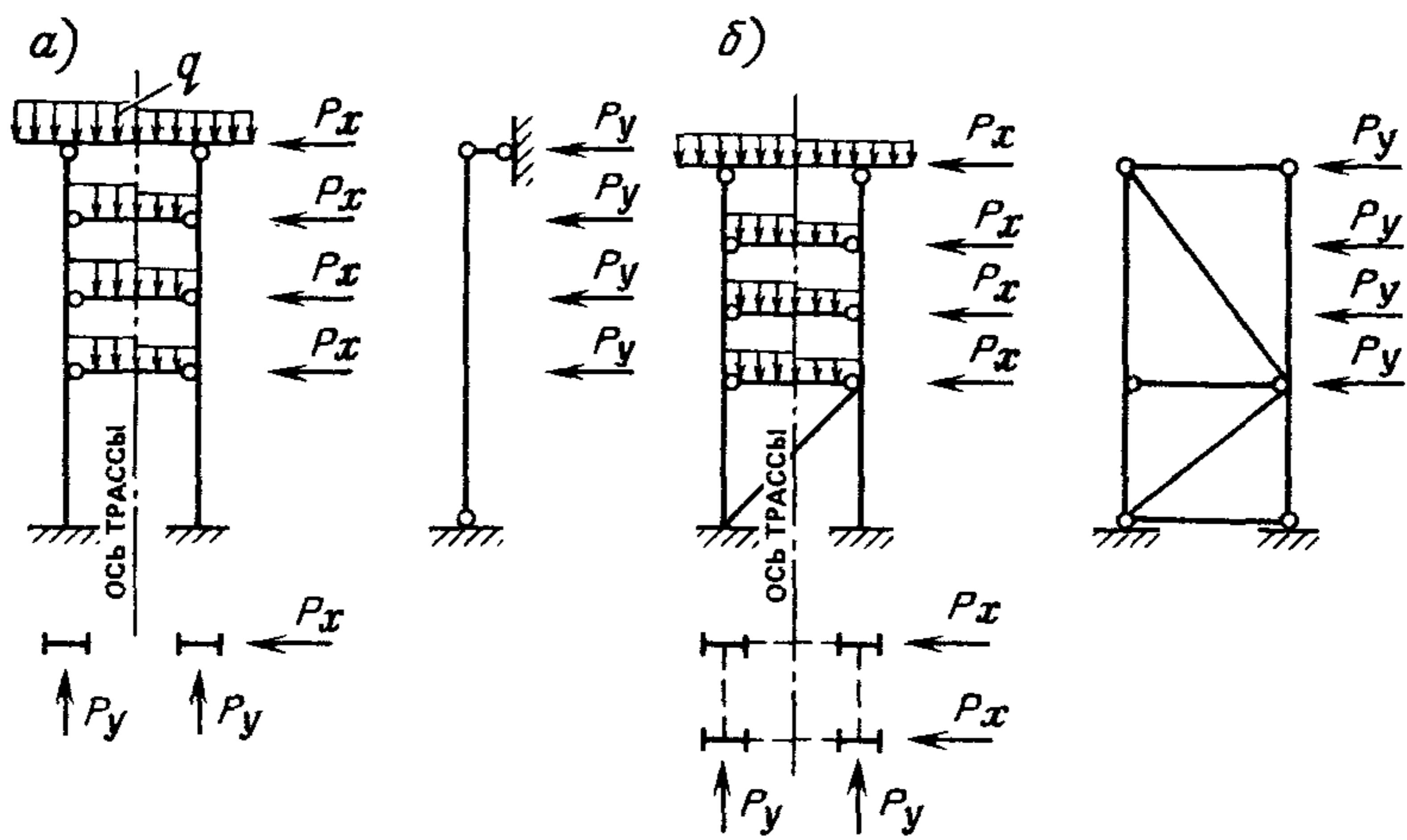
Рис. 30. Расчетные схемы стальных многоярусных опор
