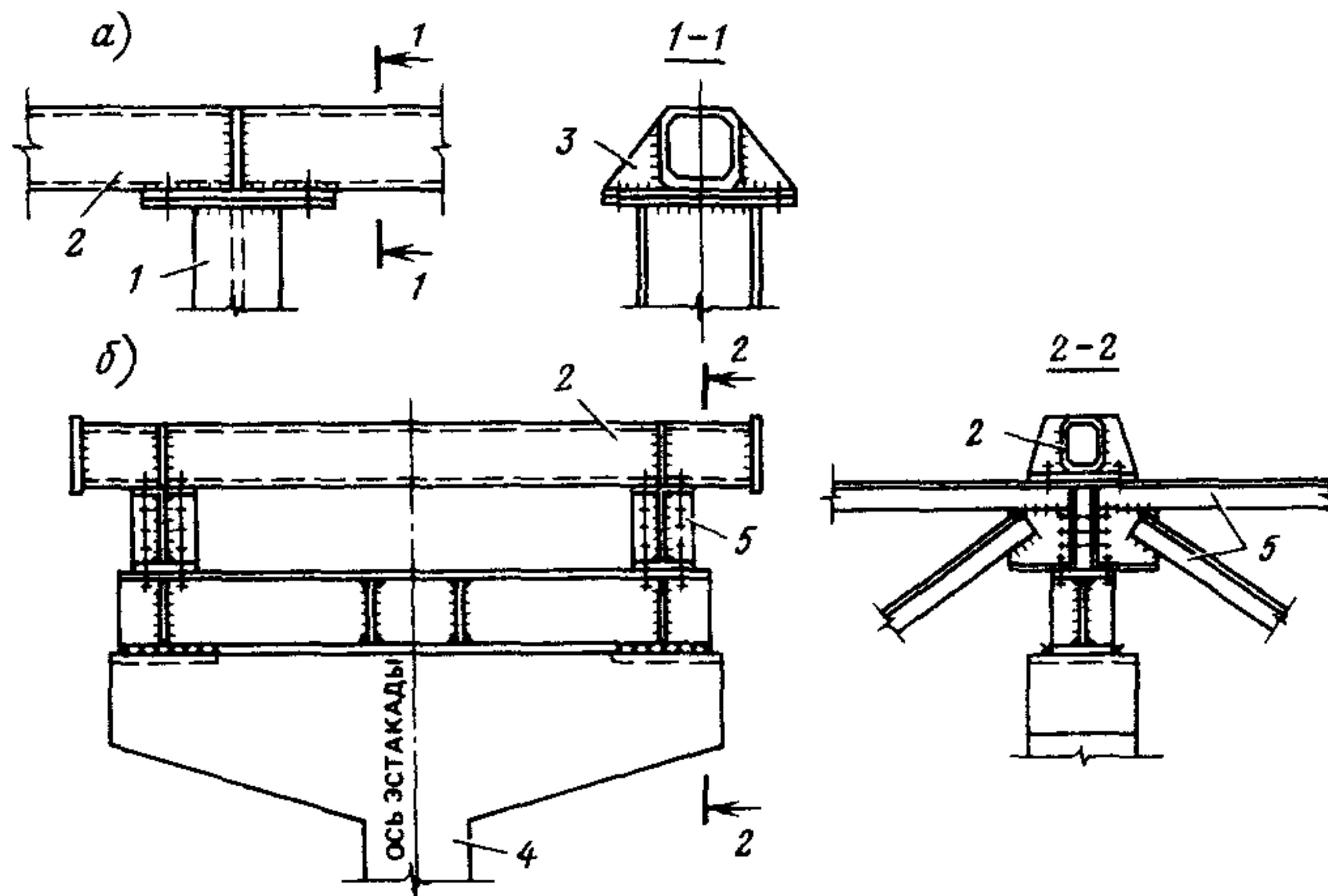
Рис. 8. Узлы опирания стальных конструкций
