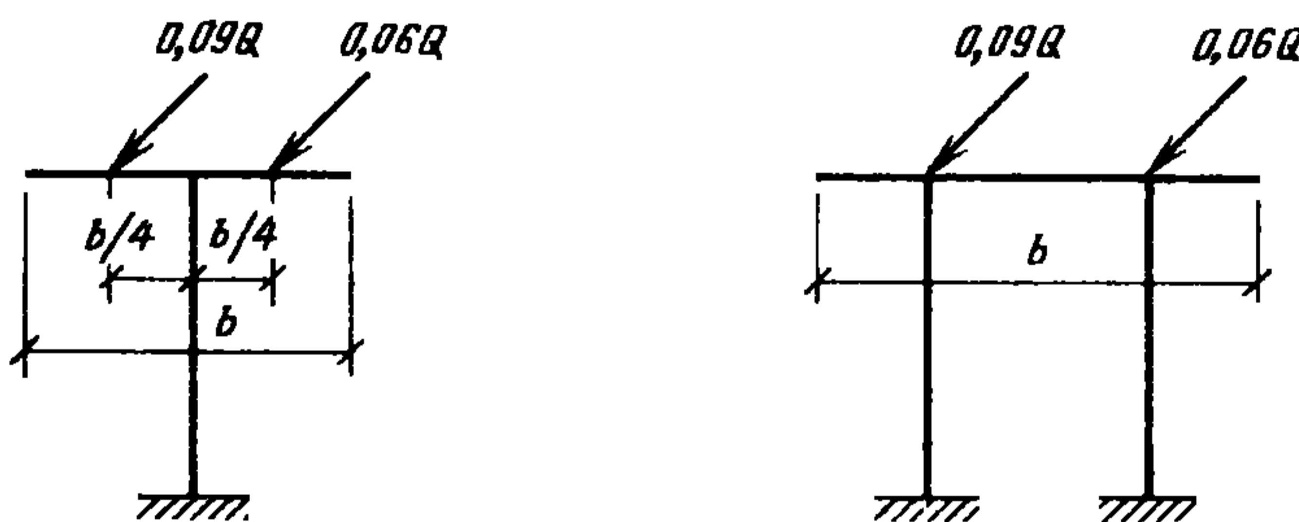
**Рис. 23. Распределение горизонтальной нагрузки при расчете колонн и фундаментов промежуточных отдельно стоящих опор по поперечному сечению трассы**
