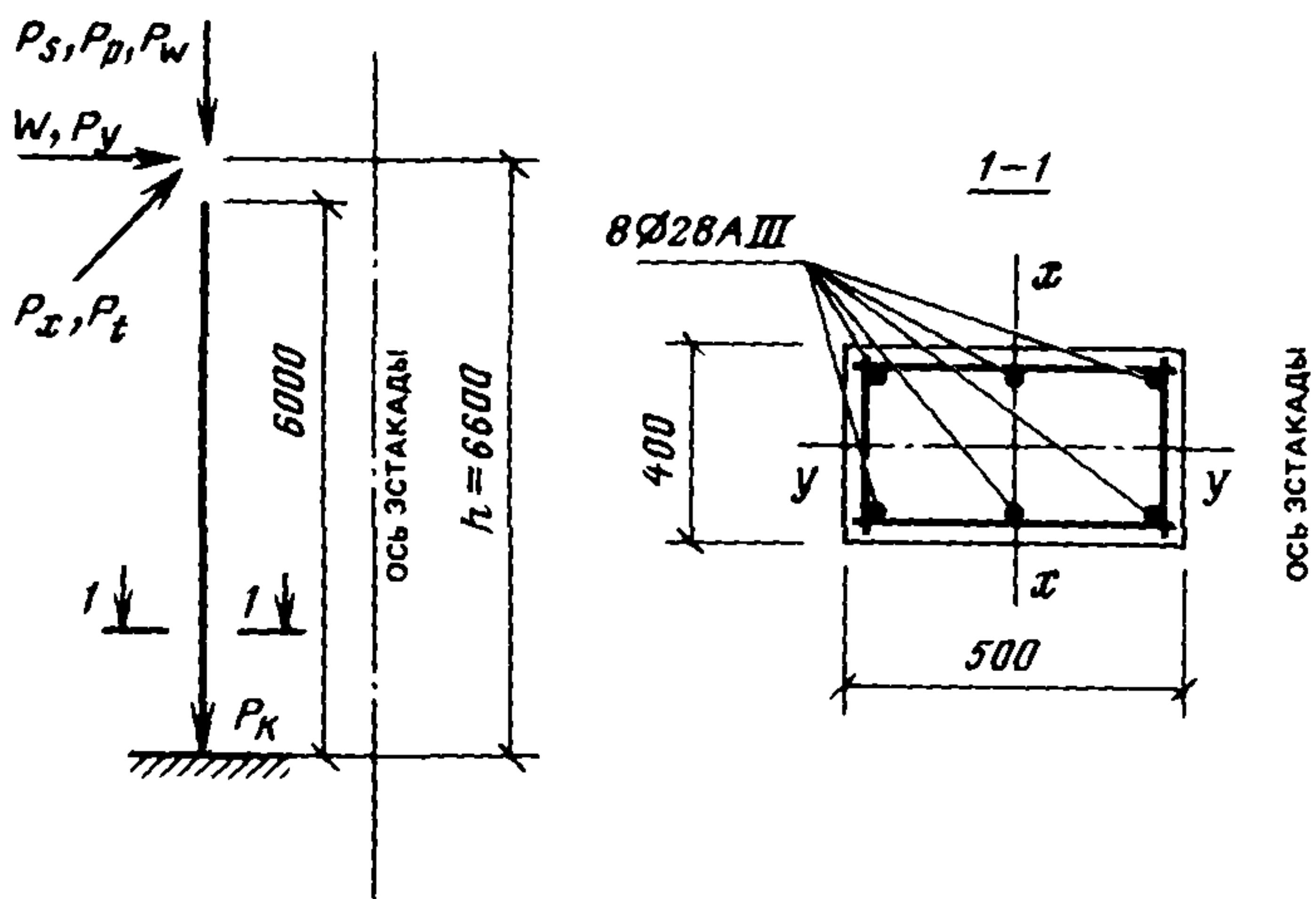
Рис. 16. Расчетная схема колонны эстакады
