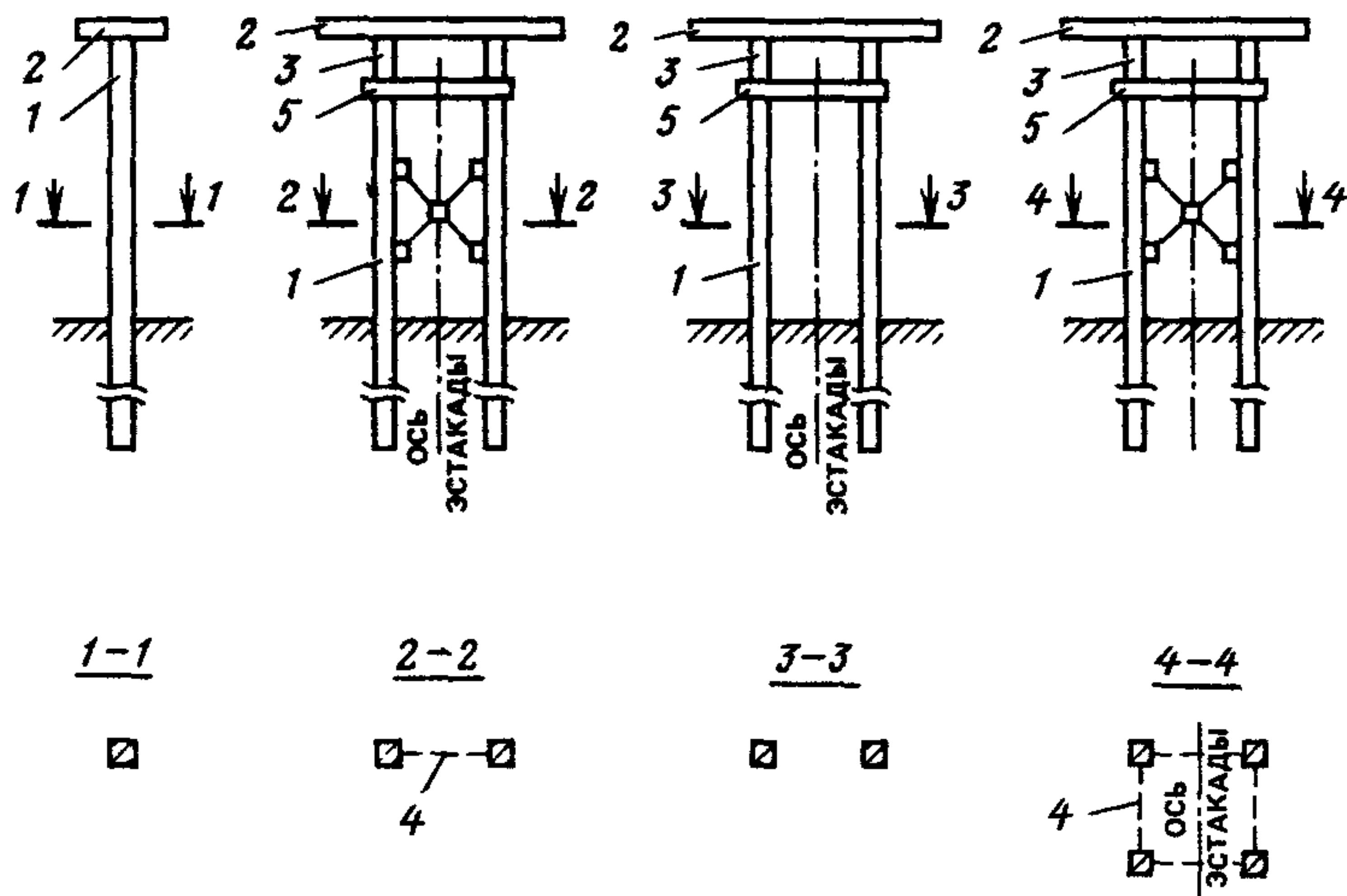
**Рис. 11. Типы опор с применением свай-колонн**
