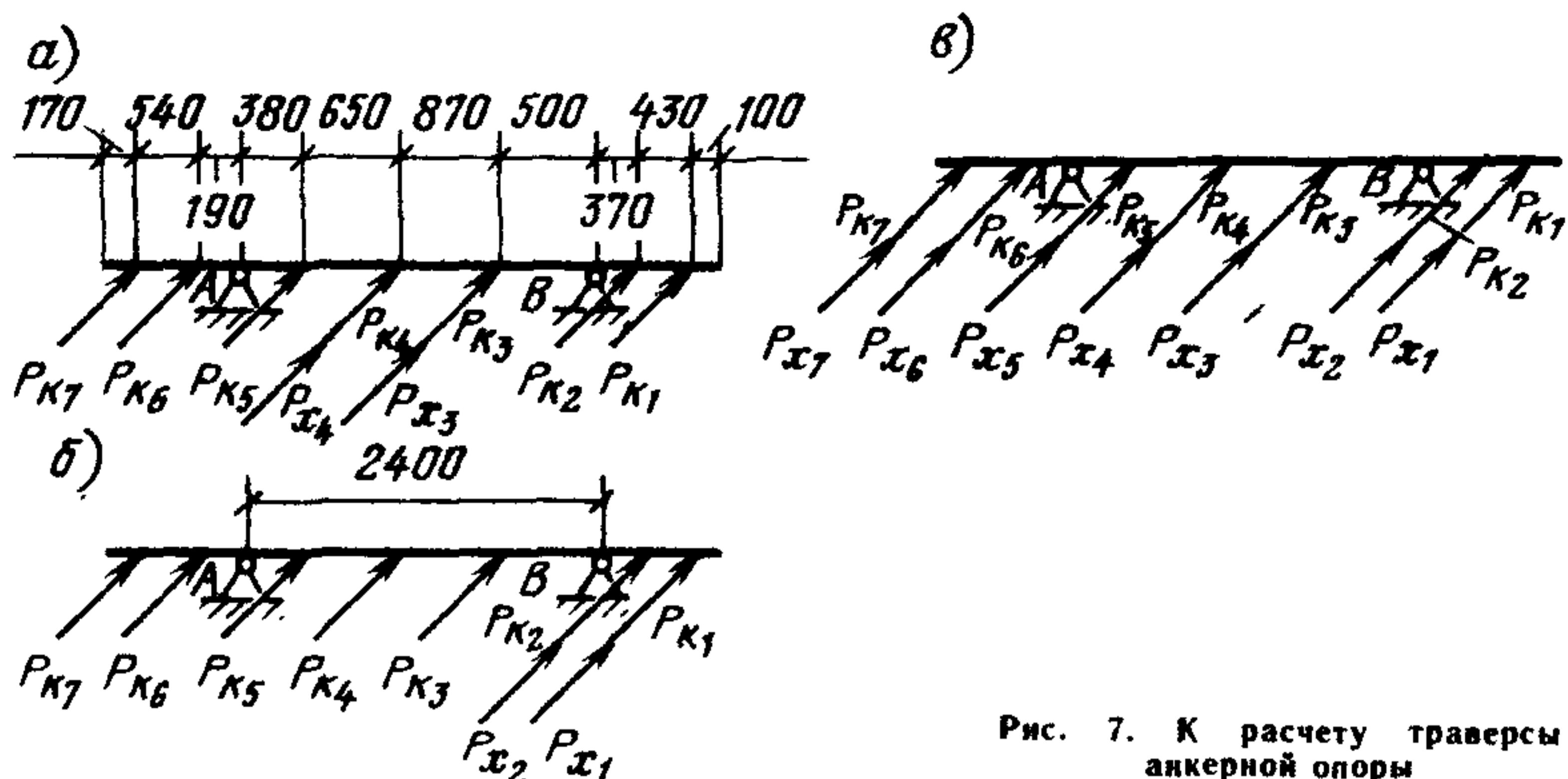
Рис. 7. К расчету траверсы анкерной опоры
