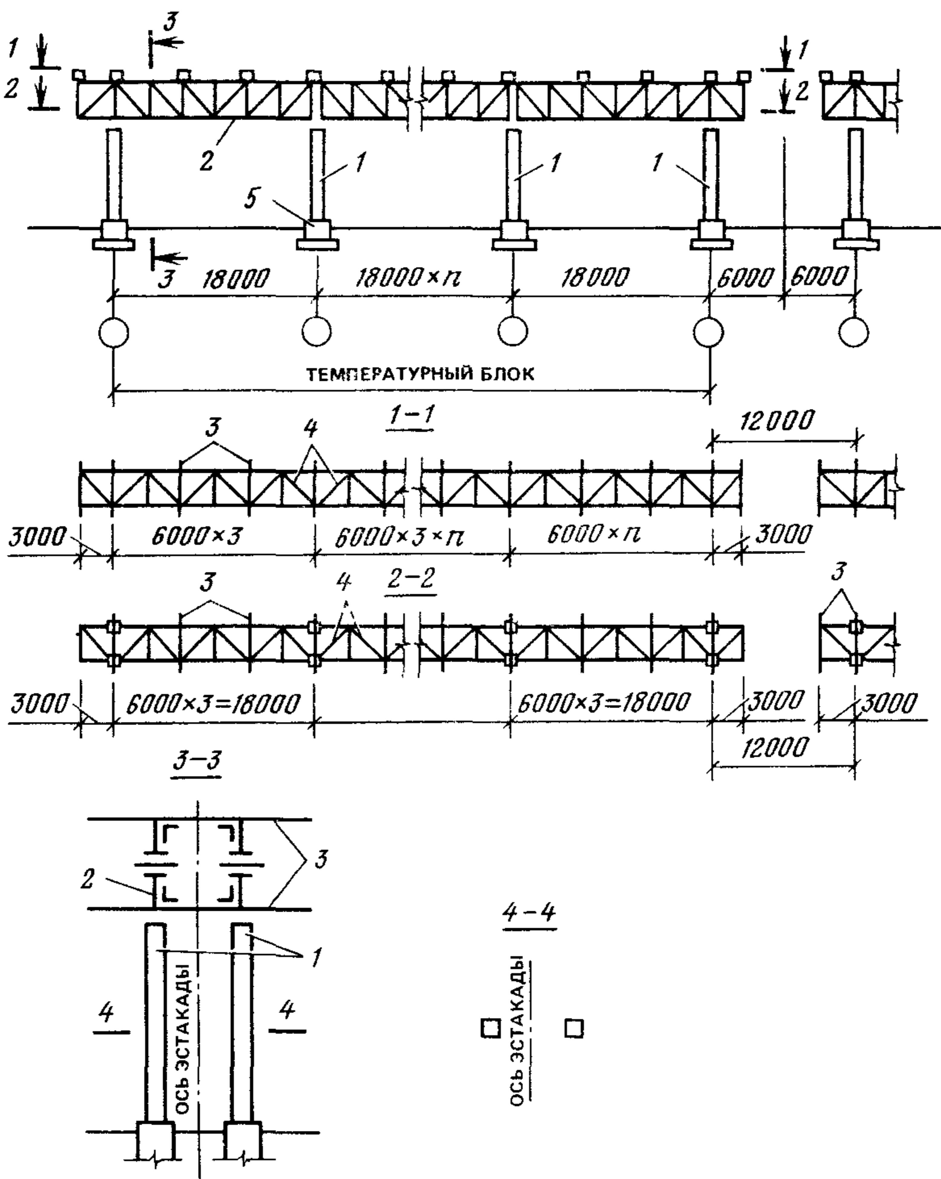
**Рис. 6. Конструктивная схема двухъярусной эстакады**
