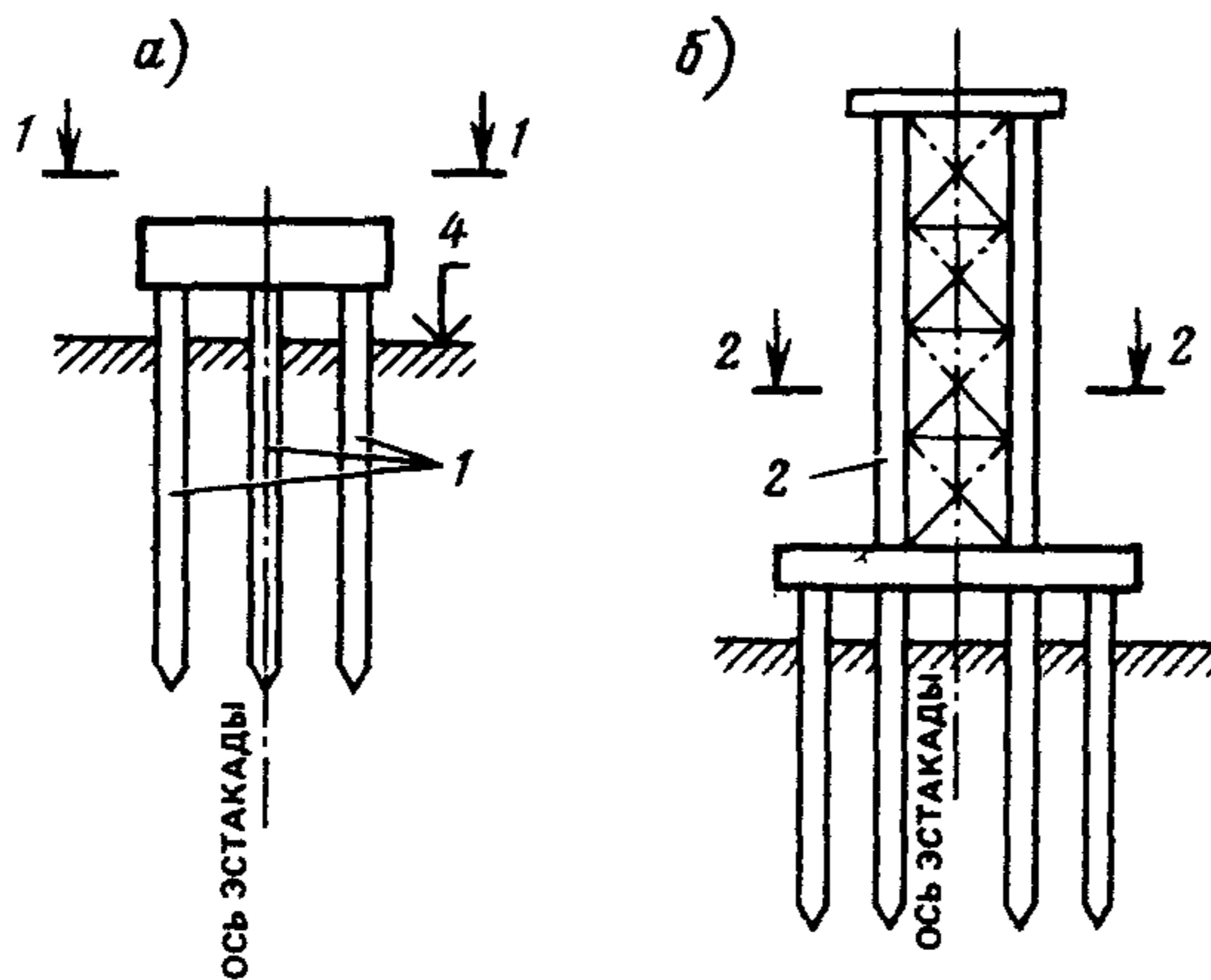
Рис. 13. Опоры с применением свайного ростверка
