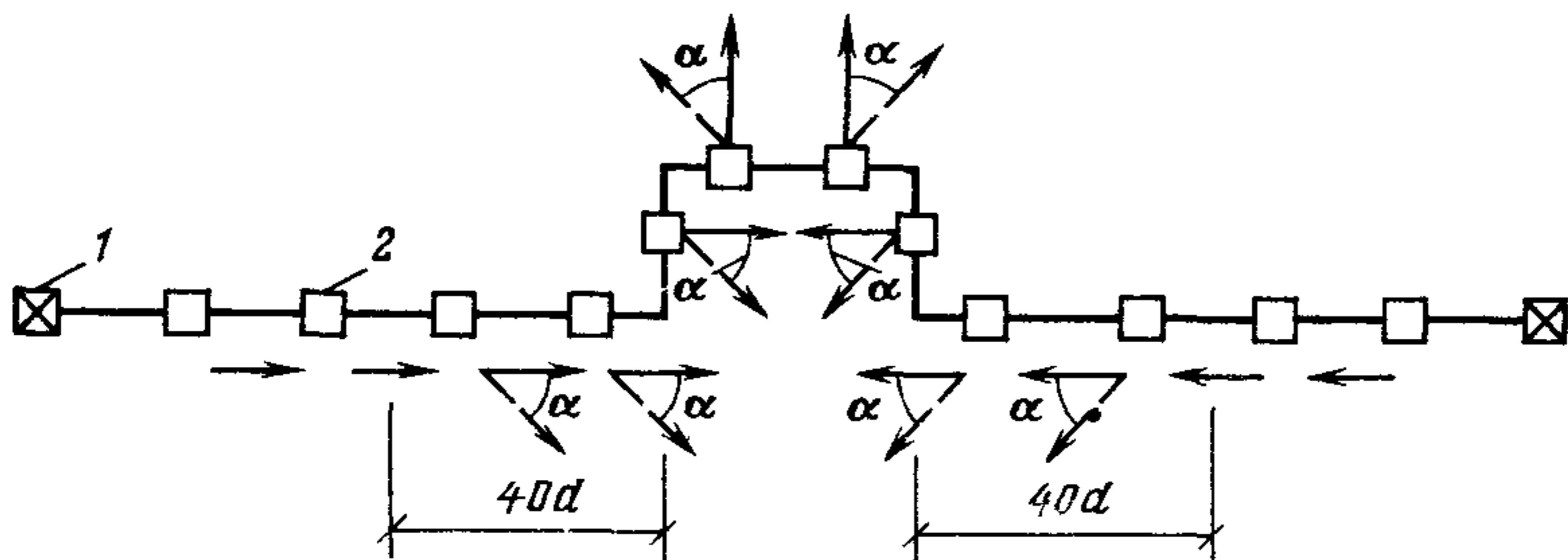
Рис. 21. Направления горизонтальной нагрузки в местах подвижного опирания трубопроводов на отдельно стоящие опоры при нагревании трубопроводов  $\alpha = 45^\circ$  — в скользящих опорных частях,  $\alpha = 70^\circ$  в катковых
