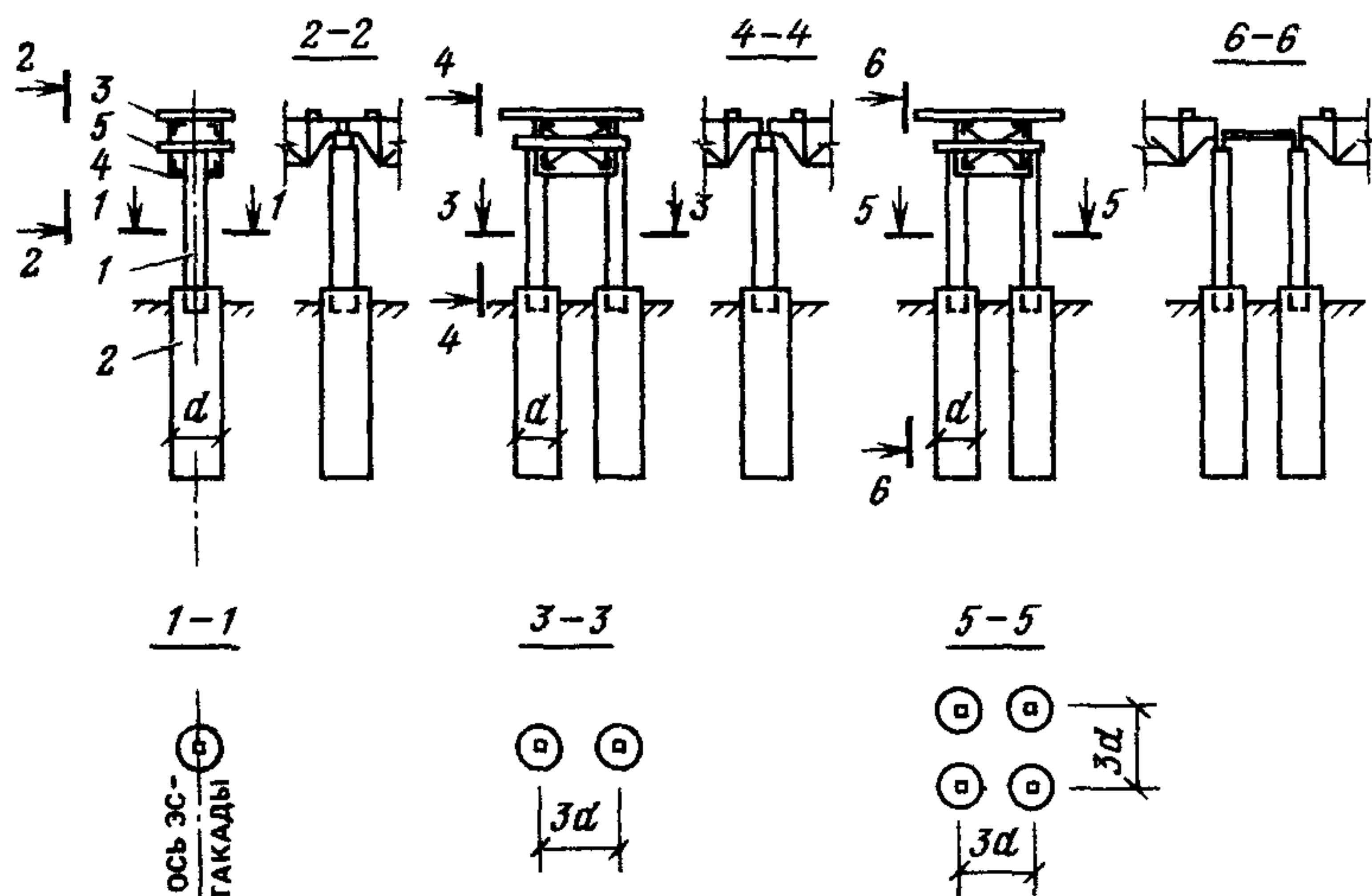
**Рис. 12. Типы опор с применением буронабивных свай и свай-оболочек**
