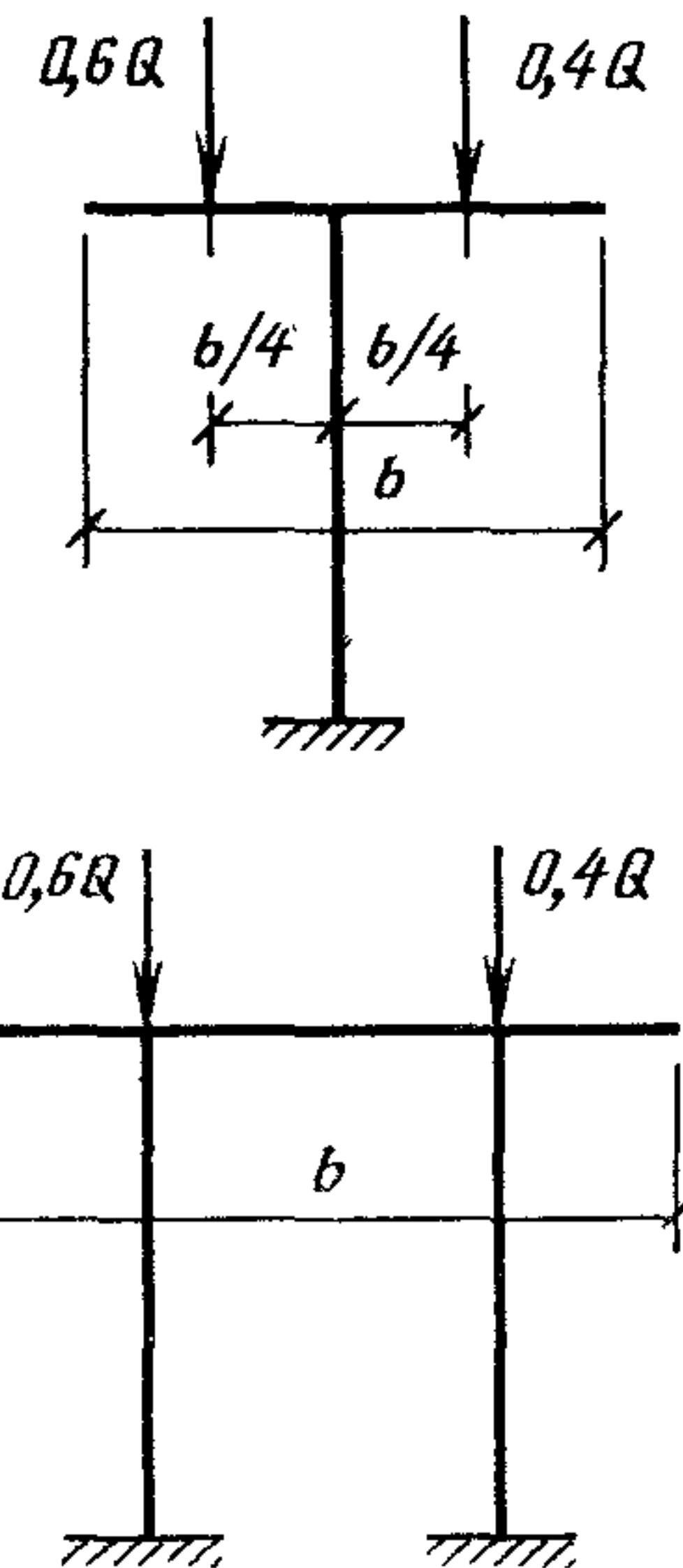
**Рис. 18. Распределение вертикальной нагрузки при расчете колонн и фундаментов промежуточных отдельно стоящих опор по поперечному сечению трассы**
