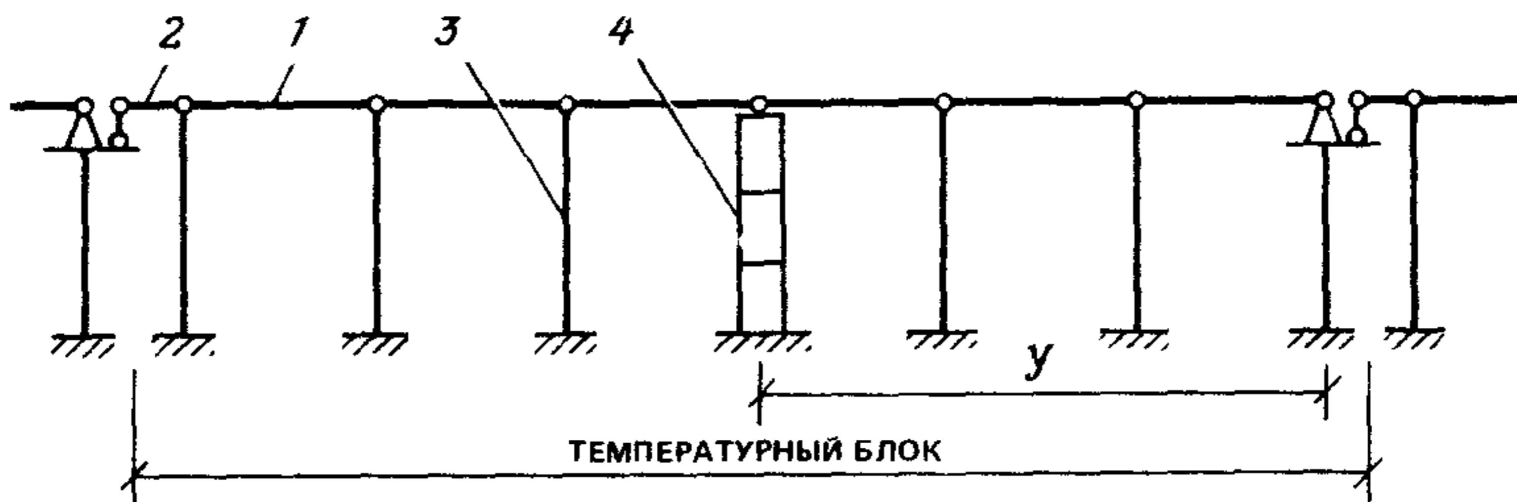
**Рис. 28. Расчетная схема эстакады в продольном направлении**
