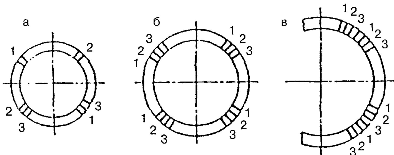
**Рис. 3. Схема вырезки образцов для механических испытаний**
