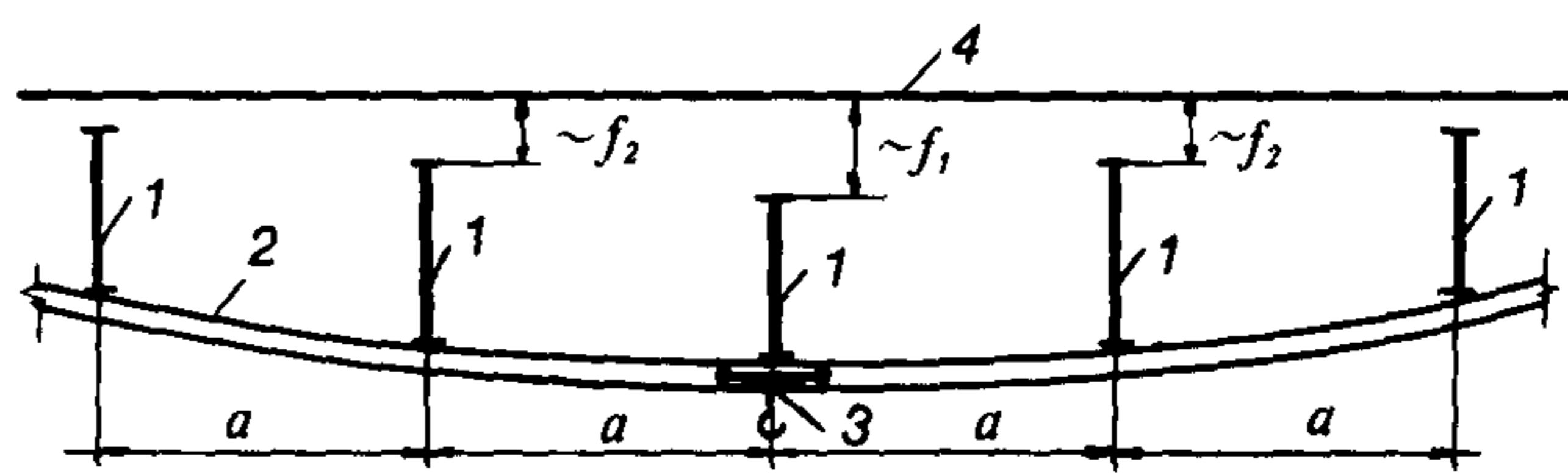
Черт. 5. Схема для определения прогибов строительных конструкций при наличии подвесных крановых путей
