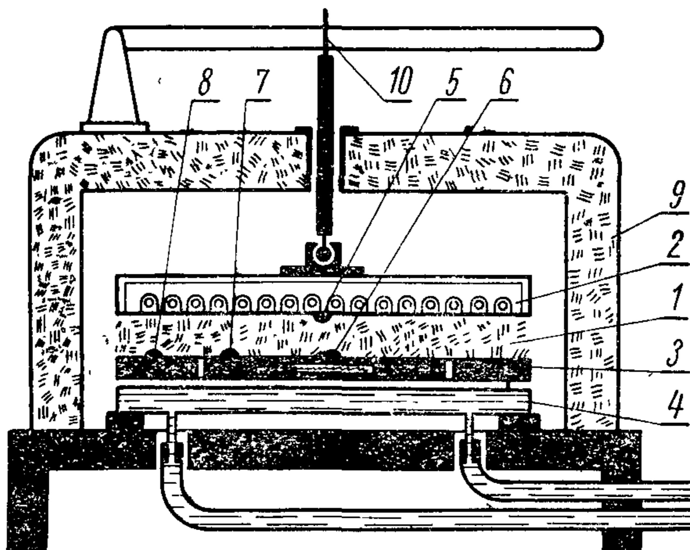
1.2. Тепловой поток от нагревателя через образец и малоинерционный тепломер передается холодильнику. Величина теплового потока, проходящего через центральную часть образца, измеряется тепломером, представляющим собой термобатарею на парниковом диске, или тепломером с воспроизводящим элементом, в котором вмонтирован плоский электрический нагреватель.
