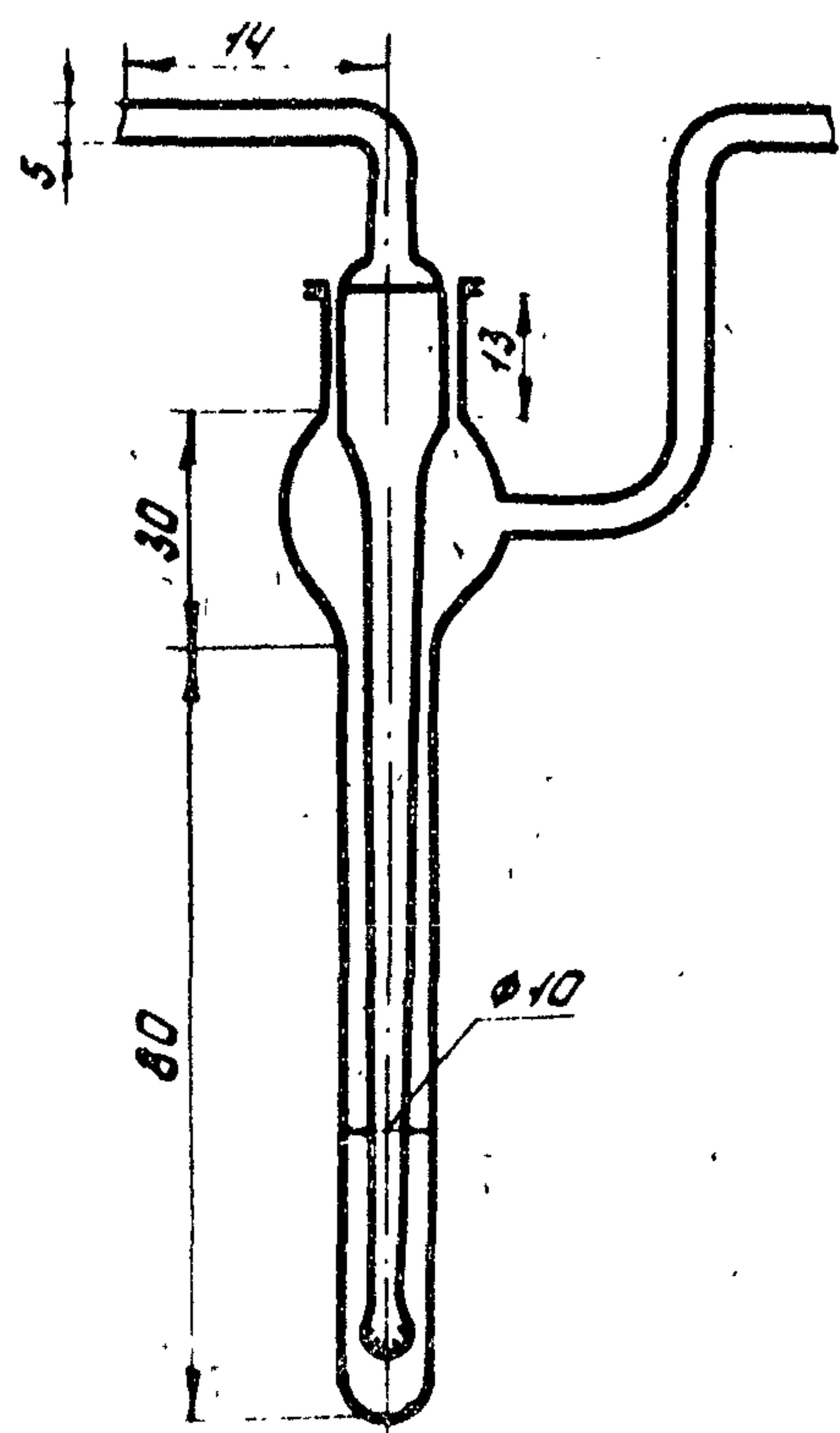
Рис. I. Микропоглотительный прибор Полежаева.
