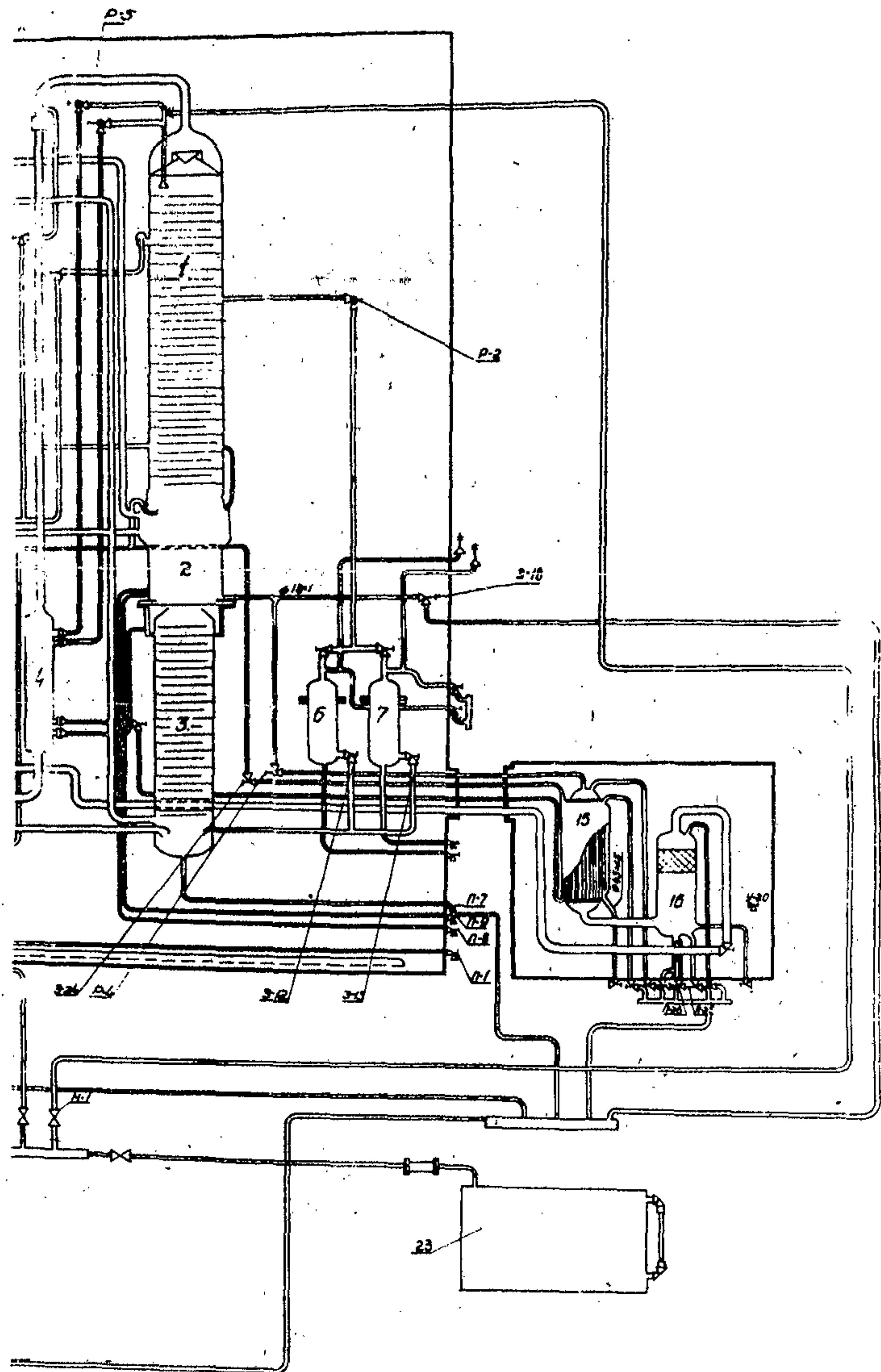
Схема обезжиривания блока разделения воздуха КГ-300М:
