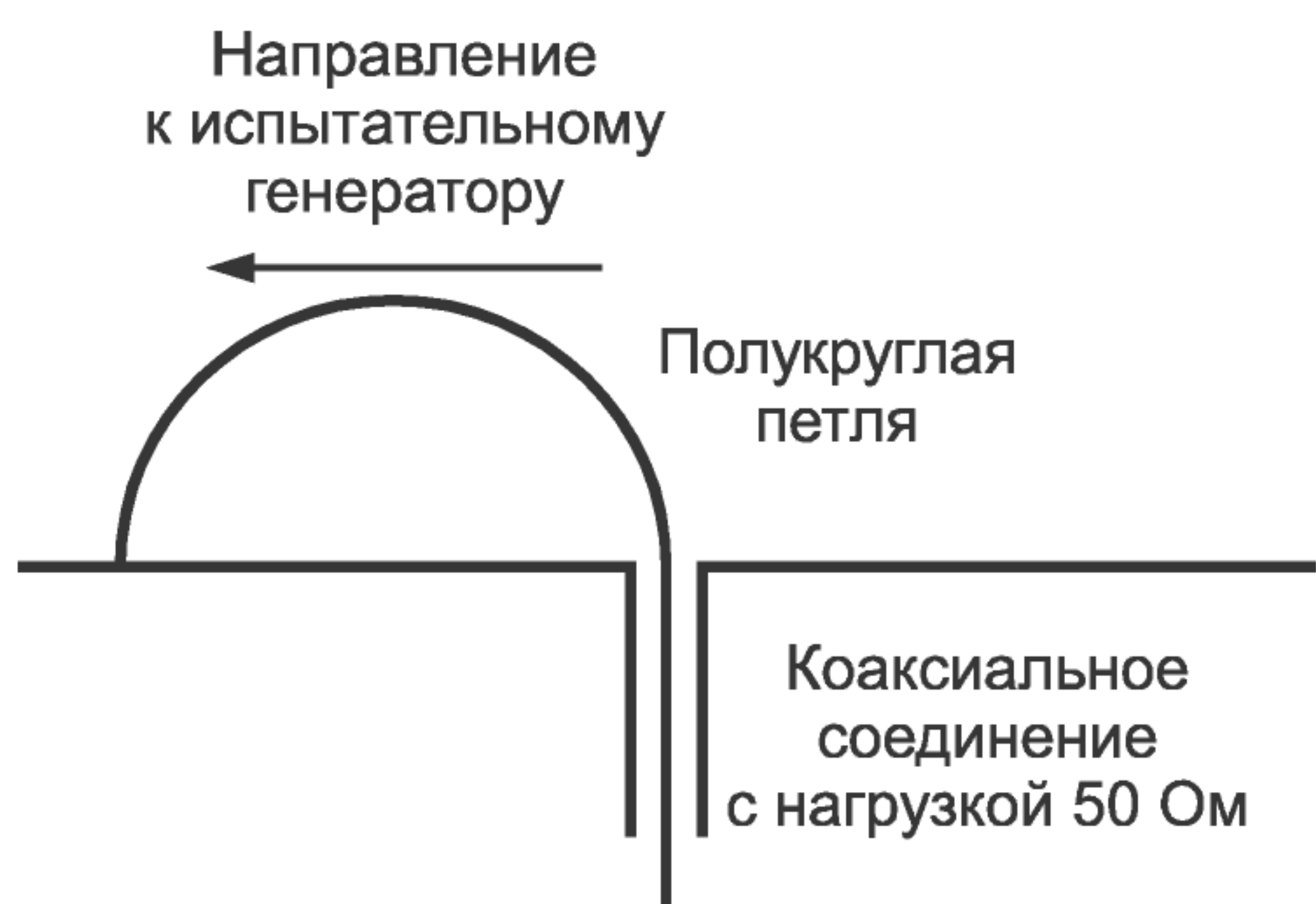
Рисунок D.3 — Полукруглая петля на пластине заземления
