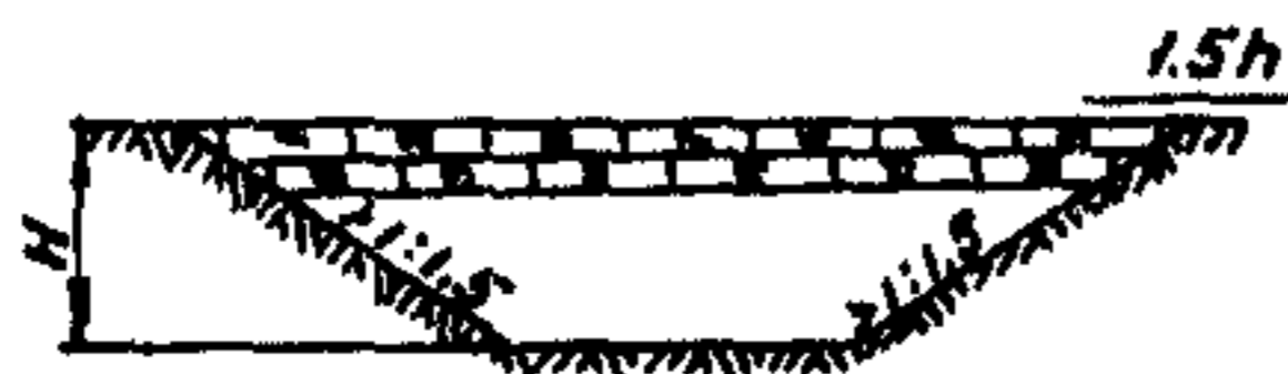
Рис. 3.5. Схема разработки выемки с перемещением грунта и укладкой в насыпь бульдозерами I—IV—последовательность разработки траншеи и перемещения грунта
