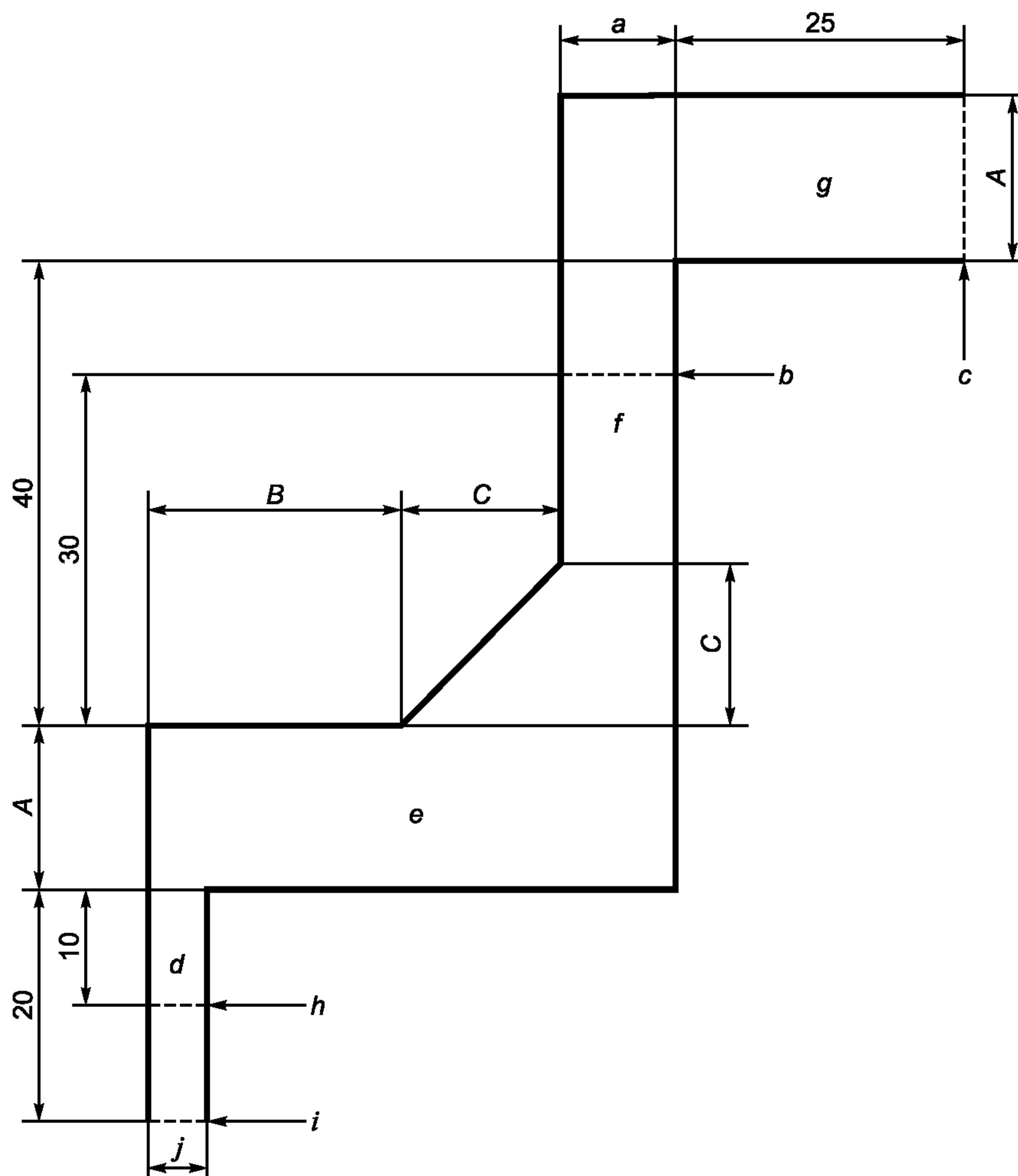
*A* — расстояние, в 1,1 раза превышающее диаметр окружности поворота по следу колес, или 14 м (в зависимости от того, какой из размеров больше); *B* — расстояние, в 1,75 раза превышающее диаметр окружности поворота по следу колес, или 22 м (в зависимости от того, какой из размеров больше); *C* — расстояние, в два раза превышающее максимальную колесную базу, или 15 м (в зависимости от того, какой из размеров меньше)
