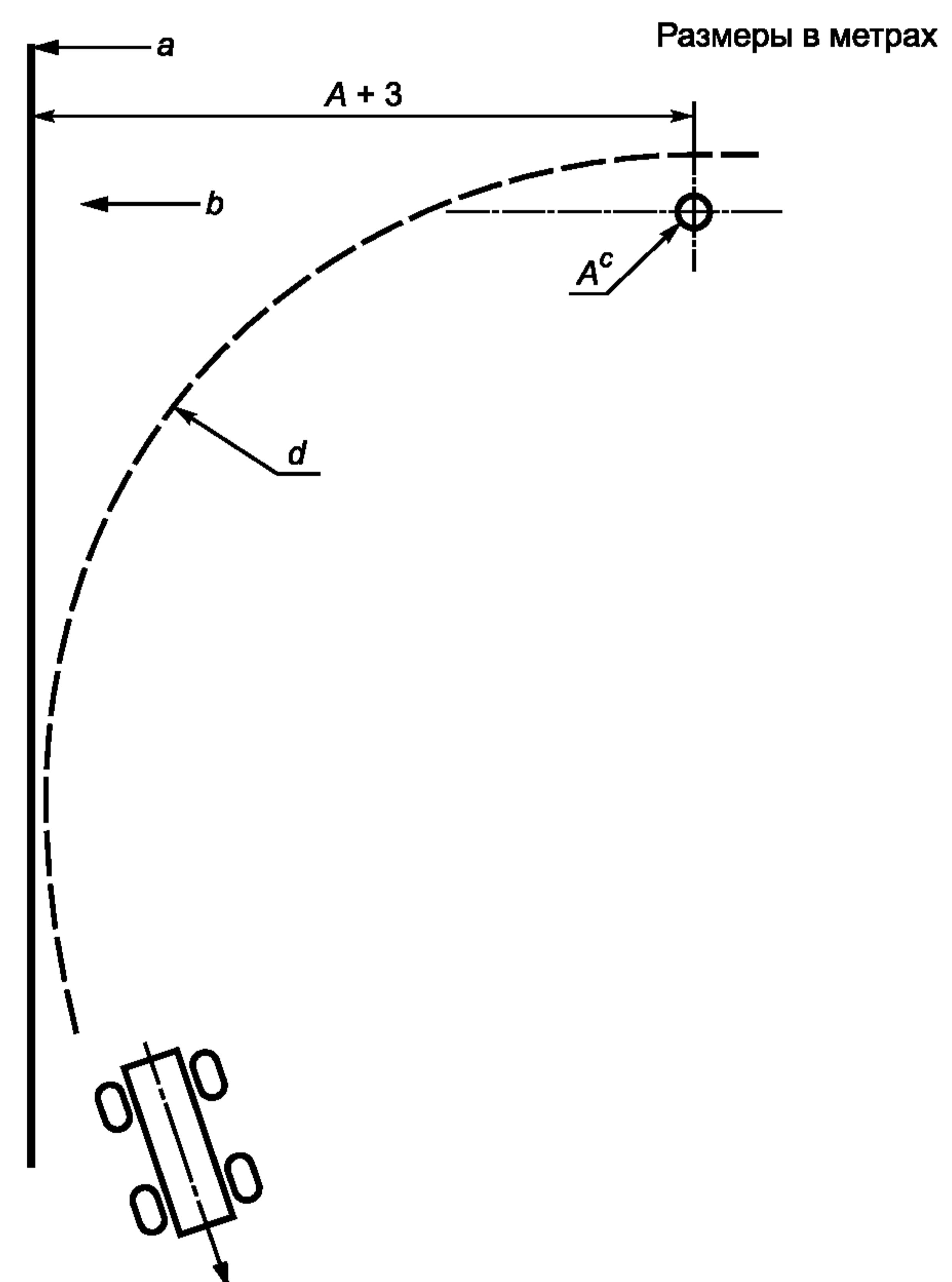
*A* — расстояние, в 1,1 раза превышающее диаметр окружности поворота по следу колес, или 14 м в зависимости от того, какой из размеров больше; *a* — перпендикуляр к первоначальному направлению движения; *b* — первоначальное направление движения; *c* — точка *A*: положение передней оси в момент начала управляемого движения (см. 10.3.8); *d* — внешняя линия следа колес
