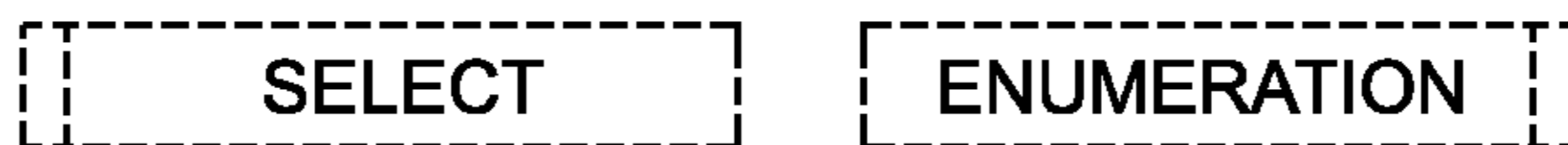
Рисунок D.5 — Символы для конструкционных типов данных языка EXPRESS
