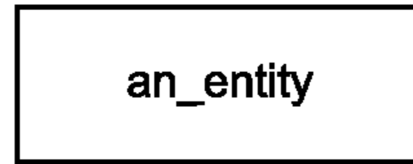
Рисунок D.10 — Обозначение объектного типа данных языка EXPRESS
