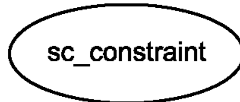
Рисунок D.11 — Обозначение конструкции языка EXPRESS SUBTYPE_CONSTRAINT
