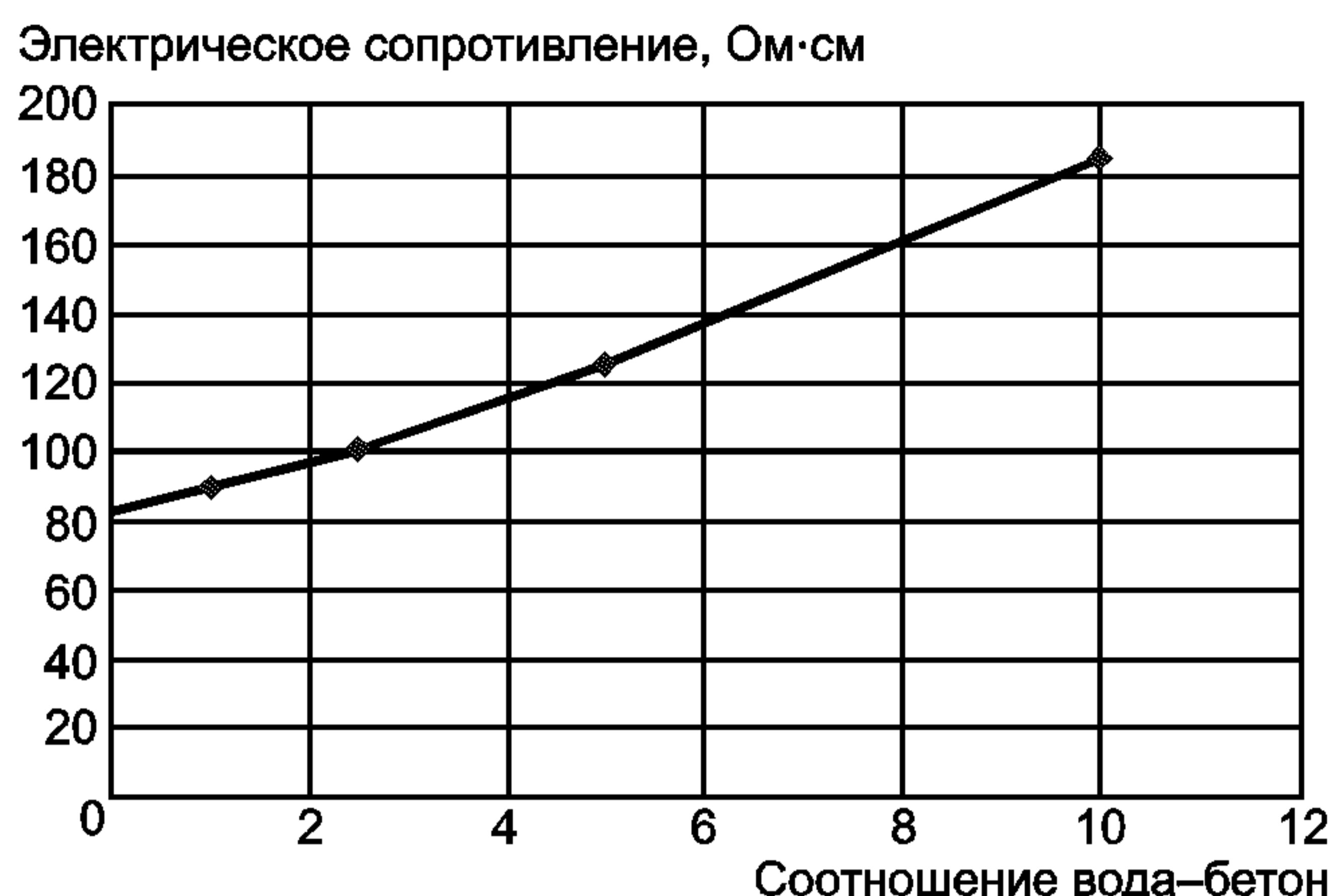
Рисунок 4 — Оценка электрического сопротивления водной вытяжки из бетона
