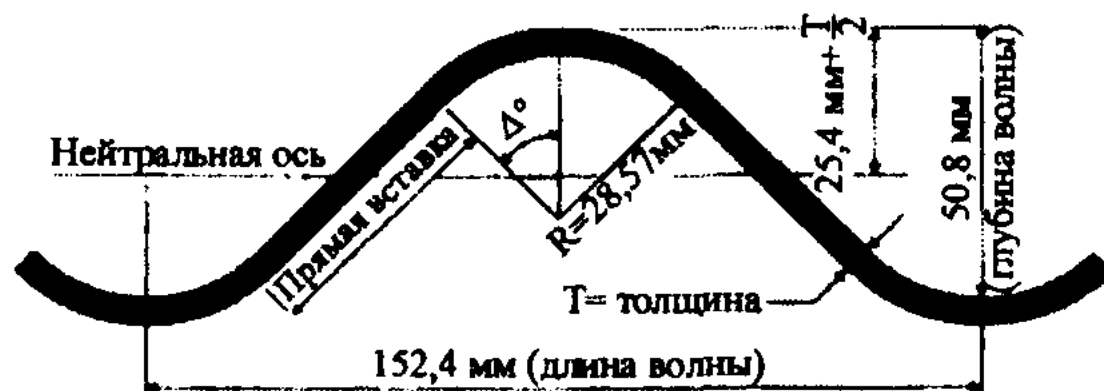
Рис. А.2. Профиль гофрированного листа Толщина листа 3,0-7 мм, углы изгиба гофра 44,53-46,08°, Прямая вставка 43,24-47,88 мм
